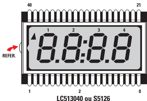
Figure 4 : Quand vous insérez l'afficheur LCD dans ses deux rangées de barrettes de vingt trous chacune, vérifiez bien que la petite protubérance de verre (REFER) est bien vers la gauche. La référence peut être également un signe < à l'intérieur du LCD, à gauche. Voir figure 6a.
