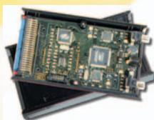
Cet appareil permet de coder un signal vidéocomposite, en ayant le choix entre quatre modes de cryptage, ou de décoder une reproduction déjà
