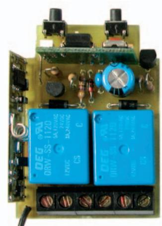
Figure 3: Photo d'un des prototypes de la platine du récepteur universel de radiocommande.
