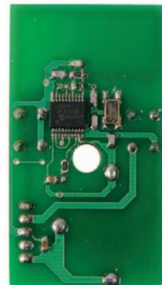
Figure 5a: Photo d'un des prototypes de la platine de l'émetteur, côté rfPIC.
