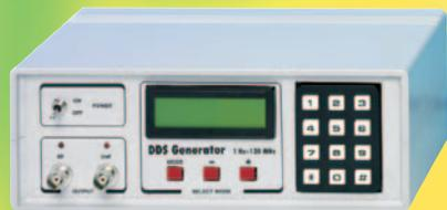
Ce générateur de signaux BF à VHF, réalisé à partir du fameux circuit intégré DDS AD9951, permet de prélever à sa sortie un signal sinusoïdal dont la fréquence peut varier d'un minimum de 1 Hz à un maximum de 120 MHz. Les DDS étant appelés à
