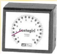
A une époque où les cyclomoteurs et plus particulièrement les scooters font un retour en force parmi les véhicules sillonnant nos villes, il apparaît que ces engins aux lignes modernes sont le plus souvent dépourvus d'un compte-tours indiquant au conducteur le régime du moteur. Alimentation 12 Vdc. Nbrs Tours/min de 0 à 10000 avec visualisation par leds.
