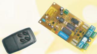
Les avantages offerts par les dispositifs radio-commandés sont si évidents que nous aurions beaucoup de réticence aujourd'hui à renoncer à cette technologie de confort. La nouvelle radio-commande que nous vous présentons ici est dotée d'une clé d'accès et de deux relais de sortie qui permettent d'activer facilement et à distance (30 m) les mécanismes les plus divers comme ouverture de portail, une alarme antivol, un éclairage extérieur, un Velux ou un store et bien d'autres choses encore.
