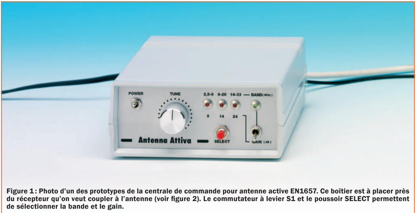
**Figure 1:** Photo d'un des prototypes de la centrale de commande pour antenne active EN1657. Ce boîtier est à placer près du récepteur qu'on veut coupler à l'antenne (voir figure 2). Le commutateur à levier S1 et le poussoir SELECT permettent de sélectionner la bande et le gain.
