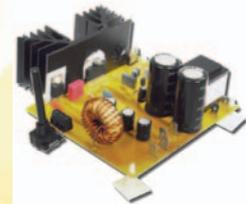
Idéal pour le laboratoire, cet appareil est en mesure de fournir une tension continue comprise entre 0 et 25 volts avec un courant maximal de 8
