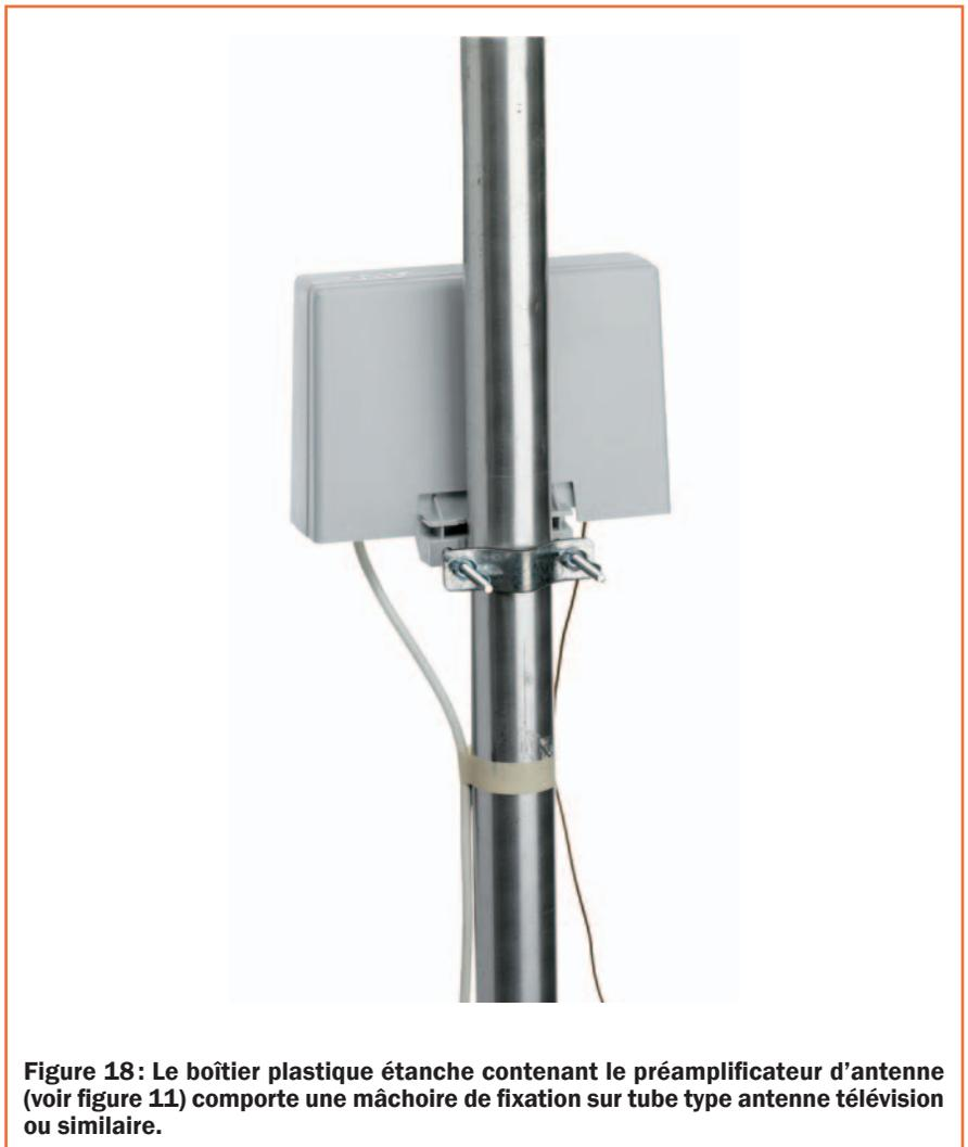
Figure 18: Le boîtier plastique étanche contenant le préamplificateur d'antenne (voir figure 11) comporte une mâchoire de fixation sur tube type antenne télévision ou similaire.
