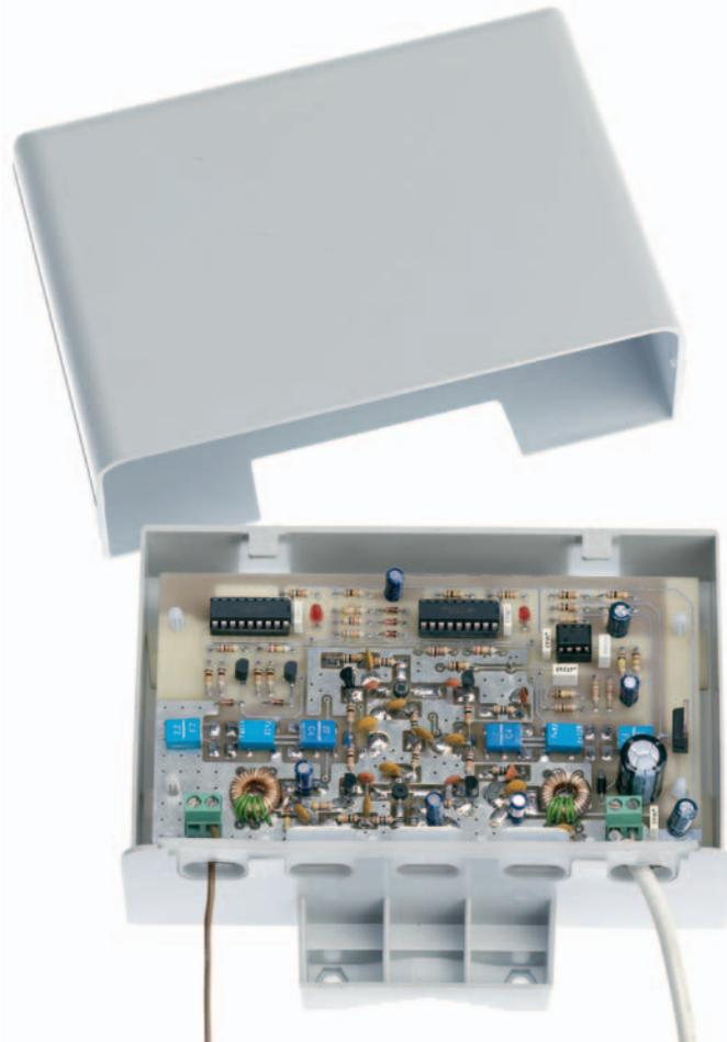
Figure 11 : Photo d'un des prototypes de la platine du préamplificateur d'antenne EN1656 fixée sur le fond du boîtier plastique spécifique étanche MTK13.04 à l'aide de quatre entretoises autocollantes. Ce boîtier comporte une mâchoire de fixation sur tube, comme le montre la figure 18. Les trous pratiqués sur le côté visible laissent passer le fil d'antenne et le câble coaxial.
