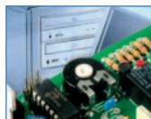
Ce montage, complètement géré par microcontrôleur et doté d'un bloc de batteries rechargeables, maintient le ventilateur de refroidissement de la CPU en fonctionnement afin d'éviter toute montée en température excessive après l'arrêt de l'ordinateur.
