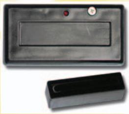
Ce système émet un signal d'alarme codé MOTO-ROLA MC145026 quand l'aimant s'éloigne de l'ampoule "reed" dont il est pourvu. Conçu pour protéger l'accès des portes et des fenêtres, il se monte facilement sur les dormants des huisseries. Un microcontact permet, également, de donner l'alarme par radio si le dispositif est arraché ou démonté. Si la pile est faible, un buzzer le signale.
