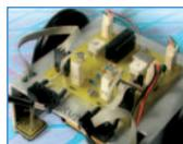
Un profilé en aluminium, deux roues et naturellement une touche d'électronique et le jeu est fait! Un groupe d'élèves électroniciens a su mettre en pratique les connaissances acquises sur les bancs de l'école pour réaliser un robot simple dont "l'intelligence" tient dans un petit microcontrôleur adéquatement programmé.
