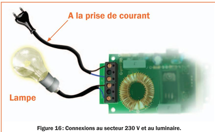
Figure 16: Connexions au secteur 230 V et au luminaire.
