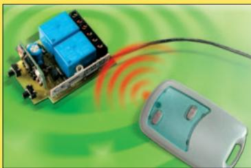
Ce récepteur utilise un module hybride Aurel pour réaliser un récepteur de radiocommande on-off à deux canaux capable de travailler avec les anciens codes à 12 bits comme avec les plus sécurisés, ceux qui répondent au protocole KeeLoq. On peut monter un module hybride AM ou FM, en fonction des prestations que le contrôle à distance doit assurer.
