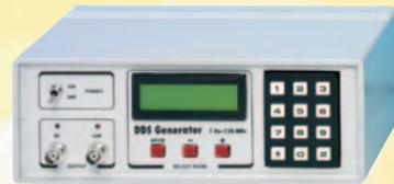
Ce générateur de signaux BF à VHF, réalisé à partir du fameux circuit intégré DDS AD9951, permet de prélever à sa sortie un signal sinusoïdal dont la fréquence peut varier d'un minimum de 1 Hz à un maximum de 120 MHz. Les DDS étant appelés à devenir les circuits intégrés incontournables de beaucoup d'appareils électroniques du futur. Alimentation: 230 Vac. Le générateur complet est constitué du kit EN1645, du module CMS KM1644 et de l'alimentation EN1646.
