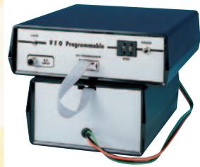
Ce montage vous permet de programmer un microcontrôleur ST7 afin de réaliser des VFO à PLL à chargement sériel, capables de produire une gamme de fréquences allant de 50 à 180 MHz. Le Kit VFO EN1565 est livré sans le programmeur de ST7 EN1546K qui est vendu séparément. Alimentation 12 Vdc
