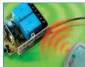
Ici nous utilisons une fois de plus un module hybride Aurel pour réaliser, avec très peu de composants autour, un RX de radiocommande on-off à deux canaux capable de travailler avec les anciens codes à 12 bits comme avec les plus sécurisés, ceux qui répondent au protocole KeeLoq. On peut monter un module hybride AM ou FM, en fonction des prestations que le contrôle à distance doit assurer.
