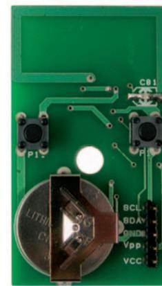
Figure 5b: Photo d'un des prototypes de la platine de l'émetteur, côté pile bouton.
