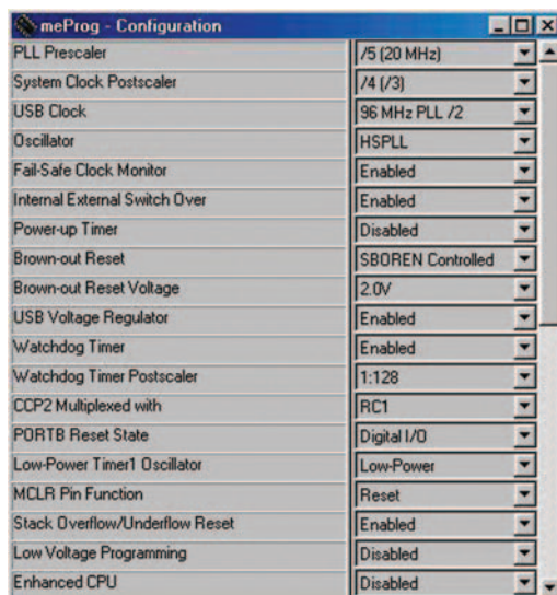
Figure 4 : Pour la programmation du PIC nous utilisons le Melabs Programmer de MicroEngineering Labs, en maintenant la configuration visible dans cette fenêtre de dialogue.
