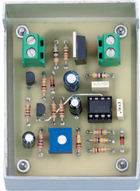
Figure 6: Photo d'un des prototypes de la platine de l'allumage progressif pour ampoule 12 V EN1648 installée dans son boîtier MOX30 (vous devrez le percer pour fixer la platine au fond à l'aide de quatre entretoises, pour laisser entrer les deux fils d'alimentation 12 V et pour laisser sortir les deux fils allant à la charge).
