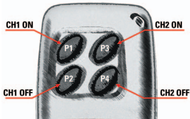
Figure 2 : Si les cavaliers J1-J2 du récepteur sont sur AB, quand on presse P1 le relais 1 s'active et si on presse P2 il se met au repos. Si on presse P3, le relais 2 s'active et si on presse P4 il se met au repos. Si les cavaliers J1-J2 sont sur BC, quand on presse P1 le relais 1 s'active et quand on le relâche il se met au repos (dans ce cas P2 et P4 ne sont pas utilisés).
