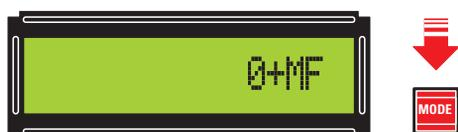
Figure 55: Pressez une seule fois le poussoir Mode et le LCD affiche 0+MF.
