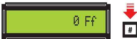
Figure 36: Pressez à nouveau la touche # et le LCD affiche 0 Ff, c'est la valeur de la fréquence finale de votre balayage ("sweep").
