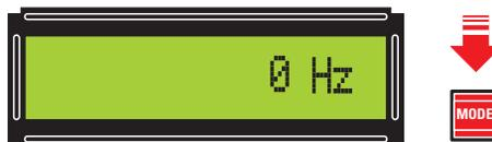
Figure 49: Pressez deux fois le poussoir Mode de façon à afficher 0 Hz.
