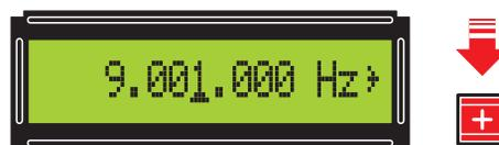
Figure 28: Pressez le poussoir + et la fréquence augmente de 1 000 Hz à chaque pression. Quand vous arrivez ainsi à la fréquence de 9 009 000 Hz, elle continue à augmenter de 1 000 Hz.
