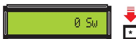
Figure 43: Pour lancer le balayage, pressez à nouveau la touche \* et 0 Sw s'affiche sur le LCD.
