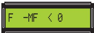
Figure 59: Si cette indication s'affiche, c'est que la fréquence est inférieure à la MF.
