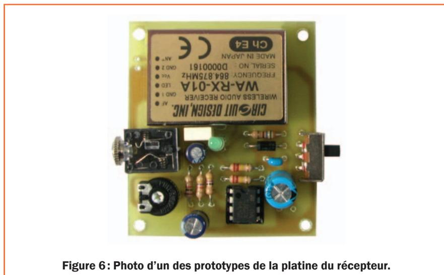
Figure 6 : Photo d'un des prototypes de la platine du récepteur.
