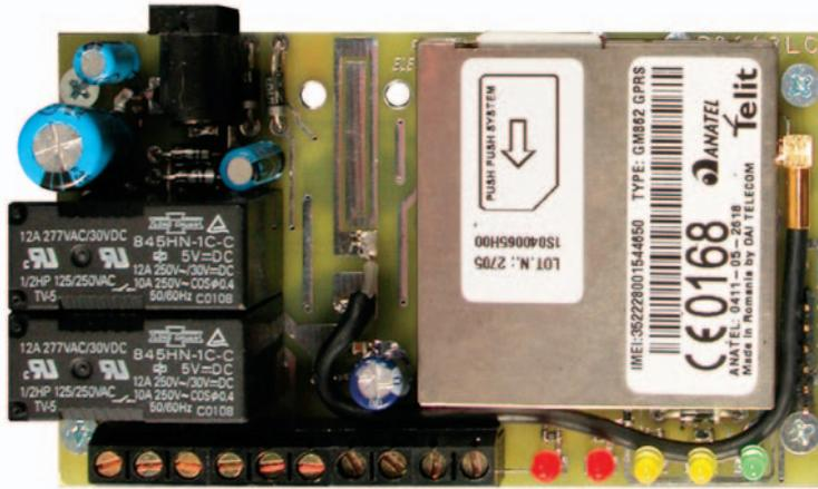
Figure 4a: Photo d'un des prototypes du contrôle à distance GSM, côté composants.
