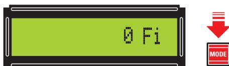
Figure 34: Après visualisation initiale de 0 Hz, pressez deux fois le poussoir Mode et l'indication Fi s'affiche (Fréquence initiale).
