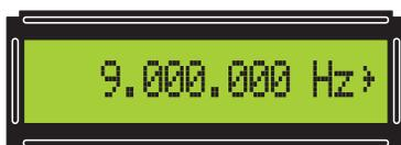
Figure 23: Quand vous avez entré une fréquence, vous pouvez la modifier de quelques Hz-kHz-MHz en vous servant des poussoirs +/-.
