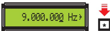
Figure 24: Si, par exemple, le LCD affiche 9 000 000 Hz > et si vous souhaitez modifier cette fréquence de quelques Hz, pressez la touche \* de façon à souligner le dernier 0 de droite.
