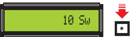
Figure 39: Pressez la touche \* et vous pourrez choisir la vitesse de balayage, laquelle peut être de 1 - 10 - 100 - 1 000 Sw, etc.
