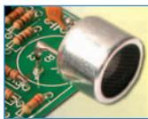
Cet appareil est en mesure de détecter la présence de personnes et d'objets jusqu'à une distance d'environ deux mètres. On peut s'en servir, sur un véhicule, comme radar de recul ou bien pour réaliser des appareils d'automatisme industriel, de petits robots, etc. Il dispose d'une barre de LED indiquant la distance de manière analogique et d'un buzzer d'alarme.
