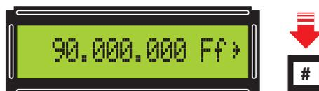
Figure 42: Pressez à nouveau la touche # et quand 0 Ff apparaît (voir figure 36), tapez 90 000 000 et pressez la touche de confirmation #.
