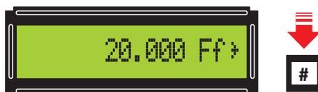
Figure 37: Tapez 20 000, puis pressez la touche de confirmation # et le LCD visualise 20 000 FLIP-FLOP >.
