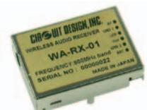
Notez que le module WA-RX-01 possède un circuit de silencieux (“muting”) interne, servant à couper le signal BF de sortie lorsque le signal radio reçu est trop faible pour être exploité dans de bonnes conditions; le silencieux se base sur le niveau de la MF en amont du second filtre céramique à 10,7 MHz.
