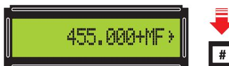
Figure 48: Tapez au clavier la valeur en Hz de la MF à ajouter et pressez la touche # de confirmation.
