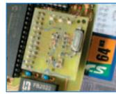
Permet de publier sur Internet ou sur réseau local LAN des données de température relevées par des sondes numériques, au moyen du protocole FTP. Ce montage sert de base pour développer les applications les plus diverses ; si l'on modifie adéquatement le programme résidant dans le PIC, il permet de publier n'importe quel type de fichier.
