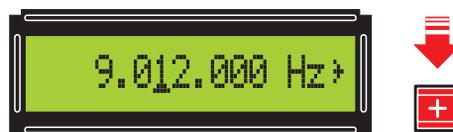
Figure 29: Parvenu à 9 009 000 Hz, si vous maintenez pressé le poussoir +, la fréquence continue d'augmenter. Si vous pressez le poussoir -, la fréquence diminue.
