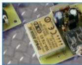
Avec deux modules UHF 863 à 865 MHz, un émetteur et un récepteur, nous acheminons le signal d'un microphone vers un ampli ou un mélangeur distant (jusqu'à 40 m). Ce système à deux unités TX et RX est idéal pour quelqu'un qui veut pouvoir se déplacer dans un studio, un gymnase ou sur une scène, un stade, etc., en parlant ou en chantant dans le micro. Bref, il s'agit d'un micro sans fil de grande qualité.
