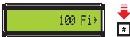
Figure 35: Commencez à taper au clavier 100, puis pressez la touche de confirmation # et le LCD visualise 100 Fi >.
