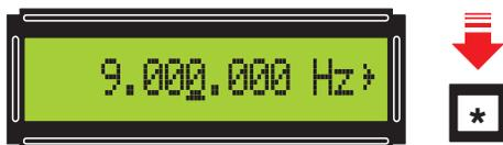
Figure 27: Pour modifier la fréquence de 9 000 000 Hz >, par exemple, de 1 000 Hz, en + ou en -, pressez la touche \* de façon à souligner le quatrième 0 à partir de la droite.
