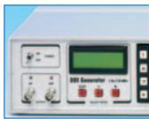
Ce générateur de signaux BF à VHF, réalisé à partir du fameux circuit intégré DDS AD9951, permet de prélever à sa sortie un signal sinusoïdal dont la fréquence peut varier d'un minimum de 1 Hz à un maximum de 120 MHz. Les DDS étant appelés à devenir les circuits intégrés incontournables de beaucoup d'appareils électroniques du futur, nous vous avons expliqué comment ils fonctionnent; dans cette seconde partie, nous allons réaliser le générateur et vous apprendre à vous en servir.
