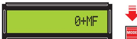
Figure 47: Pressez une seule fois le poussoir Mode et le LCD affiche 0+MF.
