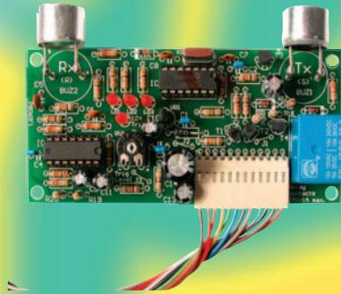
Cet appareil est en mesure de détecter la présence de personnes et d'objets jusqu'à une distance d'environ deux mètres (0,2 à 2,5 m). On peut s'en servir, sur un véhicule, comme radar de recul ou bien pour réaliser des appareils d'automatisme industriel, de petits robots, etc. Il dispose d'une barre de LED indiquant la distance de manière analogique (0 à 4 V), d'un buzzer d'alarme et d'un relais de sortie (250V / 1A). Alimentation 12 Vdc
