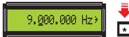
Figure 30: Pour modifier la fréquence de 100 000 Hz, pressez la touche \* de façon à souligner le sixième 0 à partir de la droite et pressez le poussoir +.
