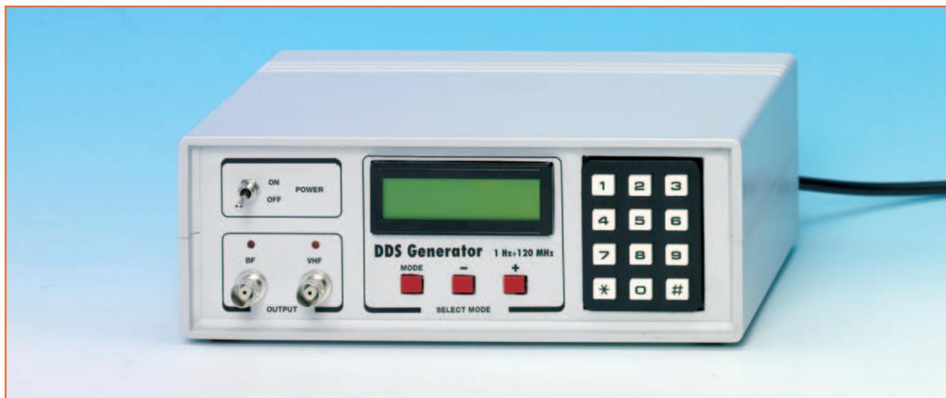
Comme annoncé le mois dernier, dans cette seconde partie, nous allons vous aider à construire ce générateur sinusoïdal BF-VHF, constitué de trois platines: EN1644 (le "module" DDS), EN1645 (la platine de base) et EN1646 (la platine d'alimentation).
