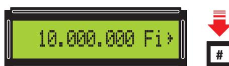
Figure 41: Pour modifier la fréquence, pressez trois fois le poussoir Mode de façon à faire apparaître 0 Fi (voir figure 34), puis tapez 10 000 000.
