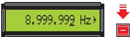
Figure 26: Pressez le poussoir - et la fréquence diminue de 1 Hz à chaque pression. Si vous maintenez pressé les poussoirs + ou -, la fréquence se modifie de manière progressive automatiquement.
