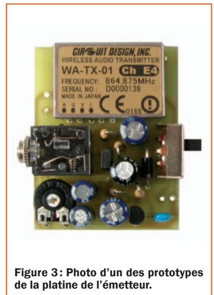
Figure 3: Photo d'un des prototypes de la platine de l'émetteur.
