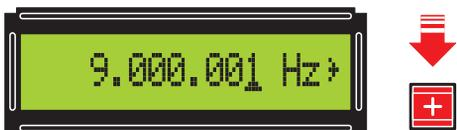
Figure 25: Pressez le poussoir + et la fréquence augmente de 1 Hz à chaque pression. Si vous utilisez les poussoirs +/- pour modifier la fréquence, il n'est plus nécessaire de presser la touche # de confirmation.
