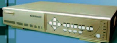
DVR à 4 canaux avec tiroir extractible pour disque dur. Format de compression MPEG4. Serveur Web pour visualisation à distance des images par Internet. Interface USB 2.0 pour le dépôt des prises de vues dans le PC. L'appareil dispose des fonctions duplex: enregistrement et live multi-écran simultanés, Motion Detector (détecteur de mouvement) et recherche rapide des enregistrements sur critères date/heure et déclenchement d'alarme.
