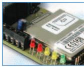
Permet de contrôler à distance, au moyen du réseau de téléphonie mobile GSM, deux charges de puissance en mode bistable ou en mode monostable. L'appareil dispose en outre de deux entrées pour l'envoi de messages d'alarme et d'état. Il peut servir aussi de
