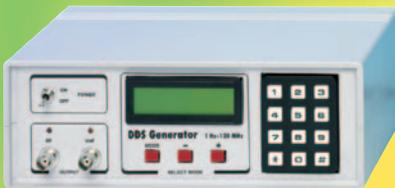
Ce générateur de signaux BF à VHF, réalisé à partir du fameux circuit intégré DDS AD9951, permet de prélever à sa sortie un signal sinusoïdal dont la fréquence peut varier d'un minimum de 1 Hz à un maximum de 120 MHz. Les DDS étant appe-
