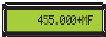
Figure 56: Ensuite, tapez au clavier la valeur en Hz de la MF qui apparaît avec l'indication +MF.
