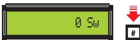
Figure 38: Pour lancer le balayage, pressez à nouveau la touche # et vous verrez apparaître sur le LCD l'indication 0 Sw.
