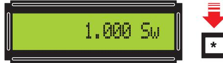
Figure 44: Pressez la touche \* et vous pourrez choisir la vitesse de balayage qui, dans ce second exemple, peut être de 1 000 Sw.
