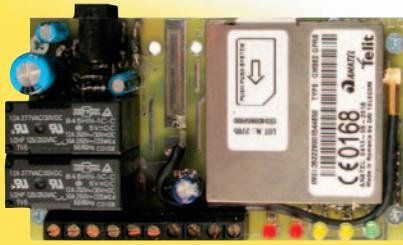
Cet appareil permet de contrôler à distance, au moyen du réseau de téléphonie mobile GSM, deux charges de puissance en mode bistable ou en mode monostable (230 Vac sous 10A). L'appareil dispose en outre de deux entrées (commandée) en tension : 3 à 30 V) pour l'envoi de messages d'alarme et d'état. Il peut
