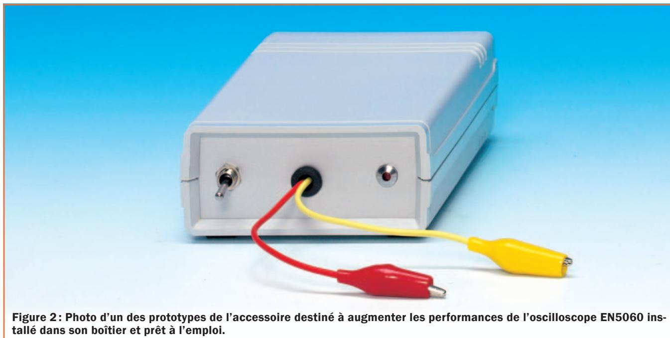
Figure 2: Photo d'un des prototypes de l'accessoire destiné à augmenter les performances de l'oscilloscope EN5060 installé dans son boîtier et prêt à l'emploi.
