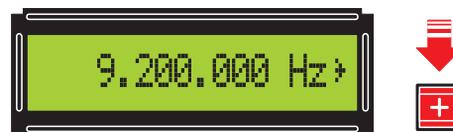
Figure 32: Quand vous pressez le poussoir + la fréquence augmente toujours au pas de 100 000 Hz, soit 100 kHz. Lorsque vous pressez le poussoir - la fréquence diminue toujours au pas de 100 000 Hz.
