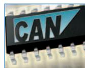
Conçu comme protocole de communication série pour faire communiquer entre eux tous les systèmes électroniques présents à bord d'une voiture, le bus CAN gagne aussi du terrain dans les domaines de l'automation industrielle (robotique) et de la domotique.
