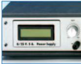
L'appareil que nous vous proposons ici est une alimentation de labo professionnelle des plus fiables : la tension de sortie, précise et stable peut être réglée à volonté et continûment de 0 V à 25 V en fonction de vos besoins ; la limitation de courant, elle aussi réglable en continu de 0 à 5 A protège l'appareil contre les courts-circuits éventuels.
