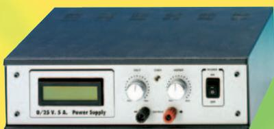
Ce répéteur VHF pour télécommande L'appareil que nous vous proposons ici est une alimentation de labo professionnelle des plus fiables : la tension de sortie, précise et stable peut être réglée à volonté et continûment de 0 V à 25 V en fonction de vos
