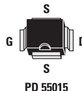
**Figure 1:** Aspect et brochage (vu de dessus: gâchette-source-source-drain) du MOSFET PD55015, seul semiconducteur de ce montage (à part le régulateur). Attention, le repère-détrompeur en U de ce circuit intégré indique l'une des deux broches de source (quand elle est en bas, comme le montre la figure, la gâchette est à gauche et le drain à droite).
