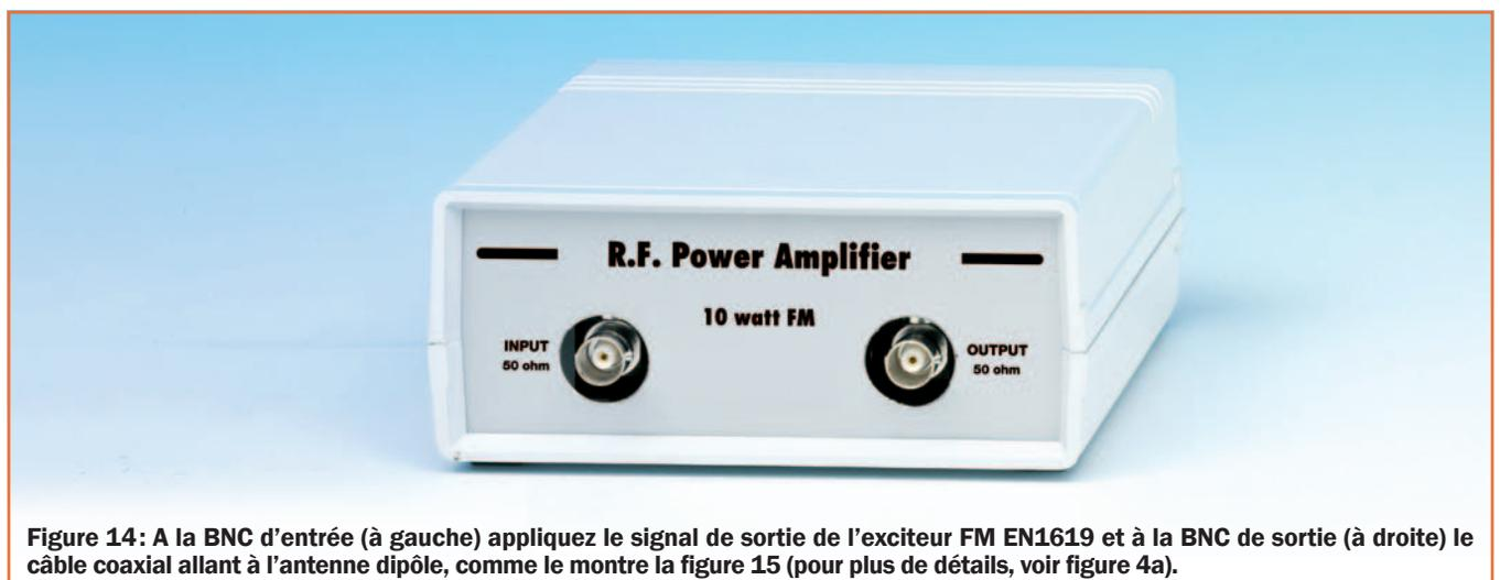
Figure 14: A la BNC d'entrée (à gauche) appliquez le signal de sortie de l'exciteur FM EN1619 et à la BNC de sortie (à droite) le câble coaxial allant à l'antenne dipôle, comme le montre la figure 15 (pour plus de détails, voir figure 4a).
