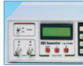
Ce générateur de signaux BF à VHF, réalisé à partir du fameux circuit intégré DDS AD9951, permet de prélever à sa sortie un signal sinusoïdal dont la fréquence peut varier d'un minimum de 1 Hz à un maximum de 120 MHz. Les DDS étant appelés à devenir les circuits intégrés incontournables de beaucoup d'appareils électroniques du futur, nous allons vous expliquer, dans cette première partie, comment ils fonctionnent (vocation didactique oblige : c'est la rentrée ou pas ?).
