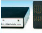
Avec un boîtier de télécommande IR nous allons pouvoir allumer/éteindre à distance deux appareils domestiques au choix (téléviseur, home-cinéma, chaîne Hi-Fi, etc.) et disposer en plus de trois canaux pour régler continûment la luminosité de trois ampoules à filament.
