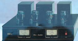
Les transformateurs de sortie sont à carcasses lamellées en acier doux à grains orientés et leur blindage est assuré par un écran de cuivre. L'ensemble est immobilisé dans une résine et moulé dans un boîtier métallique externe.
