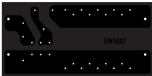
**Figure 18b: Dessin, à l'échelle 1, du circuit imprimé de la platine de la sonde de charge EN1637, côté soudures.**
