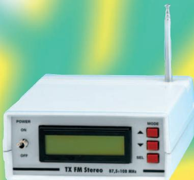
Si vous avez besoin d'un exciteur FM pour construire un émetteur complet de radiodiffusion 88-108 MHz (associé à un amplificateur final HF de puissance) ou d'un générateur de labo pour cette gamme d'ondes (vous permettant de régler les récepteurs FM) ou bien simplement d'un microphone HF de qualité Hi-Fi mono ou stéréo, ce kit va vous réjouir ! Cet émetteur FM stéréo à synthèse de fréquence et PLL ne comporte pas moins
