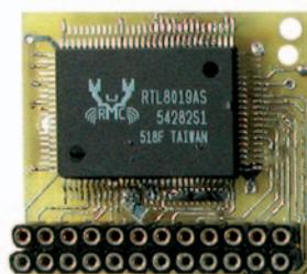
Figure 5a: Photo d'un des prototypes du module Ethernet ET616, côté puce RTL8019 et connecteur.
