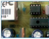
Nous mettons à profit les LAN désormais présents dans les théâtres et les discothèques pour transférer les flux de données standard DMX512 de la régie aux portiques où sont fixés les projecteurs et autres appareils de puissance. Le circuit peut fonctionner comme convertisseur DMX512/Ethernet et comme décodeur Ethernet/DMX512.
