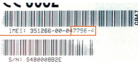
Pour habiliter un téléphone mobile à l'activation du serveur Web et à la réception du SMS avec les données de l'IP, il est nécessaire d'envoyer avec le même mobile un SMS contenant le code IMEI du module GPRS (donnée présente sur l'étiquette du dispositif).
