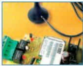
Appelé par un téléphone mobile, ce serveur se connecte au réseau GPRS pour nous permettre de consulter les données lues localement par deux sondes et accède à Internet par un navigateur. L'adresse IP à spécifier dans la barre des adresses pour accéder à la page web du dispositif est l'IP publique que le modem a obtenu durant la connexion et qu'il nous a communiquée par SMS.
