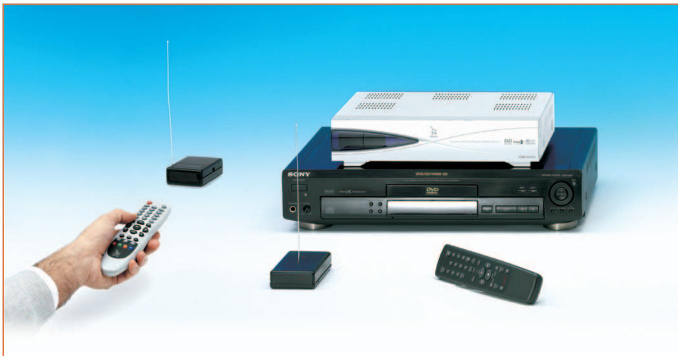
**Figure 1: Le répéteur pour télécommande se compose d'un module émetteur TX qui reçoit le signal IR de la télécommande et le transforme en un signal radio VHF et d'un module récepteur RX qui le reconvertit en un signal IR capable de commander n'importe quel appareil doté, bien sûr, d'un système de télécommande infra-rouge.**
