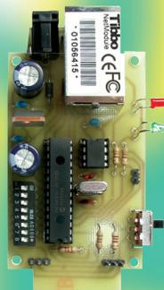
Nous mettons à profit les LAN désormais présents dans les théâtres et les discothèques pour transférer les flux de données standard DMX512 de la régie aux portiques où sont fixés les projecteurs et autres appareils de puissance. Le circuit peut fonctionner comme convertisseur DMX512/Ethernet et comme décodeur Ethernet/DMX512. Alimentation 12 Vdc. Dim : 10 cm x 5 cm. Le kit est livré avec le module Tibbo EM200, et2 prises DMX.
