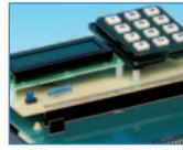
Cette nouvelle platine d'expérimentation est un outil (ludique !) indispensable pour quiconque souhaite se perfectionner dans la mise en œuvre des microcontrôleurs PIC. Elle permet d'utiliser un clavier numérique (comme on en trouve sur les téléphones) et un afficheur LCD (tout aussi numérique) - composant désormais incontournable au labo d'électronique pour effectuer toutes les mesures et tous les contrôles voulus.
