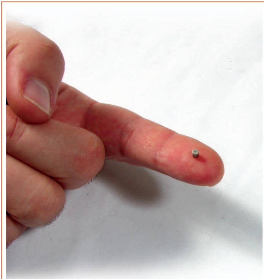
Figure 3: Photo de la minuscule capsule microphonique Knowles utilisée dans ce circuit.
