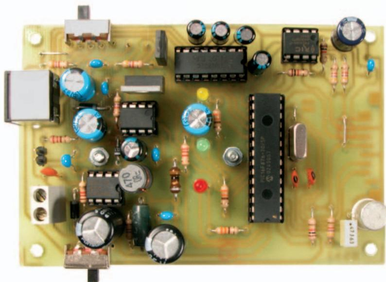
Figure 9a: Photo d'un des prototypes de l'enregistreur GPS sur SD-Card, côté composants.
