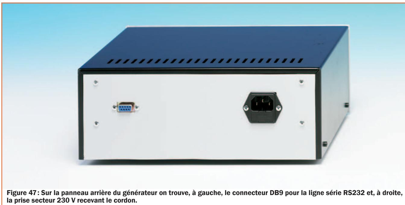
**Figure 47 :** Sur la panneau arrière du générateur on trouve, à gauche, le connecteur DB9 pour la ligne série RS232 et, à droite, la prise secteur 230 V recevant le cordon.
