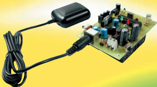
Installé à bord d'un véhicule routier ou d'un bateau, cet appareil « embarqué » enregistre sur carte SD le parcours effectué et permet de le visualiser, à l'aide d'un programme de cartographie GPS, dans les moindres détails. La carte mémoire SD de 64 Mo permet de mémoriser environ 1 700 000 positions, ce qui permet d'enregistrer pendant 20 jours avec une précision d'un enregistrement par seconde. Alimentation 12 à 24 VDC
