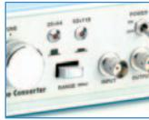
Si vous possédez un oscilloscope ordinaire avec bande passante de 20 MHz, il ne pourra jamais visualiser des signaux de fréquences supérieures. Réalisez cet accessoire simple et économique (le convertisseur EN1633) et vous pourrez visualiser n'importe quel signal HF jusqu'à environ 100 MHz et même au-delà.
