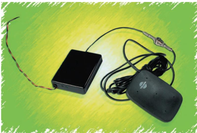
Figure 4: Photo d'ensemble de notre système d'écoute discrète (ou dissimulée) d'un environnement à surveiller. Tous les composants trouvent place dans un boîtier de très petites dimensions; les seuls éléments externes sont l'antenne GSM et les deux microphones miniatures.
