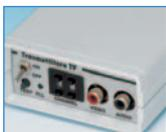
Les étonnantes prestations fournies par le modulateur audio et vidéo en CMS utilisé par le Générateur de mire EN1630 (voir les numéros 82 et 83 d'ELM) nous ont encouragés à concevoir et à réaliser un émetteur TV (audio et vidéo). Cet émetteur fonctionne dans la gamme de fréquences UHF mais ne nécessite ni self ni condensateur ajustable d'accord.
