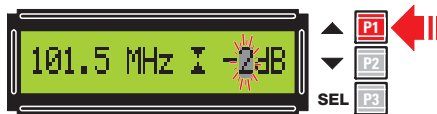
Figure 30: Si vous continuez à presser P1, vous obtiendrez une atténuation du signal de -2 dB.
