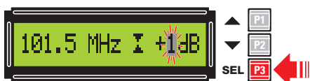
Figure 23: Si on presse le poussoir SEL (en bas), le nombre situé à gauche de l'indication dB clignote.
