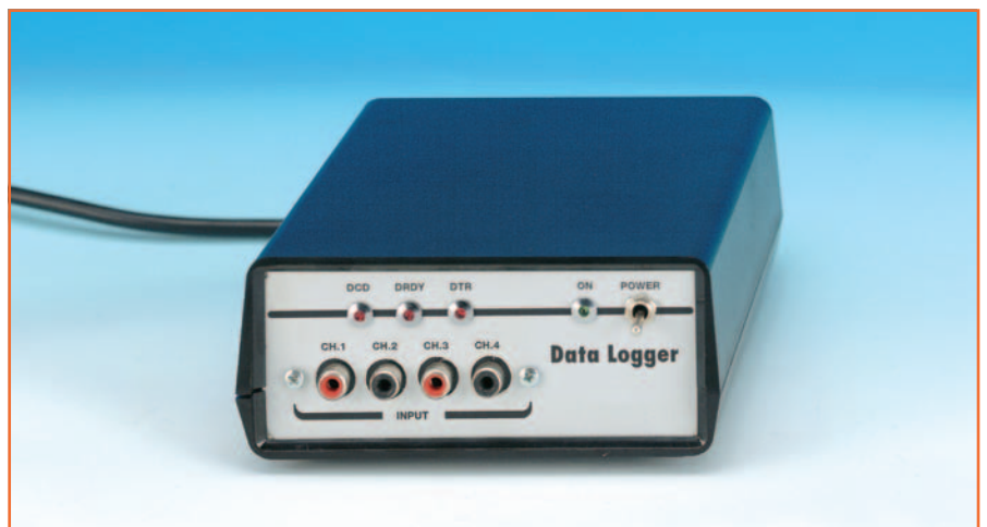
Figure 10: L'enregistreur de données monté dans son boîtier, couvercle refermé et prêt à être relié au PC et à ses différents capteurs (quatre entrées CH1 à CH4). Les LED DCD-DRDY-DTR visualisent à chaque instant l'état de fonctionnement du convertisseur A / N.
