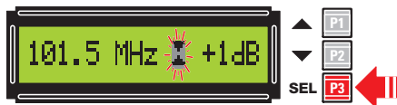
Figure 24: Pressez à nouveau ce poussoir SEL et vous verrez le symbole des deux flèches clignoter.
