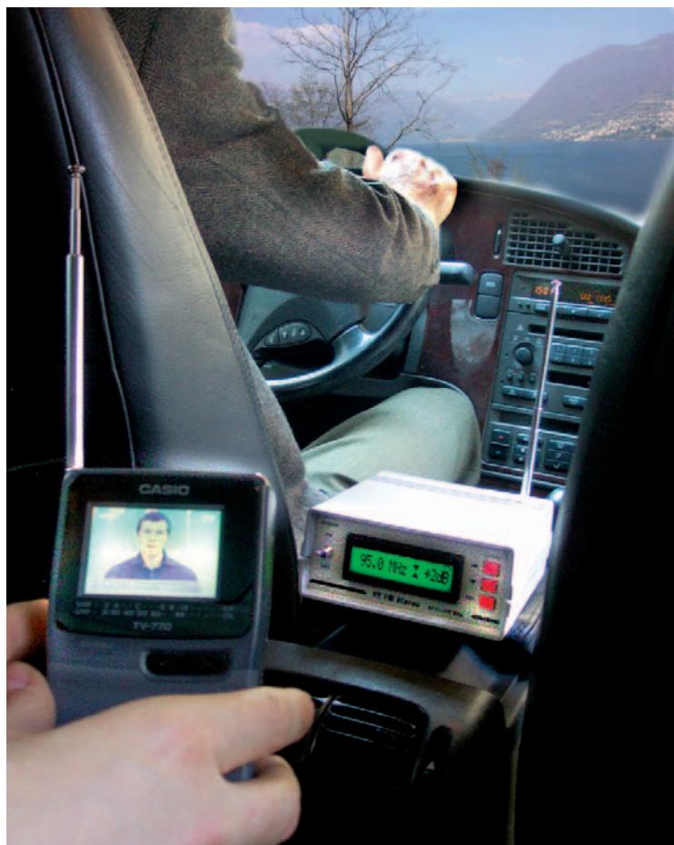
Figure 4: Si vous reliez la prise audio d'un petit téléviseur portable au générateur FM, vous pouvez vous servir de l'installation stéréo de votre voiture ou de votre camping car pour jouir d'une écoute amplifiée du son (et tout cela sans fil, bien sûr).
