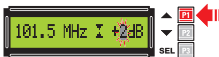
Figure 27: Si vous voulez augmenter le gain du signal BF, il suffit de presser le poussoir P1.
