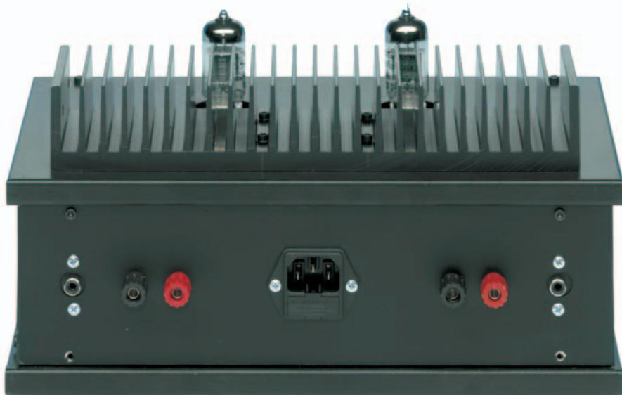
Figure 5: Photo d'un des prototypes de l'amplificateur dont on voit cette fois le panneau arrière avec son embase femelle d'entrée du secteur 230 V et pour chaque canal (droit et gauche) les deux bornes de sortie vers les enceintes et la RCA "cinch" d'entrée du signal BF.
