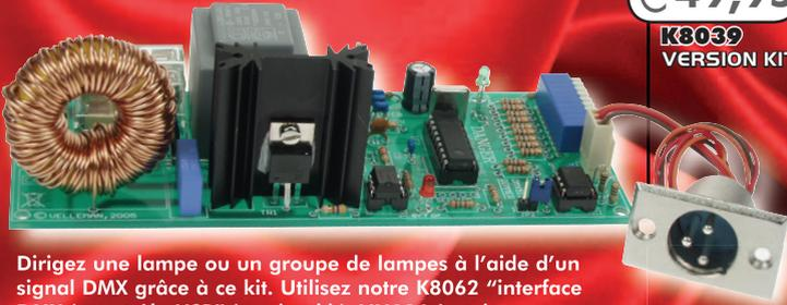
Dirigez une lampe ou un groupe de lampes à l'aide d'un signal DMX grâce à ce kit. Utilisez notre K8062 "interface DMX à contrôle USB" (version kit), VM116 (version assemblée) ou n'importe quel autre panneau de contrôle à contrôleur DMX-512.
