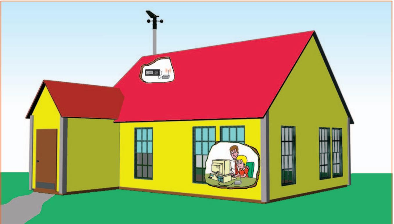
Figure 1: Si vous reliez votre station météorologique EN100WS à l'émetteur du radiomodem et le récepteur à votre ordinateur, vous pourrez acquérir directement et sans fil les données provenant de la centrale météo distante.
