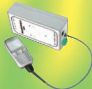
Système de contrôle à distance capable de gérer, par SMS, deux sorties à relais et de vérifier l'état logique des entrées numériques, lesquelles peuvent être configurées comme entrées d'alarme. Les trois lignes I2C-bus dont est doté l'appareil lui permettent de gérer en cascade jusqu'à huit extensions en entrée et en sortie et ce jusqu'à un total de 64 E / S.
