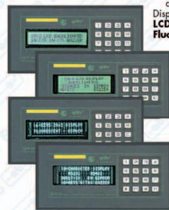
dans les formats **2x20** ou **4x20** caractères; clavier à 16 touches; communication en RS 232, RS 422, RS 485, ou Current Loop; Buzzer; E<sup>2</sup> capable de contenir jusqu'à 100 messages; 4 entrées optocouplées, que l'on peut acquérir à travers la ligne série et susceptibles de représenter
