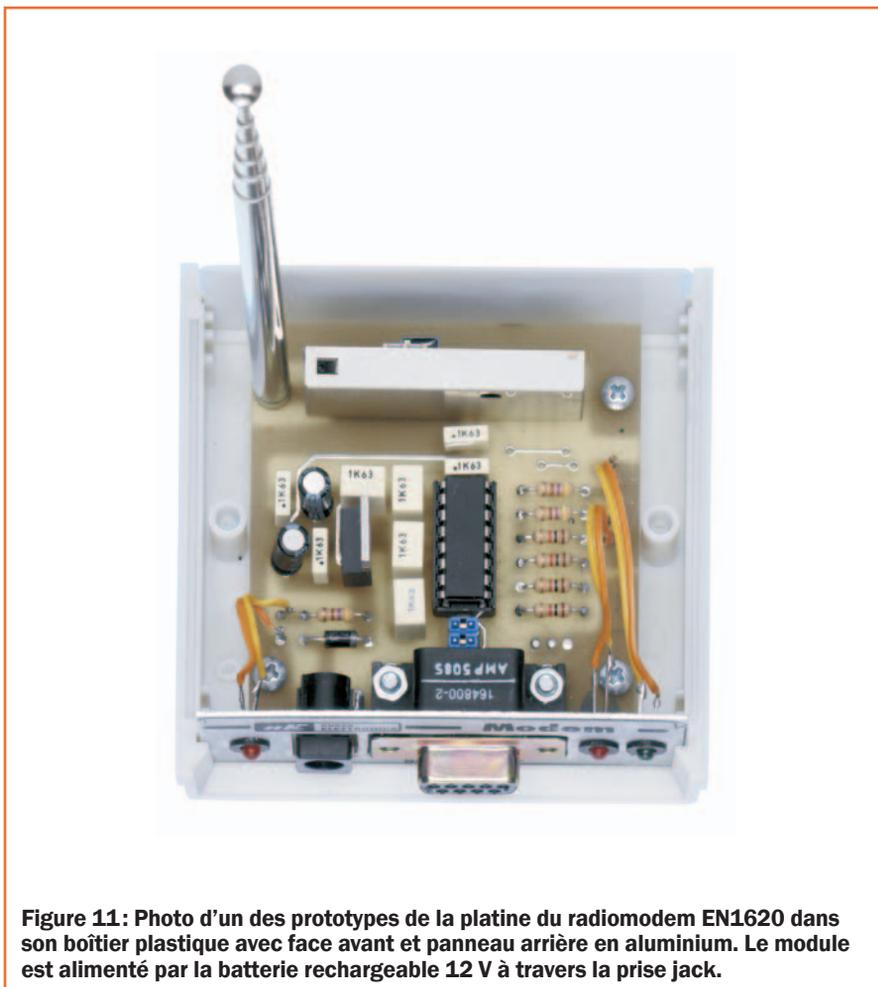
Figure 11: Photo d'un des prototypes de la platine du radiomodem EN1620 dans son boîtier plastique avec face avant et panneau arrière en aluminium. Le module est alimenté par la batterie rechargeable 12 V à travers la prise jack.
