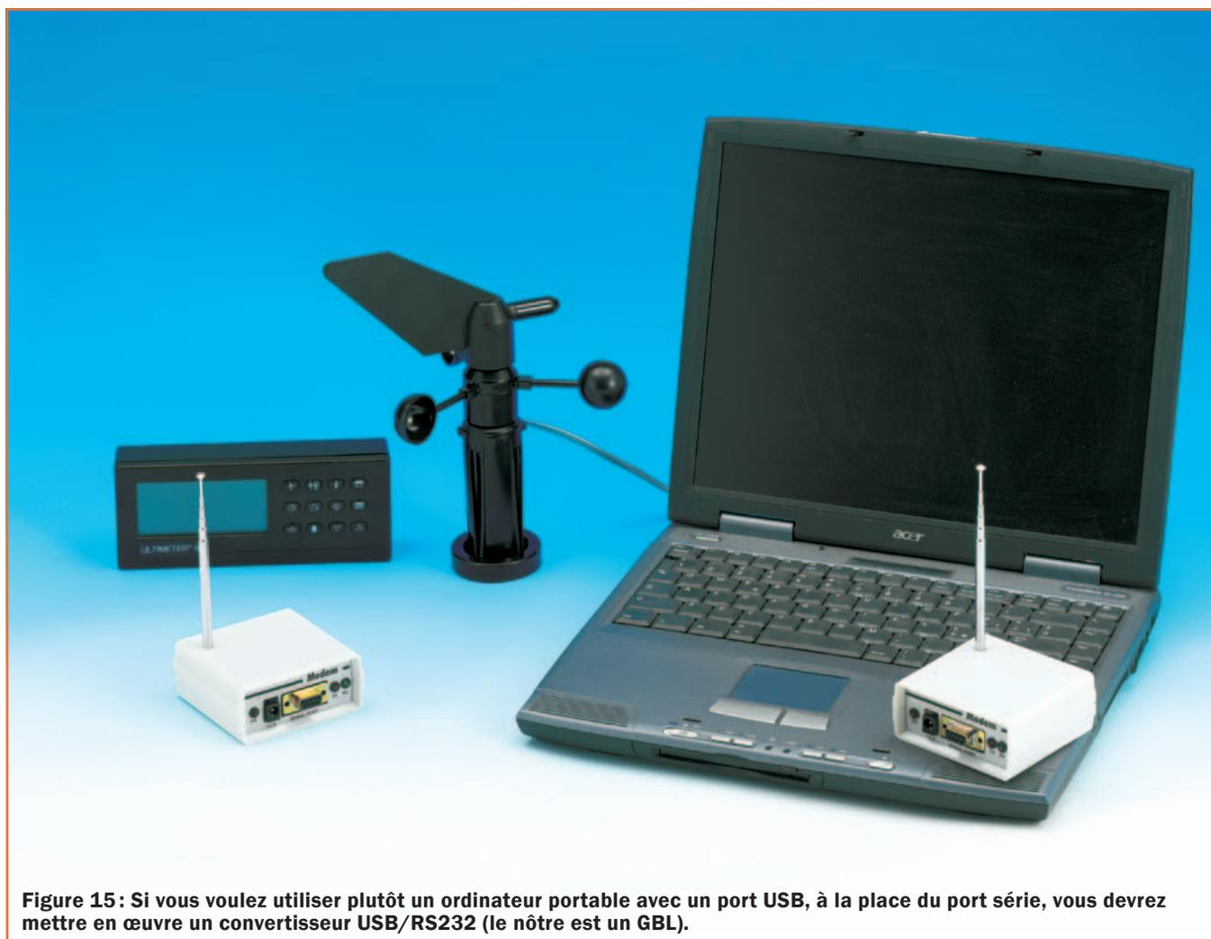
**Figure 15:** Si vous voulez utiliser plutôt un ordinateur portable avec un port USB, à la place du port série, vous devrez mettre en œuvre un convertisseur USB/RS232 (le nôtre est un GBL).
