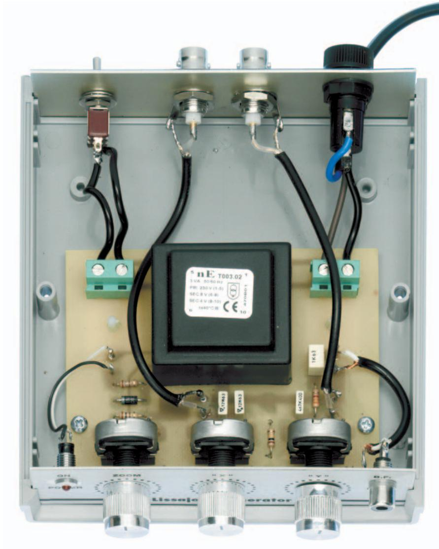
Figure 3c: Photo d'un des prototypes du circuit servant à visualiser à l'écran de tout oscilloscope les figures de Lissajous et montage dans le boîtier plastique avec face avant et panneau arrière en aluminium anodisé.
