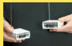
Avec ce modem intelligent sur 433,1 MHz, vous pourrez transmettre et recevoir des données par radio (et par conséquent éliminer le câble de connexion entre un périphérique et l'ordinateur). Vous pourrez ainsi rendre «wireless» (sans fil) votre station météo EN100WS, mais aussi bien d'autres appareils. Deux modem EN1620 sont nécessaires pour réaliser la liaison sans fil.
