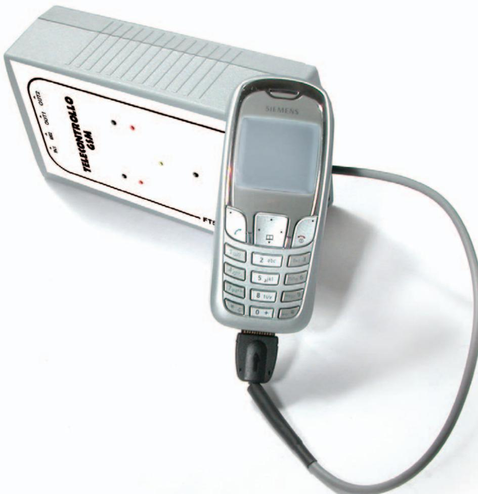
**Figure 6: Photo d'un des prototypes de l'appareil de contrôle à distance par GSM couplé au téléphone mobile SIEMENS A65 au moyen du câble spécifique (ce téléphone se trouve facilement à bas prix).**
