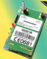
Grâce au minuscule module GPS / GSM Wavecom nous allons réaliser un localiseur à distance alimenté par une batterie rechargeable ; il est tellement minuscule (58 x 32 x 6 mm) qu'on pourra le mettre dans la poche et pas seulement à bord d'un véhicule (pour ce dernier cas cependant nous vous proposons un adaptateur d'alimentation à découpage ET601). Avec Internet et la cartographie disponible, une utilisation en réseau permet de visualiser la position du localiseur sur une carte.
