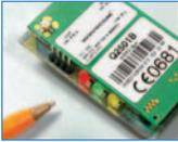
Grâce au minuscule module GPS / GSM Wavecom nous avons réalisé un localiseur à distance alimenté par une batterie rechargeable; il est tellement petit qu'on peut le mettre dans la poche et pas seulement à bord d'un véhicule. Avec Internet et la cartographie disponible, une utilisation en réseau permet de visualiser la position du localiseur sur une carte. Après avoir (première partie) analysé et réalisé le matériel, nous nous penchons dans la seconde sur le logiciel.
