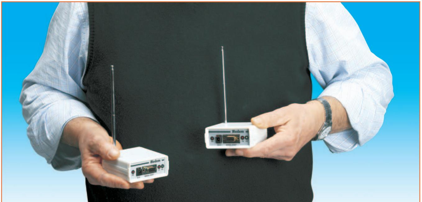
Ces deux radiomodems (ces deux exemplaires du même appareil en fait) vont vous permettre de relier la centrale de votre station météo EN100WS à votre ordinateur en mode "wireless" (aux débuts de la radio, on disait "sans fil" et on appelait les passionnés des "sans-filistes"): plus besoin de câble entre les deux, ce qui est plutôt commode! Bien sûr, l'utilité de cette liaison HF ne se limite pas à la station météo, même si nous l'avons conçue primitivement pour cela.
