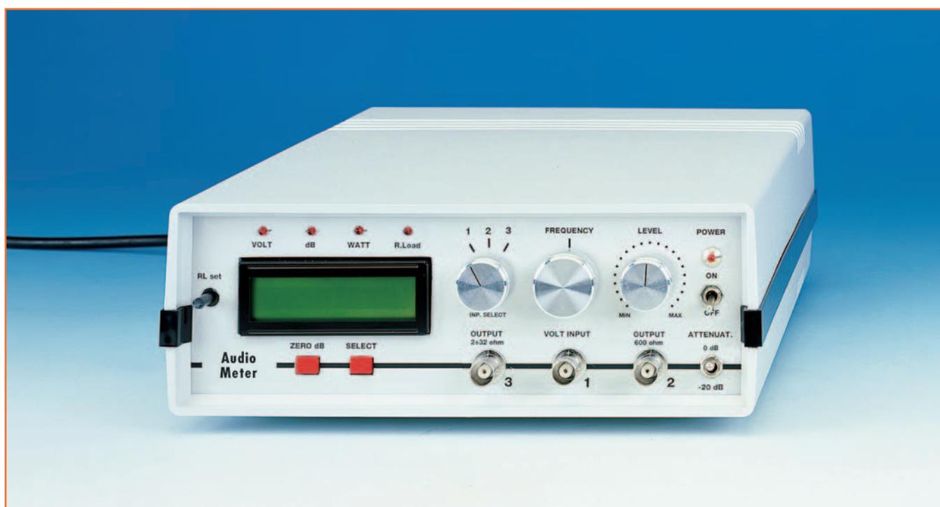
Quelqu'un qui construit des filtres Cross-Over pour enceintes acoustiques ou des préamplificateurs et des étages finaux BF, est désireux, dès le montage terminé, d'en vérifier les caractéristiques: il veut savoir, dans le cas des Cross-Over, leur fréquence de coupure et leur valeur d'atténuation exprimée en dB par octave; dans celui des préamplis BF, la valeur des fréquences minimale et maximale qu'ils peuvent amplifier et de combien peut les atténuer ou les accentuer leur circuit de contrôle de
