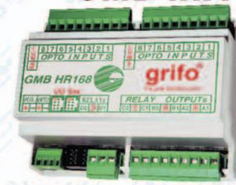
La **GMB HR168** est fondamentalement un module à Barre DIN en mesure d'accueillir un CPU **grifo® Mini-Module** du type **GMM** à 40 broches. Elle dispose de 16 entrées Galvaniquement isolées pour les signaux **NPN** ou **PNP**; 8 Relais de 5 A; ligne RS 232, RS 422, RS 485 ou Boucle de Courant; diverses lignes TTL et un alimentateur stabilisé.
