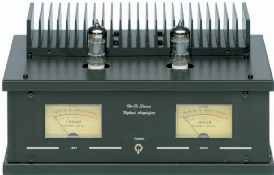
Figure 4: Photo d'un des prototypes de l'amplificateur dont on voit la face avant avec ses deux Vu-mètres et le dessus avec les deux lampes et le dissipateur des MOSFET.
