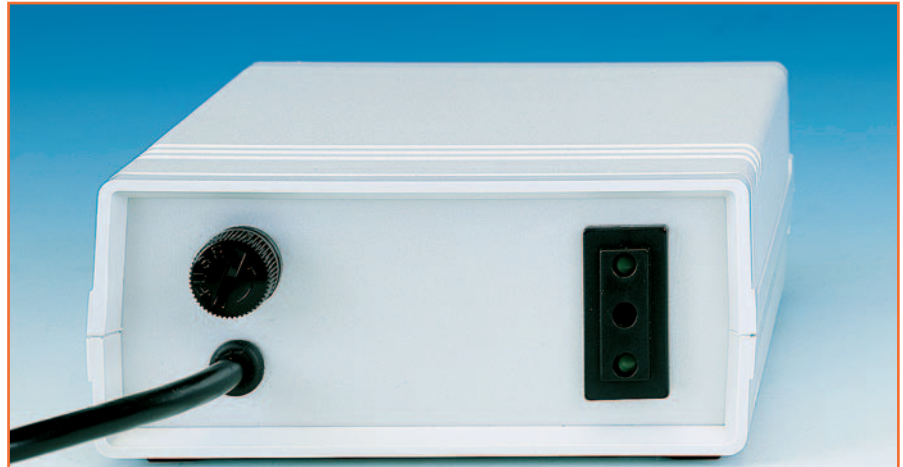
Figure 4: Photo d'un des prototypes de l'auto-switch installé dans son boîtier plastique et vu du côté du panneau arrière d'où sort le cordon secteur 230 V et où sont montés le porte-fusible et la prise à laquelle raccorder l'appareil à protéger.
