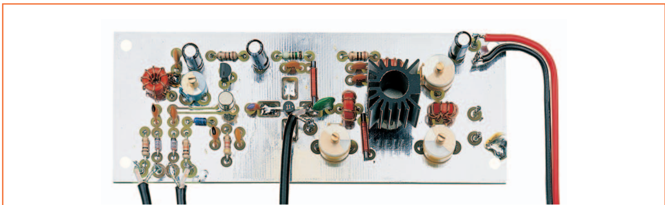
Figure 13: Photo d'un des prototypes de la platine du VCO EN1603. Pour relier cet étage au PLL / modulateur EN1604, utilisez du câble coaxial RG174 et n'oubliez pas d'en souder les tresses de blindage à la masse des deux côtés.
