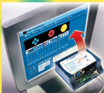
Ce système de régie lumière au protocole DMX512 comporte une interface USB et bien sûr un programme de gestion. Toutes les ressources nécessaires (DLL et routines de test) sont fournies afin que vous puissiez réaliser des programmes personnalisés en Delphi, Visual Basic.NET et C++ Builder.
