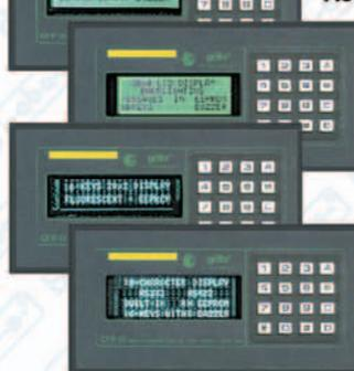
dans les formats 2x20 ou 4x20 caractères; clavier à 16 touches; communication en RS 232, RS 422, RS 485, ou Current Loop; Buzzer; E<sup>2</sup> capable de contenir jusqu'à 100 messages; 4 entrées optocouplées, que l'on peut acquérir à travers la ligne série et susceptibles de représenter de façon autonome 16 messages différents. même temps jusqu'à 8 dispositifs.
