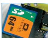
Nous avons utilisé une carte SD pour réaliser une unité de mémoire économique gérable par protocole sériel. Ce montage peut être couplé à un PC ou bien utilisé avec des appareils «stand alone» (fonctionnant tout seuls sans ordinateur) nécessitant une capacité importante ; le programme complet des tests pour PC est disponible.
