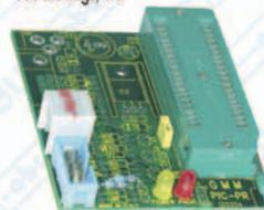
connecteur D9 pour la connexion à la AVR **ISP**; connecteur RJ12 pour MPLAB; connecteur à 10 broches pour la connexion au Programmeur MP PIK+; connecteur pour la section alimentateur; 2 LEDs; ect..
