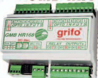
La **GMB HR168** est fondamentalement un module à Barre DIN en mesure d'accueillir une CPU **grifo<sup>®</sup> Mini-Module** de type **GMM à 40 broches**. Elle dispose de 16 entrées Galvaniquement isolées pour les signaux **NPN** ou **PNP**; 8 Relais de 5
