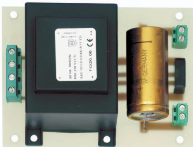
**Figure 6:** Photo d'un des prototypes de la platine de l'alimentation EN1617. On le voit, c'est une alimentation non stabilisée simple asymétrique fournissant environ 32 Vcc pour un courant de 0,9 A (bien sûr, elle peut également être utilisée pour alimenter d'autres montages réclamant la même tension pour un courant égal ou inférieur).
