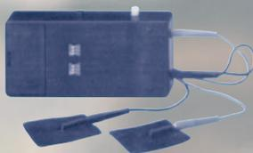
Cet appareil permet de soulager des douleurs tels l'**arthrose** et les **céphalées**. De faible encombrement, ce kit est alimenté par piles incorporées de 9 volts. Tension électrode maximum : -30 V - +100 V. Courant électrode maximum : 10 mA. Fréquences : 2 à 130 Hz.
