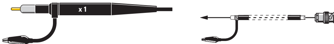
Figure 5: Si votre sonde ne comporte que l'indication x1, le signal acheminé à l'entrée de l'oscilloscope a la même amplitude que celui présent sur la pointe de touche.
