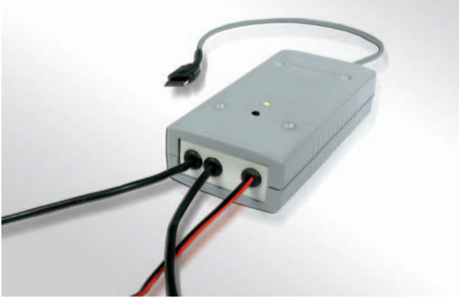
Figure 5: Montage dans le boîtier de l'alarme vidéo à distance, boîtier fermé (appareil prêt à fonctionner).
