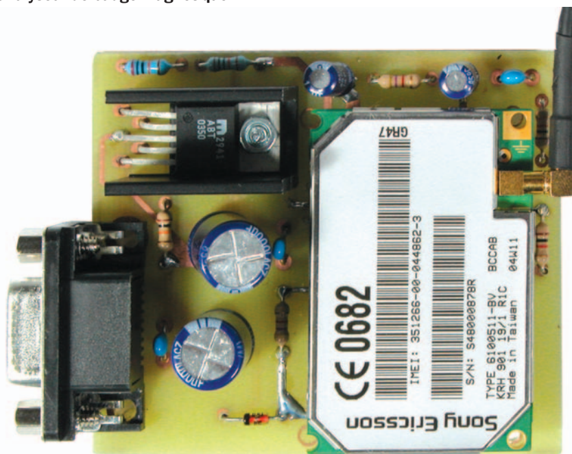
Figure 3: Photo d'un des prototypes de la platine de la liaison GSM du lecteur / analyseur de badge magnétique.
