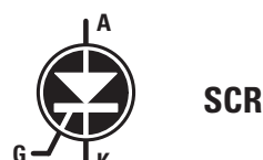
Figure 2: Représentation schématique du thyristor (SCR en Anglais). La gâchette est cette fois du côté de la cathode.
