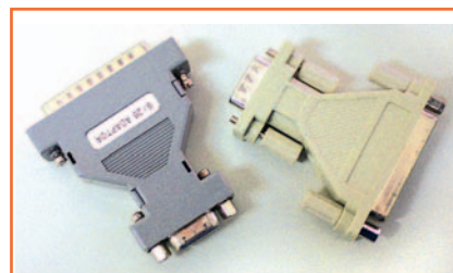
Figure 2: Adaptateurs de connecteurs 25 pôles/DB9 que l'on trouve même en grande distribution non spécialisée.
