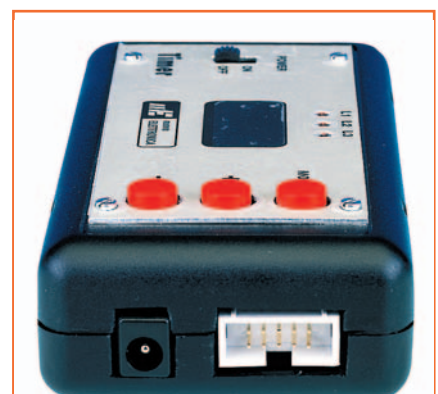
Figure 13: Les connecteurs visibles sur la photo servent à reprogrammer le microcontrôleur. La prise de gauche (5,6 V) est à relier à l'alimentation EN1203 et le connecteur de droite (dix pôles) au programmeur EN1546 (voir figure14).
