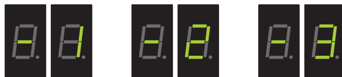
Figure 12: Quand la durée réglée est écoulée, le signe - suivi du numéro du "timer" clignote.
