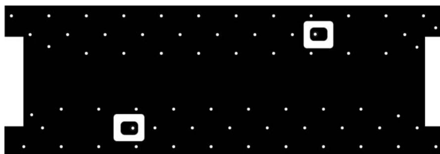
Figure 2b-2 : Dessin, à l'échelle 1, du circuit imprimé double face à trous métallisés du ROSmètre, côté plan de masse.
