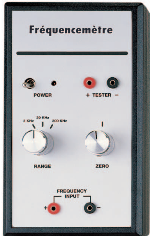
Figure 571 : A droite, voici comment se présente la face avant du boîtier. Les 4 douilles sont reliées au circuit imprimé au moyen de morceaux de fil de cuivre souple isolé plastique (figure 566a).
