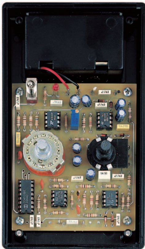
Figure 570 : A gauche, le circuit imprimé fixé dans son boîtier à l'aide de 4 vis auto-filetantes. Dans le logement situé en haut du boîtier sera placée la pile 9 V.
