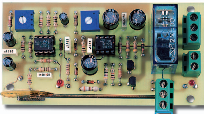
Figure 3: Photo d'un des prototypes du détecteur de vibrations. Après avoir soudé le petit disque dans la fente du circuit imprimé, il faut aussi fixer à l'extrémité du fil un contrepois et pour cela nous nous servons d'un bornier à trois pôles.
