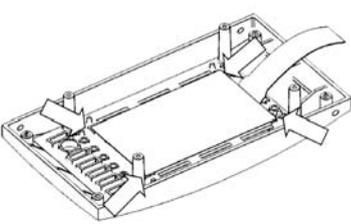
Troisième phase : positionnez le capteur à écran tactile à l'intérieur de la face avant du clavier comme le montre la figure (côté sensible vers l'extérieur).
