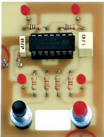
Figure 556 : Photo d'un de nos prototypes de FLIP-FLOP. Le circuit est celui de la figure 553. Avant de souder sur le circuit imprimé les pattes des diodes LED, contrôlez que leurs têtes sortent légèrement des quatre trous de la face avant du boîtier plastique. Quand vous insérez dans son support le circuit imprimé 4011, vérifiez que son repère-détrompeur est bien orienté vers C1 (figure 555a).
