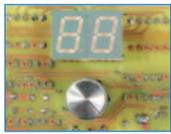
L'appareil utilise deux capteurs pour détecter les conditions atmosphériques (pluie et vent) et un microcontrôleur pour la gestion des données, avec possibilité d'activer une sortie à relais au cas où le seuil d'alarme prédéfini serait dépassé. Il est idéal pour contrôler la fermeture de sécurité (en cas de pluie ou vent fort) des stores, parasols et autres Velux motorisés.
