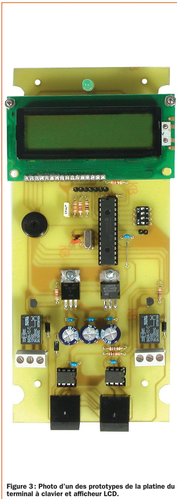
Figure 3: Photo d'un des prototypes de la platine du terminal à clavier et afficheur LCD.
