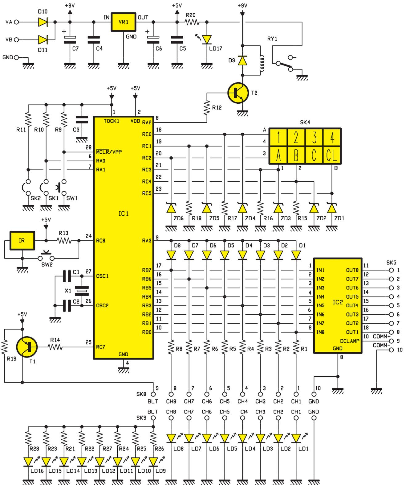
Figure 1: Schéma électrique du clavier à écran tactile.
