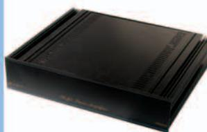
Cet amplificateur BF peut fonctionner en mono (ponté) ou en stéréo. Il fournit une puissance maximale musicale / RMS de 300 / 155 W par canal, soit au total 600 / 300 W. Il est protégé thermiquement. Un circuit spécial règle, en permanence, sur la classe A l'étage de sortie et ce, sans perte inutile de puissance. Les haut-parleurs sont protégés contre le «bump» de mise sous tension et les composants continus pouvant se présenter à leur entrée.
