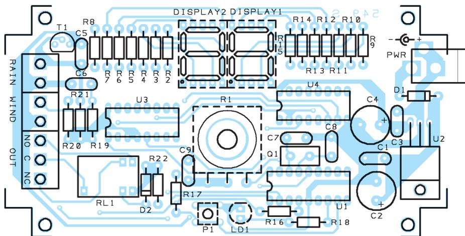
Figure 2a: Schéma d'implantation des composants du contrôleur "pluie et vent" à affichage numérique.
