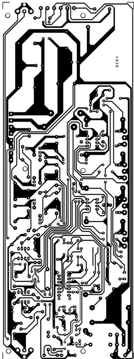
Avec un photocopieur, vous devez l'agrandir de 141 % (A4 > A3). Le circuit imprimé est à l'échelle 1 sur le site de la revue.
