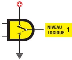
Figure 530 : Quand une broche est au niveau logique 1, elle peut être considérée reliée internement à la tension positive d'alimentation.
