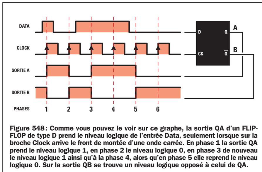
Figure 548: Comme vous pouvez le voir sur ce graphe, la sortie QA d'un FLIP-FLOP de type D prend le niveau logique de l'entrée Data, seulement lorsque sur la broche Clock arrive le front de montée d'une onde carrée. En phase 1 la sortie QA prend le niveau logique 1, en phase 2 le niveau logique 0, en phase 3 de nouveau le niveau logique 1 ainsi qu'à la phase 4, alors qu'en phase 5 elle reprend le niveau logique 0. Sur la sortie QB se trouve un niveau logique opposé à celui de QA.
