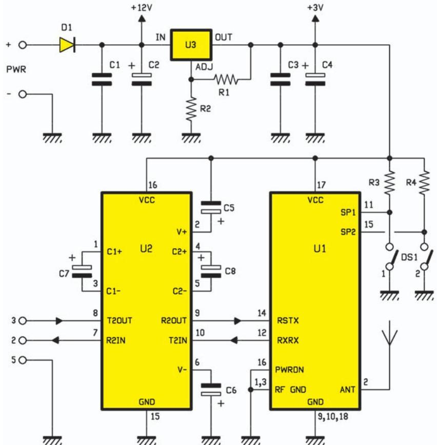
Le dispositif relié au PC (que nous appelons improprement émetteur : en réalité il peut émettre et recevoir), utilise un module AUREL XTR903 dans la version 868 MHz et un convertisseur MAX232 capable de fonctionner avec des signaux de niveaux compris entre 0 et 3 V. Le dip-switch à deux micro-interrupteurs permet de sélectionner la vitesse de transmission entre 9 600 et 38 400 bits/s.
