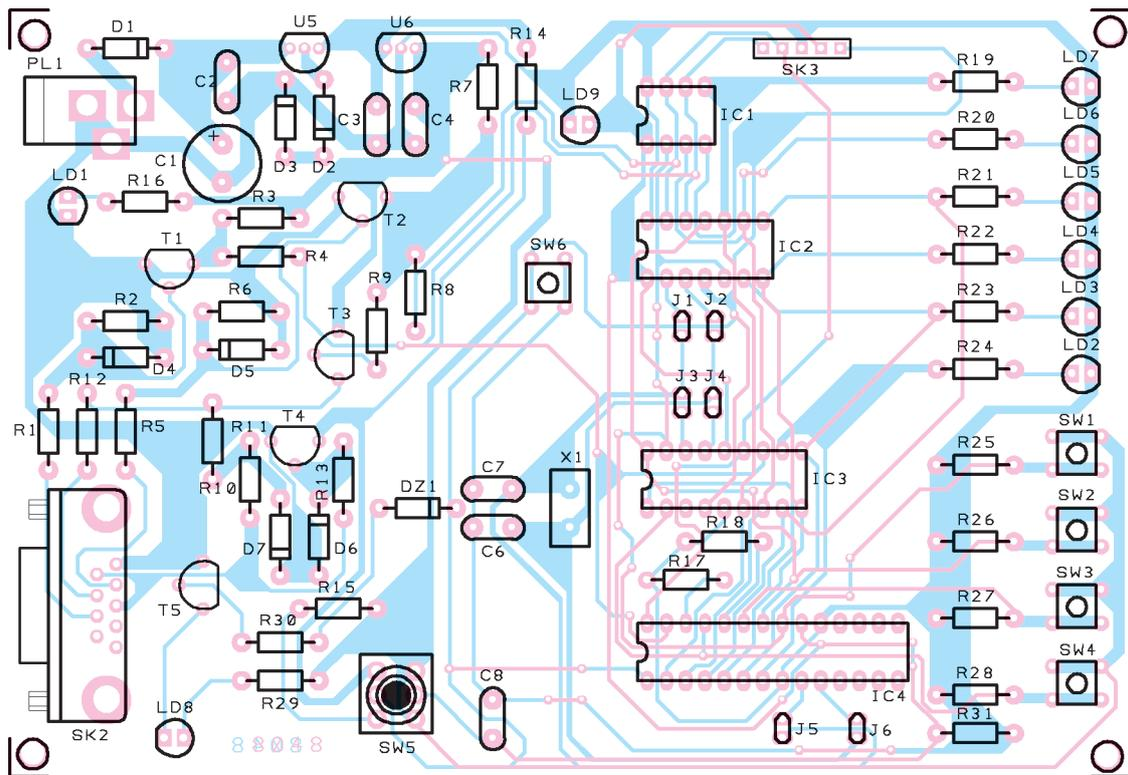
**Figure 2a: Schéma d'implantation des composants du programmeur de PIC.**
