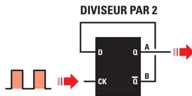
Figure 550 : En reliant l'entrée D de ce FLIP-FLOP à la sortie QB, on prélève sur la broche QA la fréquence appliquée sur la broche CK divisée par 2. Ce qui fait que, en appliquant une fréquence de 100 kHz sur l'entrée CK, nous préleverons sur la sortie QA 50 kHz.
