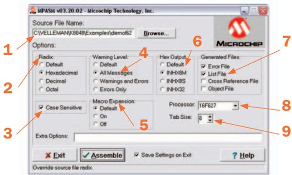
La procédure de programmation d'un microcontrôleur commence toujours par l'écriture du programme qui peut être faite au moyen d'un "word processor" ASCII de n'importe quel type (par exemple Notepad, compris dans le pack standard de Microsoft Windows, voir a). Il est possible aussi d'utiliser le pack de développement MPLAB Microchip, pouvant être chargé sur le site [www.microchip.com](http://www.microchip.com).
