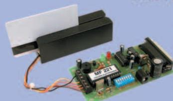
Nouveau système modulaire de lecteur de carte avec sortie série : étudié pour fonctionner avec des lecteurs standards ISO7811. Vous pouvez connecter plusieurs systèmes sur la même RS232 : un commutateur électronique et une ligne de contrôle permettent d'autoriser la communication entre le PC et la carte active, bloquant les autres.
