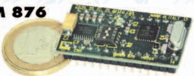
grifo<sup>®</sup> Mini-Module à 28 broches basée sur la CPU Microchip PIC 16F876A avec 14,3K FLASH; 368 Bytes RAM; 256 Bytes EEPROM; 2 Temporisateurs Compteurs et 2 sections de Temporisateur Compteur à haute fonctionnalité (PWM, comparaison); 2 Comparateurs; 5 A/D; I<sup>2</sup>C BUS; Master/Slave SPI; 22 lignes d'E/S TTL; RS 232 ou TTL; 1 LED d'état; etc.
