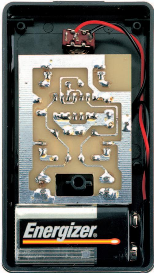
**Figure 557 :** Photo du circuit imprimé fixé à l'intérieur du boîtier. Dans l'espace demeuré libre dans la partie inférieure de ce dernier, on placera la pile 6F22 de 9 V. Le circuit imprimé est maintenu en place par les écrous des poussoirs P1-P2.
