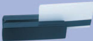
Le dispositif contient une tête magnétique et un circuit amplificateur approprié capable de lire les données présentes sur la piste ISO2 de la carte et de les convertir en impulsions digitales. Standard de lecture ISO 7811 : piste de travail (ABA) : méthode de lecture F2F (FM) : alimentation 5 volts DC : courant
