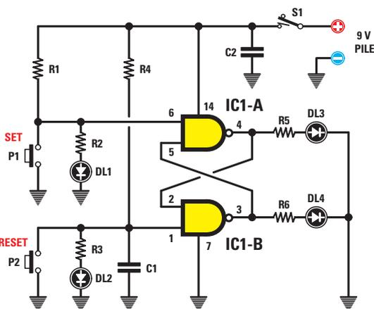
Figure 553 : Schéma électrique du FLIP-FLOP utilisé en platine d'expérimentation. Les diodes LED connectées aux entrées ou aux sorties de ces NAND s'allument quand le niveau logique 1 est présent sur leurs broches.
