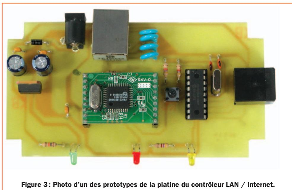
Figure 3: Photo d'un des prototypes de la platine du contrôleur LAN / Internet.
