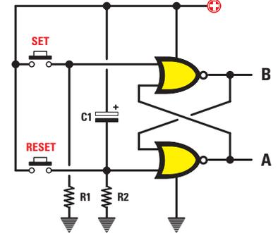
Figure 538: Schéma électrique d'un FLIP-FLOP Set-Reset utilisant deux portes NOR. La table de Vérité de ce FLIP-FLOP est reportée figure 539.
