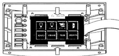
Quatrième phase : positionnez le "lay-out", préparé avec l'imprimante, sur l'écran tactile (les caractères imprimés sont tournés vers l'extérieur).
