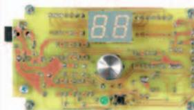
Ce montage utilise deux capteurs pour détecter les conditions atmosphériques (pluie et vent) et un microcontrôleur pour la gestion des données, avec possibilité d'activer une sortie à relais au cas où le seuil d'alarme prédéfini serait dépassé. Il est idéal pour contrôler la fermeture de sécurité (en cas de pluie ou vent fort) des stores, parasols et autres Velux motorisés.
