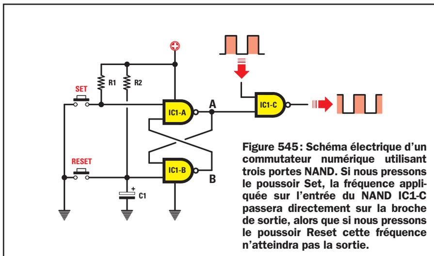
Figure 545: Schéma électrique d'un commutateur numérique utilisant trois portes NAND. Si nous pressons le poussoir Set, la fréquence appliquée sur l'entrée du NAND IC1-C passera directement sur la broche de sortie, alors que si nous pressons le poussoir Reset cette fréquence n'atteindra pas la sortie.
