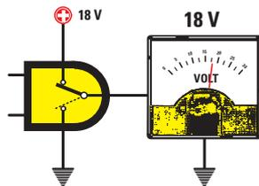
Figure 533 : Si l'on utilise des circuits intégrés CMOS, pouvant être alimentés par des tensions variables de 5 à 18 V, il va de soi que leur niveau logique aura une valeur égale à la tension d'alimentation.
