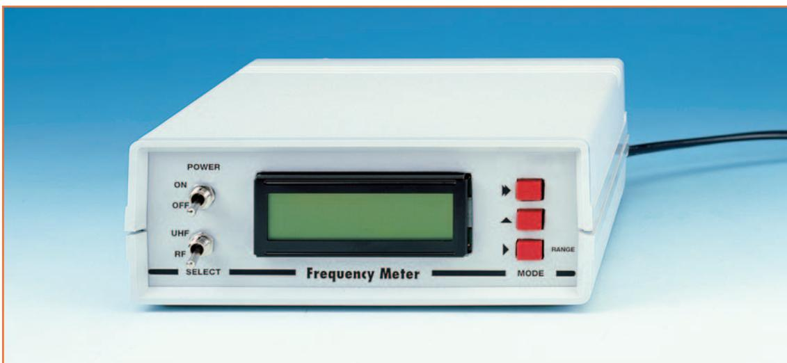
**E**n fait, ce nouveau fréquencesmètre numérique a réussi dans notre labo à mesurer des fréquences au-delà de 2,4 GHz, mais sans doute, à cause de la tolérance des composants, ne faut-il pas espérer le faire travailler en dessus de 2,2 ou 2,3 GHz. Dans cette première partie, nous allons nous consacrer à son étude théorique,
