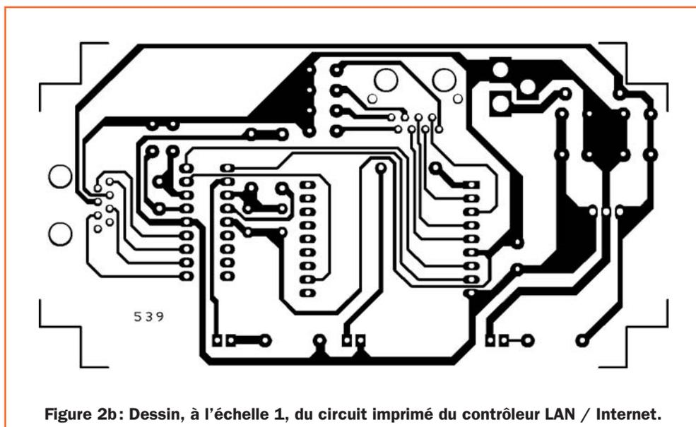
Figure 2b: Dessin, à l'échelle 1, du circuit imprimé du contrôleur LAN / Internet.
