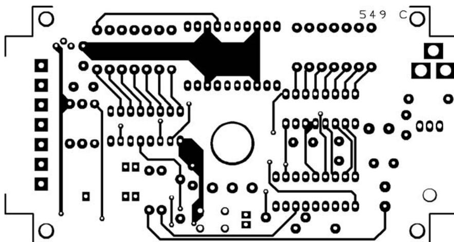
Figure 2b-2: Dessin, à l'échelle 1, du circuit imprimé double face à trous métallisés du contrôleur "pluie et vent" à affichage numérique, côté composants.
