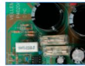
Set étage amplificateur final BF peut fonctionner en mono (ponté) ou en stéréo. Il fournit une puissance maximale musicale / RMS de 300 / 155 W par canal, soit au total 600 / 300 W. Il est protégé thermiquement. Un circuit spécial règle, en permanence, sur la classe
