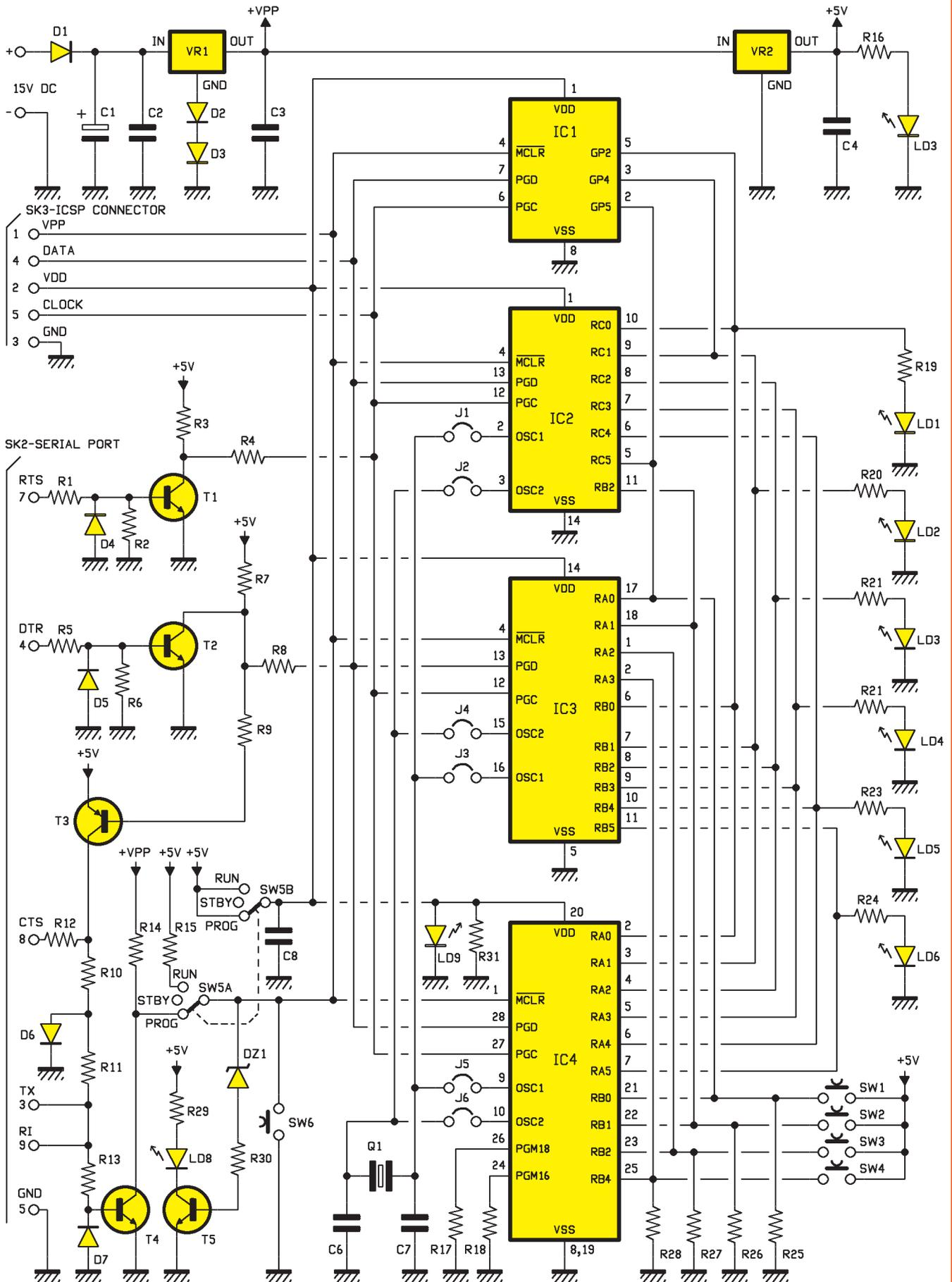
Figure 1 : Schéma électrique du programmeur de PIC.
