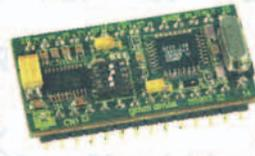
grifo<sup>®</sup> Mini-Module de 28 broches basée sur la CPU AVR Atmel ATmega 8 avec 8K FLASH; 1K RAM; 512 Bytes EEPROM; 3 Temporisateurs Compteurs, 3 PWM; 8 A/N 10/8 bits; SPI; Chien de garde Temporisateur; 23 lignes d'E/S TTL; RS 232 ou TTL; 1 LED d'état; Commutateur DIP de configuration; etc. Alimentation de 2,7V à 5,5V.
