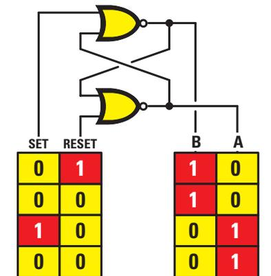
Figure 539: Cette table de Vérité montre les niveaux logiques présents sur les sorties A-B d'un FLIP-FLOP utilisant deux portes NOR.
