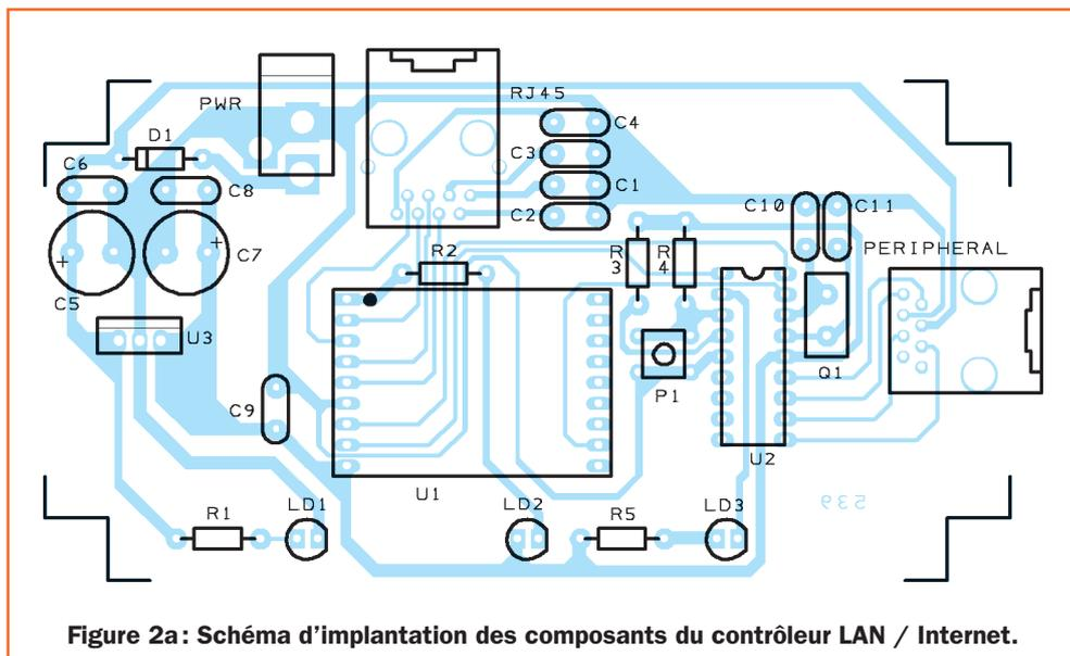
Figure 2a: Schéma d'implantation des composants du contrôleur LAN / Internet.
