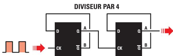
Figure 551 : En reliant en série deux FLIP-FLOP de type D on obtient un diviseur par 4. Ce qui fait que, en appliquant sur l'entrée CK une fréquence de 100 kHz, nous aurons sur la sortie QA du second diviseur une fréquence de 25 kHz.
