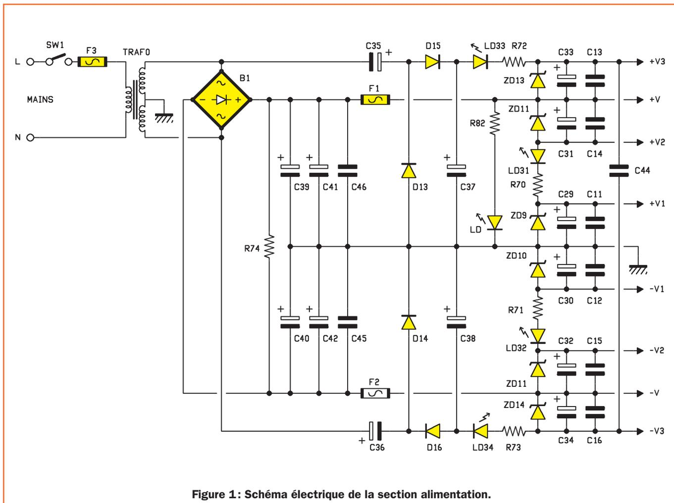
Figure 1: Schéma électrique de la section alimentation.
