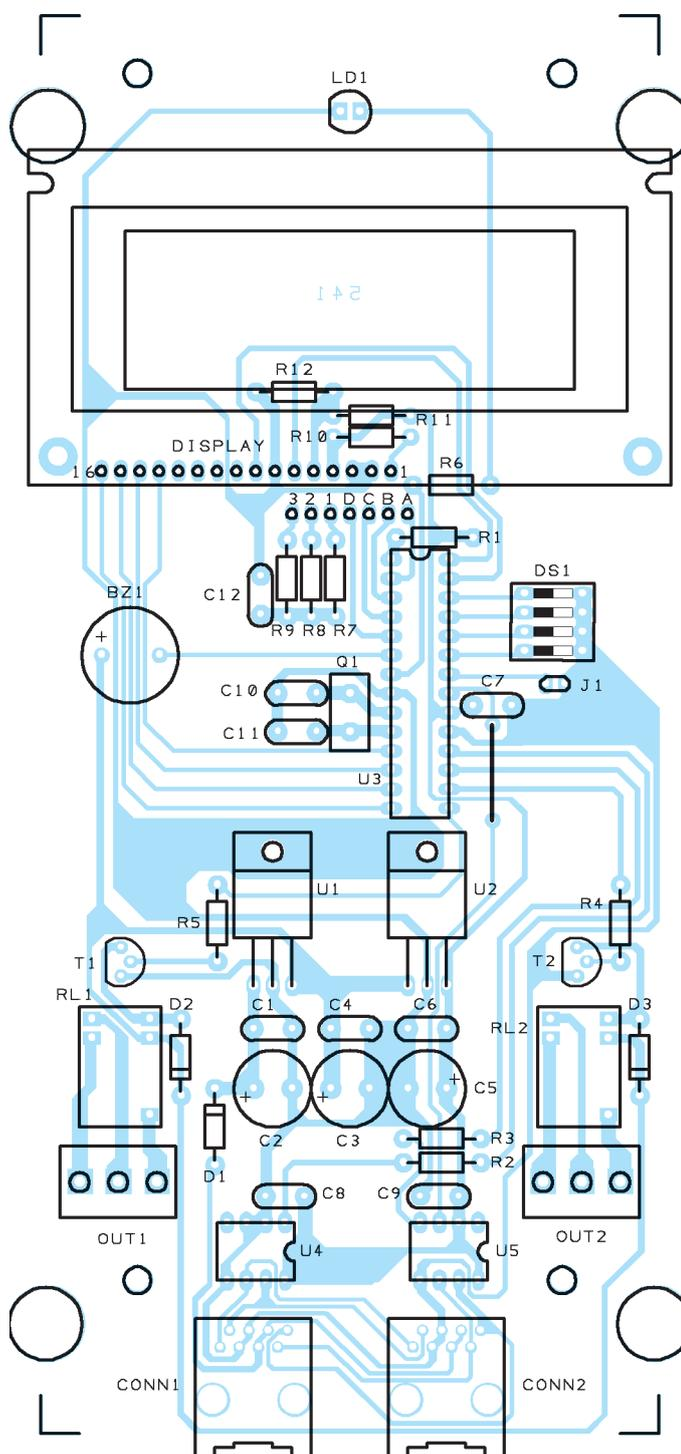
Figure 2a: Schéma d'implantation des composants du terminal à clavier et afficheur LCD.
