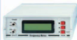
Ce fréquencesmètre est des plus performants. Il «monte» allégrement à 2,2 GHz et permet de soustraire ou d'ajouter la valeur de MF de tout récepteur dont on veut connaître la fréquence d'accord.
