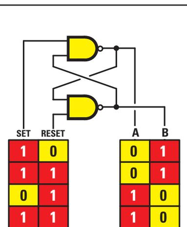
Figure 536: Cette table de Vérité montre les niveaux logiques présents sur les sorties A-B d'un FLIP-FLOP utilisant deux portes NAND.
