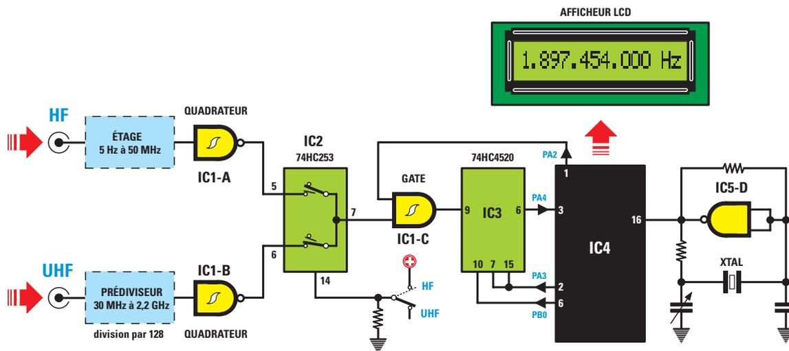
Figure 1 : Schéma synoptique du fréquencemètre numérique.
