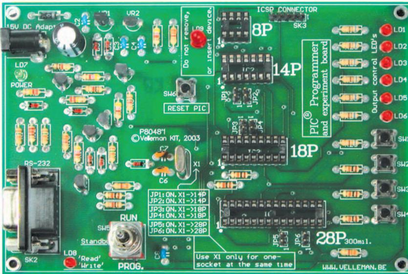
A droite, les quatre poussoirs et les six LED permettent de tester les programmes les plus simples.
