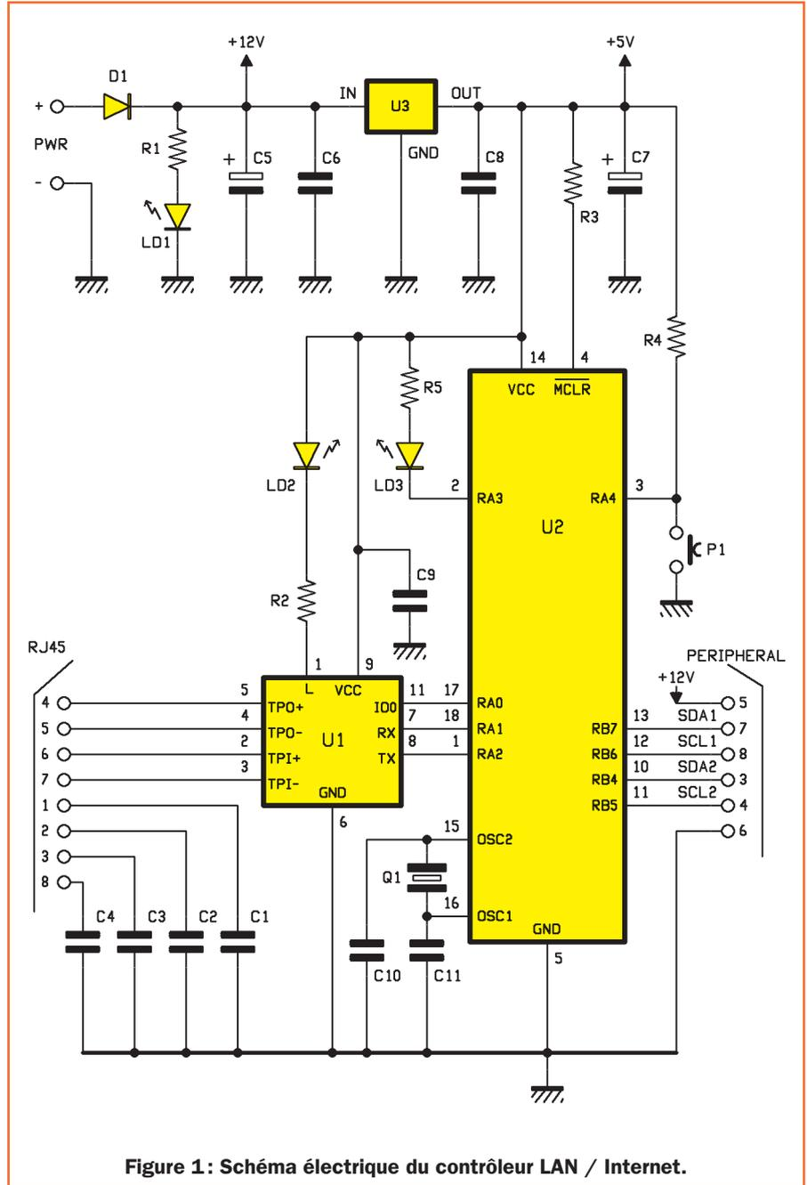
**Figure 1 : Schéma électrique du contrôleur LAN / Internet.**
