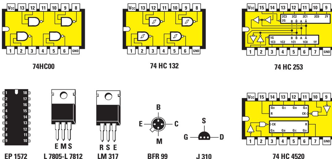
Figure 6 : Brochages des circuits intégrés vus de dessus et repère-détrompeurs en U vers la gauche, des régulateurs vus de face et des transistors vus de dessus.
