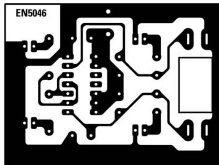
Figure 555b : Dessin, à l'échelle 1, du circuit imprimé du FLIP-FLOP, vu côté soudures.
