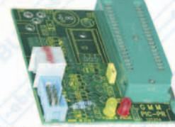
D9 pour la connexion à la RJ12 pour MPLAB; connecteur à 10 broches pour la connexion au Programmeur MP PIK+; connecteur pour la section alimentateur; 2 LEDs; ect..
