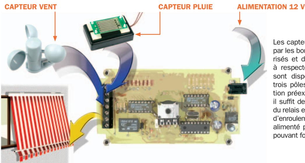
Les capteurs sont reliés à l'appareil par les borniers (ils ne sont pas polarisés et donc aucune polarité n'est à respecter). Les sorties du relais sont disponibles sur un bornier à trois pôles. Les liaisons à l'installation préexistante sont très simples : il suffit de relier les sorties C et NO du relais en parallèle avec le poussoir d'enroulement du store. L'appareil est alimenté par un bloc secteur 230 V pouvant fournir 12 V et 500 mA.
