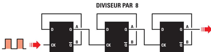
Figure 552 : En reliant en série trois FLIP-FLOP de type D, on obtient un diviseur par 8. Ce qui fait que, si sur l'entrée CK du premier diviseur de gauche est appliquée une fréquence de 100 kHz, sur la sortie QA du troisième diviseur nous aurons 12,5 kHz.
