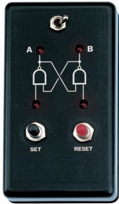
**Figure 558 :** Sur le boîtier plastique on collera l'étiquette autocollante où est représenté le symbole du FLIP-FLOP. Après avoir placé l'étiquette dans le bon sens, vous devrez exécuter trois perçages de 7 mm pour les poussoirs et l'interrupteur et quatre de 3,5 mm pour les diodes LED.
