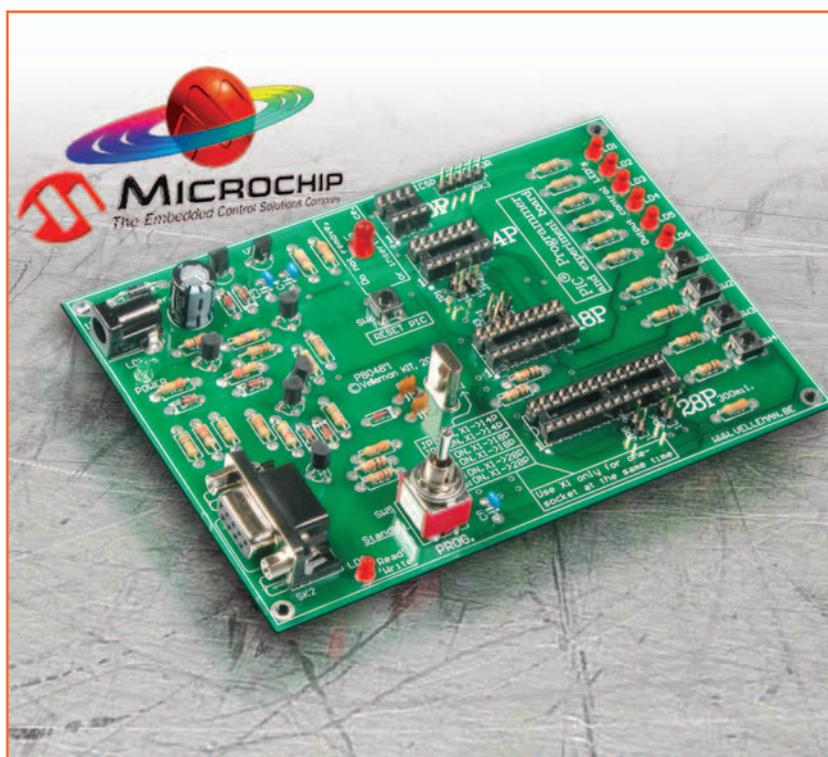
Le montage décrit ici est un programmeur multifonction apte à programmer tous (ou presque) les microcontrôleurs Microchip à mémoire programme de type "flash", c'est-à-dire effaçables électriquement. Il s'agit bien sûr de la famille PIC, les microcontrôleurs programmables à 8 bits les plus réputés chez les passionnés d'électronique. L'emploi d'une "flash" pour la mémorisation du programme a rendu beaucoup plus facile et rapide le développement du programme résident ("firmware").
