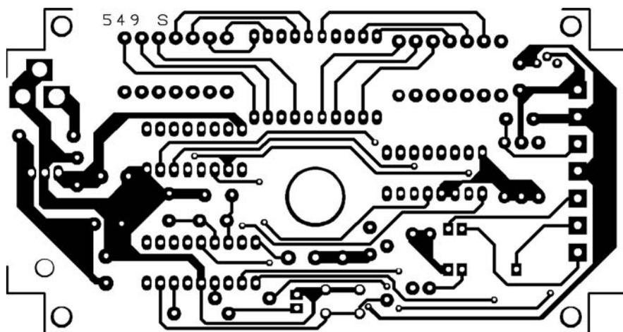
Figure 2b-1: Dessin, à l'échelle 1, du circuit imprimé double face à trous métallisés du contrôleur "pluie et vent" à affichage numérique, côté soudures.
