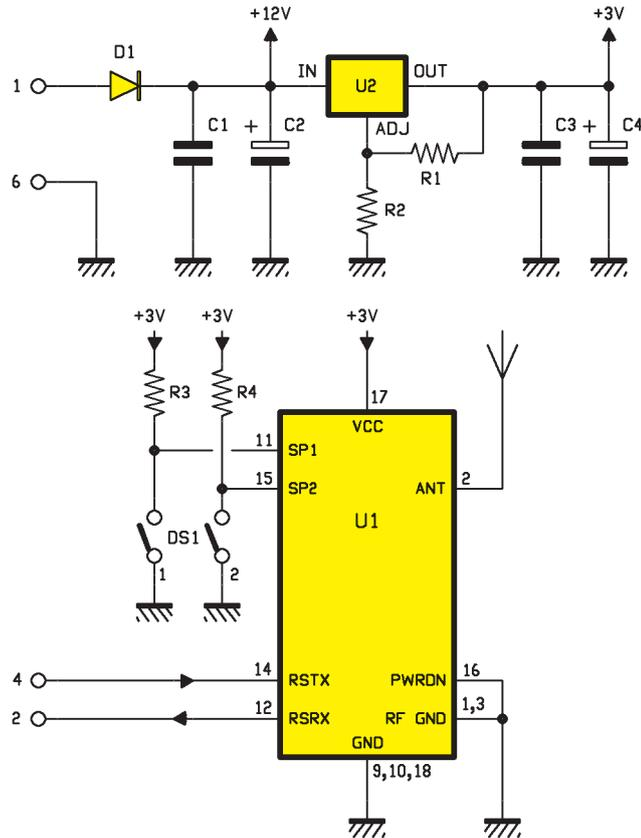
Le récepteur également est en réalité un émetteur/récepteur utilisant encore le module AUREL XTR903. Ce circuit tout simple est relié à la platine de base ET520A du système de contrôle d'éclairage de scène (directement aux points TX et RX du microcontrôleur U2). La vitesse de transmission, paramétrée par le dip-switch à deux micro-interrupteurs, doit bien sûr être égale à celle de l'émetteur.
