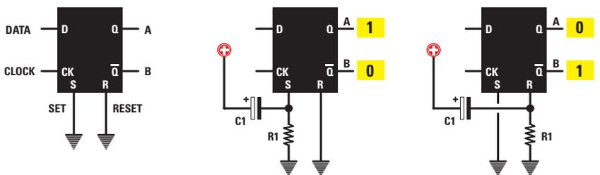
Figure 549 : Quand un FLIP-FLOP de type D comporte, en plus des broches D-CK-QA-QB, des broches Set et Reset (figure 546), celles-ci sont presque toujours reliées à la masse. Si la broche Set ou Reset est à la masse à travers une résistance et si cette broche est reliée à un condensateur de 1 microfarad (voir l'exemple du FLIP-FLOP à NOR, figure 538), la sortie QA ou QB sera contrainte au niveau logique 1 chaque fois que nous appliquerons à ce FLIP-FLOP sa tension d'alimentation.
