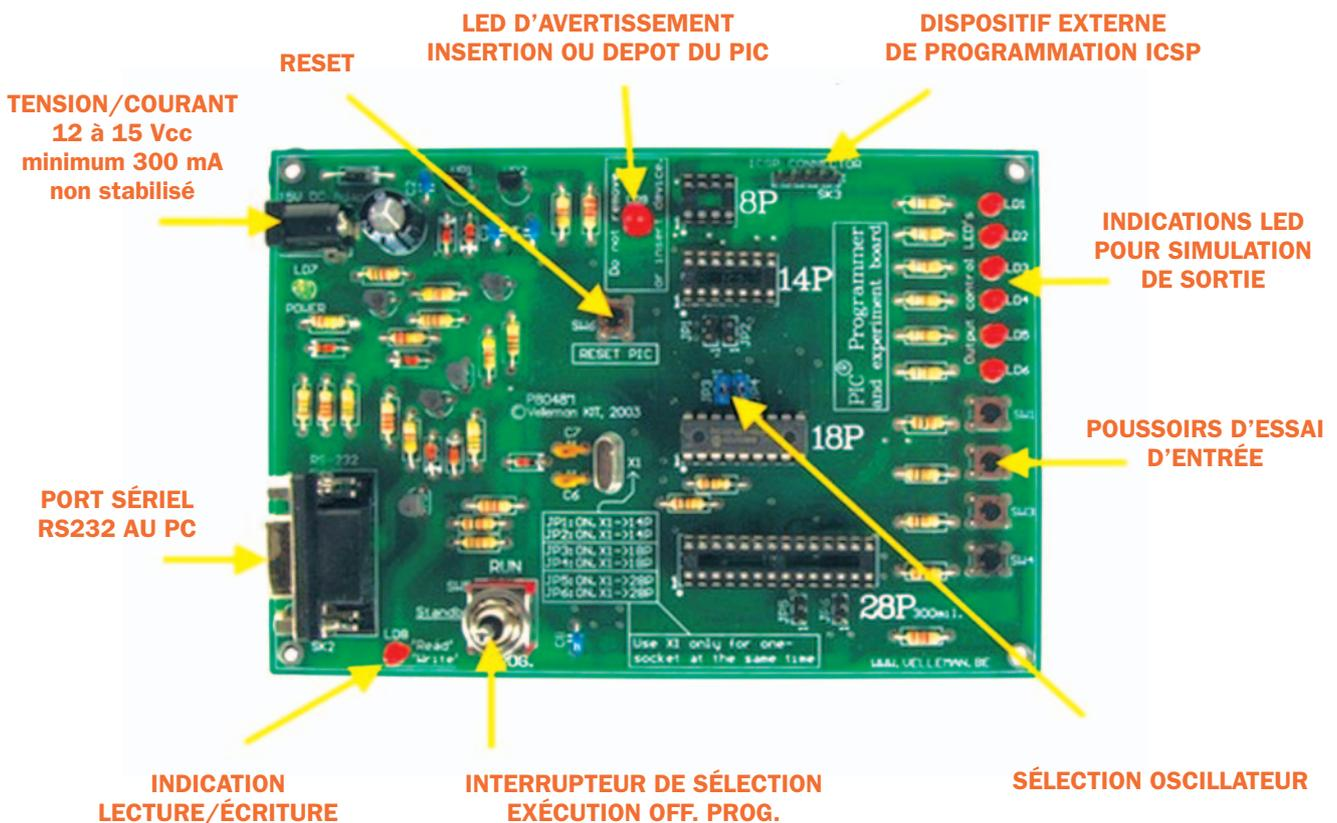
La photo montre toutes les prises d'entrée / sortie, les LED de signalisation et les divers contrôles. Le PIC à programmer à insérer dans un des quatre supports. Au moyen des quatre poussoirs et des six LED de droite, il est possible de tester les programmes les plus simples. Pour alimenter le programmeur, on se sert d'un adaptateur bloc secteur 230 V fournissant une tension non stabilisée de 12 à 15 V.
