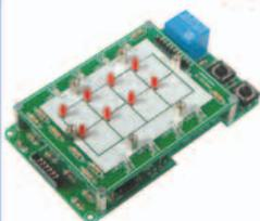
Ce clavier à écran tactile rétro-éclairé offre la possibilité de modifier les caractères des touches : il suffit pour cela d'utiliser une imprimante et un support transparent (un programme rend l'impression plus facile). L'appareil est géré entièrement par microcontrôleur et comporte huit sorties à collecteurs ouverts.
