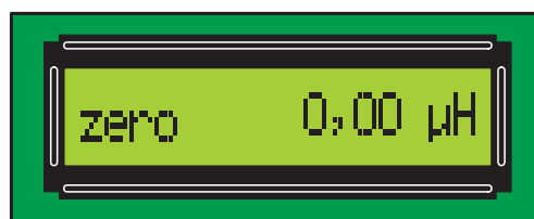
Figure 10: Pour mémoriser dans le microcontrôleur IC3 la fréquence produite par JAF1 et C1, il suffit de presser pendant quelques secondes P1 et, quand l'afficheur LCD cesse de clignoter et que cette indication apparaît, la fréquence est mémorisée.
