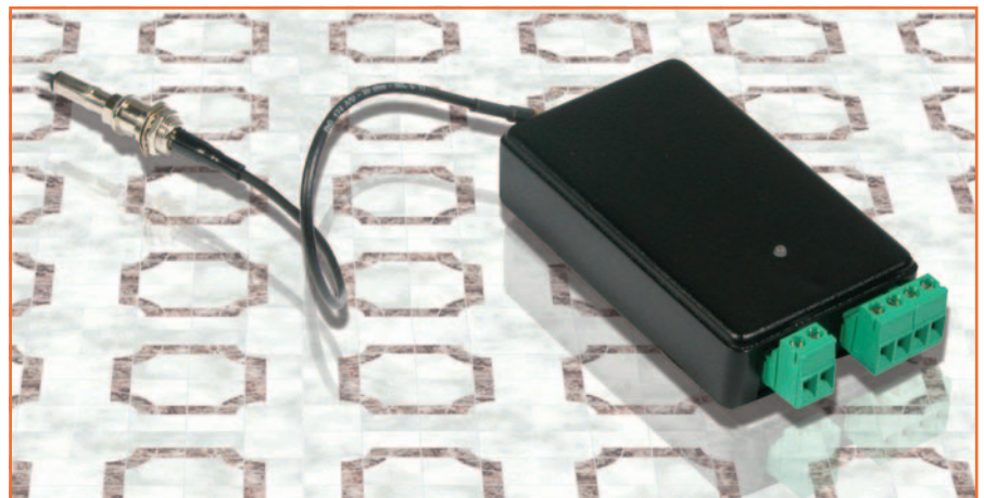
Figure 4: Platine de l'alarme téléphonique GSM installée dans son boîtier plastique type SC/700.
