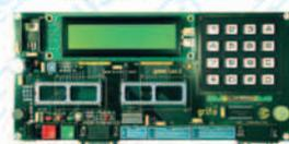
connecteurs rectangulaires **D9** pour la connexion à la ligne série en **RS 232**; connecteurs **10** broches pour la connexion à la **AVR ISP**; clavier à 16 touches; écran LCD rétroéclairé, de 20 caractères pour 2 lignes; Buzzer; connecteurs et sections d'alimentation; touches et LED pour la gestion des E/S numériques; etc.
