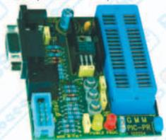
connecteur à 10 broches pour la connexion au Programmeur **MP PIK+**; connecteur pour la section alimentateur; 2 LEDs; etc..
