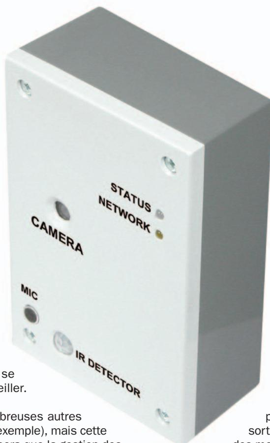
**R**appelons que l'appareil décrit dans la première partie est une unité distante GSM dotée d'une mini caméra vidéo qui, en cas d'alarme (ou sur demande), peut prendre une photo et l'envoyer comme pièce jointe d'un e-mail à une adresse électronique spécifiée. L'utilisateur peut ainsi exercer un contrôle visuel sur ce qui se passe dans un lieu qu'il désire surveiller.
