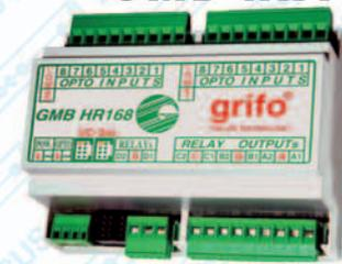
La **GMB HR168** est fondamentalement un module à Barre DIN en mesure d'accueillir une CPU **grifo** Mini-Module du type **GMM** à 40 broches. Elle dispose de 16 entrées Galvaniquement isolées pour les signaux **NPN** ou **PNP**; 8 Relais de 5
