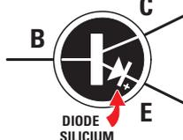
**Figure 502:** Avec les valeurs 56-47-39 kilohms, la tension reste fixe à 0,65 V parce que la jonction Base/Émetteur d'un transistor se comporte comme si une diode au silicium se trouvait à l'intérieur et, comme celle-ci commence à conduire lorsqu'on dépasse 0,65 V, même si le partiteur R1-R2 fournit une tension plus élevée, celle-ci se stabilise à 0,65 V.
