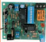
Pour radiocommande. Très bonne portée. Le nouveau module AUREL permet, en champ libre, une portée entre 2 et 5 km. Le système utilise un circuit intégré codeur MM53200 (UM86409). Décrit dans ELEC-TRONIQUE n° 1.
