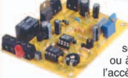
En approchant d'elle un transpondeur (type carte ou porte-clés) préalablement validé, cette serrure électronique à haut degré de sécurité commande un relais en mode bistable ou à impulsions. Chaque serrure peut permettre l'accès à 200 personnes différentes.
