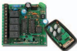
Système de télécommande à code aléatoire et tournant. Chaque fois que l'on envoie un signal, la combinaison change. Avec ses 268 435 456 combinaisons possibles le système offre une sécurité maximale.
