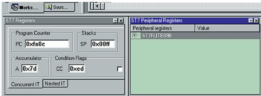
Figure 7 : Après avoir ouvert la fenêtre ST7 Registers, vous devez ouvrir aussi la fenêtre ST7 Peripheral Registers en cliquant sur l'icône R7 rouge. Pour l'agrandir, utilisez la souris et traînez les bords horizontaux et verticaux.
