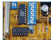
Ce mini-émetteur audio/vidéo en VHF, peut être activé et désactivé au moyen d'une télécommande codée sur 433 MHz. Il est adapté aux contrôles vidéo dans des locaux divers, mais également à la surveillance à distance d'une habitation, d'une chambre d'enfants, etc. La transmission peut être facilement reçue sur un téléviseur quelconque. Plusieurs émetteurs vidéo peuvent être commandés alternativement en leur affectant à chacun un canal de télécommande particulier.
