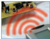
Cet appareil est un récepteur à infrarouges capable de reconnaître et d'interpréter le protocole NEC à 38 kHz de toute télécommande universelle du commerce. En utilisant n'importe laquelle de ces télécommandes et en appuyant sur les poussoirs 1 à 8, il est possible de contrôler jusqu'à huit relais (avec notre extension ET473 publiée dans ELM 47). Les sorties peuvent fonctionner en mono ou en bistable.
