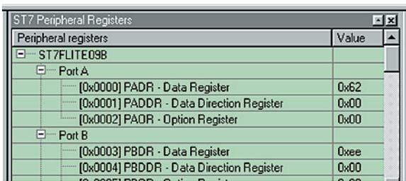
Figure 9 : En cliquant sur toutes les cases à côté de Port A, Port B, etc., vous ouvrez une liste de registres utilisés par tous les périphériques et toutes les fonctions supplémentaires du microcontrôleur.
