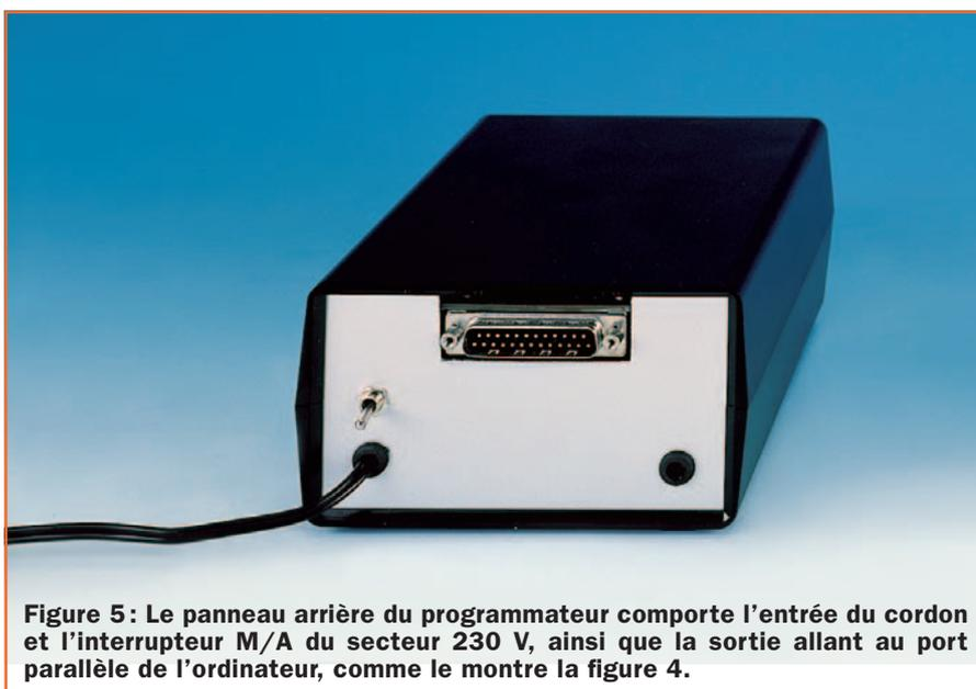
Figure 5 : Le panneau arrière du programmeur comporte l'entrée du cordon et l'interrupteur M/A du secteur 230 V, ainsi que la sortie allant au port parallèle de l'ordinateur, comme le montre la figure 4.
