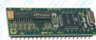
**grifo** Mini-Module de 40 broches basée sur la CPU **Atmel T89C51AC2** avec 32K FLASH; 256 Bytes RAM; 1K ERAM; 2K FLASH pour Programme de lancement; 2K EEPROM; 3
