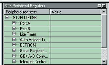
Figure 8 : En cliquant dans la case à côté de ST7FLITE09B, une liste des périphériques du microcontrôleur apparaît.
