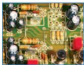
Cet étage amplificateur final BF de puissance pouvant fonctionner en mono (ponté) ou en stéréo fournit une puissance maximale 100 W RMS. Il est réalisé avec deux circuits intégrés Philips.
