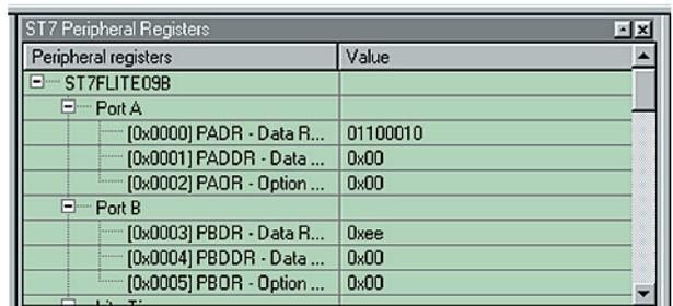
Figure 11 : Si l'on visualise en format binaire (voir figure 10) les valeurs du registre PADR, on voit immédiatement la correspondance entre le bit et la broche du port. En effet, le bit 0 correspond à la PA0, le bit 1 à la broche PA1 et ainsi de suite.
