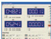
Ce système est capable d'enregistrer sur ordinateur l'évolution de signaux continus ou lentement variables et ce, même sur des périodes très longues. Les mesures peuvent être mémorisées sur le disque dur pour une élaboration future. Grâce à la connexion USB, aucune alimentation extérieure n'est nécessaire et l'installation est facile et directe.
