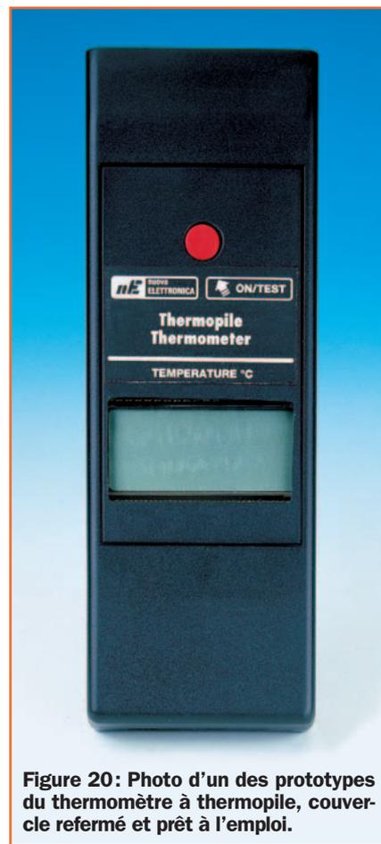
Figure 20: Photo d'un des prototypes du thermomètre à thermopile, couvercle refermé et prêt à l'emploi.
