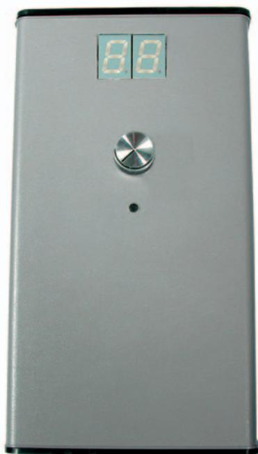
À droite la platine montée vue côté soudures où apparaissent l'axe et l'écrou du potentiomètre R8 et le poussoir P1 (les pistes étamées ont été renforcées pour le passage des forts courants secteur). À gauche la face avant du boîtier laisse le passage à l'afficheur à 7 segments (deux chiffres, indiquant la puissance consommée), à l'axe du potentiomètre (avec bouton) permettant de paramétrer la valeur de seuil et à celui du poussoir pour la mémorisation.
