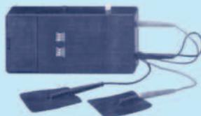
Cet appareil permet de soulager des douleurs tels l'arthrose et les céphalées. De faible encombrement, ce kit est alimenté par piles incorporées de 9 volts. Tension électrode maximum : -30 V - +100 V. Courant électrode maximum : 10 mA. Fréquences : 2 à 130 Hz.
