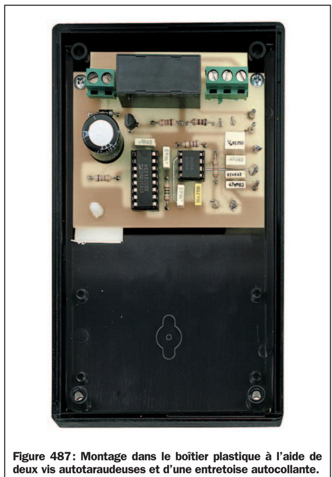
Figure 487: Montage dans le boîtier plastique à l'aide de deux vis autotaraudeuses et d'une entretoise autocollante.
