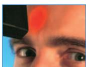
Aujourd'hui les risques de contagion nosocomiale peuvent diminuer grâce à l'électronique : en effet, les thermopiles (ou piles thermiques, c'est-à-dire produisant du courant électrique à partir d'un échauffement) permettent de construire des thermomètres mesurant la température corporelle du patient à distance (donc sans contact) en quelques secondes.
