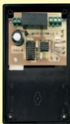
Le EN5044 permet de définir une temporisation allant d'une minute à deux heures environ, le EN5045 permet de définir une temporisation pouvant aller jusqu'à 24 heures environ.
