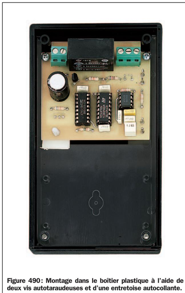
Figure 490 : Montage dans le boîtier plastique à l'aide de deux vis autotaraudeuses et d'une entretoise autocollante.
