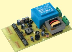
Montage se plaçant en sortie de compteur. Il permet de visualiser, sur un afficheur à deux chiffres, la consommation d'énergie (en kWh) en aval. Il est ainsi possible de connaître à tout moment la puissance délivrée. Un circuit d'alarme à seuil paramétrable fait retentir un signal acoustique quand la puissance consommée est trop élevée par rapport à la limite imposée par la puissance souscrite et le disjoncteur général.
