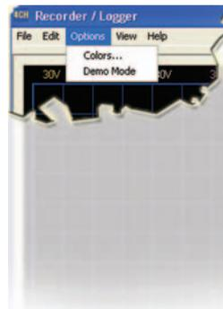
c) Chaque ligne présente sur le graphique, ou bien la grille principale, est représentée par des couleurs différentes que l'on peut modifier par l'option "colors". Par la commande "demo mode" on peut lancer une simulation de démonstration d'un échantillonnage.
