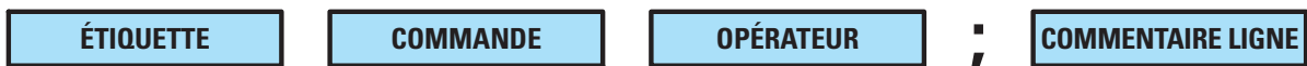
Figure 2 : Chaque ligne d'instruction est formée de quatre blocs. L'ÉTIQUETTE, la COMMANDE (voir Tableau 1, la première colonne Mnemo Commandes), les OPÉRATEURS et le COMMENTAIRE LIGNE. L'Étiquette, optionnelle, ne doit jamais dépasser huit caractères. Le Commentaire ligne doit toujours être précédé d'un ; (point virgule).
