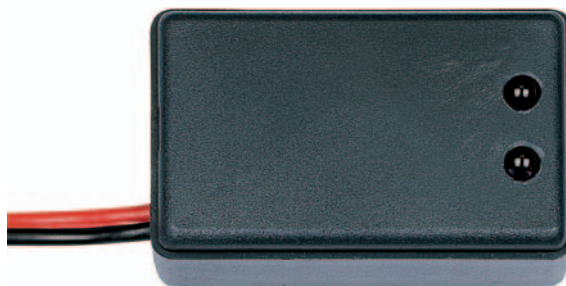
Figure 11 : Le couvercle doit être percé pour laisser affleurer les deux diodes émettrices.
