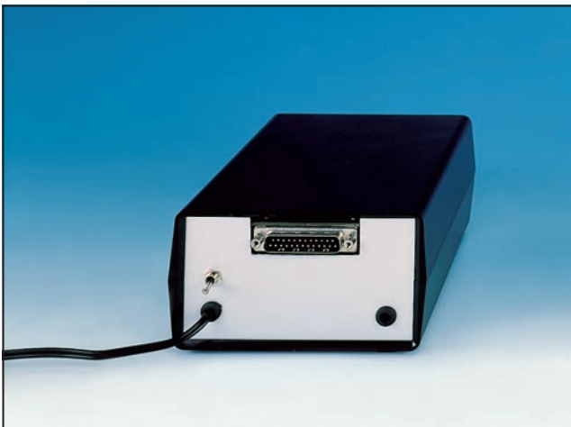
Figure 13 : Dans le boîtier plastique sont insérés le programmeur et son alimentation. Le connecteur à 25 broches sortant sur le panneau arrière sert à la liaison à l'ordinateur.
