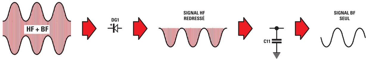
**Figure 381 :** Du secondaire de la MF2 sort un signal HF comme celui du dessin de gauche. La diode DG1 élimine la demie onde positive. Si l'on connecte entre la diode et la masse un condensateur de 15 nF, il décharge à la masse seulement la fréquence HF car, pour les 455 kHz, ce condensateur se comporte comme une résistance de quelques ohms, alors qu'en BF il se comporte comme une résistance de 1 kilohm.
