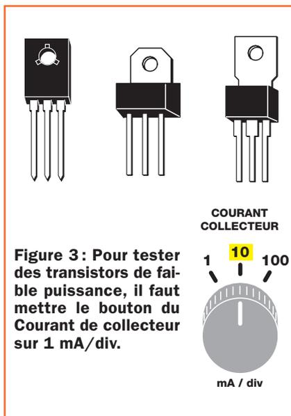
Figure 3: Pour tester des transistors de faible puissance, il faut mettre le bouton du Courant de collecteur sur 1 mA/div.
