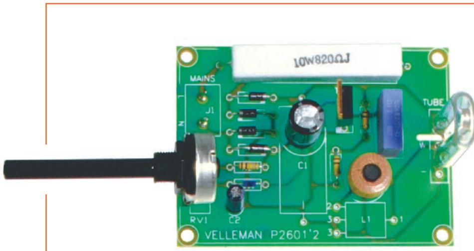
Figure 4: Photo d'un des prototypes de la platine du feu à éclats ou stroboscope prête à l'utilisation.
