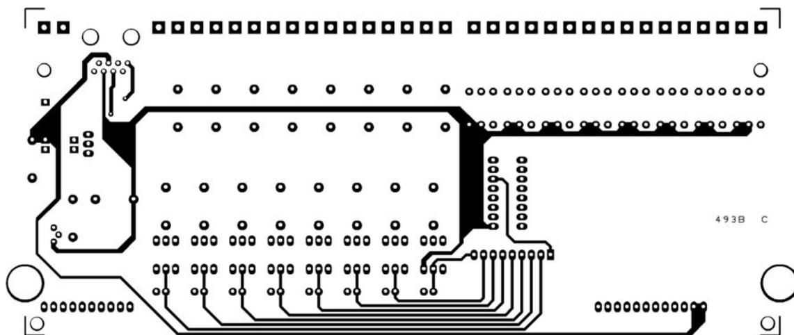
Figure 6b-1: Dessin, à l'échelle 1, du circuit imprimé de la platine B du contrôleur domotique par l'Internet, côté soudures. Attention, le dessin n'est pas à l'échelle 1: photocopiez-le avec un taux d'agrandissement de 141 %!
