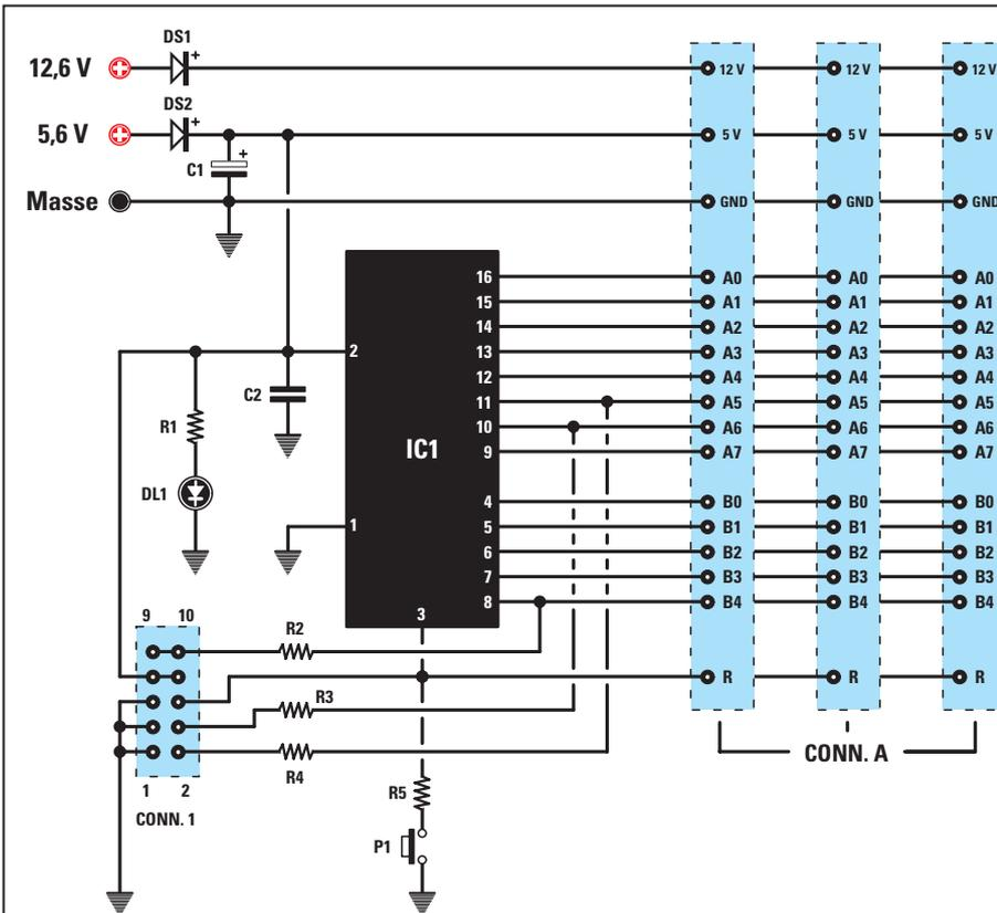
Figure 6: Schéma électrique du bus EN1547 avec son poussoir de "reset" P1. IC1 est le ST7LITE09 qui, une fois programmé, vous permettra de piloter les platines expérimentales que vous enfilerez dans les trois connecteurs CONNA.
