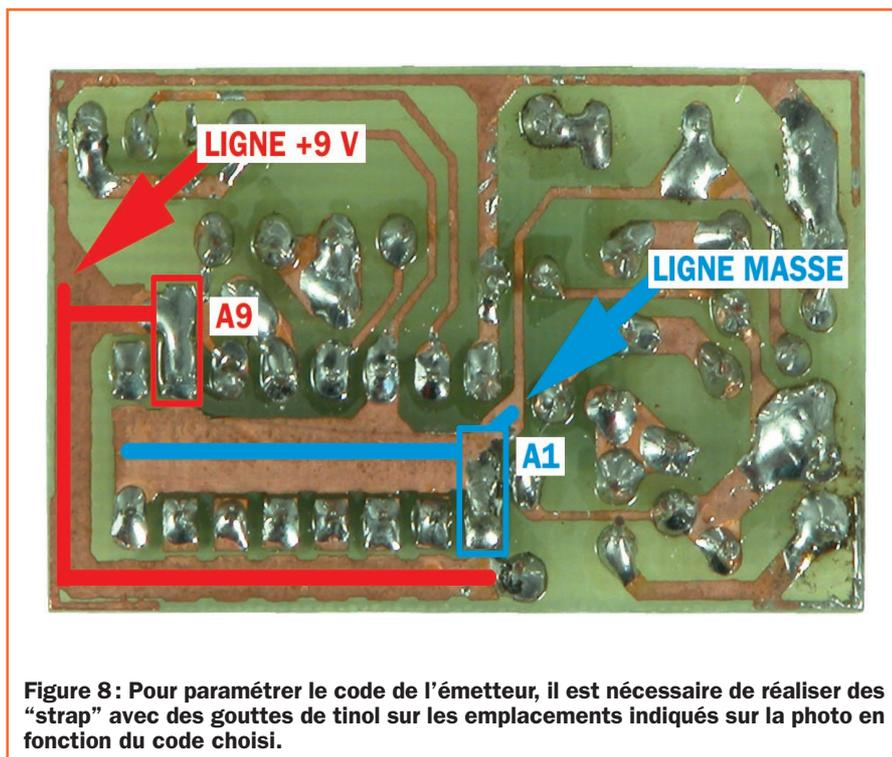
Figure 8: Pour paramétrer le code de l'émetteur, il est nécessaire de réaliser des "strap" avec des gouttes de tinol sur les emplacements indiqués sur la photo en fonction du code choisi.
