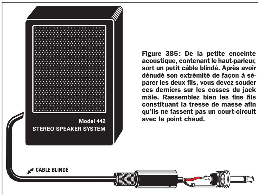
**Figure 385: De la petite enceinte acoustique, contenant le haut-parleur, sort un petit câble blindé. Après avoir dénudé son extrémité de façon à séparer les deux fils, vous devez souder ces derniers sur les cosses du jack mâle. Rassemblez bien les fins fils constituant la tresse de masse afin qu'ils ne fassent pas un court-circuit avec le point chaud.**
