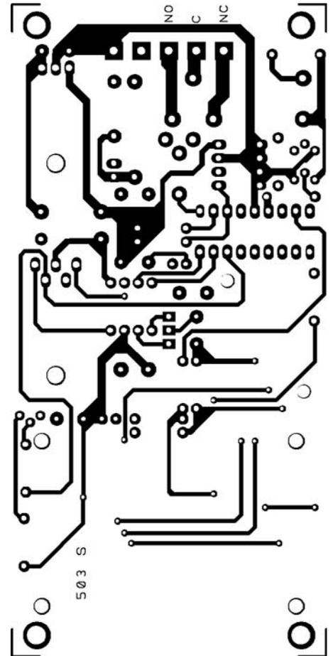
Figure 4b-2: Côté soudures. Si vous réalisez vous-même ce circuit imprimé, n'oubliez pas toutes les liaisons indispensables entre les deux faces.
