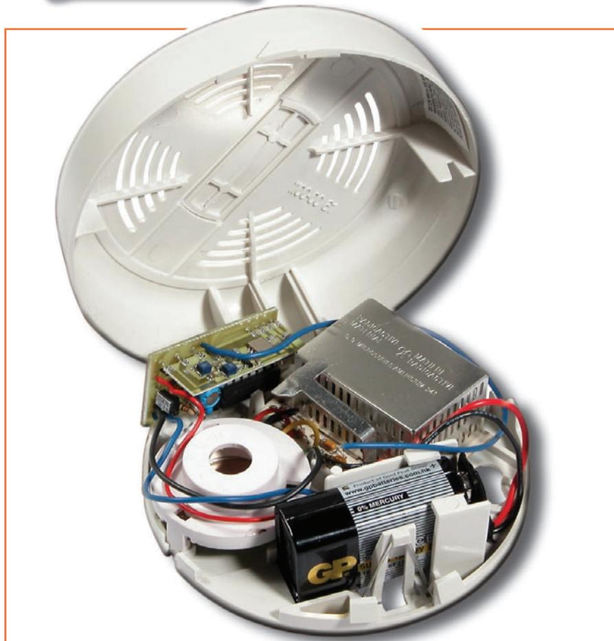
**Figure 1:** Grâce à ses dimensions très réduites, le montage que nous vous proposons prend place sans peine dans à l'intérieur du détecteur. Pour l'alimenter, nous utilisons une pile ou une batterie rechargeable 6F22 de 9 V (elle alimente aussi le détecteur). La gestion du détecteur est réalisée par un circuit intégré A5367CA de Allegro Microsystems Inc.
