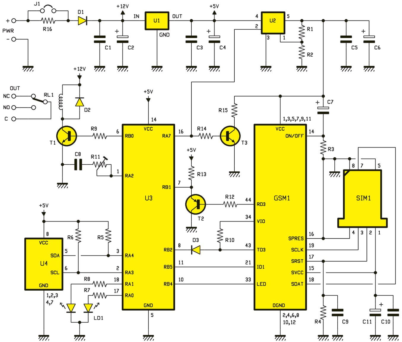
Figure 2 : Schéma électrique de l'ouvre-porte.
