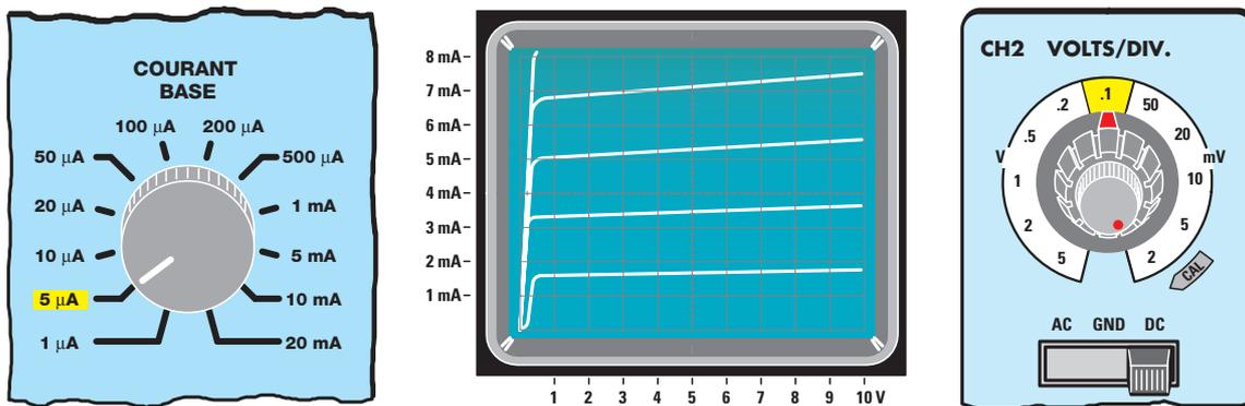
Figure 10 : Si en déplaçant le bouton Courant de base de 1 à 5 µA vous voyez que les sept courbes sortent de l'écran, réduisez l'amplification verticale de l'entrée Y du CH2, comme le montre la figure 11. Cela peut arriver pour un transistor NPN comme pour un PNP.
