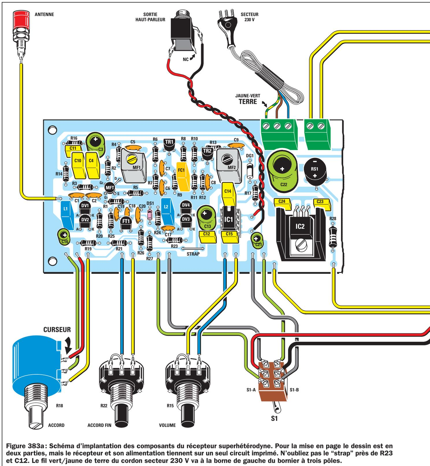
Figure 383a: Schéma d'implantation des composants du récepteur superhétérodyne. Pour la mise en page le dessin est en deux parties, mais le récepteur et son alimentation tiennent sur un seul circuit imprimé. N'oubliez pas le "strap" près de R23 et C12. Le fil vert/jaune de terre du cordon secteur 230 V va à la borne de gauche du bornier à trois pôles.
