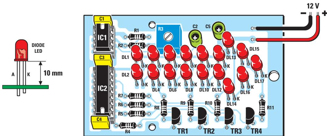
Figure 4a: Schéma d'implantation des composants de la flèche lumineuse à balayage variable. Les têtes des LED sont à maintenir à 10 mm du circuit imprimé.
