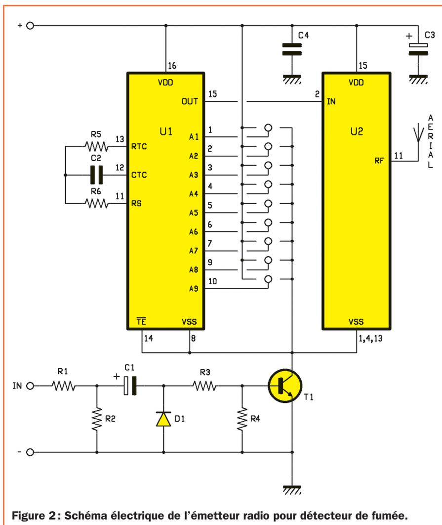
Figure 2 : Schéma électrique de l'émetteur radio pour détecteur de fumée.
