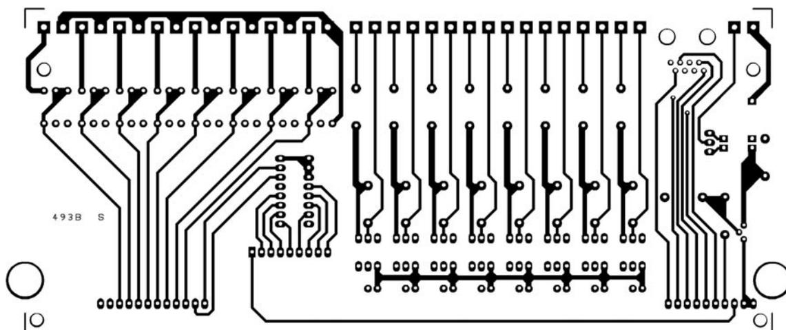
Figure 6b-2: Côté composants. Attention, le dessin n'est pas à l'échelle 1: photocopiez-le avec un taux d'agrandissement de 141 %!
