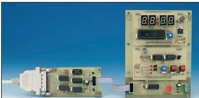
Figure 2 : A gauche, le programmeur EN1546 à relier au PC et, à droite, le bus EN1547 sur lequel on a enfilé les deux platines EN1548 et EN1549.
