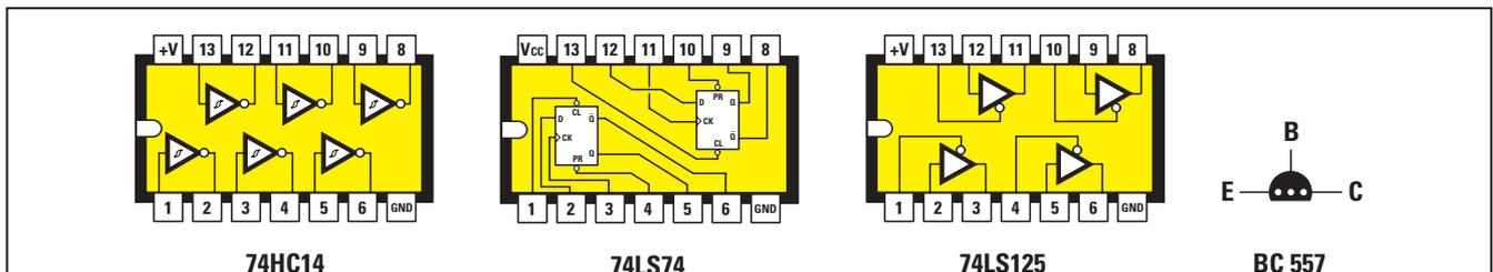
Figure 3 : Brochages, vue de dessus et repère-détrompeurs en U orientés vers la gauche, des trois circuits intégrés utilisés et du transistor BC557, vu de dessus et méplat repère-détrompeur vers le bas. Des quatre tampons du 74LS125 l'un n'est pas utilisé (voir dans le schéma électrique de la figure 4 le "buffer" IC4-D).
