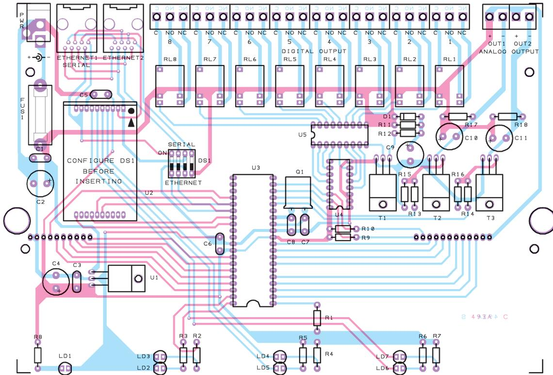
Figure 4a: Schéma d'implantation des composants de la platine A du contrôleur domotique par l'Internet.
