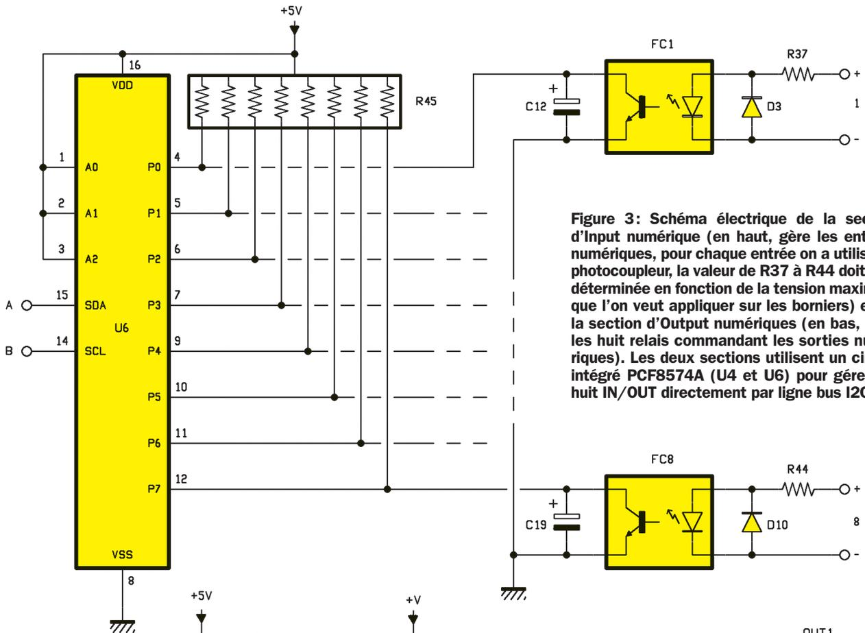
Figure 3: Schéma électrique de la section d'Input numérique (en haut, gère les entrées numériques, pour chaque entrée on a utilisé un photocoupleur, la valeur de R37 à R44 doit être déterminée en fonction de la tension maximale que l'on veut appliquer sur les borniers) et de la section d'Output numériques (en bas, gère les huit relais commandant les sorties numériques). Les deux sections utilisent un circuit intégré PCF8574A (U4 et U6) pour gérer les huit IN/OUT directement par ligne bus I2C.
