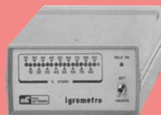
Plage de mesure : 10 - 90 %. Indication : 17 LED par pas de 5%. Sortie : alarme par relais (seuil réglable par potentiomètre).
