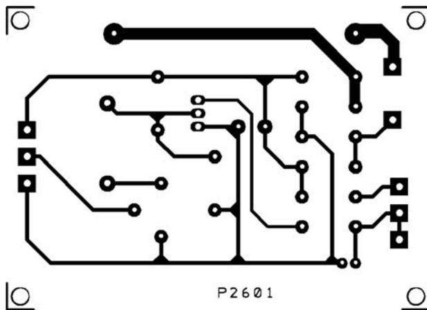
Figure 3b: Dessin, à l'échelle 1:1, du circuit imprimé du feu à éclats ou stroboscope vu côté soudures.
