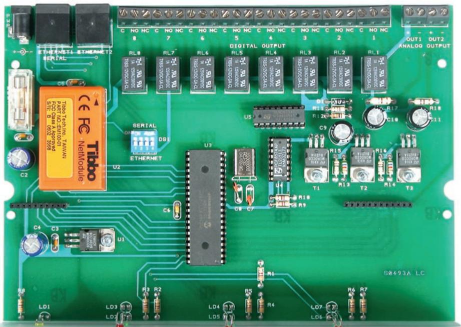
Figure 5: Photo d'un des prototypes de la platine A du contrôleur domotique par l'Internet.
