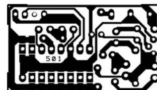
Figure 5b : Dessin, à l'échelle 1, du circuit imprimé de l'émetteur radio pour détecteur de fumée.
