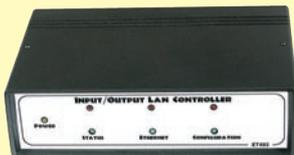
Cet appareil gère des entrées et des sorties, analogiques ou numériques, par l'Internet. Idéal pour des applications de contrôle à distance d'une maison, il est muni d'une sortie alarme et d'un port bus I2C utilisable pour une extension du système à de nouvelles entrées/sorties numériques ou analogiques.
