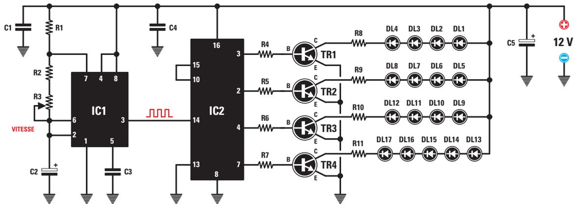
**Figure 2 :** Schéma électrique de la flèche lumineuse à balayage variable. Ce circuit est en mesure d'allumer à vitesse variable les LED reliées aux collecteurs des transistors TR1, TR2, TR3 et TR4. Les premières LED à s'allumer sont celles reliées au collecteur de TR1, ensuite c'est au tour de celles reliées à TR2, puis celles reliées à TR3 et enfin celles reliées à TR4 (voir dessin de la flèche figure 5).
