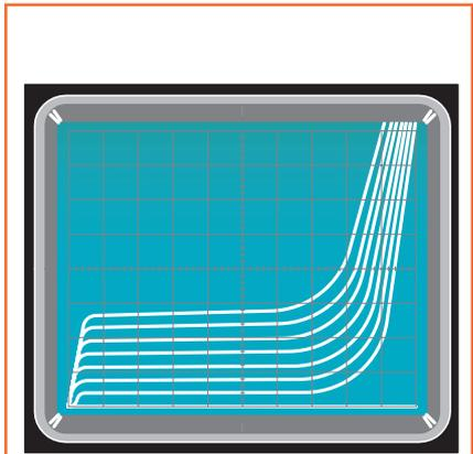
Figure 2: Si vous voyez apparaître à l'écran un graphe s'incurvant vers le haut à droite, c'est que vous avez interverti les pattes émetteur et collecteur sur les entrées EC du traceur de courbe. Dès que vous aurez rectifié, vous verrez apparaître un graphe correct, comme le montre la figure 1.
