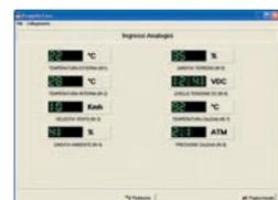
Figure 9 : Le logiciel, que nous présenterons ultérieurement avec le protocole de communication et l'extension des sorties analogiques, permet de réaliser, au moyen du contrôleur I/O LAN, un système de gestion domotique complet pour une maison. Le logiciel est en mesure de gérer des liaisons par l'Internet basées sur le protocole TCP/IP et sérielles par PC.
