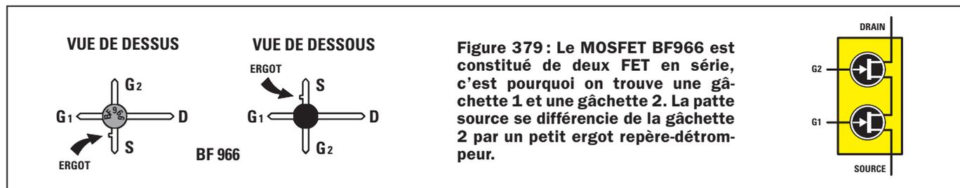
Figure 379: Le MOSFET BF966 est constitué de deux FET en série, c'est pourquoi on trouve une gâchette 1 et une gâchette 2. La patte source se différencie de la gâchette 2 par un petit ergot repère-détrompeur.
