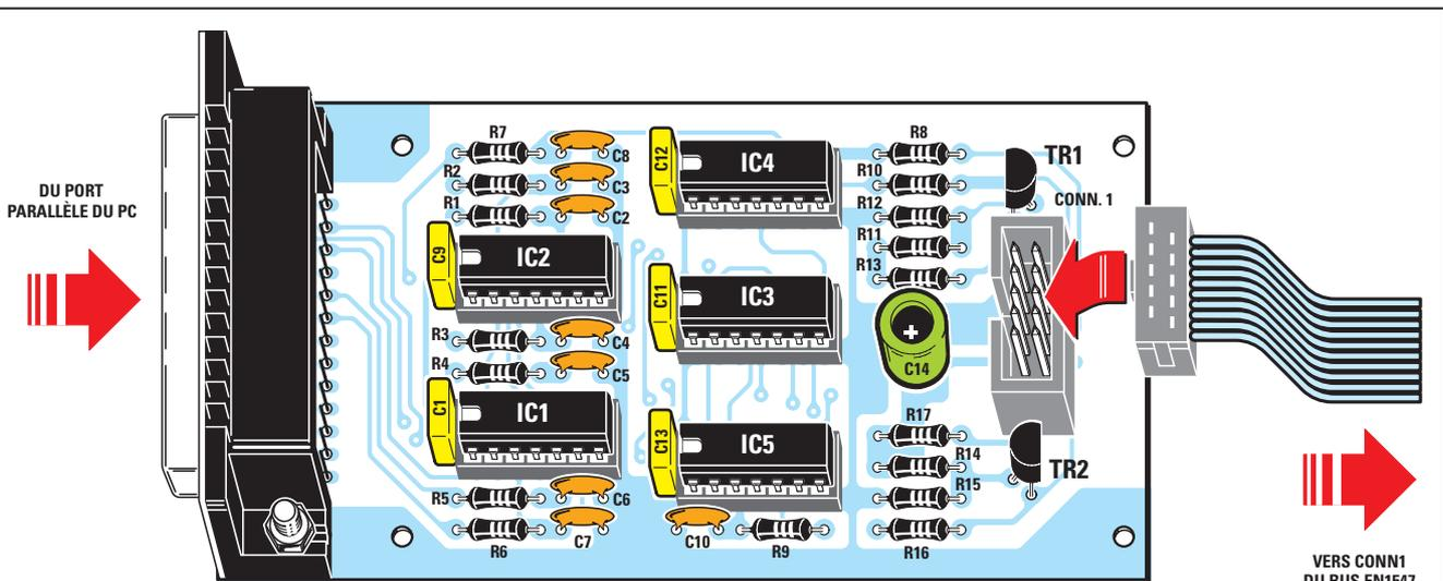
Figure 9a : Schéma d'implantation des composants de la platine du programmeur EN1546. Veillez à orienter l'évidement du CONN1 mâle à dix pôles de cette platine vers l'intérieur, soit vers C14.
