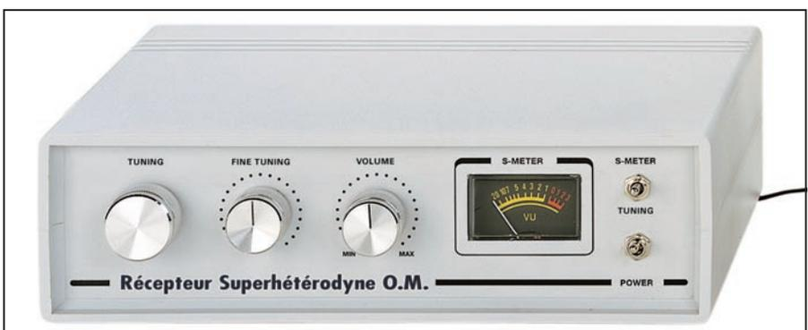
Figure 375: Photo d'un des prototypes du récepteur superhétérodyne pour OM installé dans son boîtier plastique, que nous vous invitons maintenant à construire.
