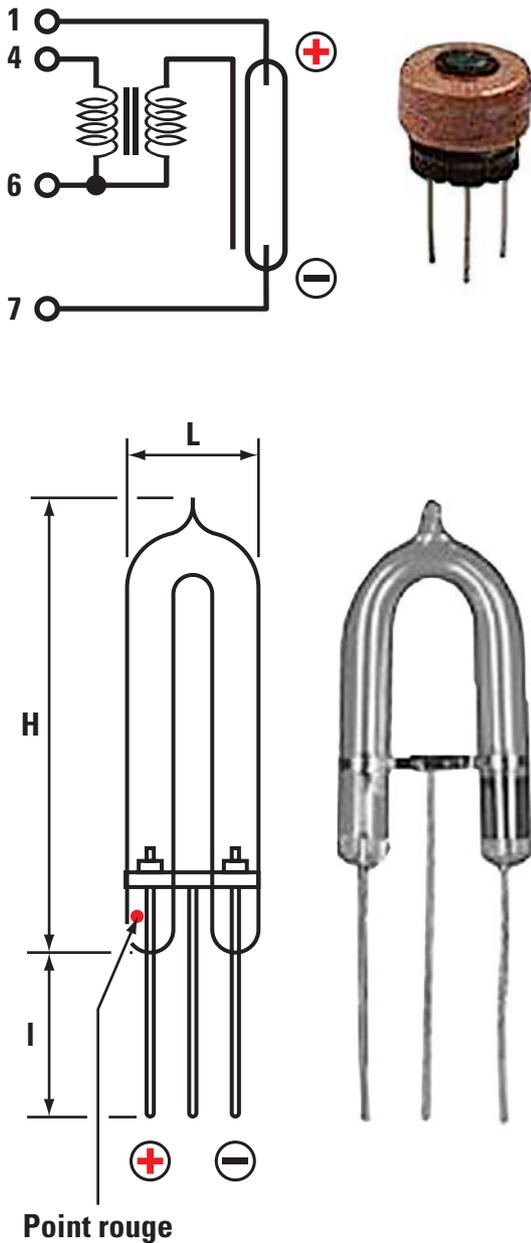
Figure 1: Les ampoules au xénon.
