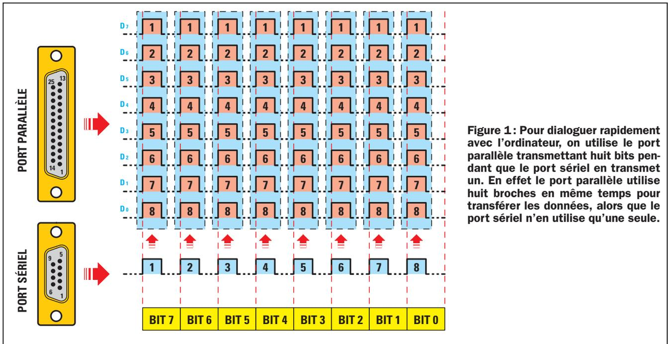
Figure 1 : Pour dialoguer rapidement avec l'ordinateur, on utilise le port parallèle transmettant huit bits pendant que le port sériel en transmet un. En effet le port parallèle utilise huit broches en même temps pour transférer les données, alors que le port sériel n'en utilise qu'une seule.
