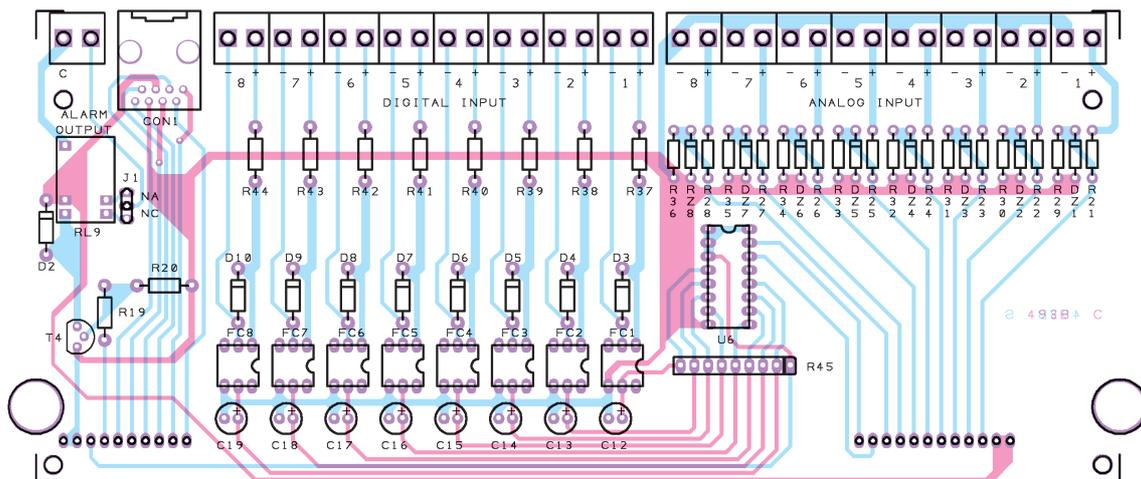
Figure 6a: Schéma d'implantation des composants de la platine B du contrôleur domotique par l'Internet.
