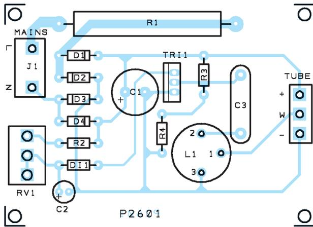
Figure 3a : Schéma d'implantation des composants du stroboscope. Trois fois rien pour beaucoup de plaisir!
