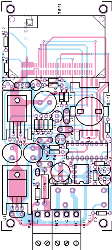
Figure 4a: Schéma d'implantation des composants de la platine de l'ouvre-porte.
