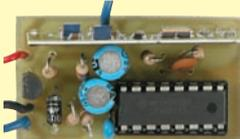
Ce kit est un émetteur radio codé, intégré dans un détecteur, qui sera chargé de transférer le signal d'alarme à une centrale anti-accident/antivol fonctionnant par radio (ET423 par exemple). La centrale enverra cette alarme par téléphone grâce à un transmetteur spécialisé (ET420 par exemple). Ce kit est facilement adaptable à n'importe quel détecteur d'incendie, de débordement de liquide ou de fuite de gaz.
