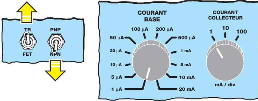
Figure 6 : Pour tester un quelconque transistor, vous devez disposer les boutons de commande du traceur de courbe dans ces positions. TR/FET sur TR, PNP/NPN sur la polarité du transistor que vous voulez contrôler, bouton du Courant de base sur 1 µA et bouton du Courant de collecteur sur la position indiquée par les figures 3, 4 et 5.
