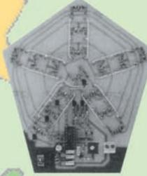
Créé pour les fêtes de Noël, ce kit représente une étoile illuminée. Le mouvement lumineux débute au centre de l'étoile pour se déplacer vers l'extérieur. De plus, une alternance de couleurs est créée de façon à passer du rouge au jaune puis au vert. Avec alim.
