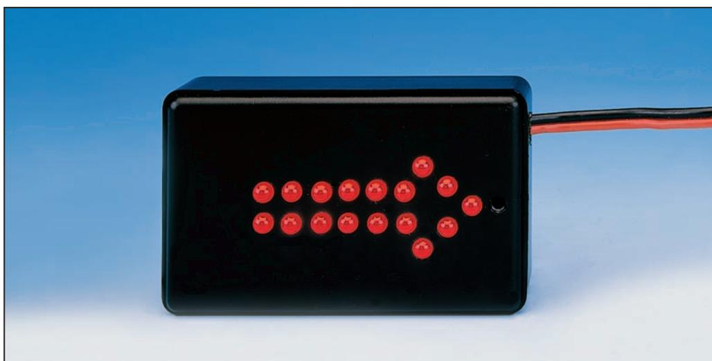
Figure 1: Parfois, peu de composants suffisent pour réaliser de ces montages très simples qui ont la faveur des jeunes électroniciens en herbe. Avec seulement deux circuits intégrés et une poignée de LED, vous pourrez réaliser cette flèche lumineuse à balayage variable.
