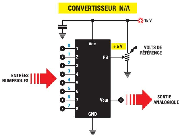
Figure 15: Si, sur la broche Réf d'un convertisseur N/A, on applique une tension de référence de 6 V, sur la broche V-out vous pourrez prélever une tension de 6 V seulement quand sur les 8 broches d'entrée, à gauche, est appliqué un signal binaire 1111 - 1111 correspondant au nombre décimal 255.
