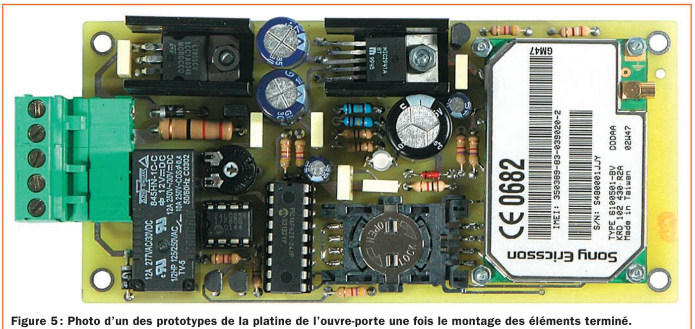
Figure 5: Photo d'un des prototypes de la platine de l'ouvre-porte une fois le montage des éléments terminé.
