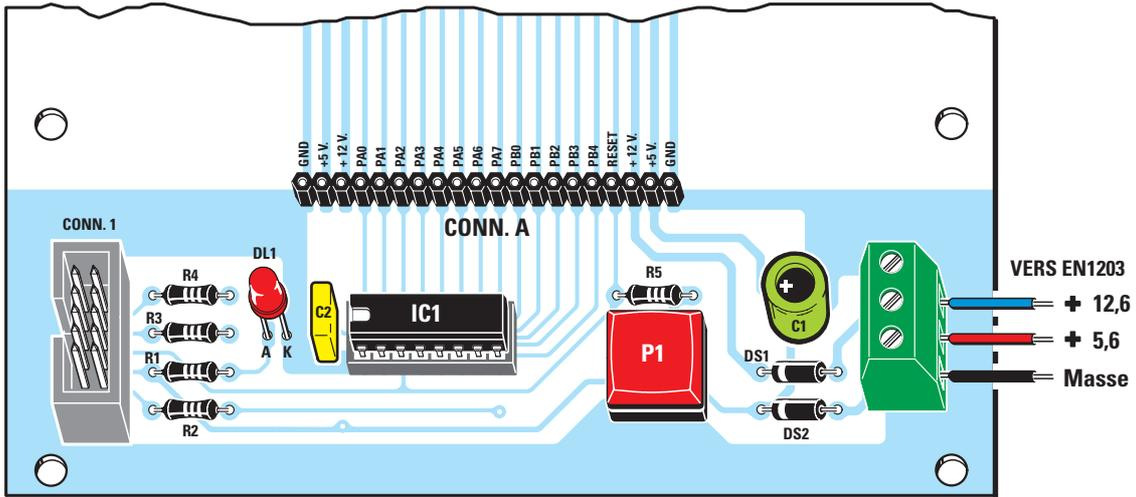
Figure 5: Au bornier à trois pôles du bus EN1547 (que nous construirons dans la deuxième partie de la Leçon), voir figure 6, vous devrez relier les fils +12,6 V, masse et +5,6 V venant de l'étage d'alimentation EN1203 (que nous construirons aussi dans la deuxième partie de la Leçon).
