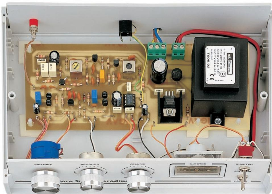
**Figure 382 :** Installation de la platine dans le boîtier plastique. Elle est fixée au fond horizontal du boîtier par six entretoises autocollantes. Avant de fixer les potentiomètres d'accord et de volume en face avant, raccourcissez leurs axes afin de pouvoir ensuite monter les boutons de manière à les tenir le plus près possible de la surface du panneau en aluminium.
