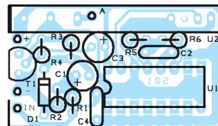
Figure 5a : Schéma d'implantation des composants de la platine de l'émetteur radio pour détecteur de fumée.
