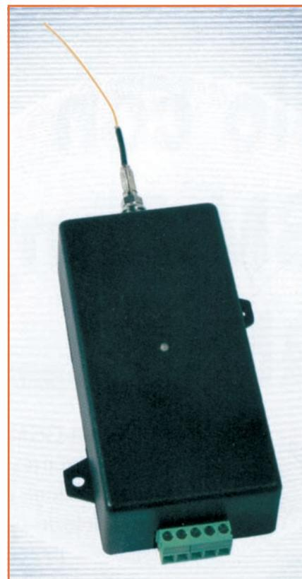
**Figure 1 :** Nous avons utilisé comme antenne un morceau de fil rigide de 8,5 cm monté sur une prise mâle FME. Si le champ de réception est très faible, il vaut mieux utiliser une antenne extérieure bibande du commerce, car elle aura un gain bien supérieur.
