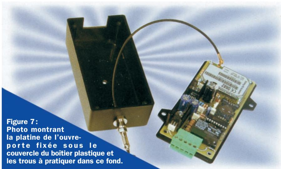
Figure 7 : Photo montrant la platine de l'ouvre-porte fixée sous le couvercle du boîtier plastique et les trous à pratiquer dans ce fond.
