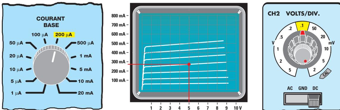
Figure 17: Si en déplaçant le bouton Courant de base de 100 à 200 µA vous voyez que les sept courbes sont correctement espacées, sachant que le bouton Courant de collecteur est sur 100 mA/div, vous devez vous rappeler que chaque carreau vertical correspond alors à un courant de collecteur de 100 - 200 - 300 - 400 - 500 - 600 - 700 - 800 mA.
