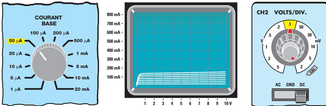
Figure 15: Pour tester les transistors de forte puissance, vous devez mettre le bouton Courant de collecteur sur 100 mA/div et le bouton Courant de base sur 50 µA, enfin vous devez placer le bouton CH2 (entrée Y) de l'oscilloscope sur 0,1 V/div. Si les courbes sont trop serrées, augmentez le courant de base.
