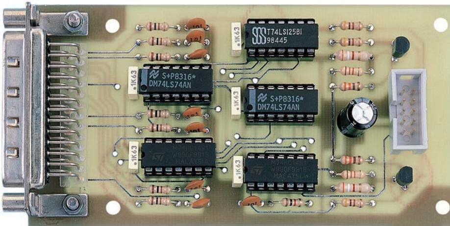
Figure 8 : Photo d'un des prototypes de la platine du programmeur EN1546. Le CONNO à vingt-cinq pôles, à gauche, est à relier au port parallèle de l'ordinateur et le CONN1, à droite, au bus EN1547 (voir figure 9a et, dans la deuxième partie de cette même leçon, figure 10a).
