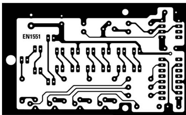
Figure 4b-2: Dessin, à l'échelle 1:1, du circuit imprimé de la flèche lumineuse à balayage variable, côté soudures.
