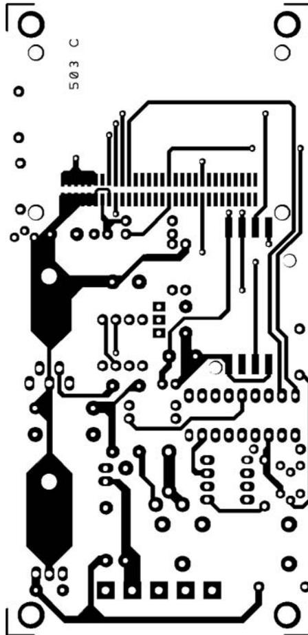
Figure 4b-1: Dessin, à l'échelle 1, du circuit imprimé double face à trous métallisés de l'ouvre-porte, côté composants.
