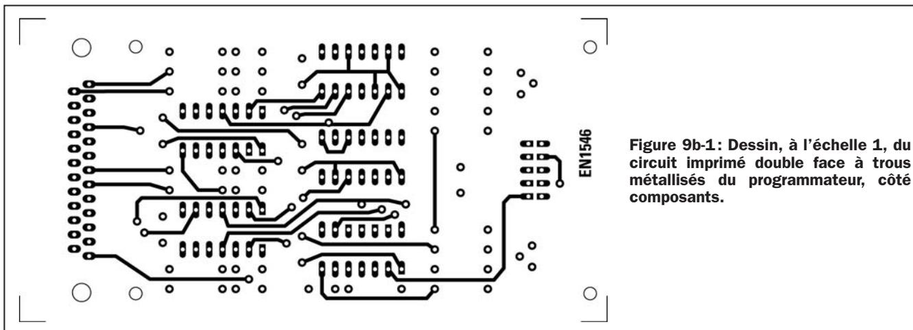
Figure 9b-1: Dessin, à l'échelle 1, du circuit imprimé double face à trous métallisés du programmeur, côté composants.
