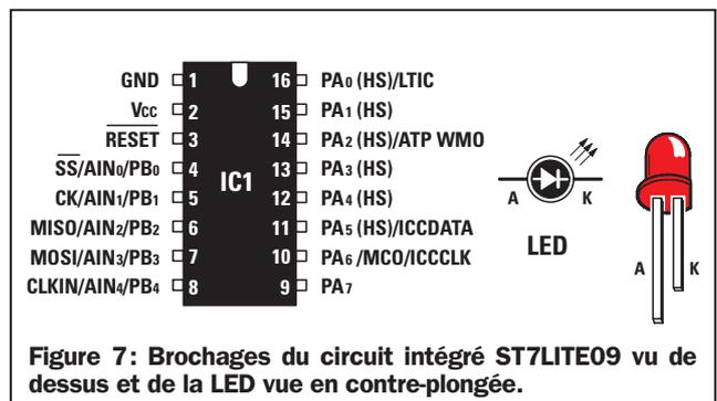
Figure 7: Brochages du circuit intégré ST7LITE09 vu de dessus et de la LED vue en contre-plongée.
