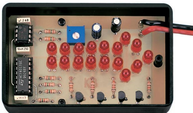
Figure 6 : Montage dans le boîtier plastique de la platine de la flèche lumineuse à balayage variable. Elle est fixée à l'aide de deux vis autotaraudeuses. Le côté du boîtier doit être percé de deux trous rapprochés de 3 mm pour le passage des fils rouge et noir d'alimentation 12 V.
