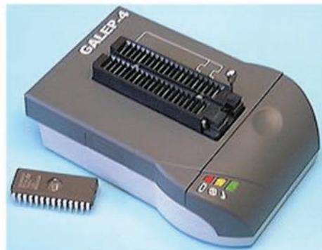
Programmeur **autonome** permettant de programmer **tous** les principaux composants en boîtier DIP (plus de 1800 à ce jour) tels que :
