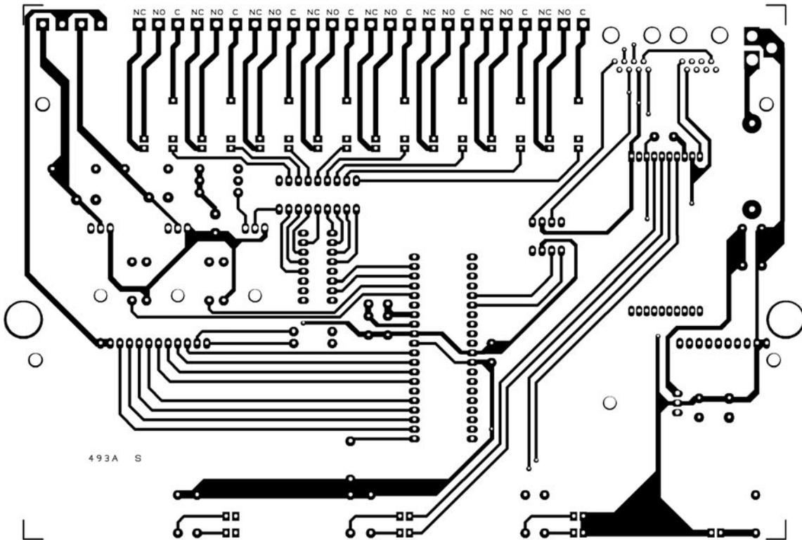
Figure 4b-2 : Dessin du circuit imprimé de la platine A du contrôleur domotique par l'Internet, côté composants.
