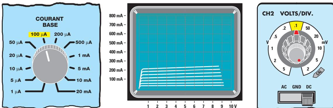
Figure 16: Si en déplaçant le bouton Courant de base de 50 à 100 µA vous voyez que les 7 courbes ne sont pas très lisibles, vous pouvez augmenter le courant de base ou augmenter la sensibilité de l'entrée Y du CH2, en la faisant passer de 0,1 V/div à 50 mV/div.
