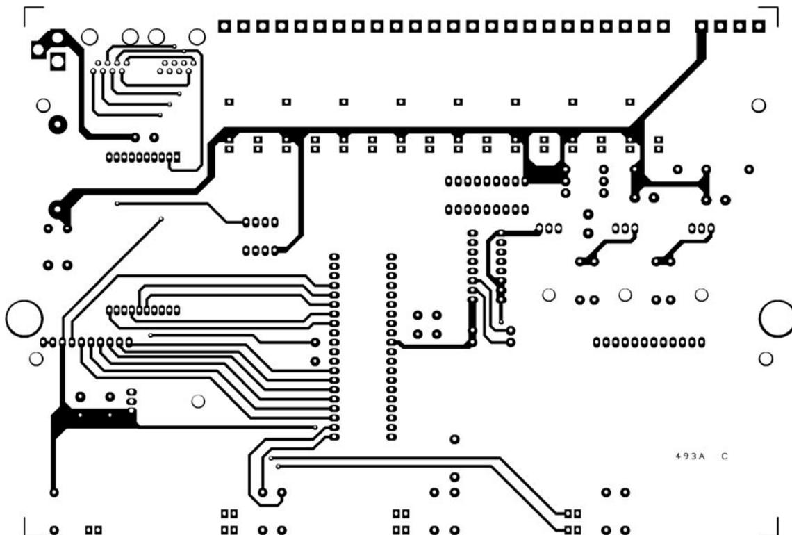
Figure 4b-1: Dessin du circuit imprimé de la platine A du contrôleur domotique par l'Internet, côté soudures.
