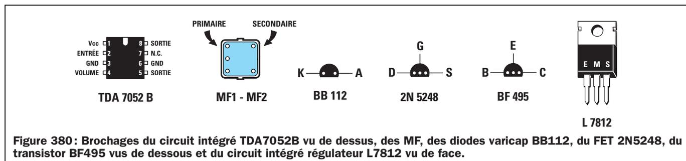
Figure 380: Brochages du circuit intégré TDA7052B vu de dessus, des MF, des diodes varicap BB112, du FET 2N5248, du transistor BF495 vus de dessous et du circuit intégré régulateur L7812 vu de face.
