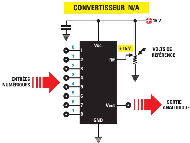
Figure 14: Si, sur la broche Réf d'un convertisseur N/A, on applique une tension de référence de 15 V, sur la broche V-out vous pourrez prélever une tension de 15 V seulement quand sur les 8 broches d'entrée, à gauche, est appliqué un signal binaire 1111 - 1111 correspondant au nombre décimal 255.
