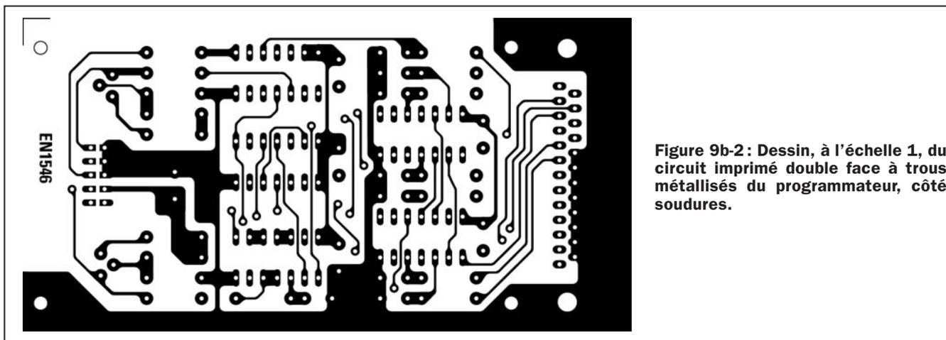
Figure 9b-2: Dessin, à l'échelle 1, du circuit imprimé double face à trous métallisés du programmeur, côté soudures.
