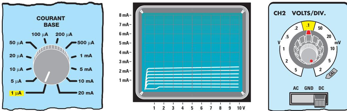
Figure 9 : Pour tester les transistors de très faible puissance, vous devez mettre le bouton Courant de collecteur sur 1 mA/div et le bouton Courant de base sur 1 µA, enfin vous devez placer le bouton CH2 (entrée Y) de l'oscilloscope sur 0,1 V/div. Si les courbes sont trop serrées, passez à la figure suivante.
