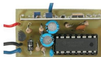
Figure 6 : Photo d'un des prototypes de la platine de l'émetteur radio pour détecteur de fumée.
