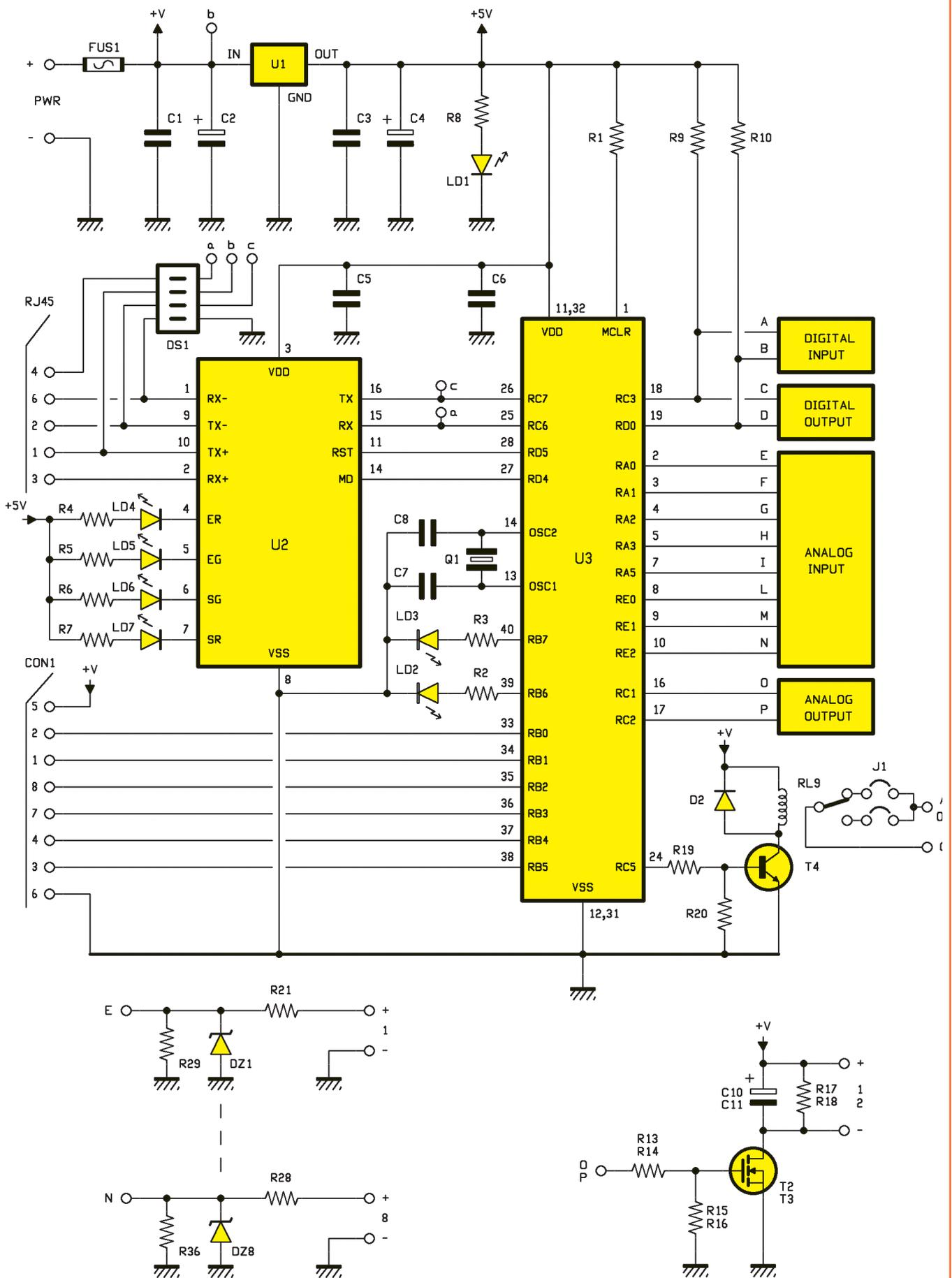
Figure 2: Schéma électrique général du circuit (en haut), de la section d'Input analogique (en bas à gauche, par commodité, seules les deux entrées E et N sont montrées, les autres étant semblables) et de la section d'output analogique (en bas à droite, on n'a représenté qu'une seule sortie, la O).
