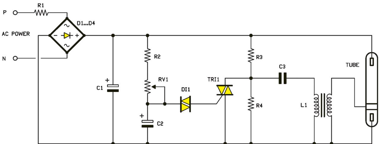
Figure 2: Schéma électrique du feu à éclats ou stroboscope à fréquence réglable.
