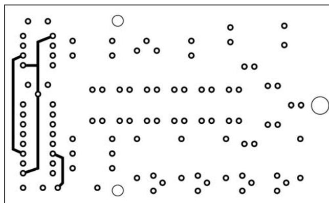
Figure 4b-1: Dessin, à l'échelle 1:1, du circuit imprimé de la flèche lumineuse à balayage variable, côté composants.
