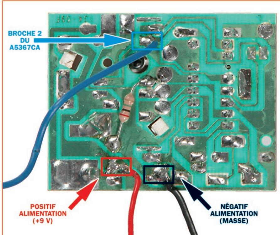
Figure 7: La photo montre les points du circuit du détecteur que nous avons utilisé auxquels il faut se connecter. Les fils rouge et noir sont ceux de l'alimentation (respectivement + et -), le fil bleu est à relier à la broche 2 du A5367CA correspondant au bornier IN du circuit.
