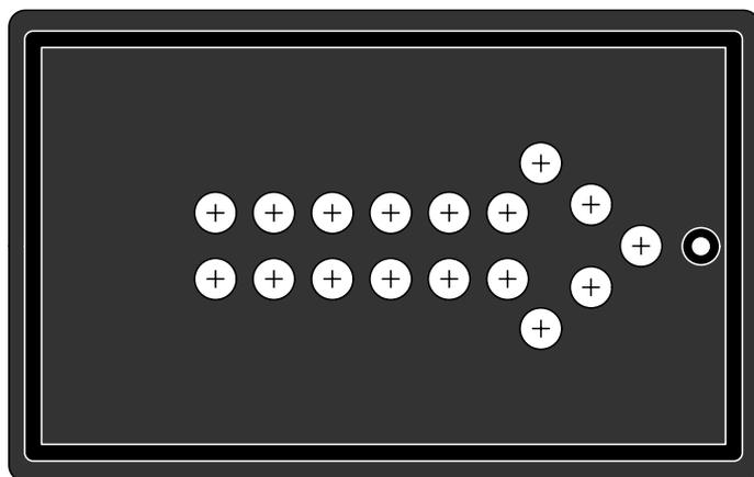
Figure 7 : Gabarit de perçage du couvercle du boîtier plastique. Photocopiez-le et collez-le sur le couvercle. Pratiquer 17 trous de 5 mm de diamètre à l'aide d'un foret à bois à pointe bien centré au milieu de la croix de chaque cercle.
