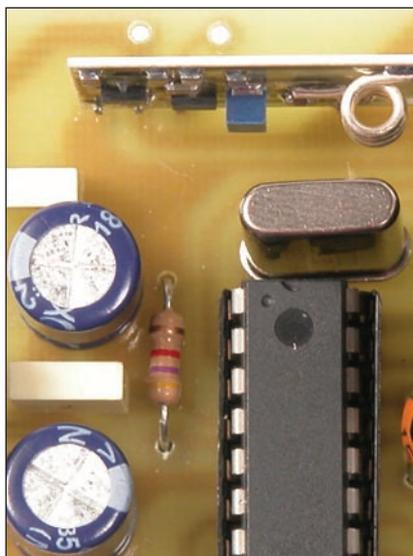
*A gauche, détail concernant le point AERIAL (correspond à la broche 3 de U2) sur le circuit imprimé où souder le fil allant à l'antenne souple extérieure (à droite).*
