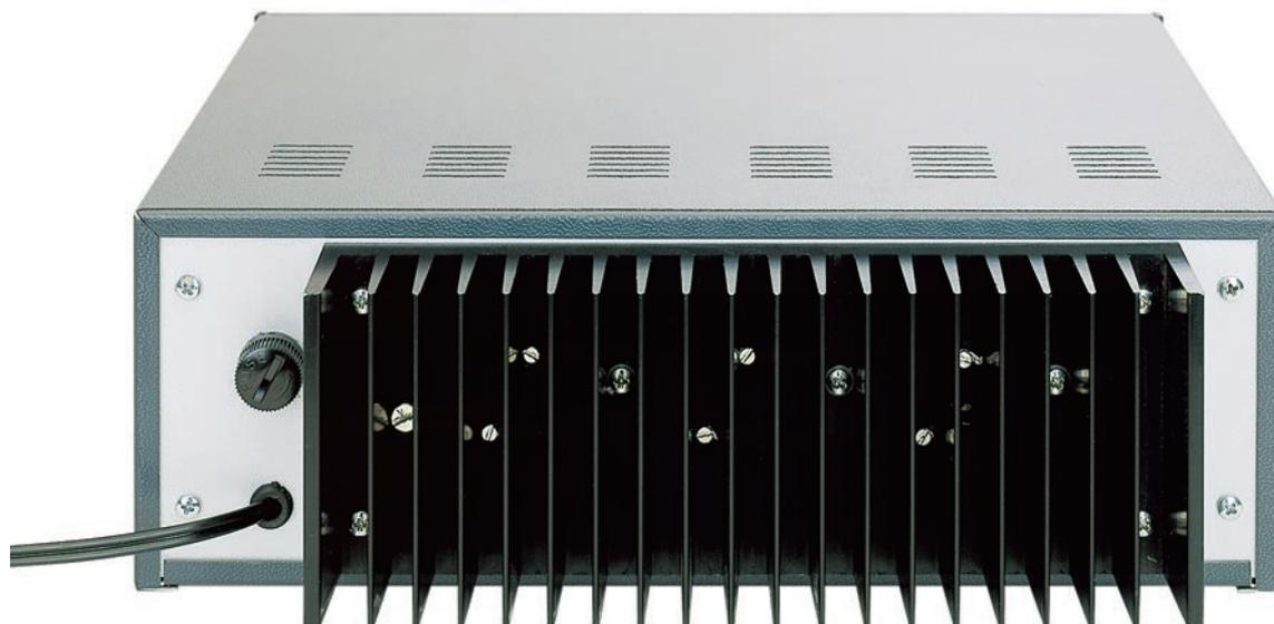
Figure 14: Le dissipateur est fixé par quatre boulons sur le panneau arrière préalablement évidé. Maintenez, en cours d'utilisation, ce dissipateur un peu éloigné de la paroi verticale de la pièce où vous vous trouvez, de même ne mettez rien sur le dissipateur afin que l'air chaud puisse s'évacuer vers le haut. Si ce dissipateur atteint 40 à 50 °C, ne vous en inquiétez pas, cette température est normale.
