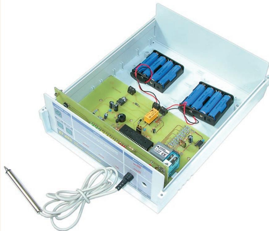
Figure 1: Notre appareil se compose de deux platines, de huit batteries rechargeables de 1,2 V type LR6 et de la poignée d'application. La procédure de sélection du traitement est entièrement paramétrable par un seul poussoir TRIP.
