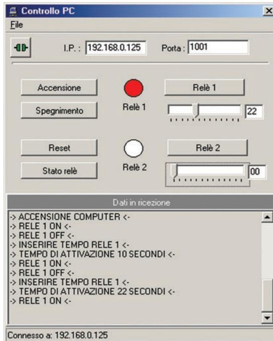
A gauche, la fenêtre de paramétrage des propriétés du port sériel du programme Connection Wizard. Il est nécessaire de régler une vitesse de transmission de 38 400 bauds, aucune parité, 8 bits de données et aucun contrôle de flux. A droite, l'écran du logiciel de gestion CONTROLLO PC. Pour se connecter il faut spécifier l'IP de l'EM100 (ou de l'éventuel routeur) et le port TCP à utiliser.
