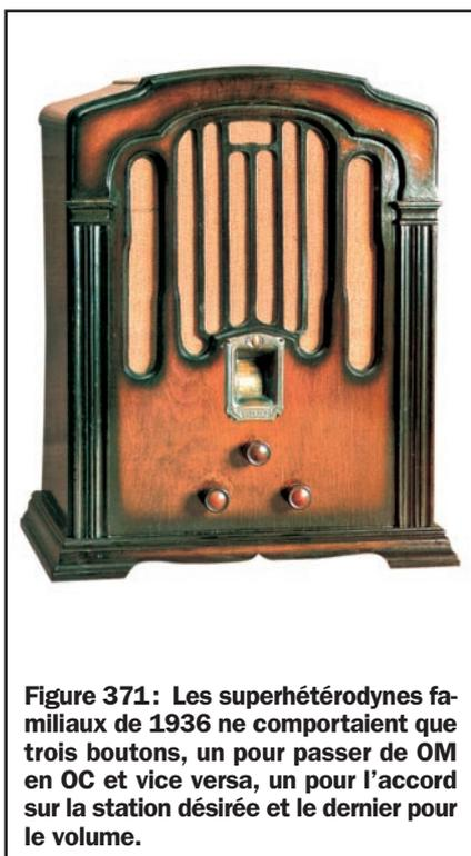
**Figure 371:** Les superhétérodynes familiaux de 1936 ne comportaient que trois boutons, un pour passer de OM en OC et vice versa, un pour l'accord sur la station désirée et le dernier pour le volume.
