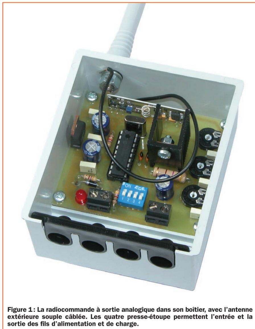
**Figure 1:** La radiocommande à sortie analogique dans son boîtier, avec l'antenne extérieure souple câblée. Les quatre presse-étoupe permettent l'entrée et la sortie des fils d'alimentation et de charge.
