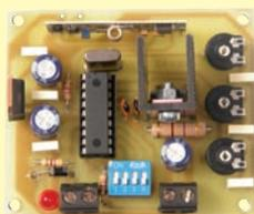
Cette radiocommande à auto-apprentissage des codes et sortie analogique, est en mesure de modifier le niveau de tension de sa sortie en fonction de la touche du boîtier de télécommande que l'on vient de presser : idéal pour réaliser des variateurs de lumière commandés à distance, l'appareil permet de paramétrer les tensions de sortie minimale et maximale.
