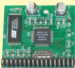
Ce circuit, capable de parler et de comprendre les commandes vocales, est réalisé à partir d'un microcontrôleur à huit bits RSC364 dont le fonctionnement ne nécessite qu'une mémoire "flash" de 2 Mo, un quartz et quelques autres composants, tient sur une petite carte de 4 x 4 cm.
