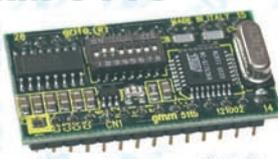
; 2K EEPROM; 3 Temporisateurs Compteurs et 2 sections de Temporisateur Compteur à haute fonctionnalité (PWM, comparaison); 18 lignes d'E/S TTL; 8 A/N 10 bits; RS 232 ou TTL; 1 LED d'état; Commutateur DIP de configuration; etc.
