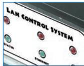
L'appareil, utilisant le module Ethernet EM100 de Tibbo Technology, permet de commander à distance par l'Internet le "reset", la mise en route et l'extinction d'un PC. La liaison à l'ordinateur se fait par deux relais connectés aux bornes PWR et RST de la carte-mère. Il est même envisageable de gérer les deux relais à distance en fonction de votre propre application.
