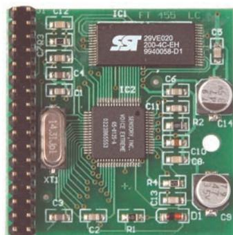
Figure 3: Photo d'un des prototypes de la platine du module Voice Extreme.
