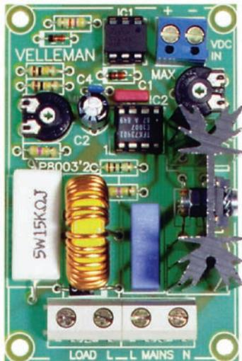
**Figure 4 :** Photo d'un des prototypes de la platine du variateur.
