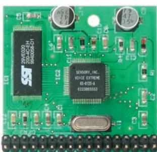
Le programmeur/platine de démonstration ET453 est capable de programmer et de travailler avec le module original Sensory (code VEM - Voice Extreme Module) comme avec le module ET455. Les deux modules sont compatibles en dimensions et broche à broche. La seule diffé-
