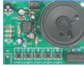
Ce circuit, capable de parler et de comprendre les commandes vocales, est réalisé à partir d'un microcontrôleur à huit bits RSC364 dont le fonctionnement ne nécessite qu'une mémoire "flash" de 2 Mo, un quartz et quelques autres composants, tient sur une petite carte de 4 x 4 cm.
