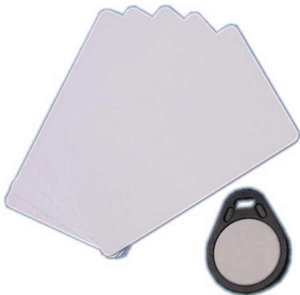
Figure 4 : Les cartes à transpondeur sont disponibles au format badge ISO7816 (carte de crédit) ou, plus commode, au format porte-clé.
