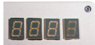
Figure 5: Les 4 évidements rectangulaires du couvercle laissent affleurer les 4 afficheurs à 7 segments.
