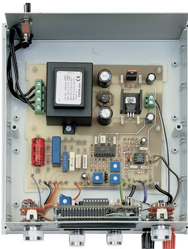
Figure 20 : Le montage dans le boîtier plastique. Comme le montre la photo, l'interrupteur M/A est monté à l'arrière. Si les soudures sont bien faites (ni court-circuit entre pistes ou pastilles ni soudure froide collée), le circuit fonctionne du premier coup.
