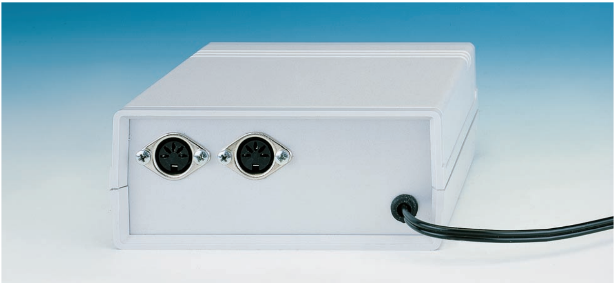
Figure 13: Le panneau arrière reçoit les deux prises destinées à recevoir les fiches des deux capteurs et laisse entrer le cordon secteur 230 V à travers son passe-fils.
