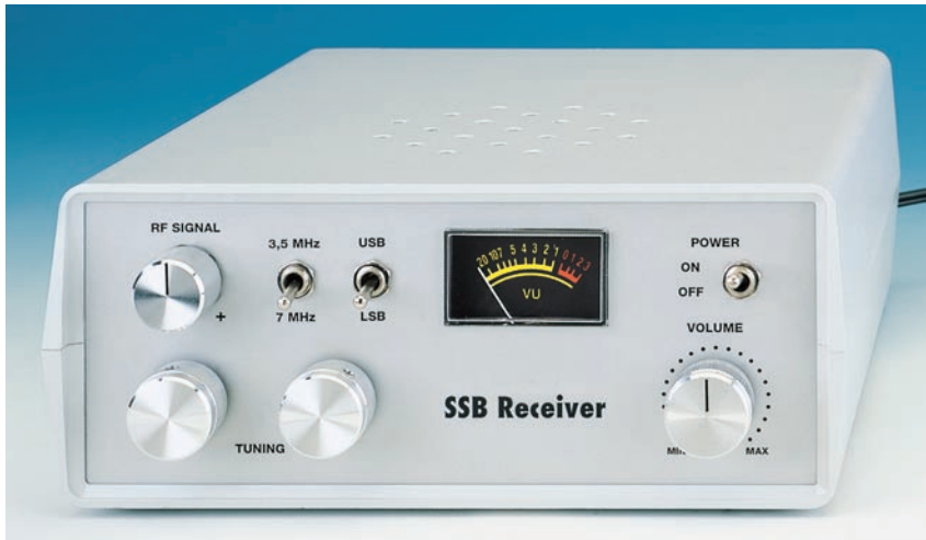
Figure 11: Le récepteur BLU bibande (3,5 et 7 MHz) dans son boîtier prêt à fonctionner. Pour l'accord ("TUNING") nous utilisons deux potentiomètres, un pour l'accord normal, l'autre pour l'accord fin (figure 20). Le potentiomètre R1 "RF SIGNAL" (signal HF), sert à atténuer les signaux trop forts.
