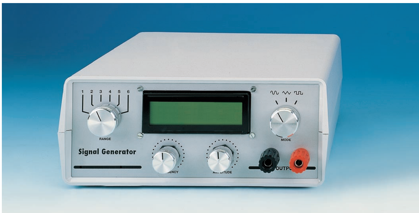
Figure 1 : Photo de l'appareil complet dans son boîtier plastique. Ce générateur BF avec fréquencemètre numérique à afficheur LCD fournit les trois formes d'ondes les plus communes : sinusoïdale, triangulaire et carrée. Pour obtenir une fréquence stable, le générateur doit être allumé 15 minutes avant l'utilisation afin de permettre à IC1 de se stabiliser.
