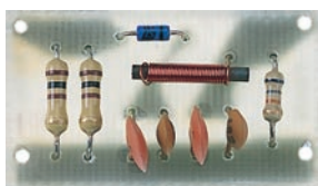
Figure 313: Photo d'un des prototypes de la platine de la sonde de charge.
