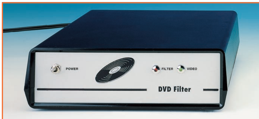
Figure 1: Ce circuit, conçu pour éliminer les “virus” anti-copie présents sur les DVD, pourra être installé dans un élégant boîtier plastique. Sur le panneau arrière en aluminium sérigraphié sortent les deux prises péritel SCART et le cordon secteur 230 V. En face avant sont présents l’interrupteur M/A et les deux LED de signalisation : verte pour signaler que le circuit fonctionne et rouge pour signaler la détection d’un “virus” et son élimination immédiate.
