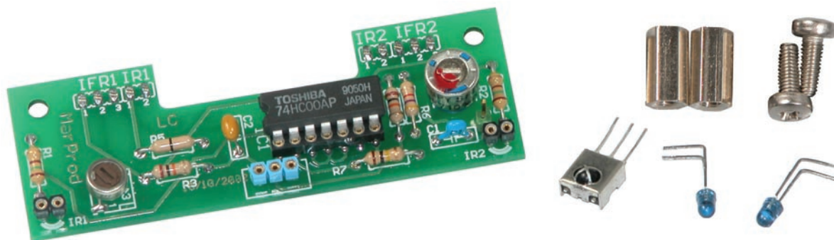
Figure 7: La platine détecteur à infrarouges avec ses LED émettrices, son récepteur et le nécessaire de montage sur la carte-mère.
