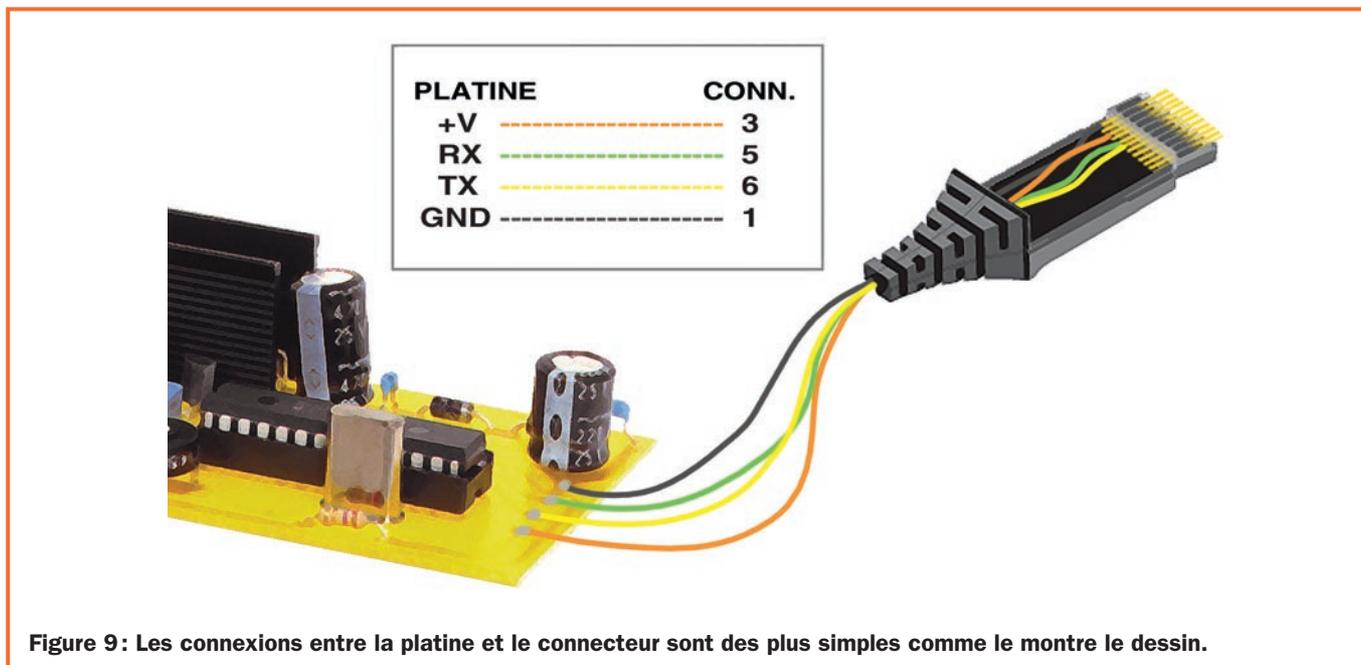
**Figure 9 :** Les connexions entre la platine et le connecteur sont des plus simples comme le montre le dessin.
