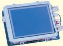
1 Vpp - 75 Ω. Alim. : 12 Vcc. Conso. : 7 W. Dimensions : 122x84x36 mm. T° de fonctionnement : -5 °C à +40 °C. Durée mini. de vie : 4 000 h.
