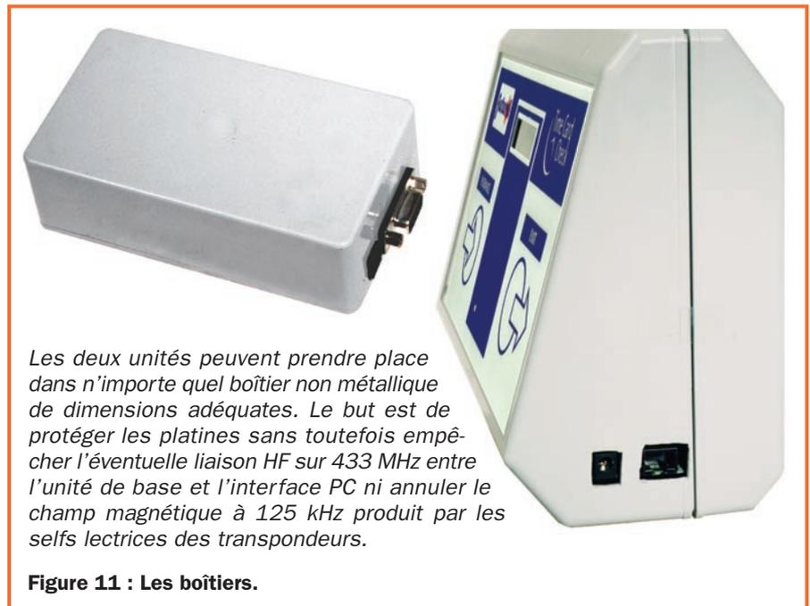
*Les deux unités peuvent prendre place dans n'importe quel boîtier non métallique de dimensions adéquates. Le but est de protéger les platines sans toutefois empêcher l'éventuelle liaison HF sur 433 MHz entre l'unité de base et l'interface PC ni annuler le champ magnétique à 125 kHz produit par les selfs lectrices des transpondeurs.*
