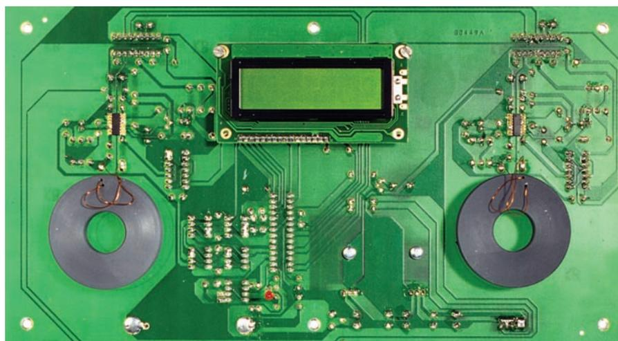
**Figure 8b :** Photo d'un des prototypes de la platine de base de l'unité principale pointeuse pour PC. Attention certains composants sont montés côté soudures (photo du bas) : platine afficheur, selfs transpondeurs, LED et circuits intégrés U2270 (lire texte).
