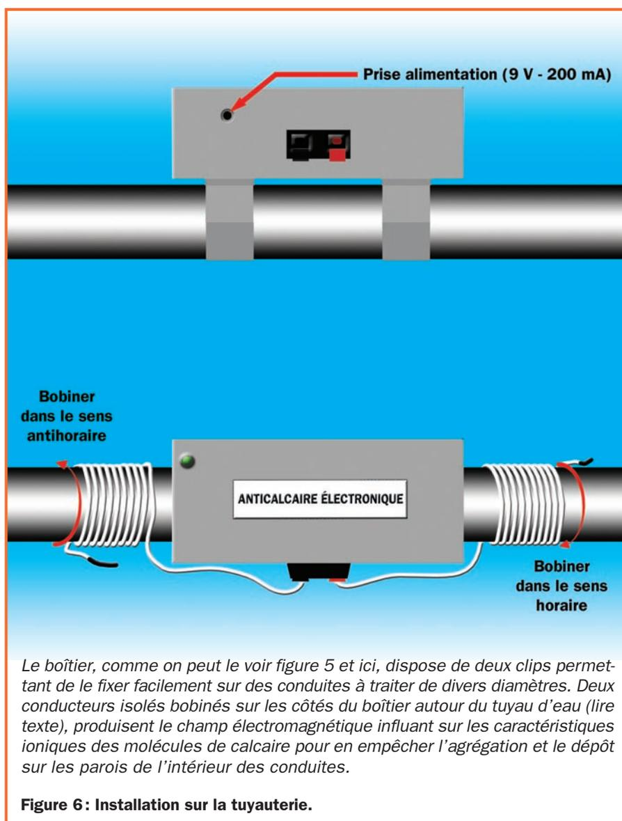
Le boîtier, comme on peut le voir figure 5 et ici, dispose de deux clips permettant de le fixer facilement sur des conduites à traiter de divers diamètres. Deux conducteurs isolés bobinés sur les côtés du boîtier autour du tuyau d'eau (lire texte), produisent le champ électromagnétique influant sur les caractéristiques ioniques des molécules de calcaire pour en empêcher l'agrégation et le dépôt sur les parois de l'intérieur des conduites.
