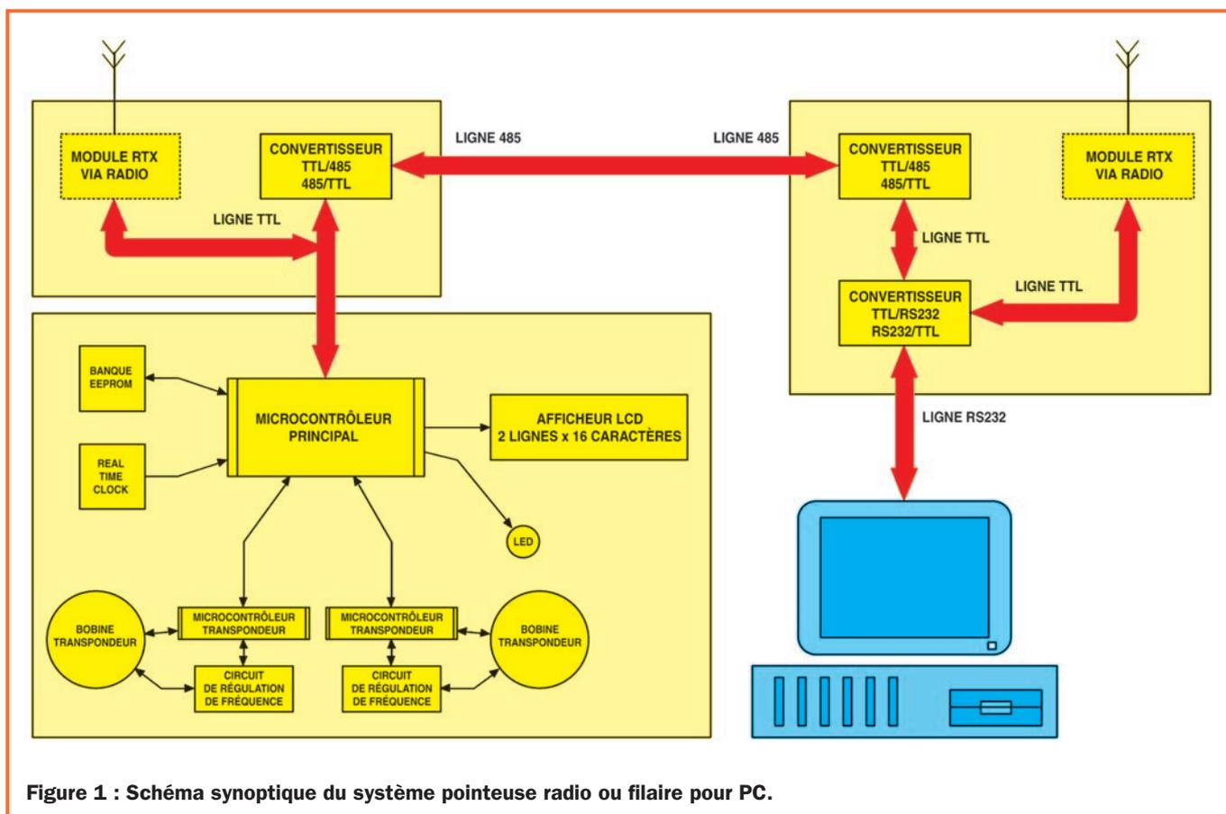
Figure 1 : Schéma synoptique du système pointeuse radio ou filaire pour PC.
