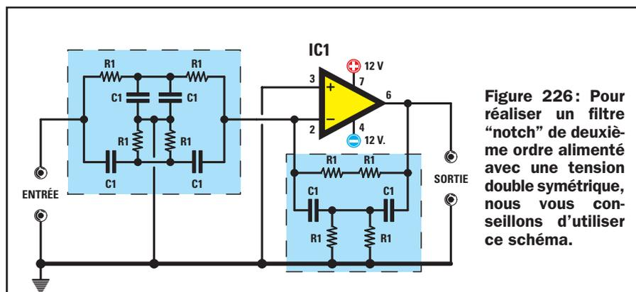
**Figure 226:** Pour réaliser un filtre "notch" de deuxième ordre alimenté avec une tension double symétrique, nous vous conseillons d'utiliser ce schéma.
