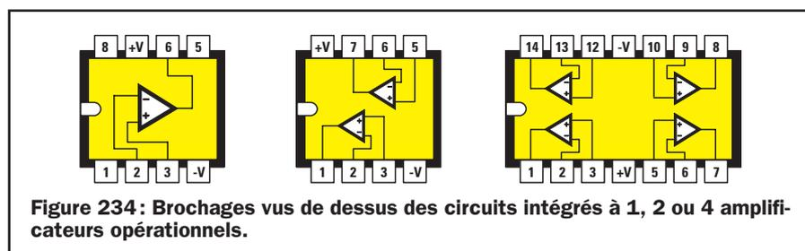
Figure 234 : Brochages vus de dessus des circuits intégrés à 1, 2 ou 4 amplificateurs opérationnels.
