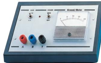
Pour vérifier si la prise de terre d'une installation électrique est dans les normes et surtout si elle est efficace, il faut la mesurer et, pour ce faire, on doit disposer d'un instrument de mesure appelé Mesureur de Terre ou "Ground-Meter".
