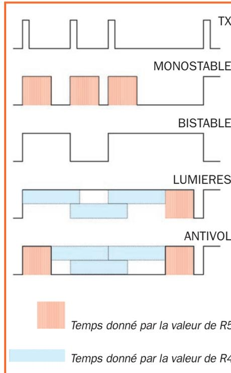
Le graphique illustre les quatre modes de fonctionnement en cas d'un hypothétique signal émis (TX). Les parties colorées représentent les durées données par les potentiomètres R5 (définissant la durée de relaxation en mode monostable) et R4 (indiquant la durée minimale entre un signal et le suivant en modes "spéciaux"). Le paramétrage des modes disponibles est effectué grâce au micro-interrupteur DS1, présent sur le récepteur, comme le montre le tableau ci-dessous.
