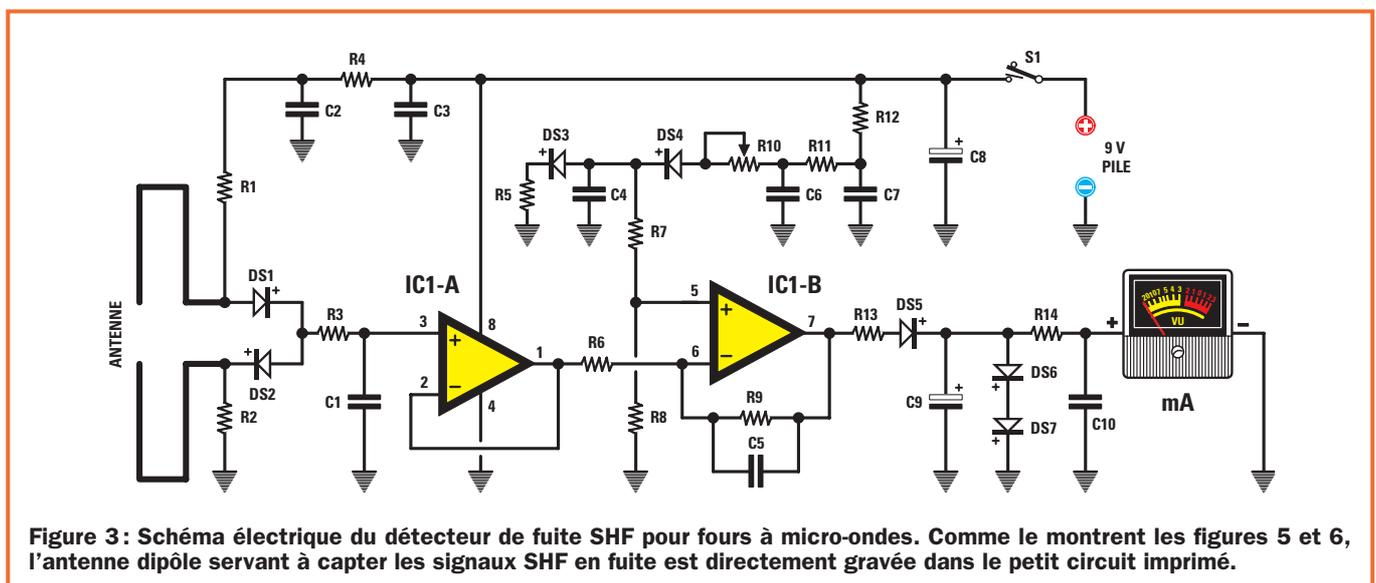
Figure 3: Schéma électrique du détecteur de fuite SHF pour fours à micro-ondes. Comme le montrent les figures 5 et 6, l'antenne dipôle servant à capter les signaux SHF en fuite est directement gravée dans le petit circuit imprimé.
