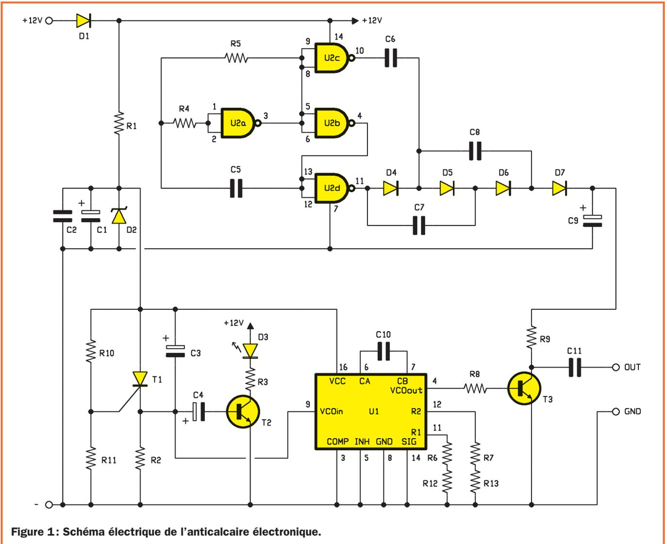
Figure 1: Schéma électrique de l'anticalcaire électronique.
