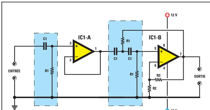
**Figure 236 :** Pour réaliser un filtre passe-haut de troisième ordre capable d'atténuer de 18 dB toutes les octaves inférieures, il suffit de mettre en série un filtre de 1er ordre (figure 211) et un filtre de deuxième ordre (figure 224). Pour calculer la fréquence de coupure en Hz ou bien les valeurs de C1 ou de R1, on utilise les formules écrites au tableau noir de la figure 237.
