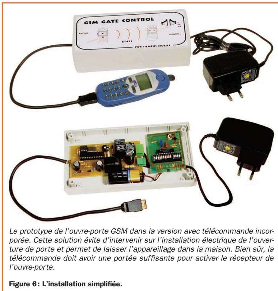
Le prototype de l'ouvre-porte GSM dans la version avec télécommande incorporée. Cette solution évite d'intervenir sur l'installation électrique de l'ouverture de porte et permet de laisser l'appareillage dans la maison. Bien sûr, la télécommande doit avoir une portée suffisante pour activer le récepteur de l'ouvre-porte.
