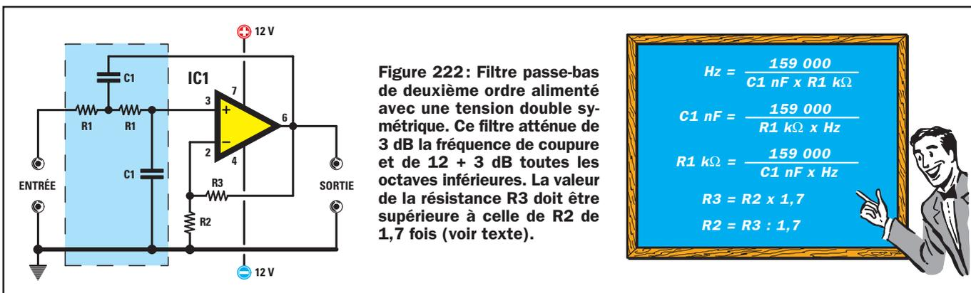
Figure 222: Filtre passe-bas de deuxième ordre alimenté avec une tension double symétrique. Ce filtre atténue de 3 dB la fréquence de coupure et de 12 + 3 dB toutes les octaves inférieures. La valeur de la résistance R3 doit être supérieure à celle de R2 de 1,7 fois (voir texte).
