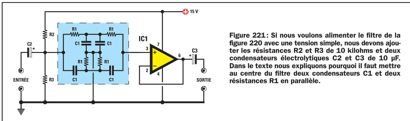
Figure 221: Si nous voulons alimenter le filtre de la figure 220 avec une tension simple, nous devons ajouter les résistances R2 et R3 de 10 kilohms et deux condensateurs électrolytiques C2 et C3 de 10 µF. Dans le texte nous expliquons pourquoi il faut mettre au centre du filtre deux condensateurs C1 et deux résistances R1 en parallèle.
