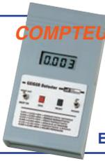
Cet appareil va vous permettre de mesurer le taux de radioactivité présent dans l'air, les aliments, l'eau, etc. Le kit est livré complet avec son boîtier sérigraphié.
