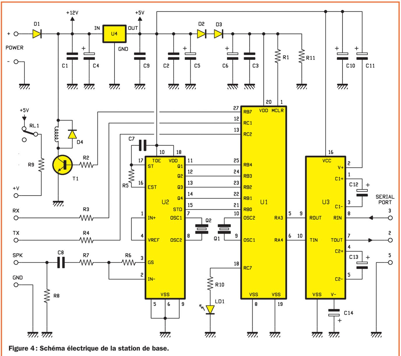
Figure 4 : Schéma électrique de la station de base.
