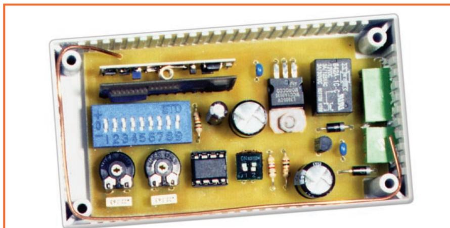
**Figure 11:** Sur le RX, l'antenne est un simple morceau de fil de cuivre de 17 cm de longueur, à souder au point "AERIAL", replié dans le boîtier.
