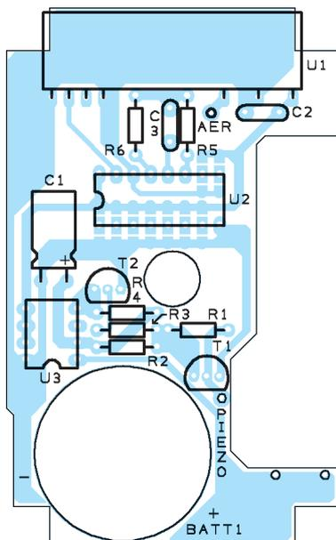
Figure 6a: Schéma d'implantation des composants du TX de la télécommande automatique.
