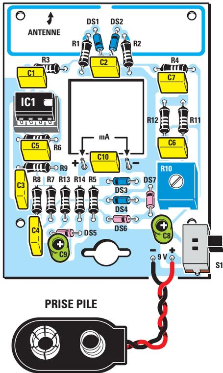
**Figure 5a :** Schéma d'implantation des composants du détecteur de fuite SHF. Dans l'évidement central, on insérera le galvanomètre  $\mu$ A-mètre et on soudera ses cosses aux deux picots disposés de part et d'autre de C10.
