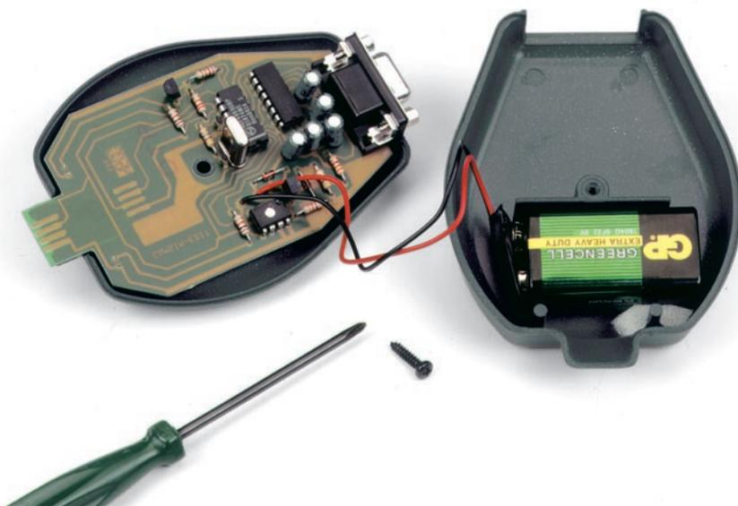
Figure 26: Avant de remplacer la pile 6F22 de 9 V, n'oubliez pas de déconnecter le lecteur/enregistreur du câble de connexion. La pile doit être bien sûr montée en respectant la polarité.
