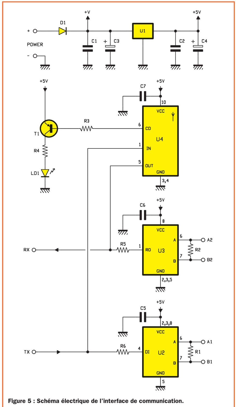
Figure 5 : Schéma électrique de l'interface de communication.
