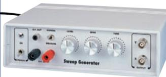
Afin de visualiser sur l'écran d'un oscilloscope la bande passante complète d'un amplificateur Hi-Fi ou d'un préamplificateur ou encore la courbe de réponse d'un filtre BF ou d'un contrôle de tonalité, etc., vous avez besoin d'un bon sweep generator (ou générateur à balayage) comme celui que nous vous proposons ici de construire.
