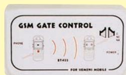
Voici une nouvelle version mise à jour du système d'ouverture de portail commandé par téléphone GSM. Dans cette application, c'est un portable Siemens série 45, plus récent, qui est utilisé. Notre nouvel appareil peut mémoriser 300 usagers et envoyer un SMS de confirmation (à l'utilisateur comme à l'administrateur s'il y en a un) quand un nouveau numéro est habilité ou éliminé. La programmation s'effectue à distance au moyen d'un SMS.
