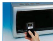
Avec ce détecteur de fuite d'ondes SHF pour four à micro-ondes nous complétons la série de nos instruments de détection destinés à contrôler la qualité des conditions environnementales de notre existence, comme les détecteurs de fuite de gaz, de champs magnétiques et HF, les compteurs Geiger, etc., ayant toujours suscité un vif intérêt de la part de nos lecteurs.
