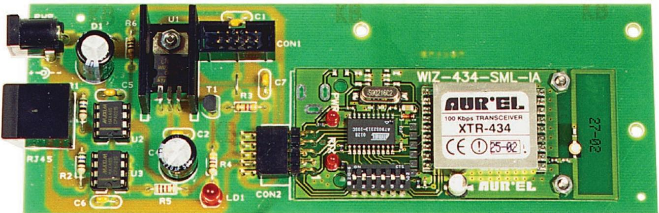
Figure 9b : Photo d'un des prototypes de la platine de communication de l'unité principale pointeuse pour PC.
