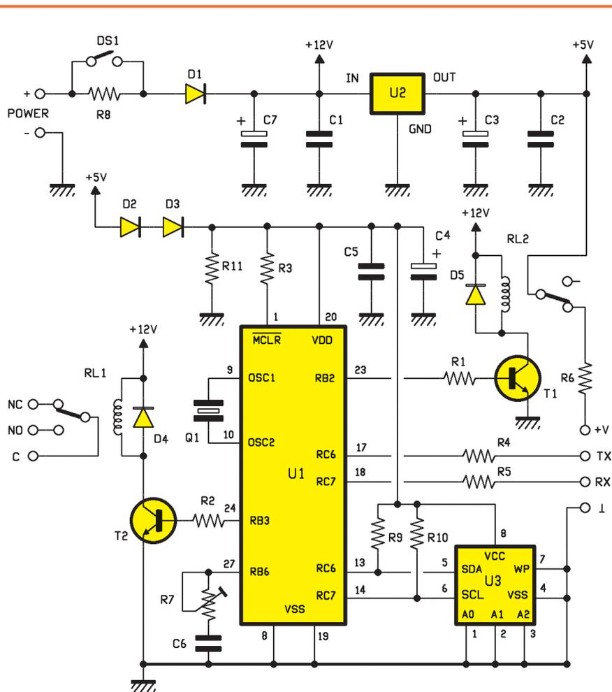
Figure 1 : Schéma électrique de l'ouvre-porte GSM.
