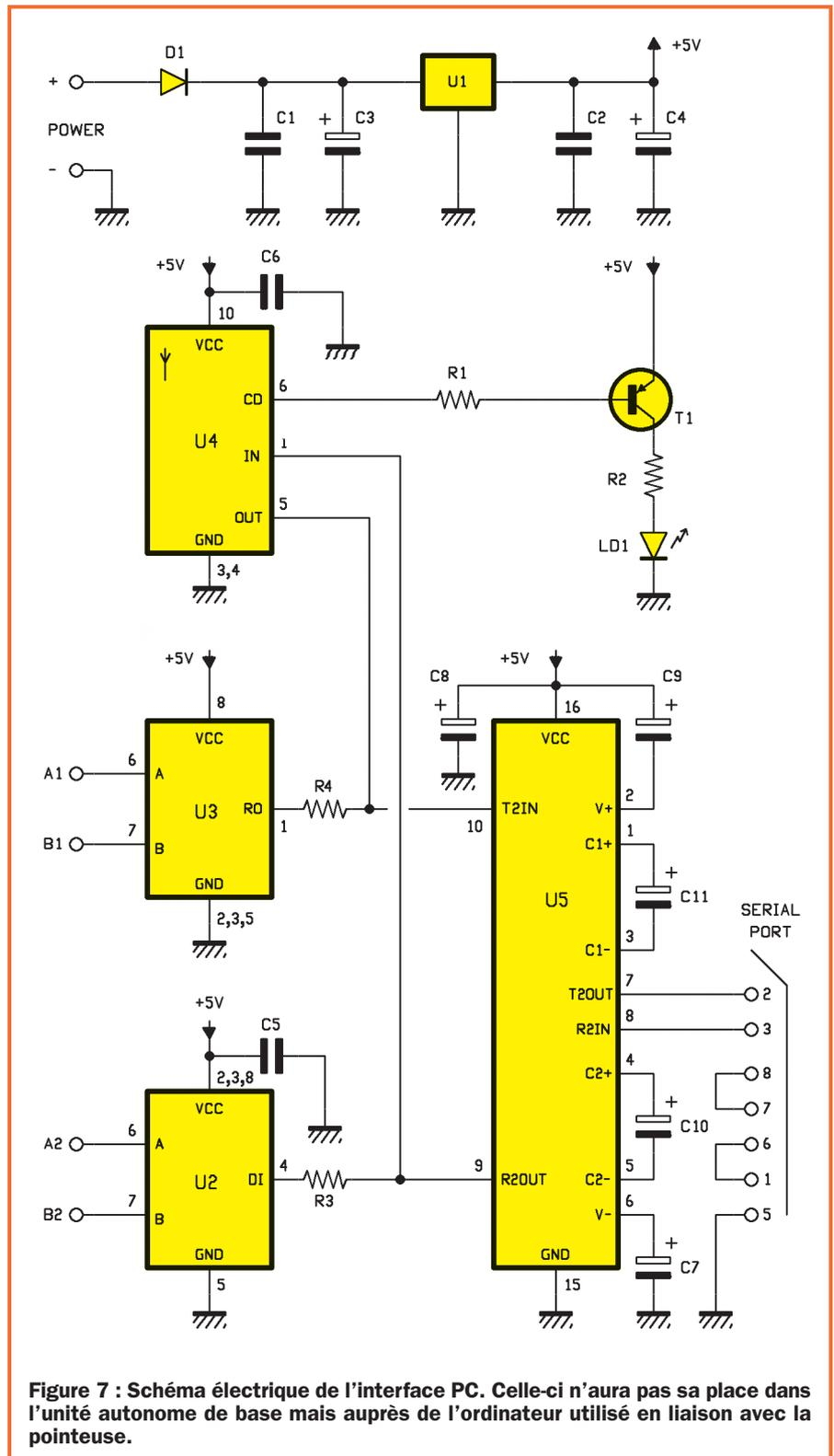
**Figure 7 : Schéma électrique de l'interface PC. Celle-ci n'aura pas sa place dans l'unité autonome de base mais auprès de l'ordinateur utilisé en liaison avec la pointeuse.**
