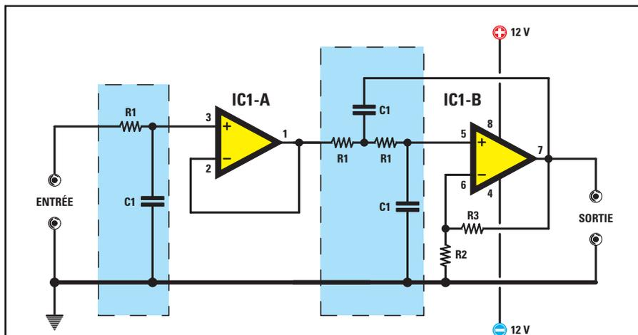
**Figure 235 :** Pour réaliser un filtre passe-bas de troisième ordre capable d'atténuer de 18 dB toutes les octaves supérieures, il suffit de mettre en série un filtre de 1er ordre (figure 209) et un filtre de deuxième ordre (figure 222). Pour calculer la fréquence de coupure en Hz ou bien les valeurs de C1 ou de R1, on utilise les formules écrites sur le tableau noir de la figure 237.
