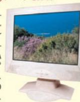
Moniteur de dimensions compact au design moderne. utilisation possible comme moniteur pour ordinateur de vidéosurveillance. Résolution : XGA 1024x768. Angle visuel : 60° droite/gauche 45° haut/bas. Niveau du signal vidéo : 1 Vpp - 75 Ω. Standard : PAL/NTSC. Tension d'alimentation : 12 VDC ± 10 %. Dimensions : 392x327 x53 mm. Poids : 5 200 g. Accessoires : pied, câbles de raccordement, télécommande et alimentation voiture.
