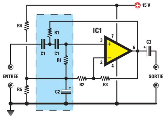
Pour modifier le gain de chaque étage simple, il suffit de faire varier la valeur des deux résistances, celle reliée entre la sortie et la broche non inverseuse et celle reliée entre cette broche et la masse. Si nous amplifions le signal plus que nécessaire, le filtre risque d'auto-osciller: par conséquent nous vous conseillons de respecter les valeurs ohmiques indiquées pour chaque étage simple (figures 229, 230, 231 et 232).
