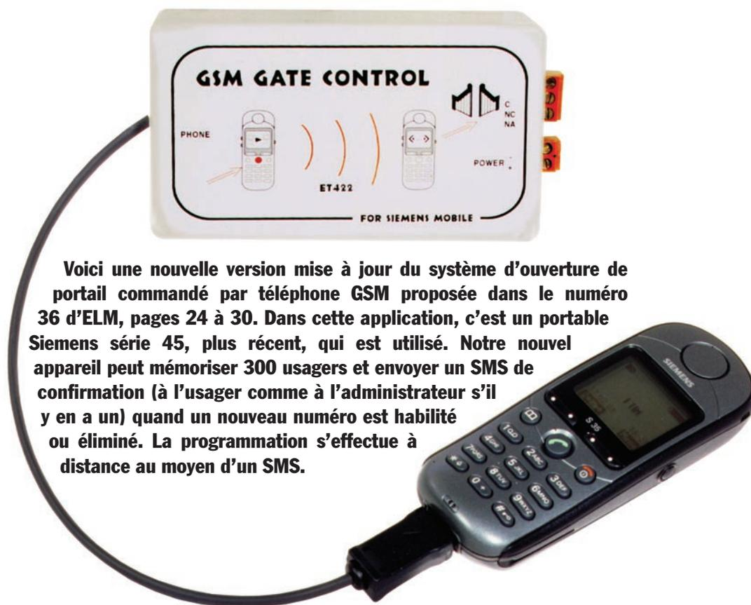
**Voici une nouvelle version mise à jour du système d'ouverture de portail commandé par téléphone GSM proposée dans le numéro 36 d'ELM, pages 24 à 30. Dans cette application, c'est un portable Siemens série 45, plus récent, qui est utilisé. Notre nouvel appareil peut mémoriser 300 usagers et envoyer un SMS de confirmation (à l'usager comme à l'administrateur s'il y en a un) quand un nouveau numéro est habilité ou éliminé. La programmation s'effectue à distance au moyen d'un SMS.**
