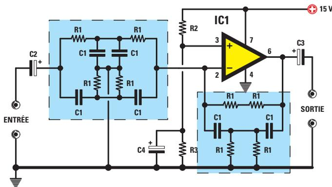
**Figure 228:** Pour alimenter le filtre de la figure 227 avec une tension simple, nous devons ajouter deux résistances de 10 kilohms (R2 et R3) et appliquer dans les positions notées C2, C3 et C4 des condensateurs électrolytiques de 10 µF.
