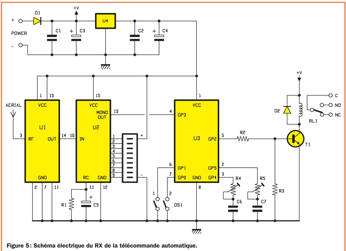
Figure 5: Schéma électrique du RX de la télécommande automatique.
