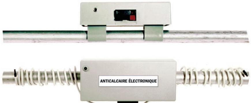
Les dimensions et la forme de la carte sont choisies pour pouvoir l'insérer à l'intérieur du boîtier plastique protégeant l'appareil. Ce boîtier est muni de clips permettant la fixation sur le tuyau d'eau (figure 6).
