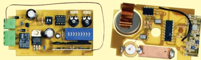
Elle émet périodiquement un signal radio codé quand la personne qui le porte marche. Grâce à des temporisations spécifiques, le récepteur peut être employé pour commander l'ouverture et la fermeture de portes électriques, mais aussi l'activation et la désactivation des systèmes antivol pour voiture et bien d'autres choses encore. Les deux microcontrôleurs sont disponibles déjà programmés en usine.
