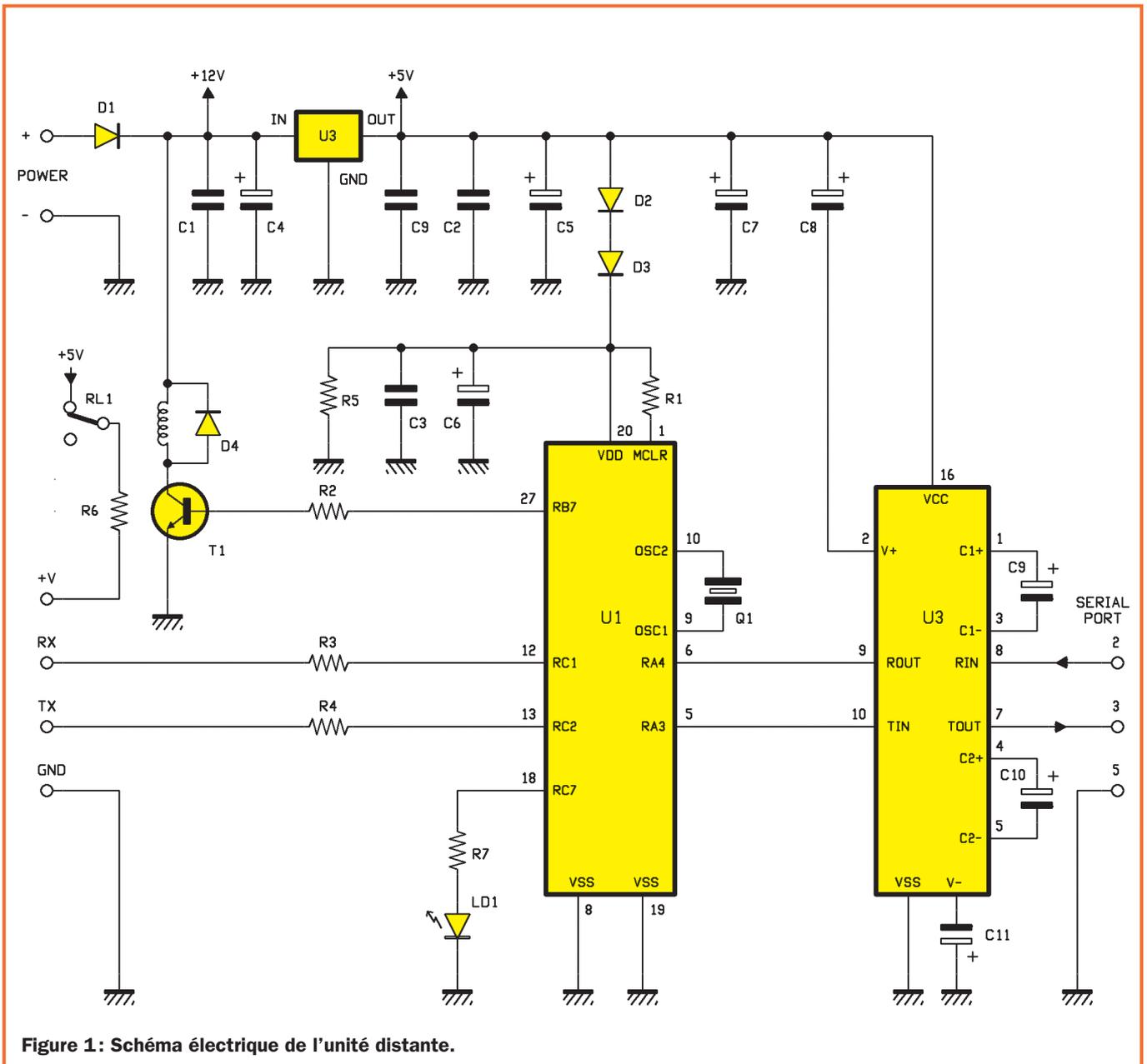
Figure 1: Schéma électrique de l'unité distante.
