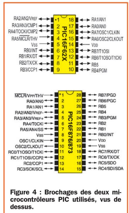
Figure 4 : Broches des deux microcontrôleurs PIC utilisés, vues de dessus.
