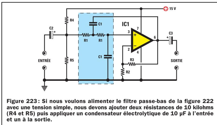
Figure 223: Si nous voulons alimenter le filtre passe-bas de la figure 222 avec une tension simple, nous devons ajouter deux résistances de 10 kilohms (R4 et R5) puis appliquer un condensateur électrolytique de 10 µF à l'entrée et un à la sortie.
