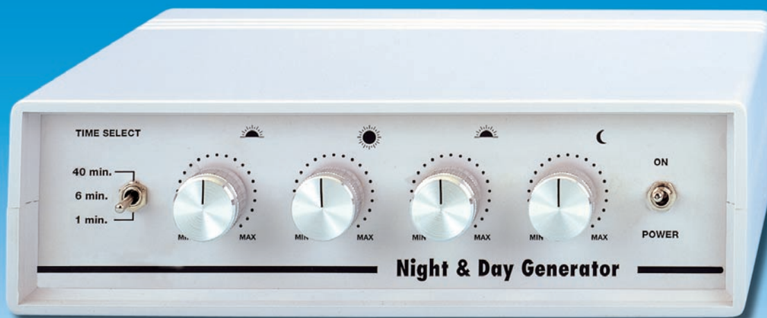
Figure 1: Les 4 boutons en face avant servent à faire varier du minimum au maximum les durées des phases Aube, Jour, Crépuscule et Nuit (figure 2). Grâce à l'inverseur S1, on peut paramétrer les durées maximales de chaque phase à 1, 6 ou 40 minutes.
