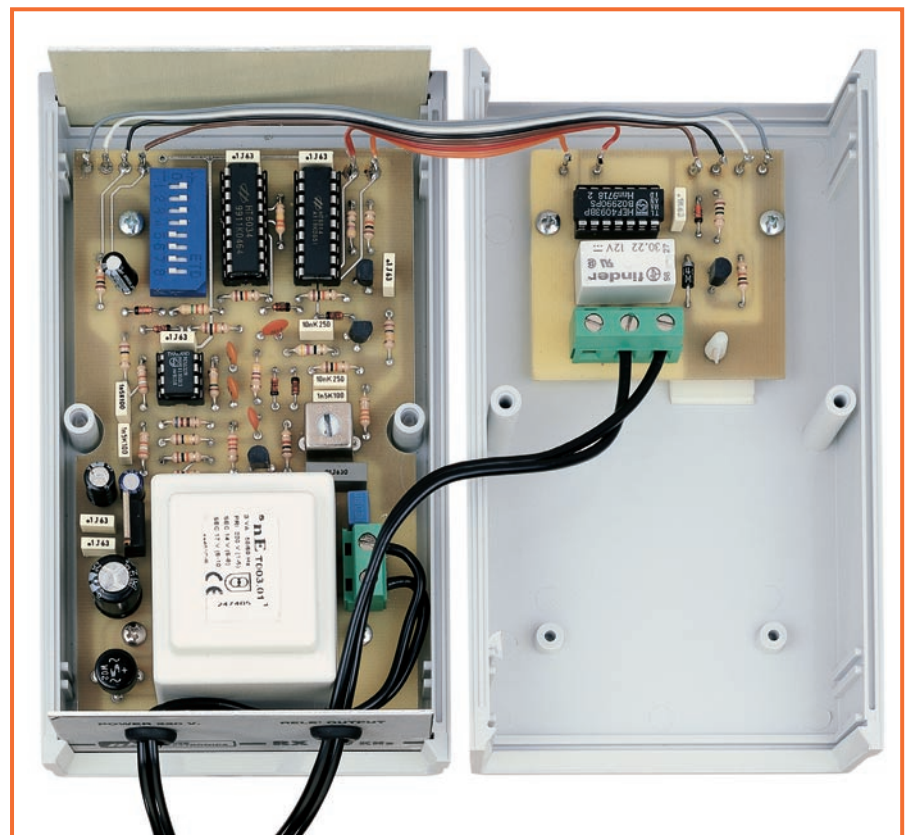
Figure 14: Photo du boîtier du récepteur ouvert. Sur le fond du boîtier, on a fixé, à l'aide de 3 vis autotaraudeuses, la platine réceptrice et, sous le couvercle, la platine du relais (figure 20), au moyen de 2 vis autotaraudeuses et d'une entretoise à base autocollante. Par les deux trous de la face avant sortent le cordon d'alimentation secteur 230 V et le câble provenant du relais et destiné à commander la mise en marche ou l'arrêt d'un appareil.
