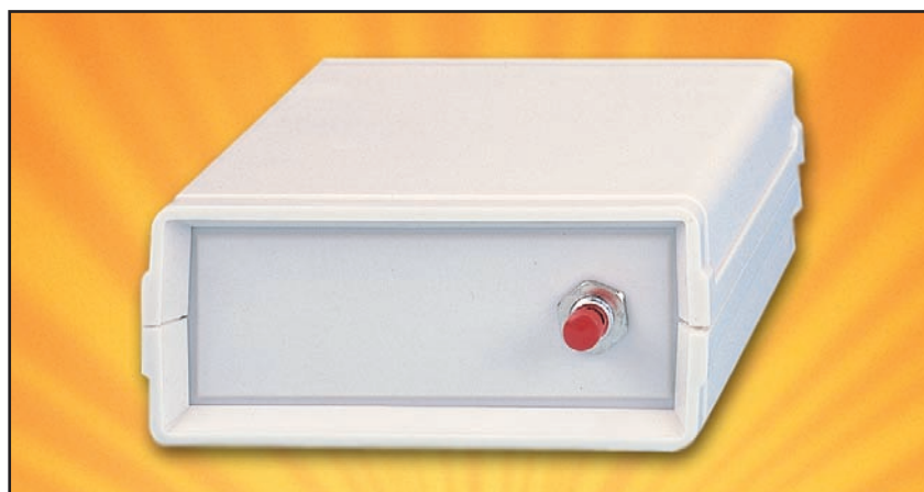
Figure 1: Pour ce timer nous n'avons qu'un seul poussoir de "START" (départ). Pressé, il excite un triac (figure 3) à la sortie duquel vous pouvez relier n'importe quel appareil fonctionnant sur secteur (dont la puissance ne dépassera évidemment pas celle admissible par ledit triac!).
