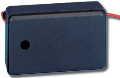
Figure 1 : Les dimensions du petit boîtier plastique choisi pour protéger l'émetteur sont très réduites (L 58 x l 35 x P 19 mm). La pile 6F22 de 9 V est extérieure. Bien entendu, si la taille de l'émetteur importe peu, vous pourrez utiliser un boîtier intégrant la pile.
