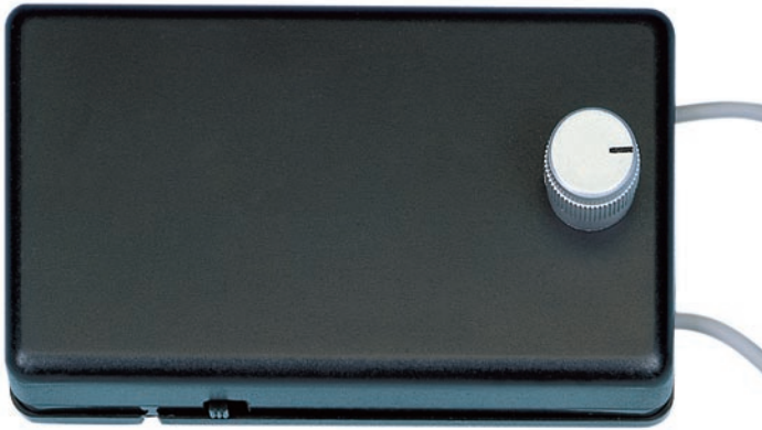
Figure 3: Le boîtier plastique utilisé n'étant pas percé, il faudra pratiquer en face avant un trou pour fixer le potentiomètre R8, sur le côté droit, un orifice rectangulaire pour le passage du levier de l'interrupteur à glissière S1 et, sur le côté supérieur, deux trous pour le passage des câbles d'entrée microphone et de sortie (figure 8).
