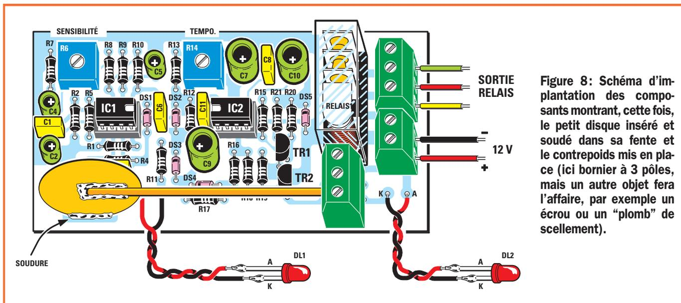
**Figure 8:** Schéma d'implantation des composants montrant, cette fois, le petit disque inséré et soudé dans sa fente et le contrepoids mis en place (ici bornier à 3 pôles, mais un autre objet fera l'affaire, par exemple un écrou ou un "plomb" de scellement).
