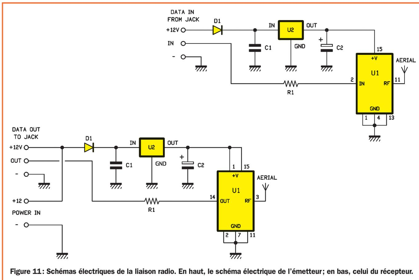
Figure 11: Schémas électriques de la liaison radio. En haut, le schéma électrique de l'émetteur; en bas, celui du récepteur.
