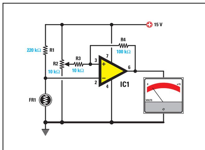
Figure 178 : Pour obtenir un trigger de Schmitt avec seuil réglable, il suffit d'appliquer une photorésistance (voir FR1) ou une résistance CTN sur l'entrée inverseuse, puis de faire varier la tension sur l'entrée non-inverseuse par l'intermédiaire du trimmer R2.
