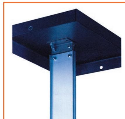
**Figure 17:** Après avoir fixé entre les deux barres verticales les lames d'acier de 0,06 millimètre, serrez les extrémités opposées entre les deux équerres en L (figure 15) puis fixez le pendule au couvercle venant ensuite coiffer le boîtier.
