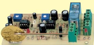
Ce montage, capable de détecter tout type de vibrations mécaniques, peut être utilisé pour résoudre divers problèmes quotidiens. Pour réaliser ce capteur, nous avons utilisé de petits disques piézo-électriques comme on en trouve dans les buzzers.
