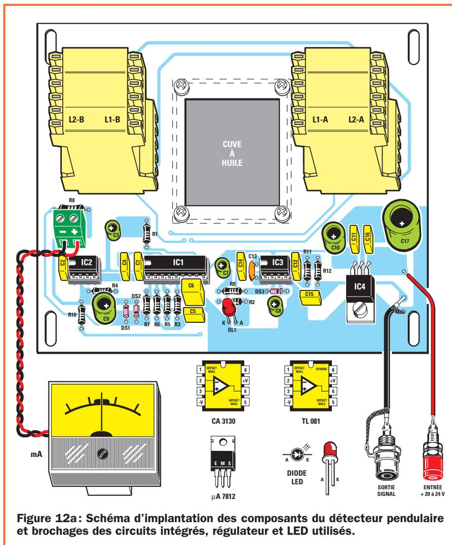
**Figure 12a: Schéma d'implantation des composants du détecteur pendulaire et brochages des circuits intégrés, régulateur et LED utilisés.**
