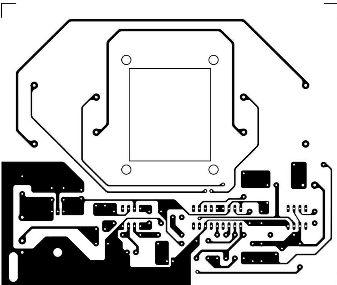
Figure 12c: Dessin, à l'échelle 1, du circuit imprimé du détecteur pendulaire, côté soudures. Si vous décidez de réaliser vous-même ce circuit imprimé, n'oubliez pas toutes les liaisons indispensables entre les deux faces. Les circuits professionnels sont à trous métallisés et sont sérigraphiés.
