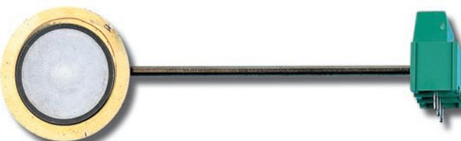
Figure 4 : A l'extrémité du fil, on fixera un contrepois (le bornier) servant à transmettre les vibrations au disque piézo-électrique.
