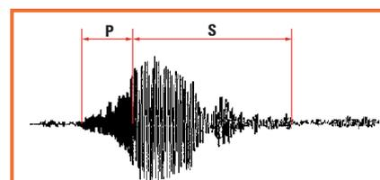
Figure 3: Pour évaluer la distance séparant le détecteur de l'épicentre, il suffit de mesurer la longueur en millimètres des ondes P. Si l'échelle d'écran est en 1 centimètre/minute, chaque millimètre correspond à une distance de 66 à 68 kilomètres; si elle est de 3 centimètres/minute, chaque millimètre correspond à environ 22 à 23 kilomètres.
