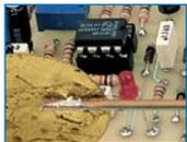
Ce montage, capable de détecter tout type de vibrations mécaniques, peut être utilisé pour résoudre divers problèmes quotidiens. Pour réaliser ce capteur, nous avons utilisé de petits disques piézo-électriques comme on en trouve dans les buzzers. Il trouvera son application soit dans des systèmes d'alarme soit dans des systèmes de sécurité.
