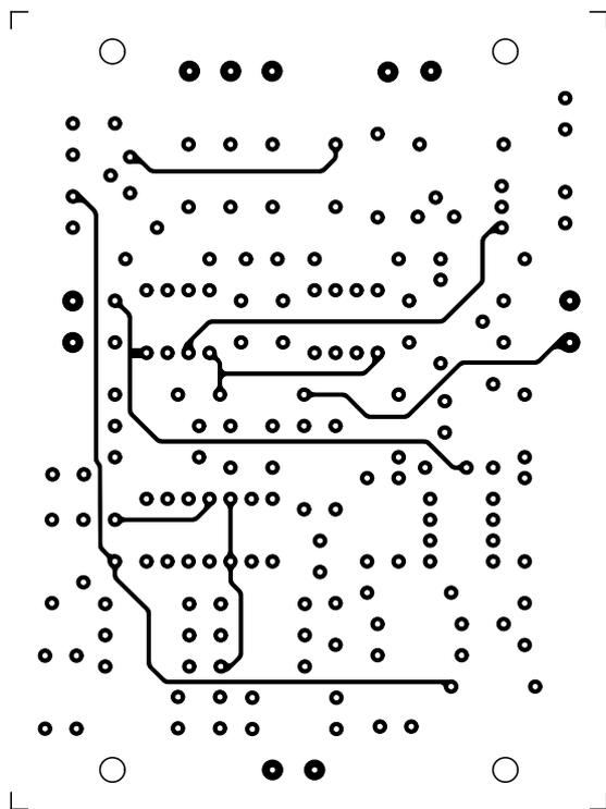
**Figure 6b:** Dessin, à l'échelle 1, du circuit imprimé du capteur volumétrique. Côté composants.
