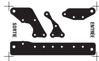
**Figure 15b :** Dessin, à l'échelle 1, du circuit imprimé de la sonde HF.
