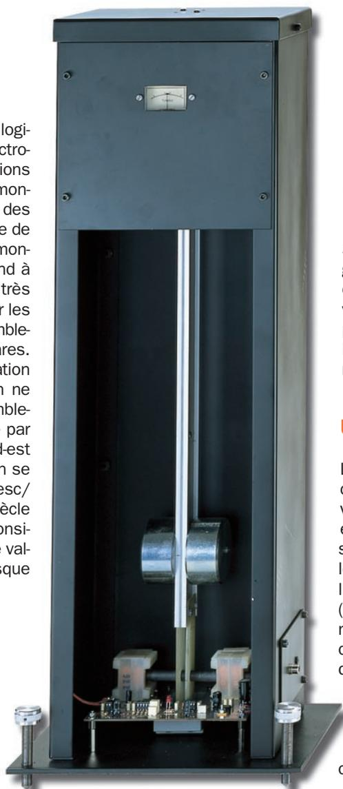
tions dues aux véhicules lourds, trains, trams, camions, passant dans le voisinage. Et, d'ailleurs, le seul défaut de ce détecteur pendulaire est d'être insensible aux tremblements de terre de faible intensité se produisant dans un rayon de 200 à 300 km. En effet, le pendule d'un sismographe ne détecte un tremblement de terre que s'il entre en résonance avec les microvibrations du terrain comme le fait un diapason. Mais voyons comment s'explique le phénomène à détecter et comment le mesurer.
