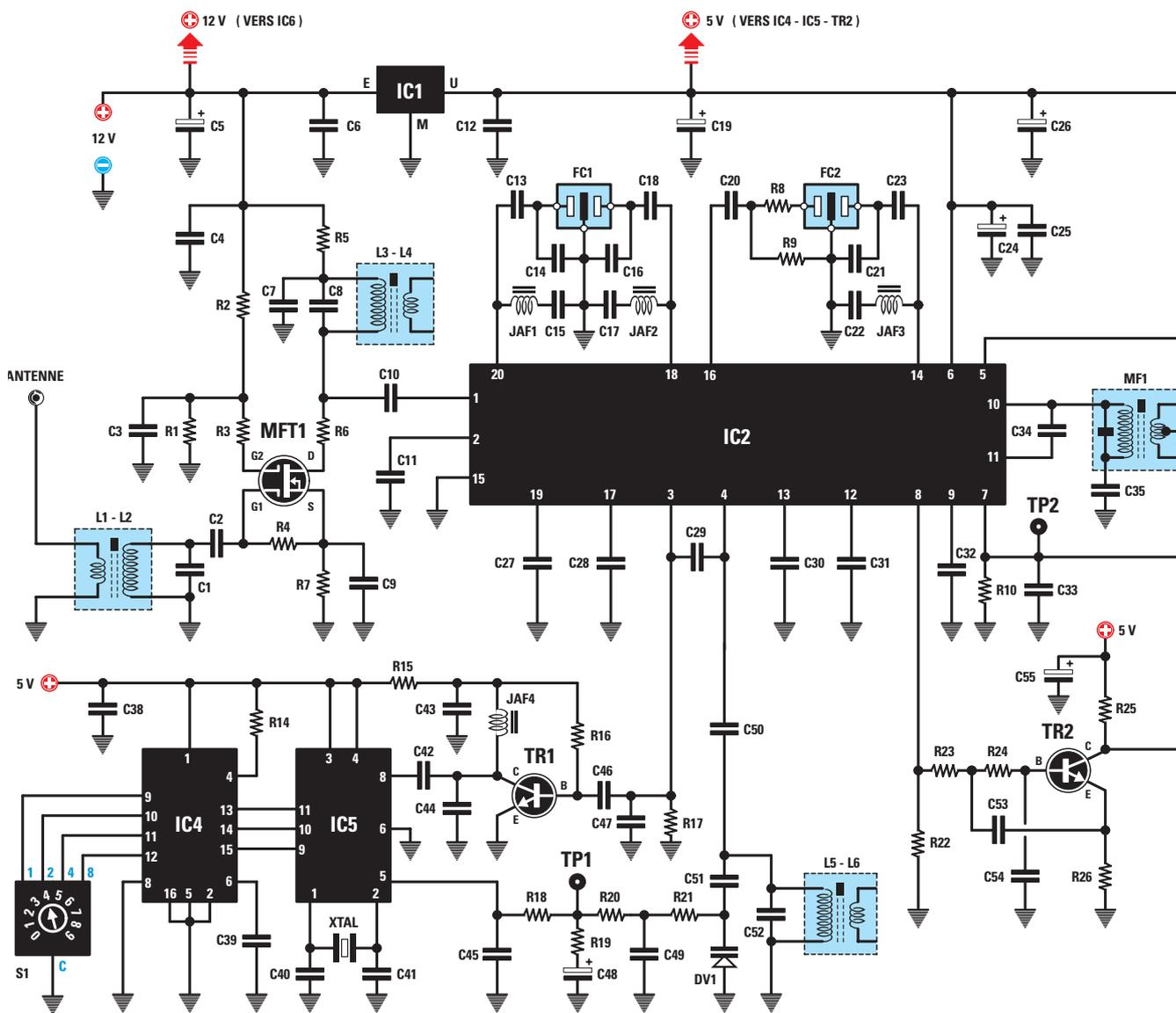
**Figure 2 : Schéma électrique du récepteur superhétérodyne en FM, en mesure de se synchroniser sur les fréquences comprises entre 170 et 173 MHz à l'aide du commutateur binaire S1. Toutes les résistances utilisées sont des modèles 1/8 de watt. Le brochage du LM358 est vu de dessus, celui des transistors BC547 est vu de dessous.**
