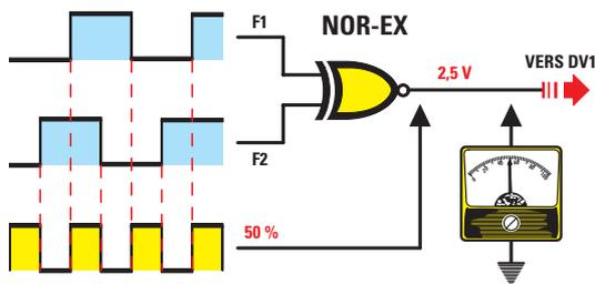
**Figure 4 :** Lorsque les deux fréquences F1 et F2 qui arrivent sur l'entrée de la porte NOR exclusif, génèrent en sortie une onde carrée ayant un rapport cyclique de 50 %, on trouve sur la diode varicap DV1 une tension de 2,5 volts. Dans cette condition, sur le transistor TR1, nous prélevons une fréquence de 171,60 MHz.
