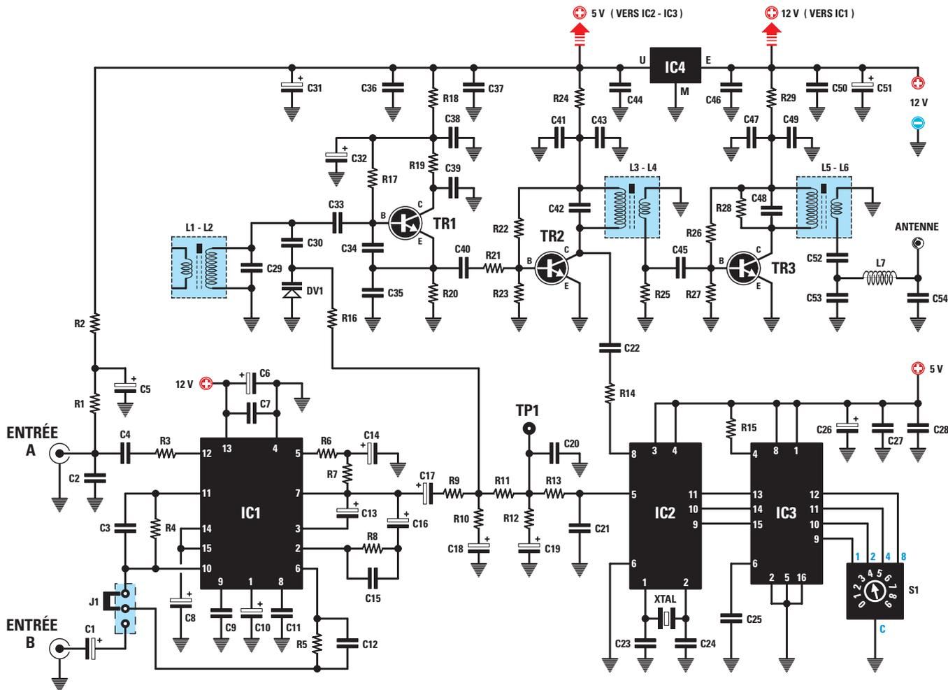
Figure 3: Schéma électrique de l'émetteur FM. L'entrée A est utilisée pour amplifier les signaux BF prélevés d'un microphone préamplifié (voir figure 13). Par contre, l'entrée B est utilisée pour amplifier les signaux issus d'un microphone quelconque. Les résistances utilisées dans ce projet sont des modèles 1/8 de watt. Pour changer la fréquence du TX, il faut tourner S1.
