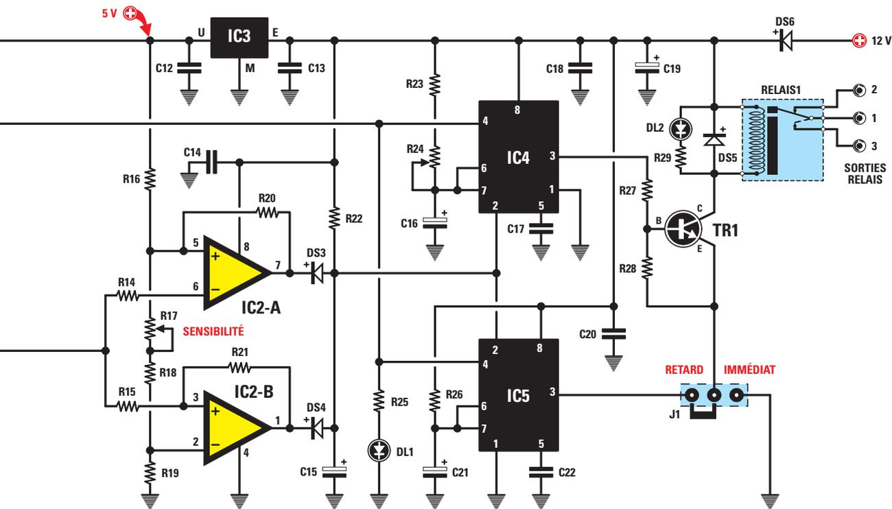
les deux amplificateurs opérationnels IC2-A et IC2-B, sert à modifier la sensibilité du détecteur, le trimmer R24, appliqué sur IC4, le cavalier sur J1 à gauche, vous obtenez une action retardée du relais, si vous le placez à droite, l'action est immédiate.
