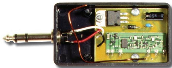
Figure 14: Photo d'un des prototypes de l'émetteur de la liaison radio.
