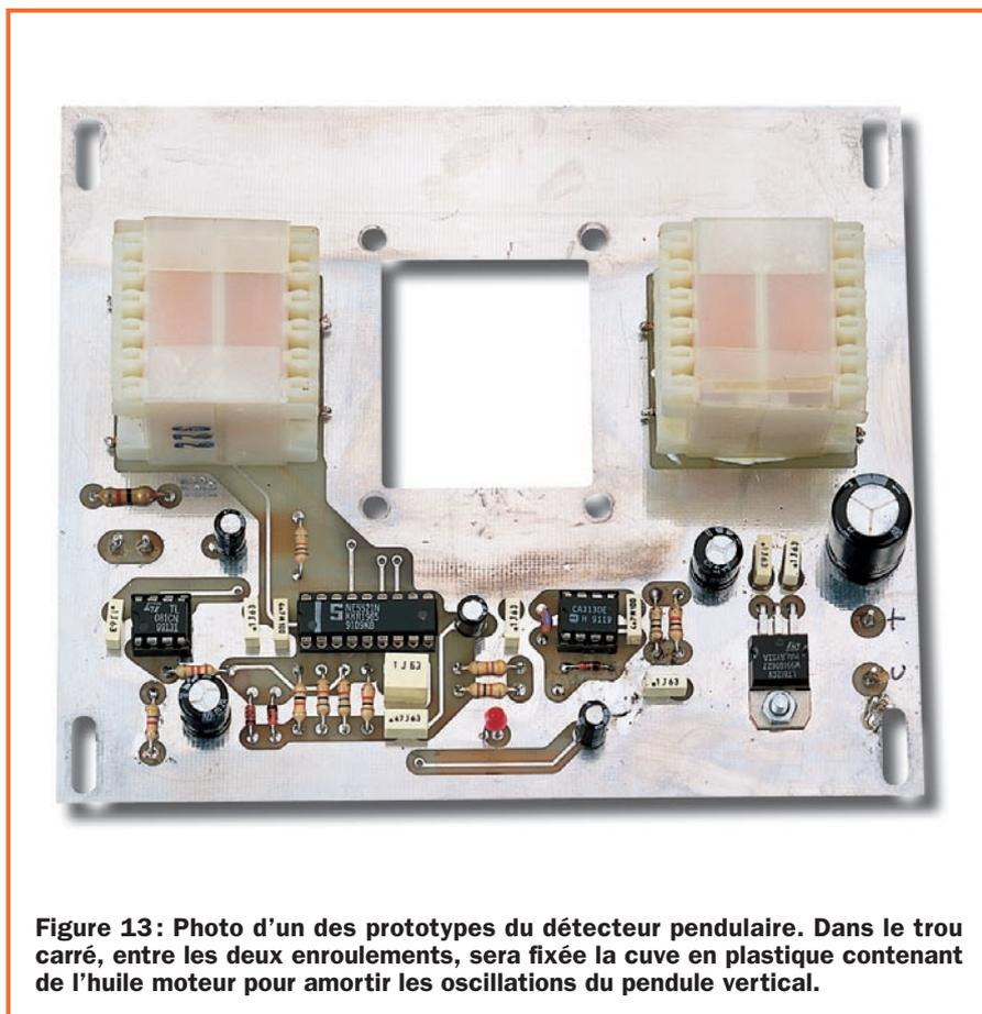
Figure 13: Photo d'un des prototypes du détecteur pendulaire. Dans le trou carré, entre les deux enroulements, sera fixée la cuve en plastique contenant de l'huile moteur pour amortir les oscillations du pendule vertical.
