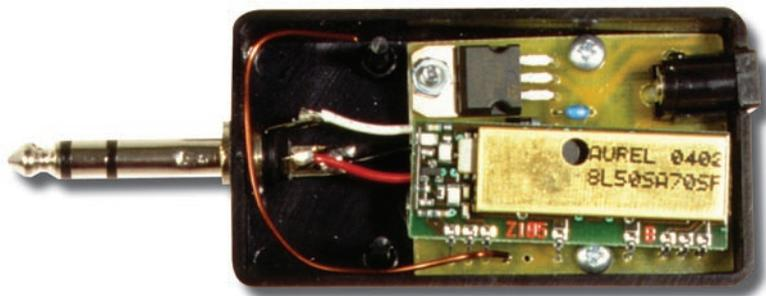
Figure 17: Photo d'un des prototypes du récepteur de la liaison radio.
