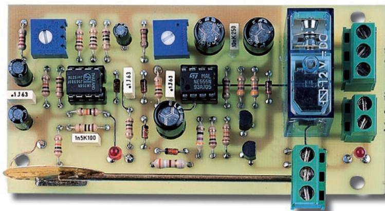
**Figure 6 : Photo d'un des prototypes du détecteur de vibrations. Après avoir soudé le petit disque dans la fente du circuit imprimé, il faut aussi fixer à l'extrémité du fil un contrepois et pour cela nous nous servons d'un bornier à 3 pôles.**
