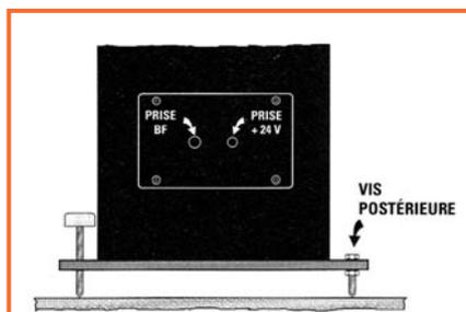
**Figure 16:** Le boîtier devra être parfaitement de niveau. Après avoir fixé à l'arrière du socle une vis normale, réglez lentement les deux vis moletées faisant office de vérins jusqu'à ce que l'aiguille du galvanomètre soit parfaitement centrée. Vous pouvez aussi faire un dégrossissage au niveau à bulle dans les deux directions x et y du plan horizontal.
