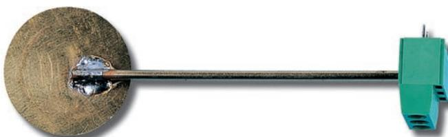
Figure 3 : Du côté entièrement en laiton du petit disque, soudez un fil rigide de 2 millimètres de diamètre et de 70 millimètres de long environ.
