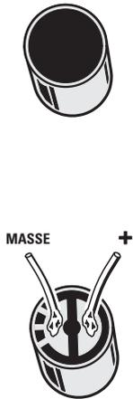
Figure 2: Comme on peut le voir dans le schéma électrique, comme capteur, nous avons utilisé une petite capsule microphonique préamplifiée. Il ne faut pas intervertir les deux pattes "M" et "+". Rappelons que la patte "M" est reliée à l'enveloppe métallique du microphone.
