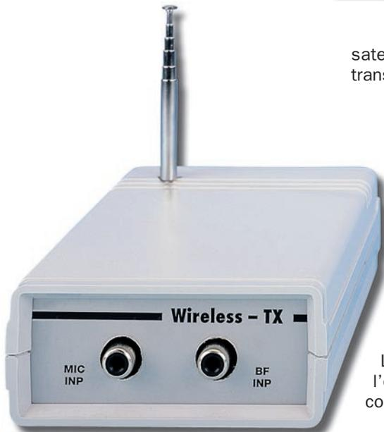
**Figure 1: L'émetteur FM Hi-Fi 170 - 173 MHz, terminé, monté dans son boîtier, prêt à fonctionner. Pour obtenir un aspect professionnel, la face avant a été sérigraphiée.**
