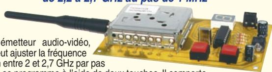
Ce petit émetteur audio-vidéo, dont on peut ajuster la fréquence d'émission entre 2 et 2,7 GHz par pas de 1 MHz, se programme à l'aide de deux touches. Il comporte un afficheur à 7 segments fournissant l'indication de la fréquence sélectionnée. Il utilise un module HF à faible prix dont les prestations sont remarquables.
