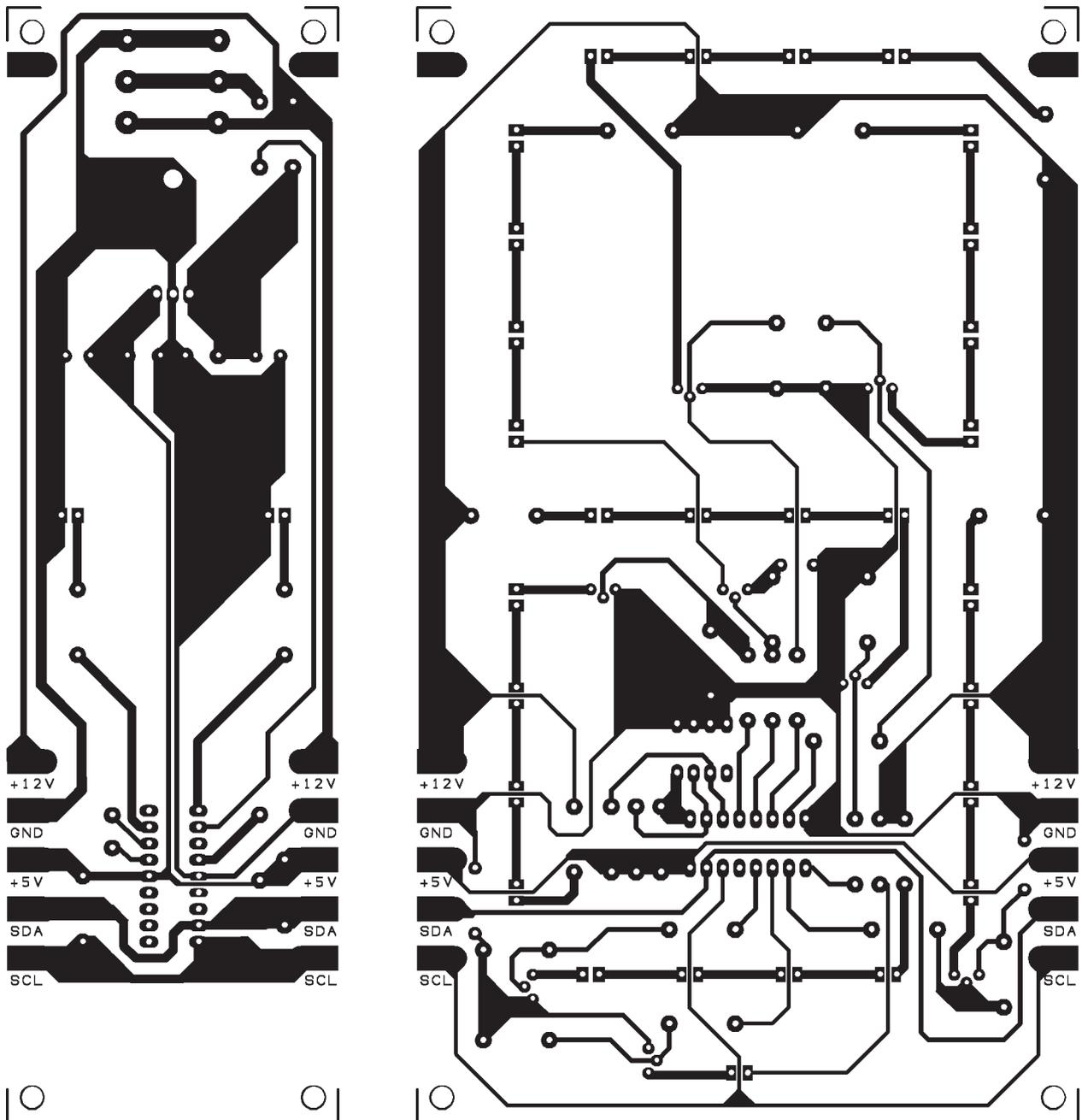
Figure 8: Dessins, à l'échelle 1, des circuits imprimés du panneau lumineux. A gauche: le circuit imprimé de la platine de contrôle. A droite: le circuit imprimé d'un afficheur (un chiffre).
