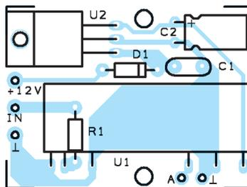
Figure 13: Schéma d'implantation des composants de l'émetteur de la liaison radio.
