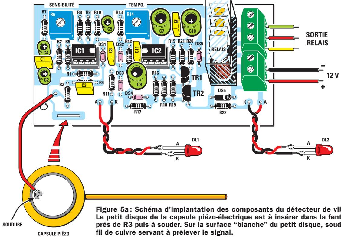
Figure 5a: Schéma d'implantation des composants du détecteur de vibrations. Le petit disque de la capsule piézo-électrique est à insérer dans la fente située près de R3 puis à souder. Sur la surface "blanche" du petit disque, soudez un fin fil de cuivre servant à prélever le signal.
