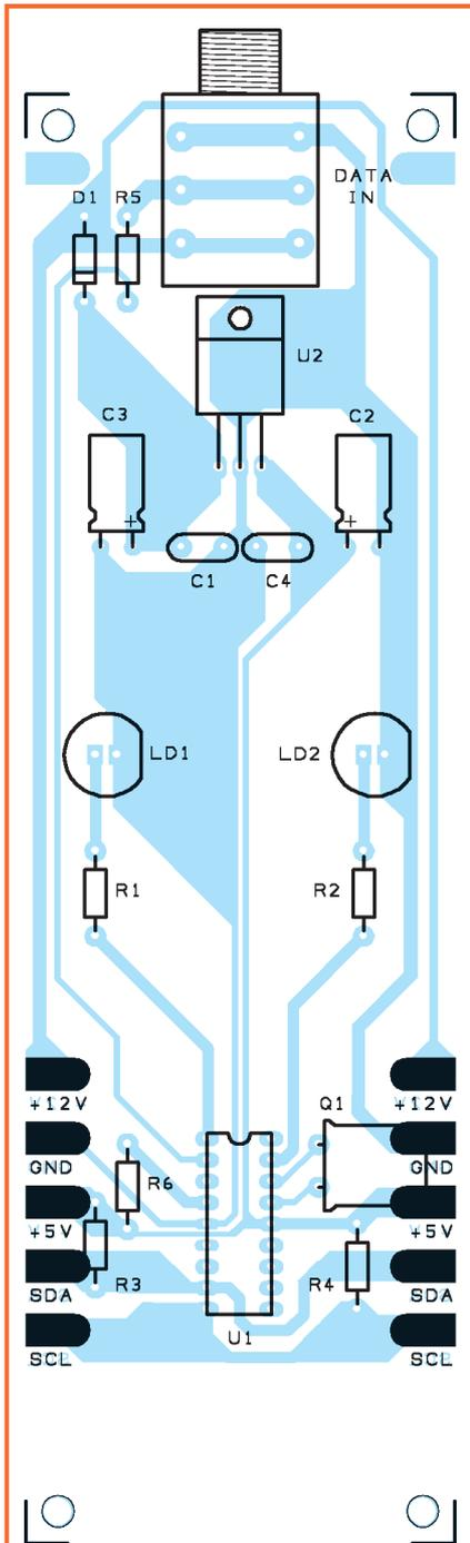
**Figure 5: Schéma d'implantation des composants de la platine de contrôle du panneau lumineux.**
