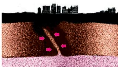
**Figure 5:** Les grandes couches rocheuses de la lithosphère sont toujours en mouvement, ce sont des failles. Si ces strates rocheuses se déplacent très lentement et de manière élastique, elles produisent des vibrations minimes détectées seulement par les sismographes les plus sensibles.
