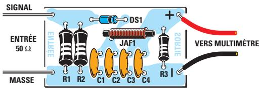
**Figure 15a :** Schéma d'implantation des composants de la sonde HF. Tous les composants visibles sur le schéma électrique de la figure 14 sont montés sur un petit circuit imprimé.
