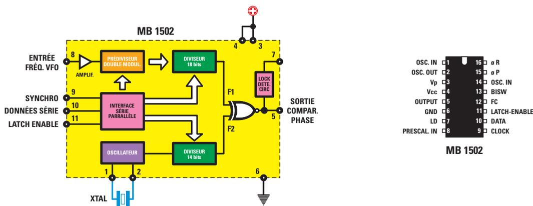
**Figure 2: Schéma synoptique du circuit intégré MB1502 utilisé dans cet émetteur, pour faire varier la tension sur la diode varicap DV1, indispensable pour la technique PLL.**
