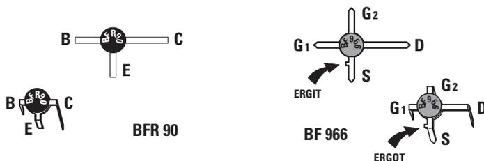
Figure 6: Avant de plier les pattes du transistor BFR90, il faut tourner la patte la plus longue "C" (collecteur), vers la droite et la patte E vers soi. Pour le MOSFET BF966, il faut toujours tourner la patte la plus longue "D" (drain) vers la droite et la patte "S" (source) qui a un ergot-repère, vers soi.
