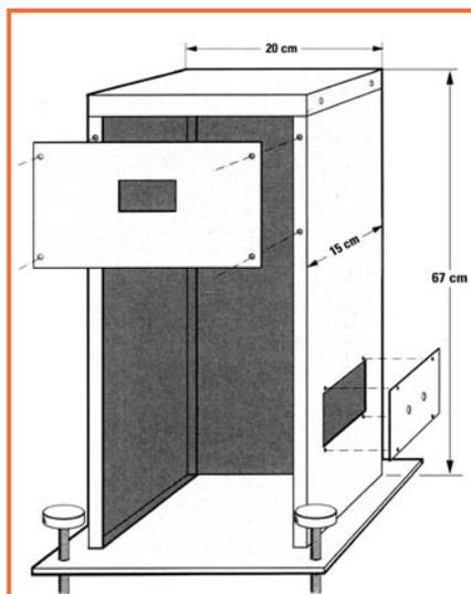
**Figure 14:** Le boîtier vertical du détecteur pendulaire doit être assemblé. Dans les orifices du boîtier prévus à cet effet, on insérera des écrous imperdables ou écroucages.
