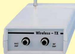
Cet émetteur FM transmet un signal de qualité HI-FI d'une puissance de 100 mW environ. Il peut être accordé entre 170 et 173 MHz. Selon l'utilisation que l'on veut en faire, le signal émis peut être capté à l'aide d'un récepteur couvrant cette gamme de fréquence ou avec un scanner.
