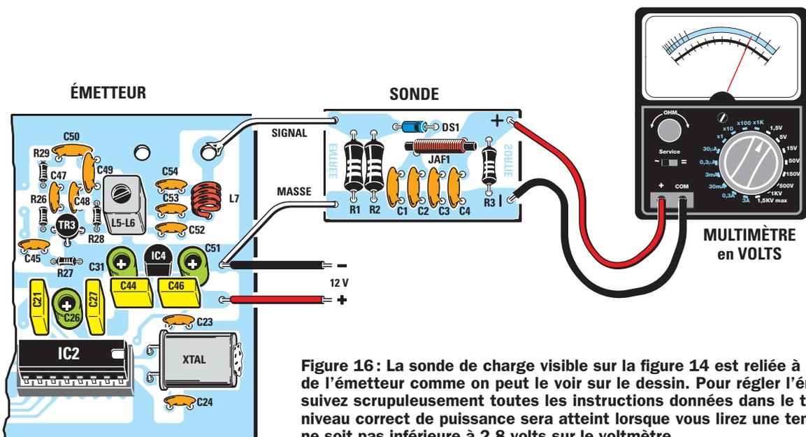
**Figure 16 :** La sonde de charge visible sur la figure 14 est reliée à la sortie de l'émetteur comme on peut le voir sur le dessin. Pour régler l'émetteur, suivez scrupuleusement toutes les instructions données dans le texte. Le niveau correct de puissance sera atteint lorsque vous lirez une tension qui ne soit pas inférieure à 2,8 volts sur le voltmètre.
