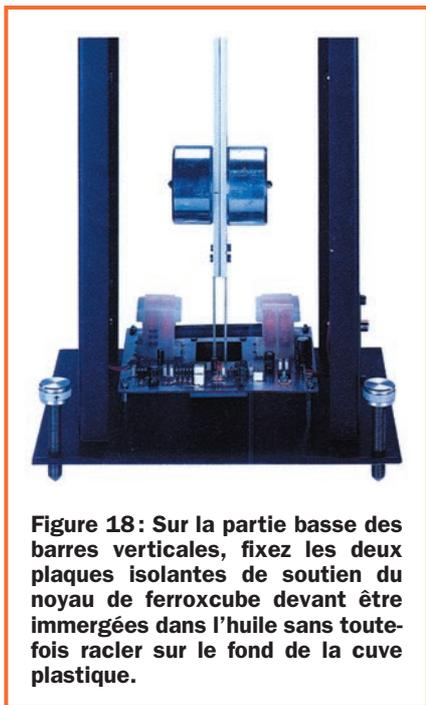
**Figure 18:** Sur la partie basse des barres verticales, fixez les deux plaques isolantes de soutien du noyau de ferrocube devant être immergées dans l'huile sans toutefois racler sur le fond de la cuve plastique.
