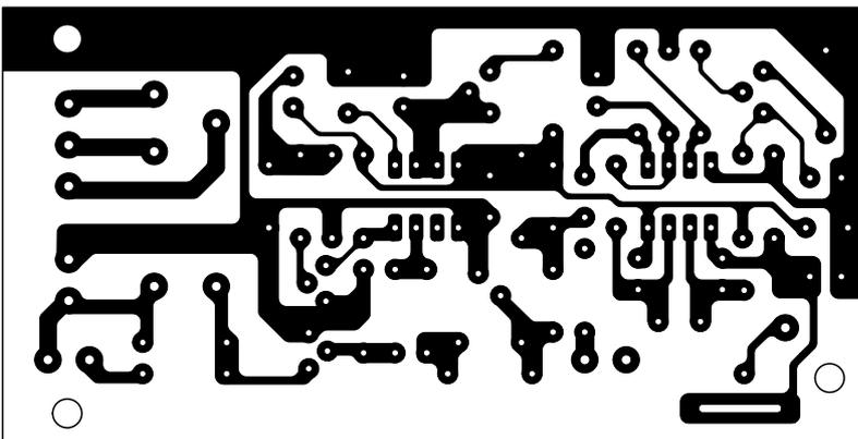
Figure 5c: Dessins, à l'échelle 1, du circuit imprimé double face à trous métallisés du détecteur de vibrations. Côté soudures.
