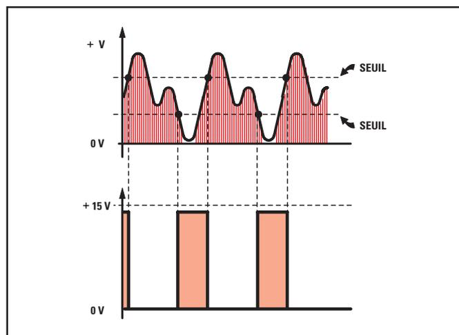
Figure 177 : Si on alimente un trigger de Schmitt à l'aide d'une tension unique, la sortie restera au niveau logique 0 tant que la tension appliquée sur l'entrée restera comprise entre la valeur de seuil maximal et minimal. Lorsque le signal descend en dessous du seuil minimal, la sortie se porte au niveau logique 1 et retourne au niveau logique 0 seulement lorsque le signal sur l'entrée dépasse le niveau du seuil maximal.
