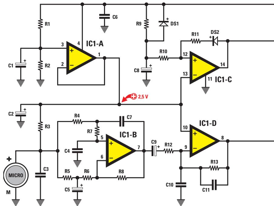
Figure 4: Schéma électrique du capteur volumétrique. Le trimmer R17 placé entre sert, quant à lui, à modifier la durée de fonctionnement de l'alarme. Si vous placez
