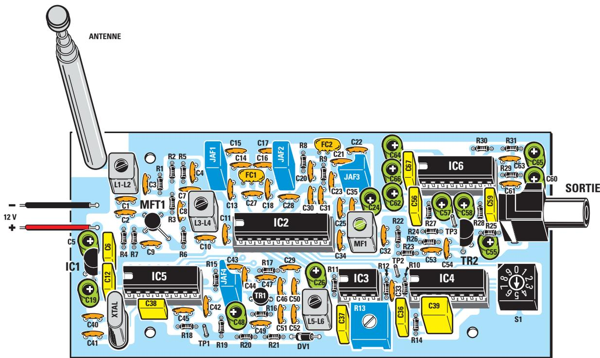
Figure 5a: Schéma d'implantation des composants du récepteur. Pour se syntoniser sur les 10 fréquences de 170 à 173 MHz évoquées dans l'article, utilisez le commutateur binaire S1. Avant d'insérer le MOSFET BF966 et le transistor BFR90, il faut replier leurs pattes comme cela est représenté sur la figure 6.
