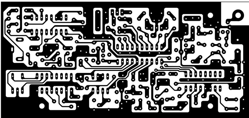
Figure 5c: Dessin, à l'échelle 1, du circuit imprimé double face du récepteur. Côté soudures. Si vous décidez de réaliser vous-même ce circuit, n'oubliez pas toutes les jonctions entre les deux faces. Le circuit professionnel est à trous métallisés et il est sérigraphié.
