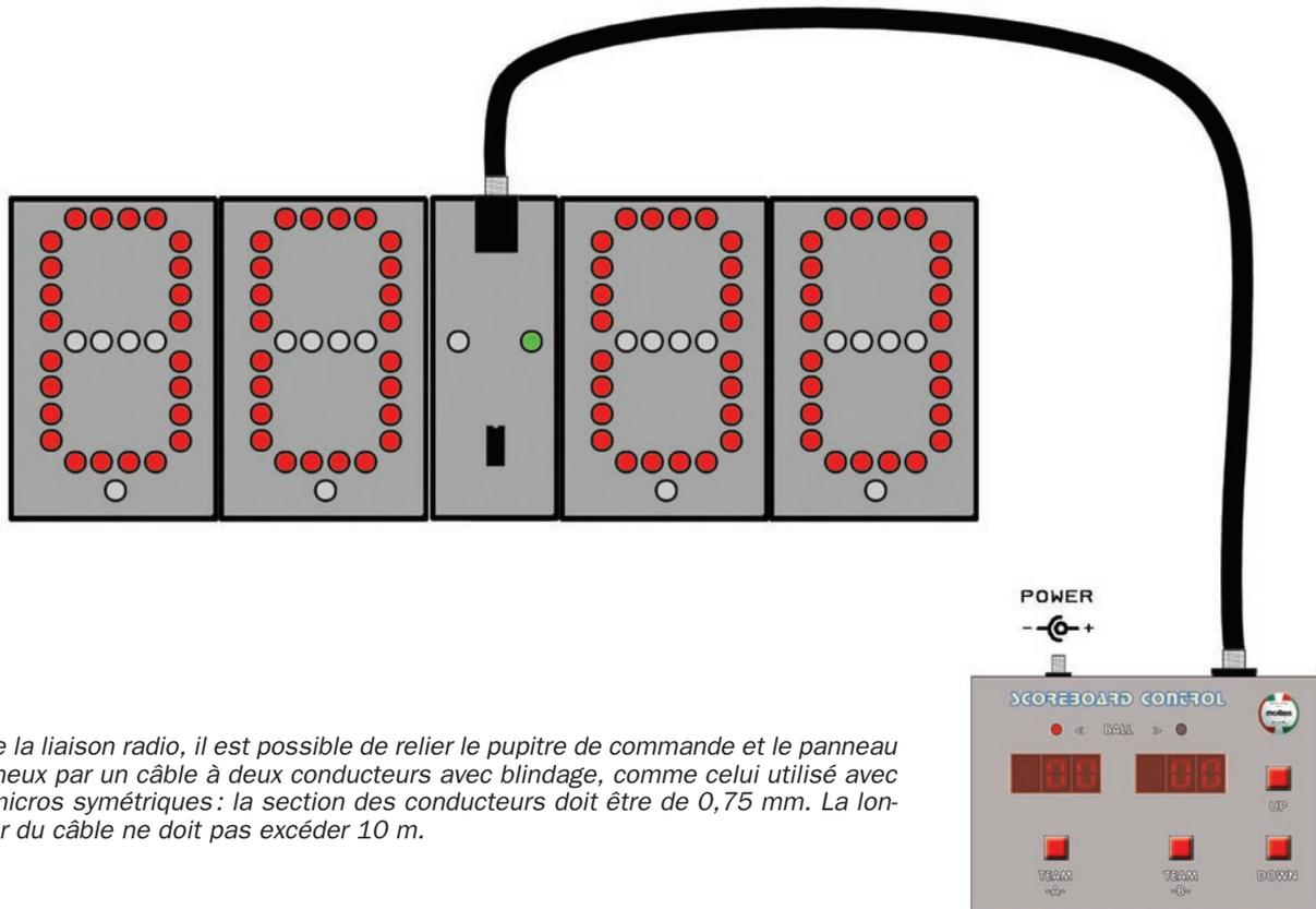
Outre la liaison radio, il est possible de relier le pupitre de commande et le panneau lumineux par un câble à deux conducteurs avec blindage, comme celui utilisé avec les micros symétriques : la section des conducteurs doit être de 0,75 mm. La longueur du câble ne doit pas excéder 10 m.
