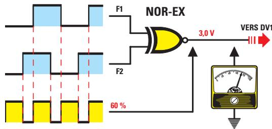
**Figure 5 :** Lorsque les deux fréquences F1 et F2 qui arrivent sur l'entrée de la porte NOR exclusif, génèrent en sortie une onde carrée ayant un rapport cyclique de 60 %, on trouve sur la diode varicap DV1 une tension de 3 volts. Dans cette condition, sur le transistor TR1, nous prélevons une fréquence de 173,20 MHz.
