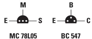
Figure 1: Brochages des circuits intégrés LM358, LM324 et NE555 vus de dessus avec leur repère-détrompeur placé vers la gauche. Le brochage du circuit intégré régulateur MC78L05 et du transistor NPN BC547 sont vus de dessous.
