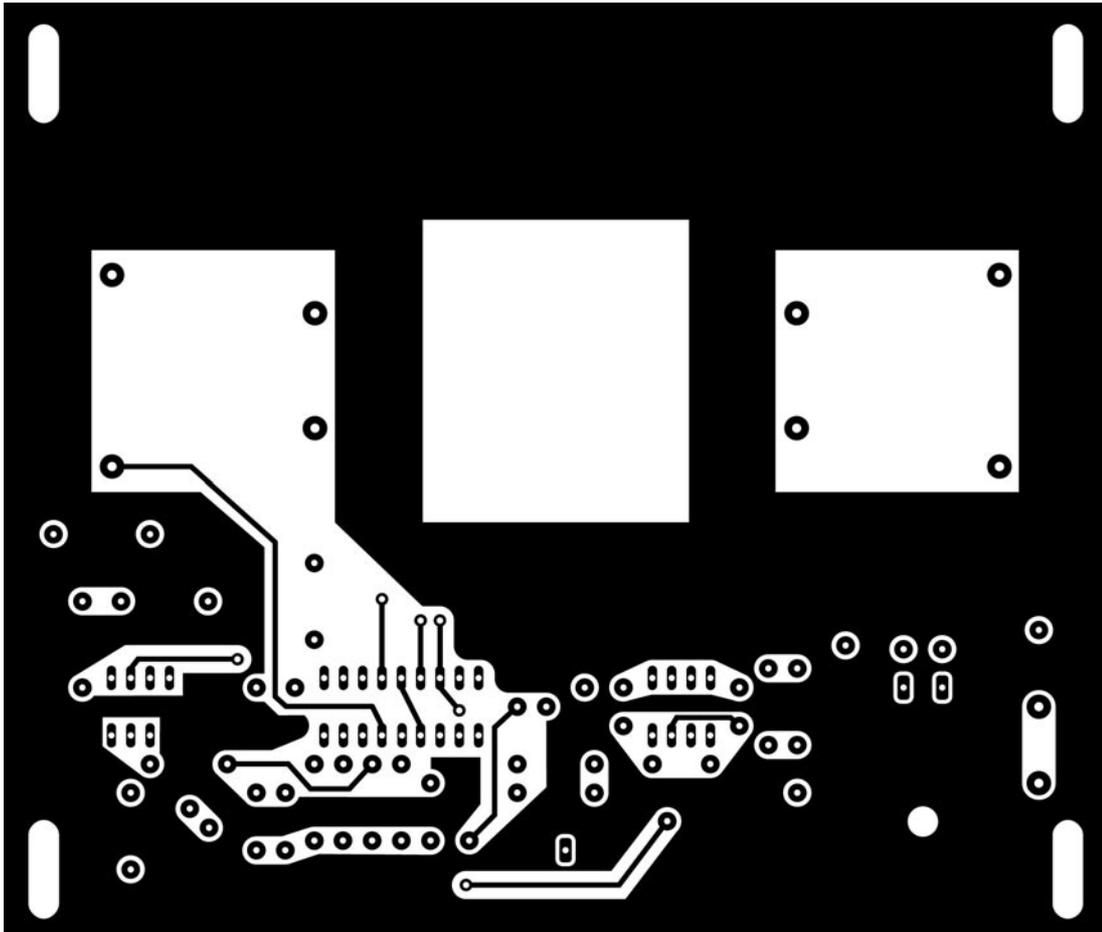
Figure 12b: Dessin, à l'échelle 1, du circuit imprimé du détecteur pendulaire, côté composants.
