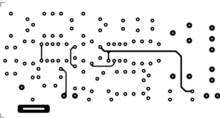
Figure 5b: Dessins, à l'échelle 1, du circuit imprimé double face à trous métallisés du détecteur de vibrations. Côté composants.
