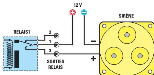
Figure 10 : La sirène d'alarme (visible sur la photo du début de l'article) est reliée sur les contacts de sorties 1 et 3 du relais (voir figure 6).
