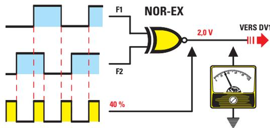
**Figure 6 :** Lorsque les deux fréquences F1 et F2 qui arrivent sur l'entrée de la porte NOR exclusif, génèrent en sortie une onde carrée ayant un rapport cyclique de 40 %, on trouve sur la diode varicap DV1 une tension de 2 volts. Dans cette condition, sur le transistor TR1, nous prélevons une fréquence de 170,40 MHz.
