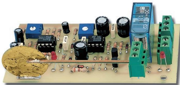
Figure 2 : Photo de notre détecteur de vibrations.
