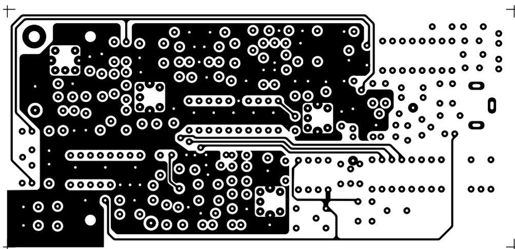
Figure 5b: Dessin, à l'échelle 1, du circuit imprimé double face du récepteur. Côté composants.
