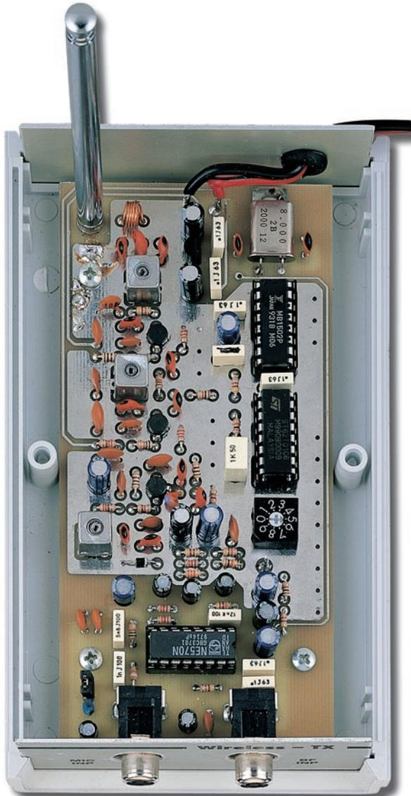
Figure 7 : Photo de l'étage émetteur, à l'intérieur de son coffret plastique. Pour faire sortir l'antenne télescopique, il convient de pratiquer un trou de 7 mm sur son couvercle.
