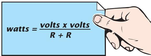
*Note : Comme sur l'entrée nous avons placé deux résistances de 100 ohms en parallèle (voir R1 et R2), la valeur R à utiliser pour le calcul de la puissance est égale à 50 ohms.*
