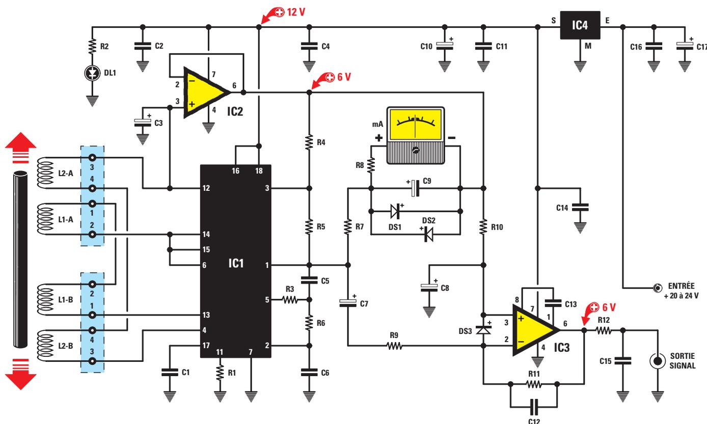
**Figure 11:** Schéma électrique du détecteur pendulaire. Le signal du séisme, prélevé sur la douille Sortie signal (IC3) est envoyé sur la douille Entrée signal de l'interface (figure 20) au moyen d'un petit câble coaxial RG174. Le détecteur est alimenté par une tension non stabilisée de 20 V prélevée sur la diode redresseuse DS1 de l'interface et appliquée à l'entrée du régulateur IC4.
