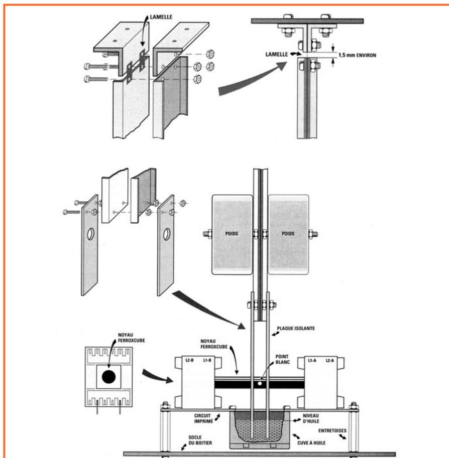
**Figure 15:** Si vous suivez bien ces dessins, vous ne rencontrerez aucune difficulté pour monter le pendule vertical. Après avoir positionné le noyau de ferroxcube au centre des deux plaques isolantes, vous pouvez les bloquer avec une goutte de colle. Vérifiez que les extrémités des plaques isolantes immergées dans l'huile ne touchent pas le fond. Le couvercle du boîtier comporte des trous oblongs permettant de régler la position des équerres en L.
