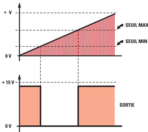
$$\begin{aligned} R1 \text{ k}\Omega &= (V_{cc} - V_{max}) : 0,15 \\ R3 \text{ k}\Omega &= V_{min} : 0,15 \\ R2 \text{ k}\Omega &= (V_{max} - V_{min}) : 0,15 \\ V_{min} &= \frac{R3}{R1+R2+R3} \times V_{cc} \\ V_{max} &= \frac{R2+R3}{R1+R2+R3} \times V_{cc} \end{aligned}$$
