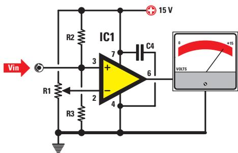
**Figure 172 :** Si l'on veut obtenir une condition logique opposée à celle reportée dans les figures 170 et 171, il suffit de relier la broche inverseuse sur le trimmer R1 et entrer avec la tension sur l'entrée non-inverseuse. Pour les résistances R2 et R3, on pourra utiliser une valeur de 10 000 ohms (10 kΩ).
