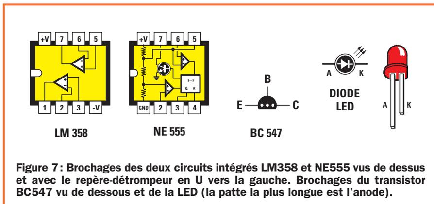
**Figure 7:** Brochages des deux circuits intégrés LM358 et NE555 vus de dessus et avec le repère-détrompeur en U vers la gauche. Brochages du transistor BC547 vu de dessous et de la LED (la patte la plus longue est l'anode).
