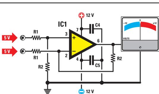
**Figure 167 : Si on applique sur les deux entrées d'un différentiel deux tensions identiques, de n'importe quelle valeur, on retrouvera toujours une tension de 0 volt en sortie.**
