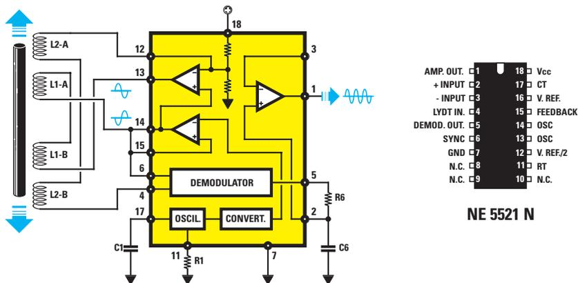
**Figure 10:** Pour pouvoir détecter même les microvibrations de la croûte terrestre, nous utilisons un détecteur très sensible constitué d'un noyau de ferroxcube placé à l'intérieur des enroulements L2-A/L1-A et L1-B/L2-B. Dès que le noyau commence à vibrer sous l'effet d'un séisme, nous retrouvons, sur la broche de sortie 1, le signal de la vibration qui, après amplification et élaboration, aboutira à l'interface puis, au moyen d'un câble sériel, à l'écran de l'ordinateur.
