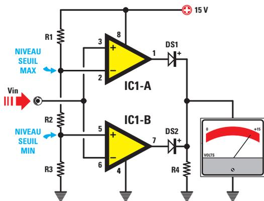
**Figure 173 :** Les comparateurs à fenêtre sont utilisés pour maintenir la broche de sortie au niveau logique 0 (niveau bas) tant que la tension appliquée sur l'entrée reste entre le niveau de seuil minimal et maximal. Si on descend en dessous de la valeur de seuil minimale autorisée ou si l'on monte au-dessus de la valeur maximale de seuil, la sortie se portera au niveau logique 1 (niveau haut).
