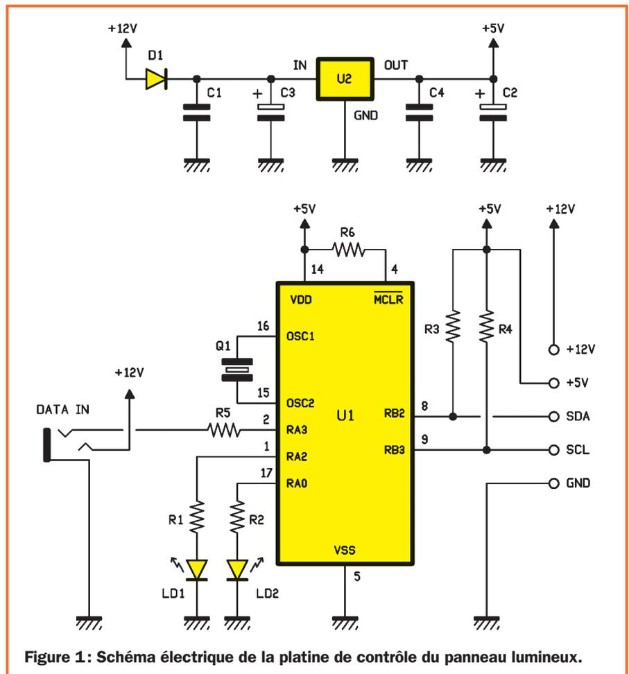
Figure 1: Schéma électrique de la platine de contrôle du panneau lumineux.
