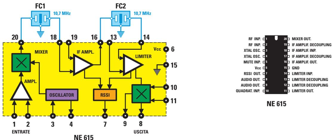
Figure 4: Comme vous pouvez le voir sur ce schéma synoptique, le circuit intégré NE615 est un récepteur superhétérodyne FM complet.
