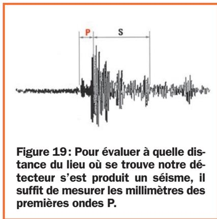
**Figure 19:** Pour évaluer à quelle distance du lieu où se trouve notre détecteur s'est produit un séisme, il suffit de mesurer les millimètres des premières ondes P.
