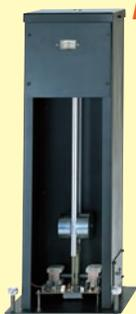
Pour visualiser sur l'écran de votre ordinateur les sismogrammes d'un tremblement de terre vous n'avez besoin que d'un détecteur pendulaire, de son alimentation et d'une interface PC avec son logiciel approprié. C'est dire que cet appareil est simple et économique.
