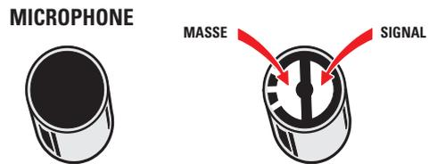
Figure 13: Si vous utilisez un microphone préamplifié, reliez-le sur la prise A, car c'est seulement sur cette entrée que se trouve une tension positive permettant de l'alimenter. Le point de sortie du signal est celui qui se trouve isolé de la masse métallique de son corps.
