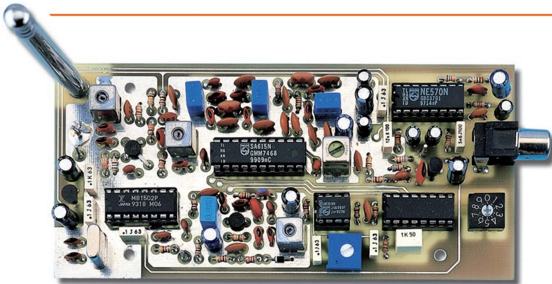
Figure 3: Photo d'un des prototypes du circuit imprimé, avec les composants montés, prêt à être alimenté.
