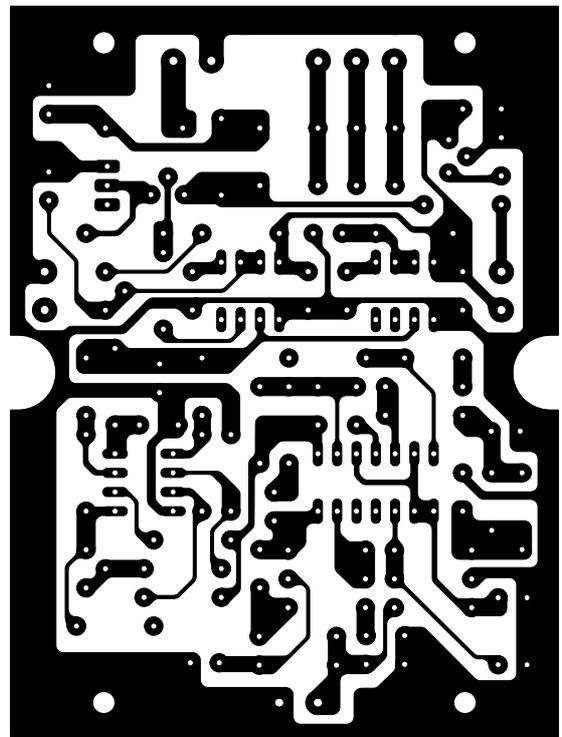
**Figure 6c:** Dessin, à l'échelle 1, du circuit imprimé du capteur volumétrique. Côté soudures. Si vous réalisez vous-même ce circuit double face, n'oubliez pas toutes les liaisons indispensables entre les deux côtés. Le circuit professionnel est à trous métallisés et il est sérigraphié.
