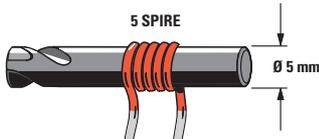
Figure 12: Pour réaliser la bobine L7, prenez du fil de cuivre émaillé de 0,5 mm et enroulez 5 spires jointives sur un support d'un diamètre de 5 mm. La bobine terminée, grattez les deux extrémités du fil de façon à faire disparaître le vernis isolant et étamez.
