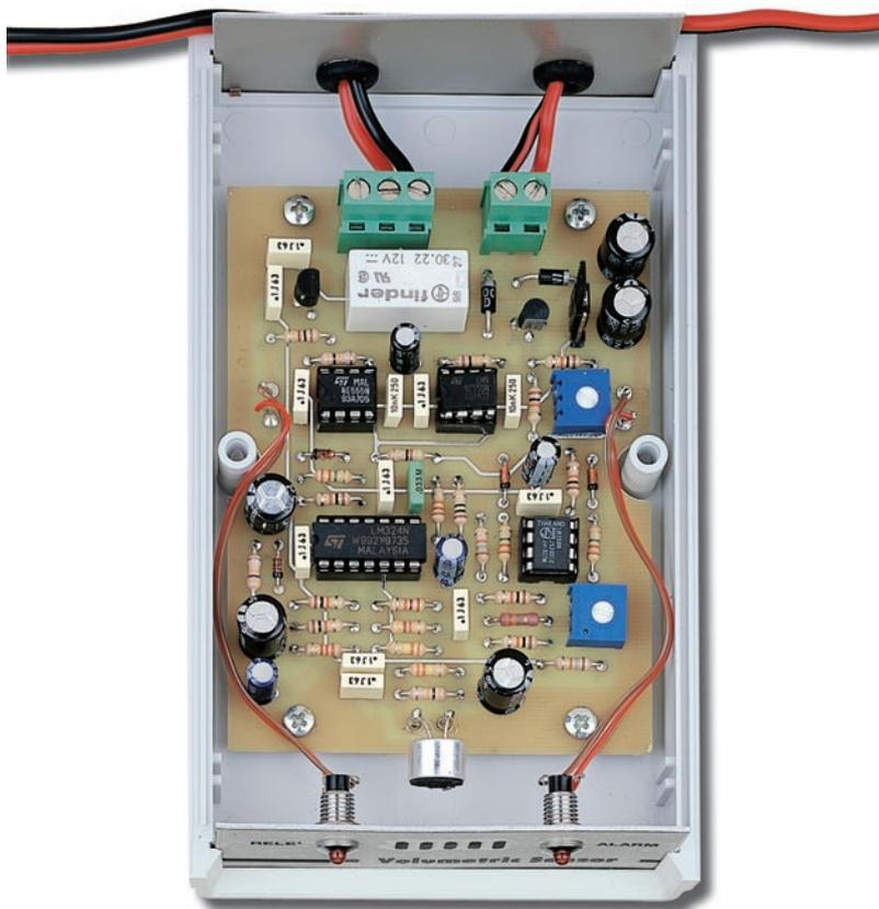
Figure 8: Après avoir fixé le circuit imprimé à l'intérieur de son coffret en plastique, sur la face avant, vissez les deux supports métalliques des deux LED DL1 et DL2.
