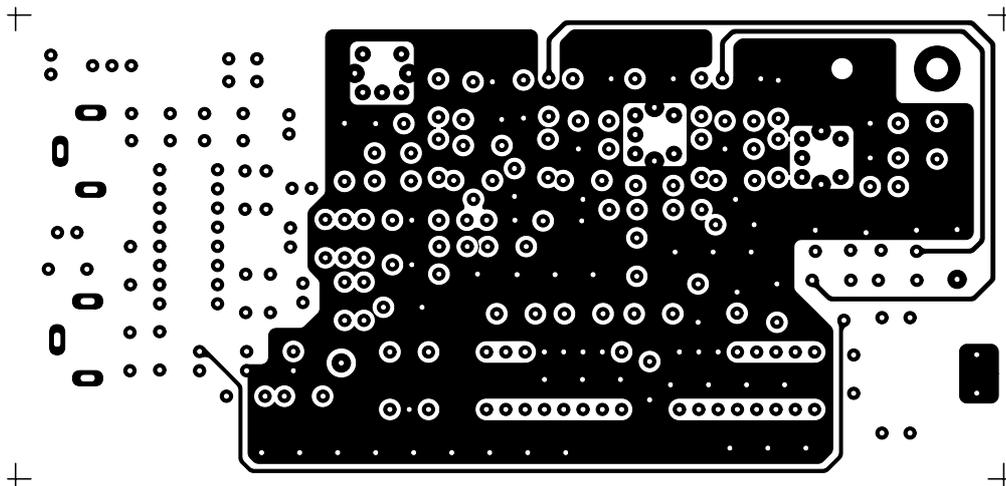
Figure 8b: Dessin, à l'échelle 1, du circuit imprimé double face de l'émetteur. Côté composants.
