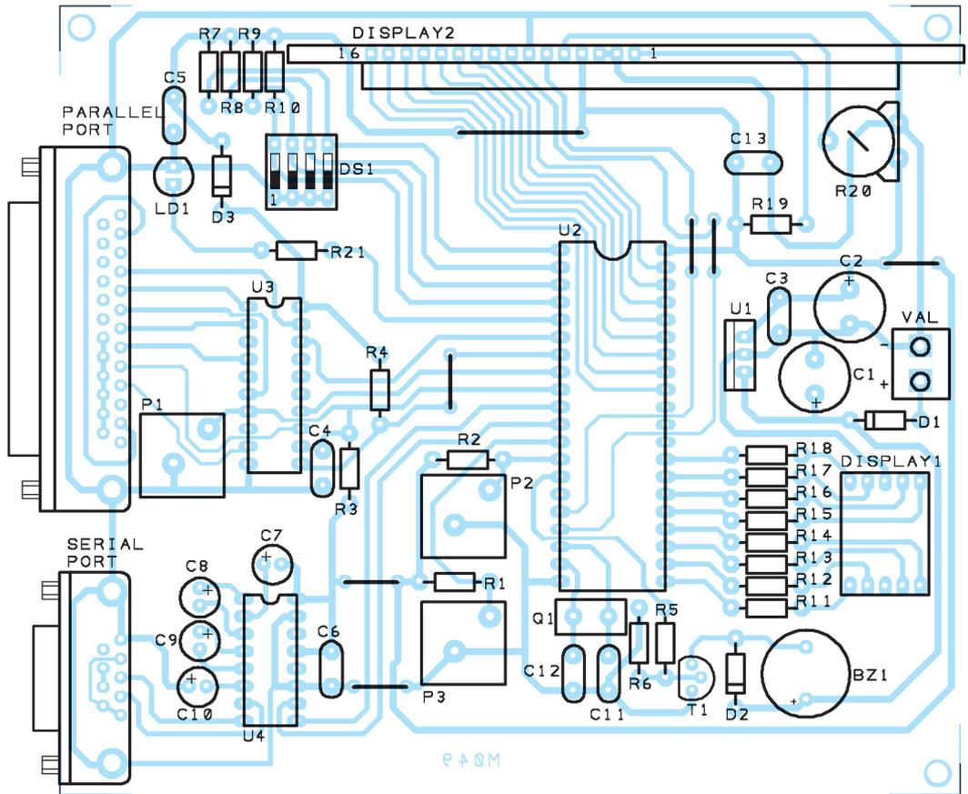
Figure 2 : Schéma d'implantation des composants de la carte de test.
