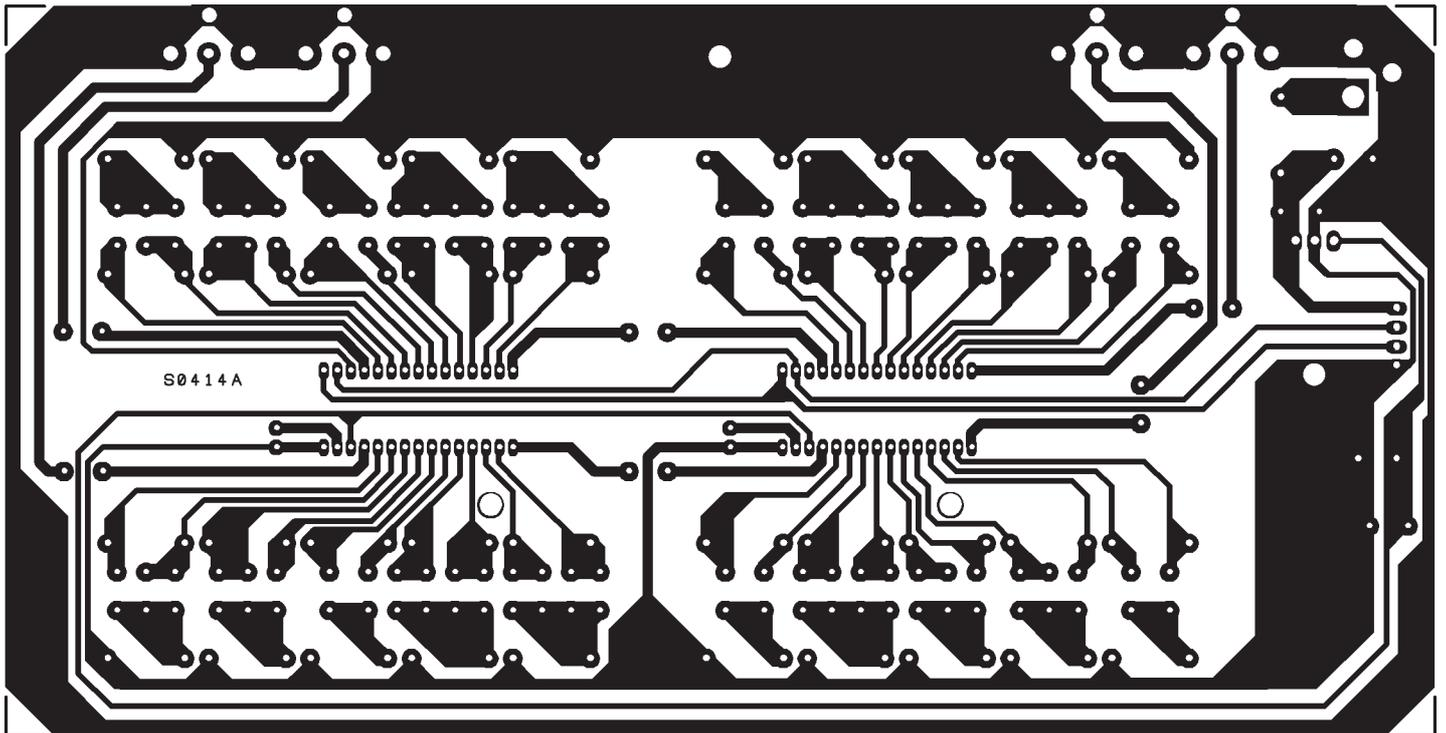
Figure 8a: Dessin, à l'échelle 1, du circuit imprimé de la carte principale de l'égaliseur stéréo à commande numérique.
