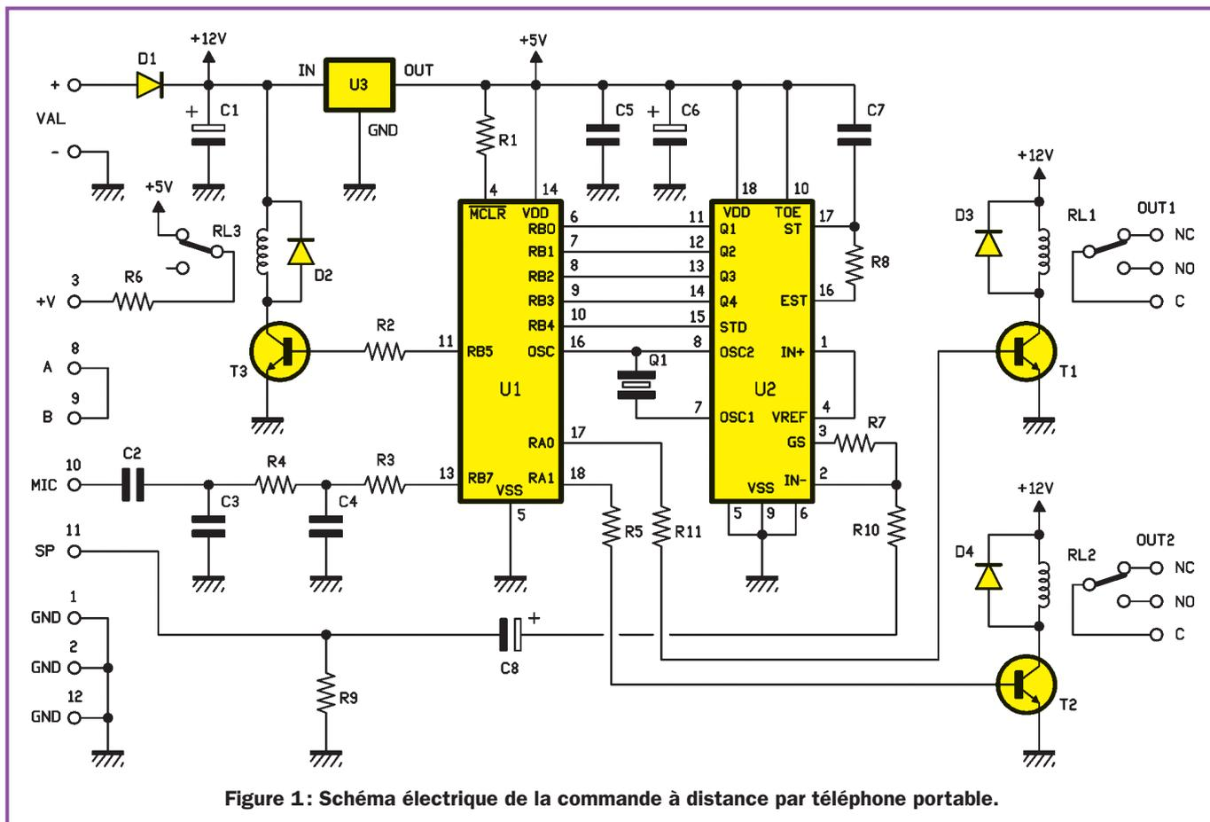
**Figure 1:** Schéma électrique de la commande à distance par téléphone portable.
