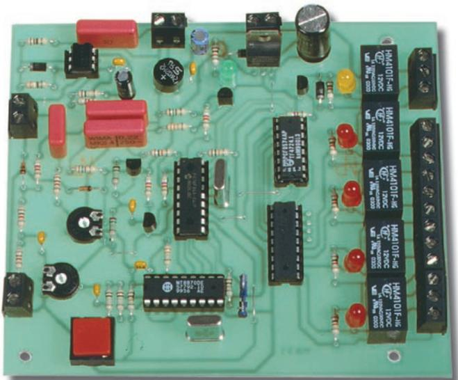
Figure 2b: Photo d'un des prototypes de la carte principale de la clef DTMF à 4 canaux (sans l'extension à 8 canaux).
