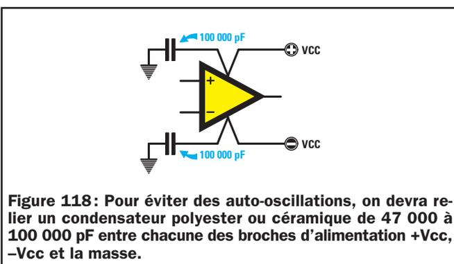
**Figure 118:** Pour éviter des auto-oscillations, on devra relier un condensateur polyester ou céramique de 47 000 à 100 000 pF entre chacune des broches d'alimentation +Vcc, -Vcc et la masse.
