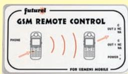
Un téléphone cellulaire et l'interface en kit ci-après permet la commande à distance, sur simple appel téléphonique d'un fixe ou d'un portable, de deux relais pouvant commuter n'importe quelle charge électrique. Kit avec boîtier et câble de liaison au téléphone portable.
