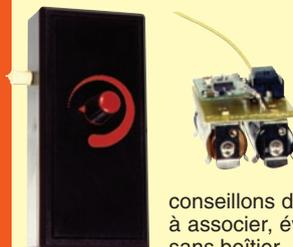
Cet appareil, un micro-émetteur UHF, est conçu pour localiser la position d'une personne, d'un animal, d'une voiture, ou d'un aéromodèle. Ce système économique et efficace travaille sur la fréquence, peu encombrée et donc tout à fait indiquée pour cette application, de 868 MHz. Pour la réception, nous vous conseillons d'utiliser le récepteur FT407 (kit avec boîtier) à associer, éventuellement, à une antenne directive. Kit sans boîtier.
