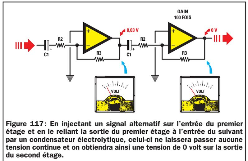
**Figure 117:** En injectant un signal alternatif sur l'entrée du premier étage et en le reliant la sortie du premier étage à l'entrée du suivant par un condensateur électrolytique, celui-ci ne laissera passer aucune tension continue et on obtiendra ainsi une tension de 0 volt sur la sortie du second étage.
