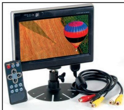
Le menu est affiché sur l'écran (OSD) pour les réglages de volume, couleur, luminosité, contraste. Il procure une image très brillante et dispose d'un rétro-éclairage intégré. Plat et léger, il est compact (180 x 130 x 34 mm) et prévu pour durer.
