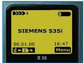
Ce dispositif, composé d'un téléphone portable Siemens de la série 35 et d'une interface de commande, comporte un relais de sortie pouvant être activé à distance par un appel provenant d'un téléphone, fixe ou portable, dont le numéro a été préalablement mémorisé parmi 200 numéros possibles. La mémorisation des numéros habilités peut même être effectuée à distance par une personne autorisée sans qu'il soit nécessaire d'accéder physiquement à l'appareil.
