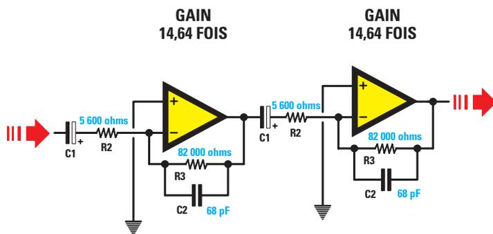
Figure 126 : Deux étages amplificateurs avec entrée inverseuse recevant un signal en alternatif. Avec les valeurs reportées de R2 et R3, le premier et le second étage amplifieront 14,64 fois un signal, on obtiendra donc un gain total de  $14,64 \times 14,64 = 214,3$ .
