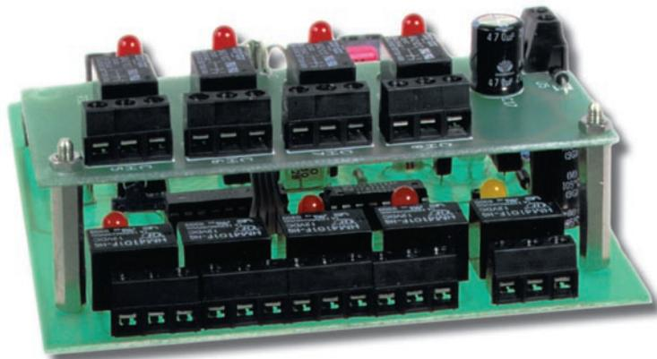
Figure 4a: Photo d'un des prototypes de la clef DTMF vue de face.
