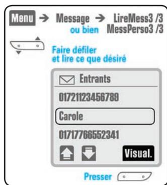
(ou Messages Personnels). Ils doivent tous être effacés ! Pour ce faire, il suffit de les sélectionner un par un, de les visualiser et, en utilisant le menu "Options", de sélectionner "Effacer Message" et de confirmer. Il faut effacer tous les numéros présents dans la rubrique du
