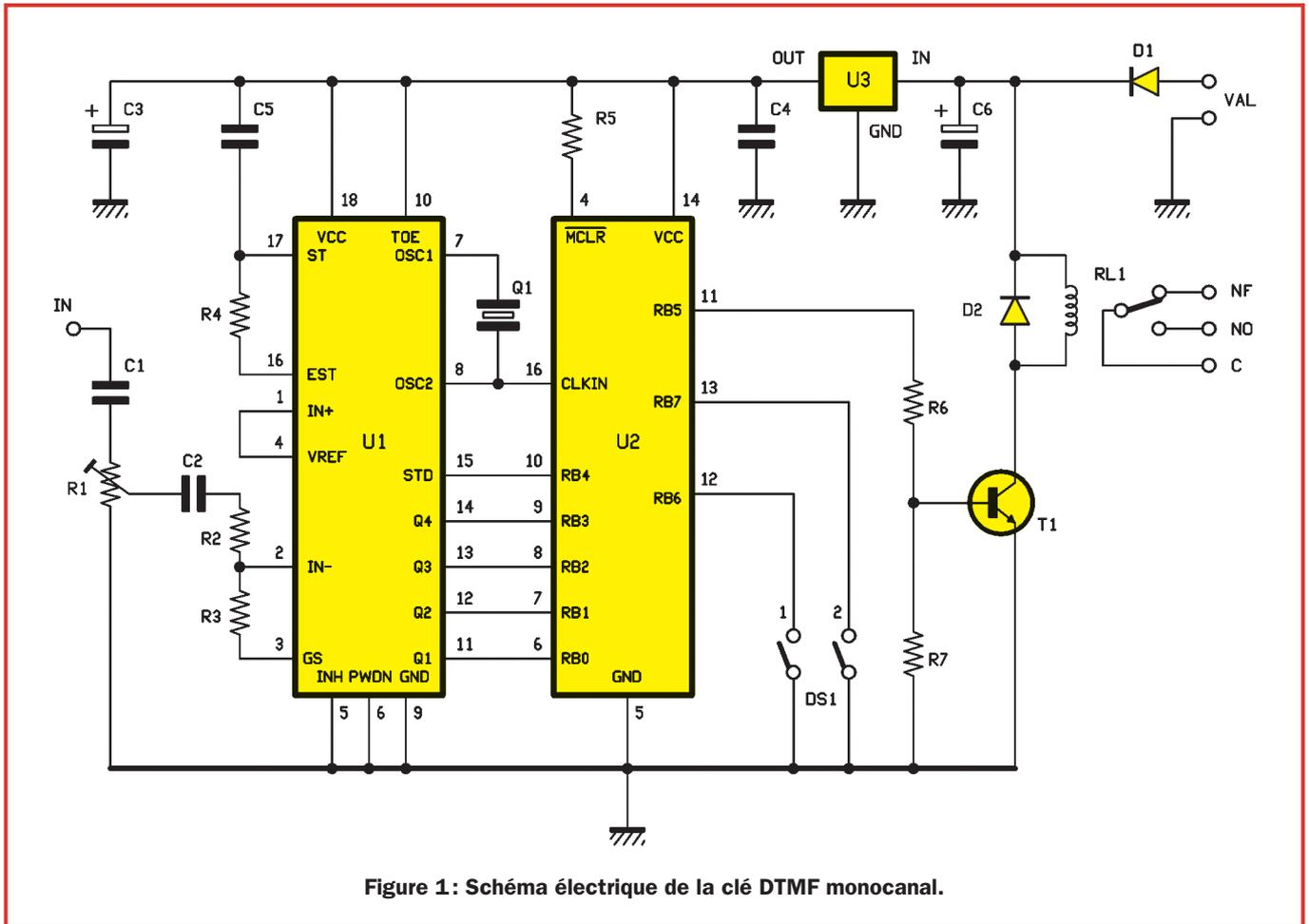
Figure 1 : Schéma électrique de la clé DTMF monocanal.
