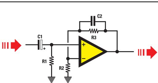
**Figure 120 :** Dans les étages préamplificateurs BF, on place toujours, en parallèle, un petit condensateur (voir C2) sur la résistance R3 pour empêcher que l'opérationnel n'amplifie des fréquences ultrasoniques.
