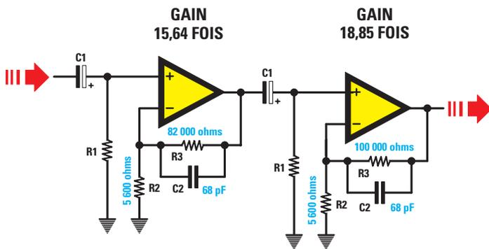
Figure 125 : Deux étages amplificateurs avec entrée non inverseuse recevant un signal en alternatif. Avec les valeurs reportées de R2 et R3, le premier étage amplifiera 15,64 fois un signal et le second étage 18,85, on obtiendra donc un gain total de  $15,64 \times 18,85 = 294,8$ .
