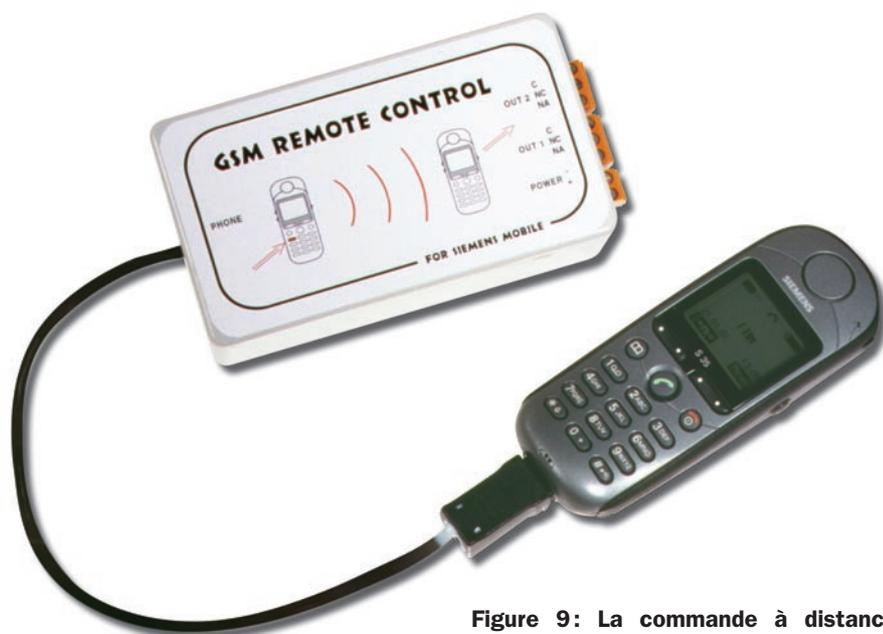
**Figure 9: La commande à distance par téléphone portable raccordée au Siemens S35.**
