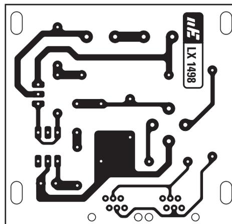
Figure 6: Dessin, à l'échelle 1, du circuit imprimé de la "sonnerie" lumineuse.
