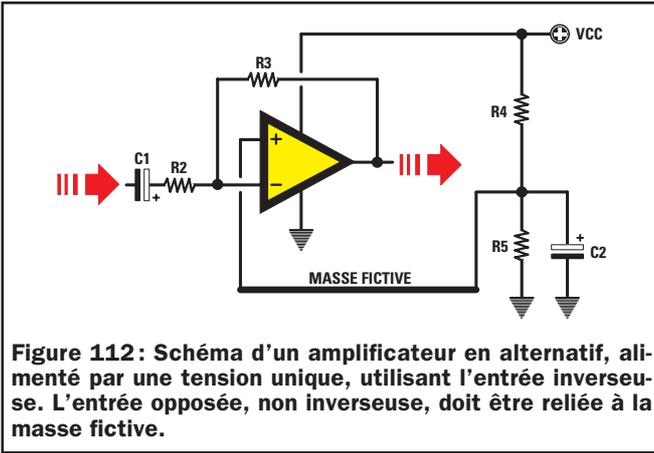
**Figure 112:** Schéma d'un amplificateur en alternatif, alimenté par une tension unique, utilisant l'entrée inverseuse. L'entrée opposée, non inverseuse, doit être reliée à la masse fictive.
