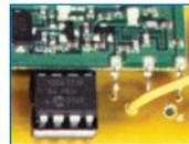
Cet appareil, un micro-émetteur UHF, est conçu pour localiser la position d'une personne, d'un animal, d'une voiture, ou d'un aéromodèle. Ce système économique et efficace travaille sur la fréquence, peu encombrée et donc tout à fait indiquée pour cette application, de 868 MHz. Pour la réception, nous avons utilisé le même récepteur que celui accompagnant le mini micro HF EF.406\* à associer, éventuellement, à une antenne directive. (\* ELM 35 p. 46)
