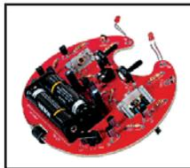
sibilité et de déterminer ainsi le "comportement" du robot. La vitesse est réglable. L'utilisateur a le choix entre deux "démarches" : droit ou en "crabe". Les "yeux" à LED indiquent le sens de la marche. Le robot s'arrête dans l'obscurité totale.
