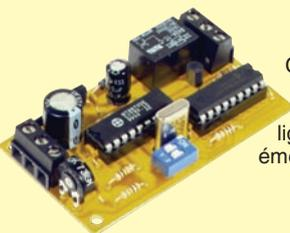
Ce kit permet de commander à distance un appareil au moyen des tons DTMF ordinaires. Il se connecte soit à une ligne téléphonique soit à la sortie d'un émetteur-récepteur radio. Kit sans boîtier.
