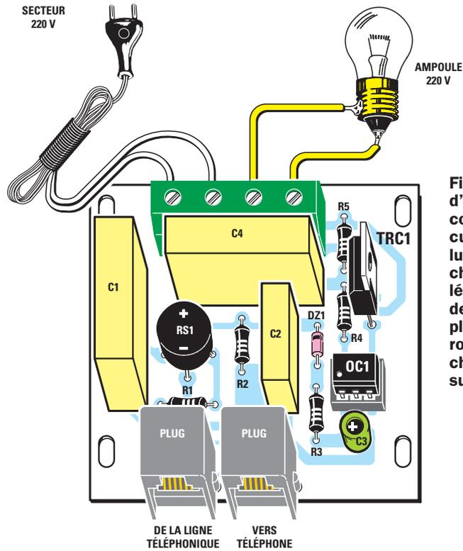
Figure 4: Schéma, d'implantation des composants du circuit permettant d'allumer une ampoule à chaque sonnerie téléphonique. Dans les deux prises femelles placées en bas, seront insérées les fiches mâles visibles sur la figure 6.
