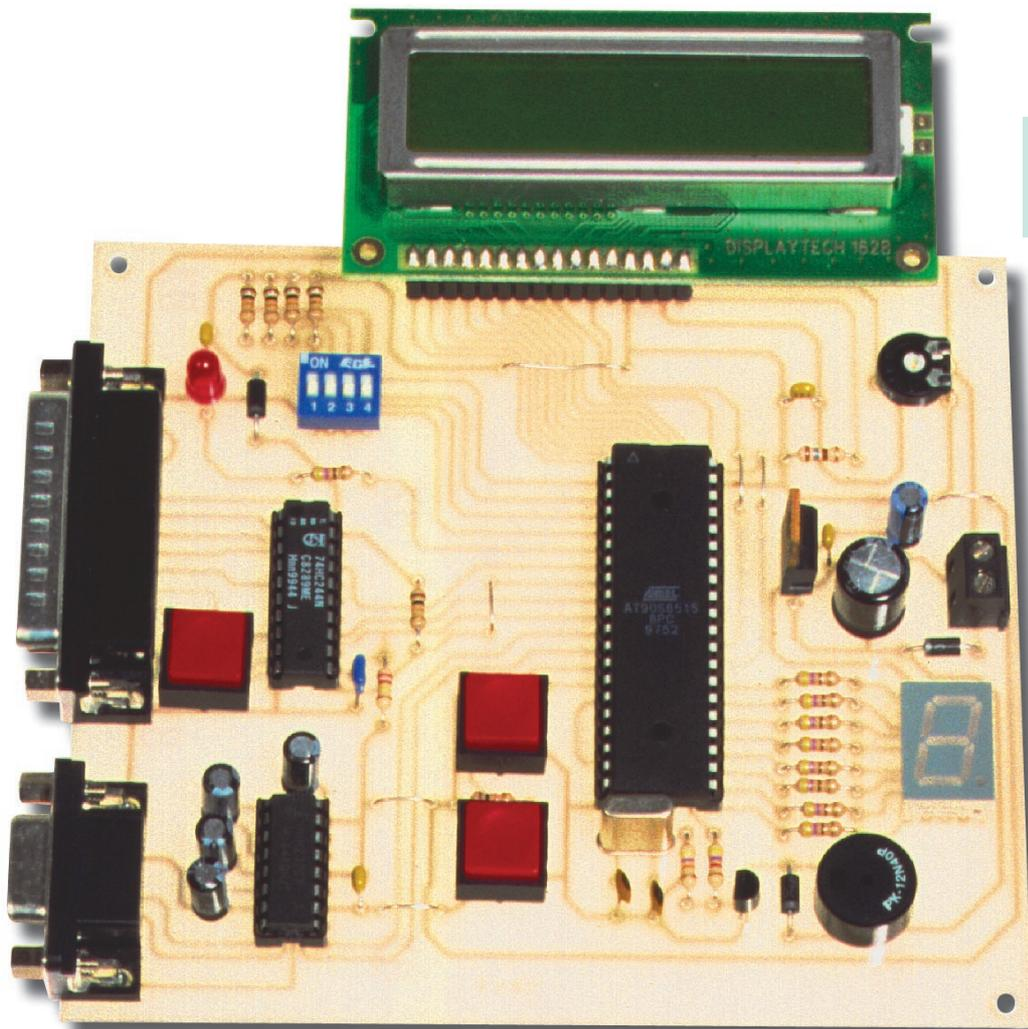
Figure 3 : Photo d'un des prototypes de la carte de test avec l'afficheur en place.
