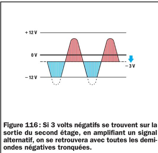
**Figure 116:** Si 3 volts négatifs se trouvent sur la sortie du second étage, en amplifiant un signal alternatif, on se retrouvera avec toutes les demi-ondes négatives tronquées.
