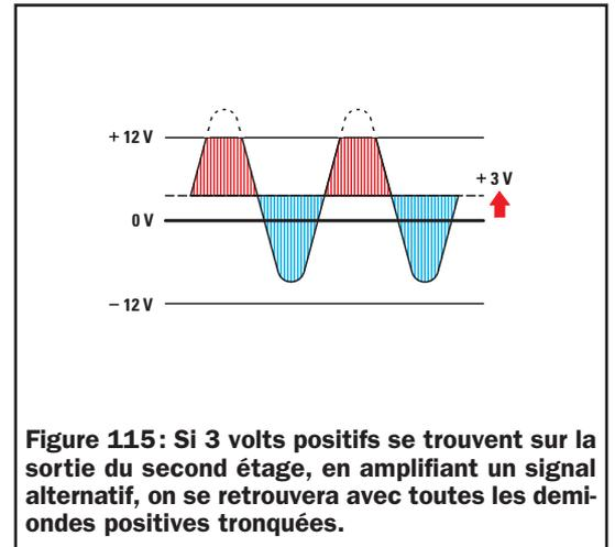
**Figure 115:** Si 3 volts positifs se trouvent sur la sortie du second étage, en amplifiant un signal alternatif, on se retrouvera avec toutes les demi-ondes positives tronquées.
