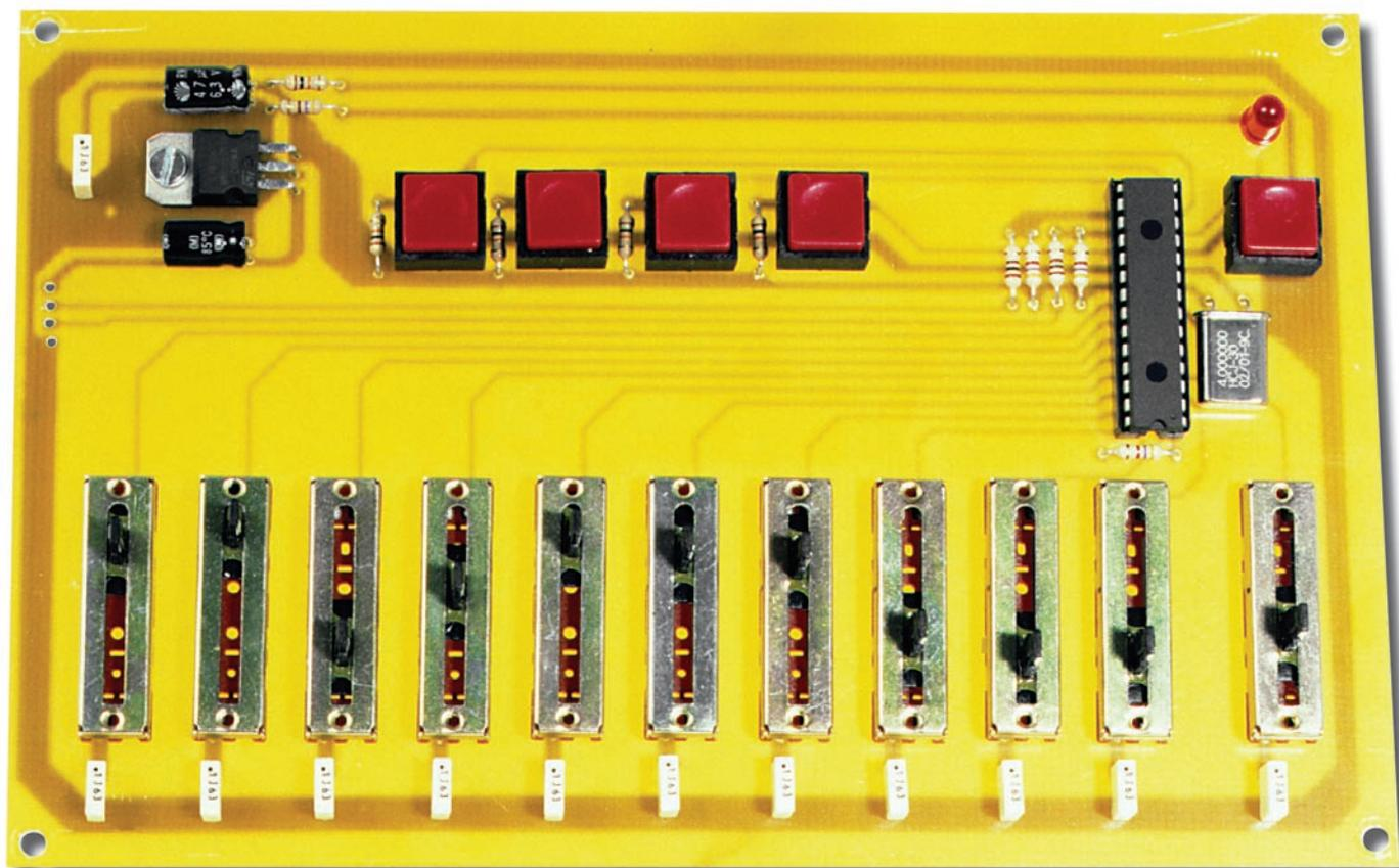
**Figure 7b:** Photo d'un des prototypes de l'égaliseur stéréo à commande numérique. Carte de commandes avec le microcontrôleur et les mémoires. Ici, en revanche, tout le travail est confié au microcontrôleur PIC16F876-MF414, déjà programmé en usine.
