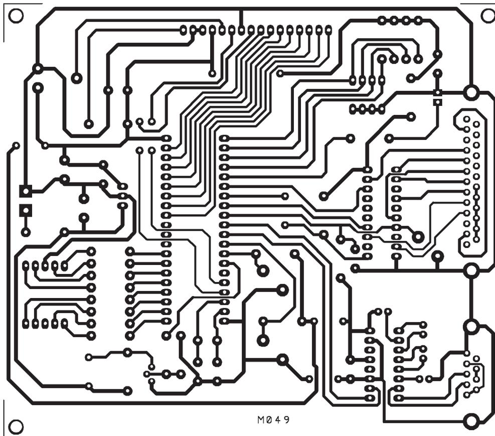
Figure 4 : Dessin, à l'échelle 1, du circuit imprimé de la carte de test. Il pourra être réalisé par la méthode décrite dans le numéro 26 d'ELM.
