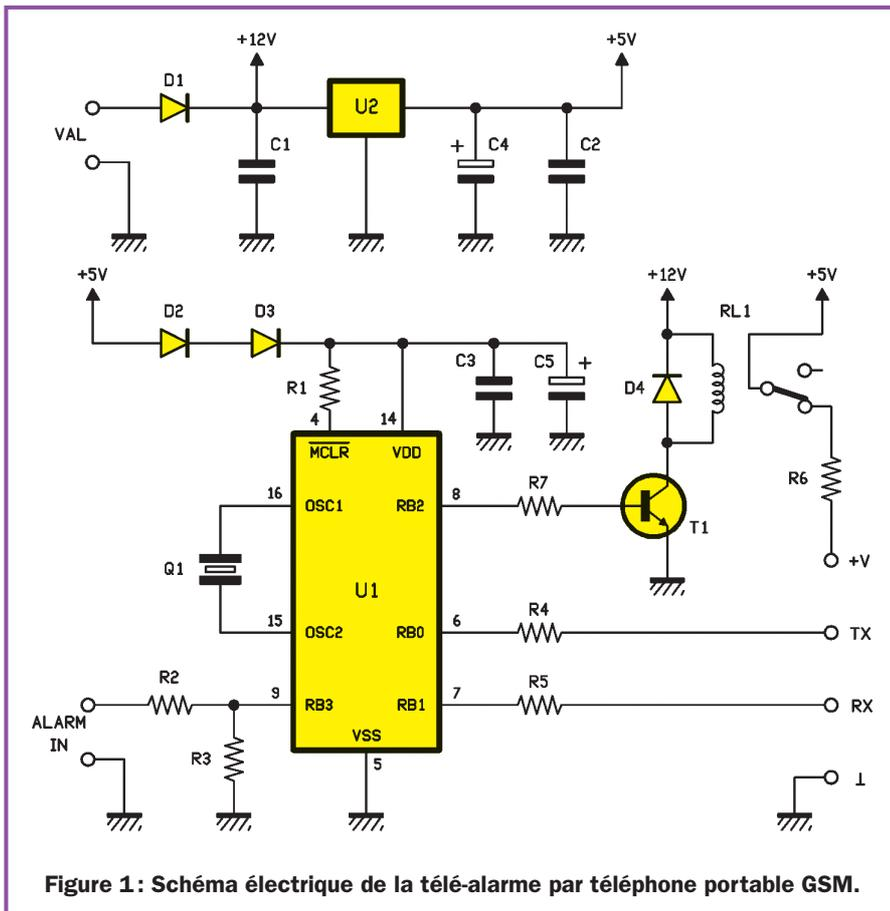
Figure 1: Schéma électrique de la télé-alarme par téléphone portable GSM.
