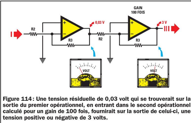
**Figure 114:** Une tension résiduelle de 0,03 volt qui se trouverait sur la sortie du premier opérationnel, en entrant dans le second opérationnel calculé pour un gain de 100 fois, fournirait sur la sortie de celui-ci, une tension positive ou négative de 3 volts.
