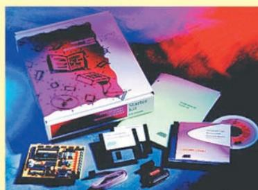
Système de développement pour les nouveaux microcontrôleurs 8 bits Flash de la famille ATMEL AVR.
