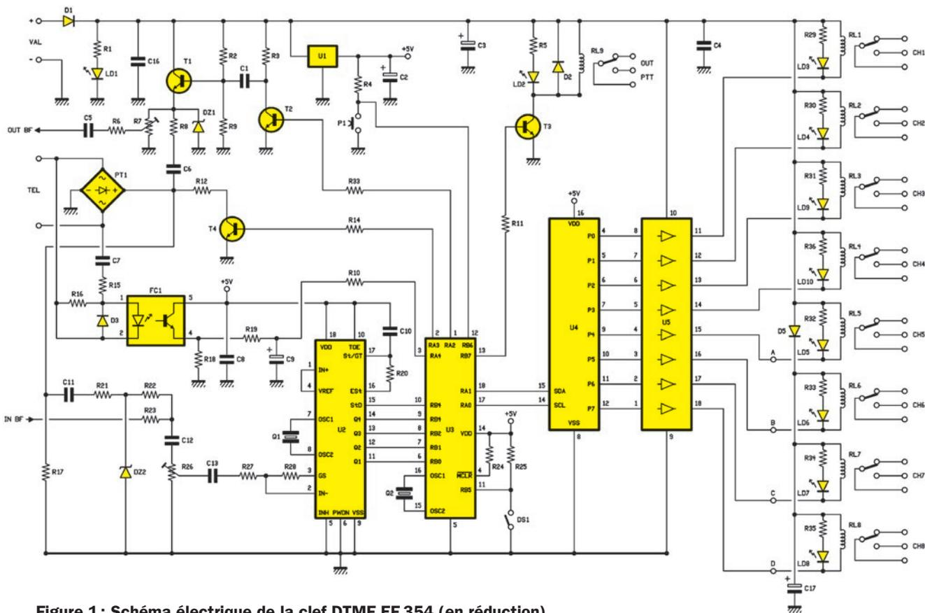
Figure 1: Schéma électrique de la clef DTMF EF.354 (en réduction).
