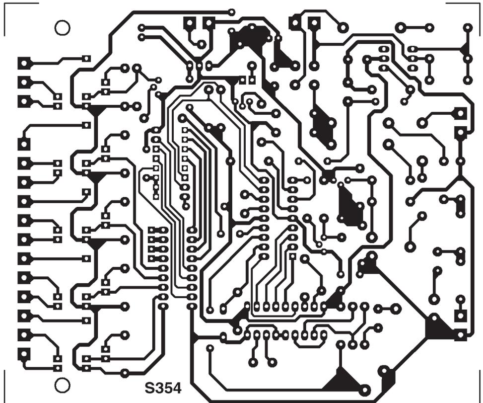
Figure 2c: Dessin, à l'échelle 1, du circuit imprimé de la carte principale EF.354.
