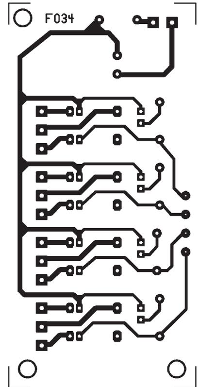
Figure 3c: Dessin, à l'échelle 1, du circuit imprimé de la carte d'extension EF.110.
