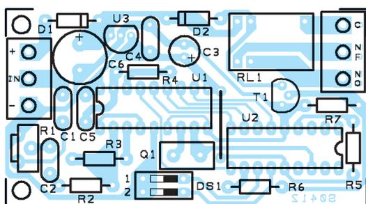
Figure 5: Schéma d'implantation des composants de la clé DTMF monocal.
