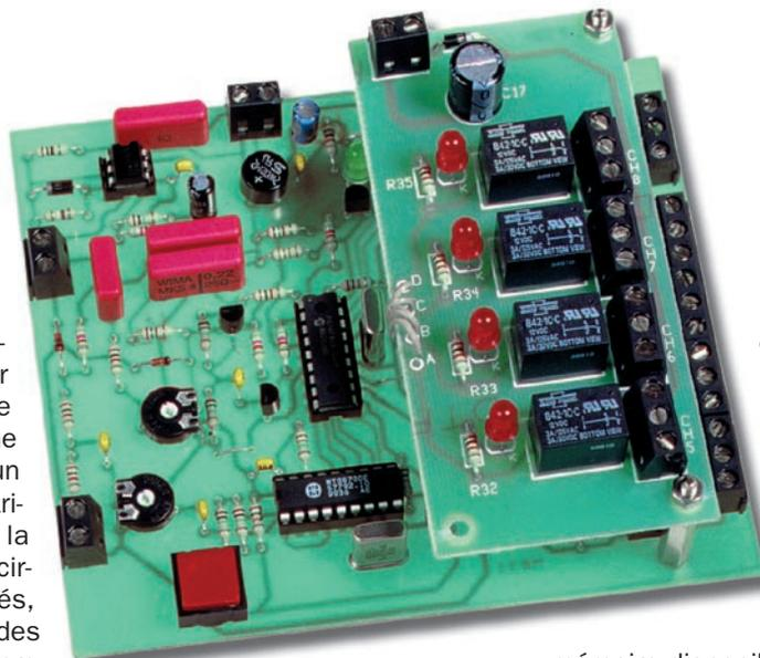
clef en mesure de fonctionner par radio ou par ligne téléphonique.
