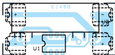
Figure 2: Schéma d'implantation des composants de l'émetteur du localiseur sur 868 MHz.
