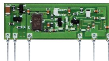
Figure 5: Le module Aurel TX8LAVSA05 vu côté soudures.
