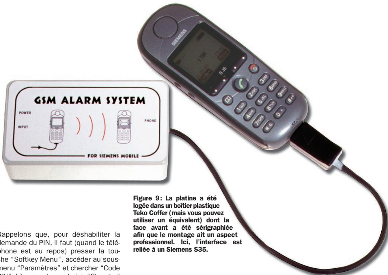
**Figure 9:** La platine a été logée dans un boîtier plastique Teko Coffre (mais vous pouvez utiliser un équivalent) dont la face avant a été sérigraphiée afin que le montage ait un aspect professionnel. Ici, l'interface est reliée à un Siemens S35.
