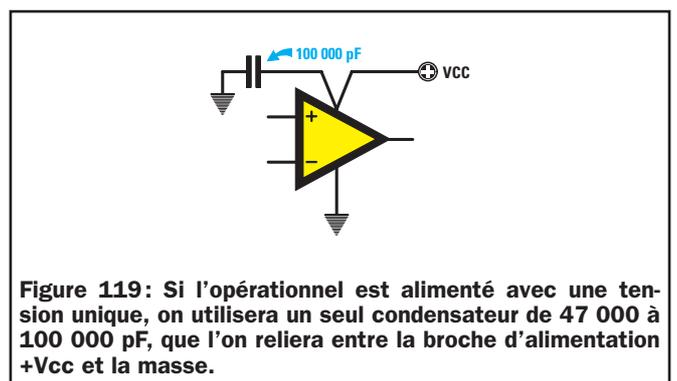
**Figure 119:** Si l'opérationnel est alimenté avec une tension unique, on utilisera un seul condensateur de 47 000 à 100 000 pF, que l'on reliera entre la broche d'alimentation +Vcc et la masse.
