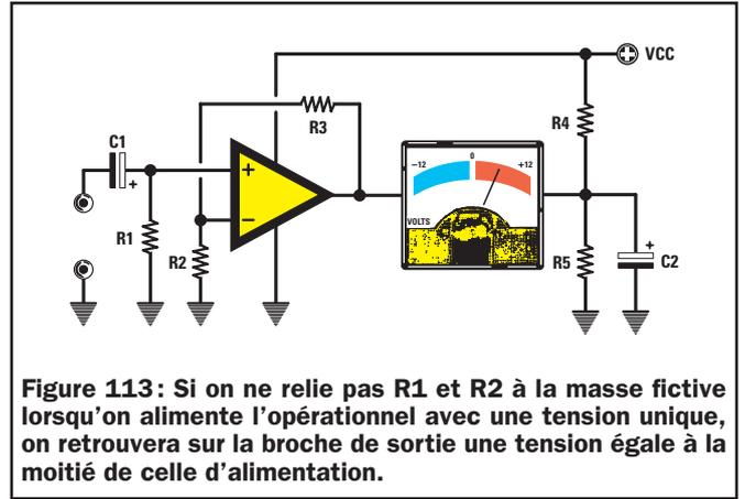
**Figure 113:** Si on ne relie pas R1 et R2 à la masse fictive lorsqu'on alimente l'opérationnel avec une tension unique, on retrouvera sur la broche de sortie une tension égale à la moitié de celle d'alimentation.
