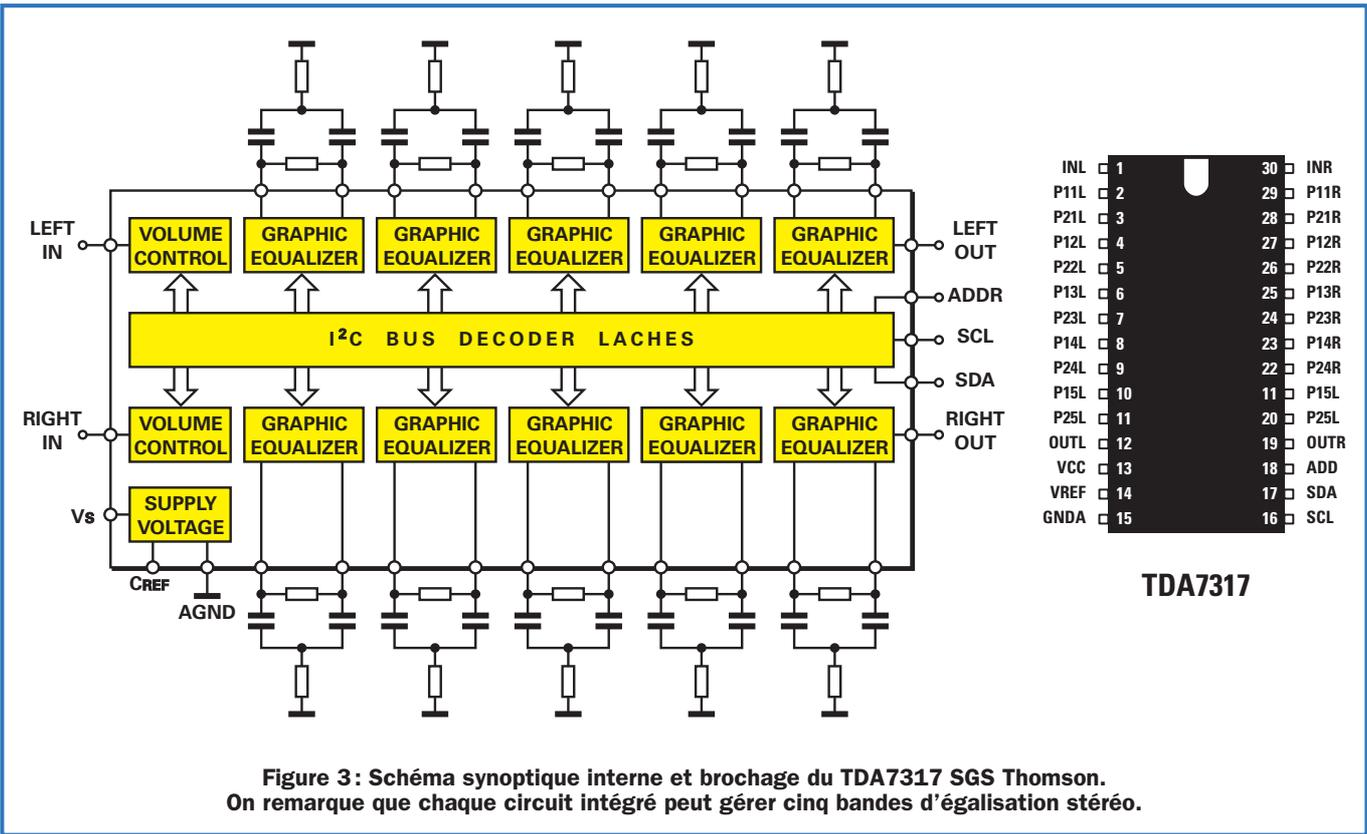
Figure 3: Schéma synoptique interne et brochage du TDA7317 SGS Thomson. On remarque que chaque circuit intégré peut gérer cinq bandes d'égalisation stéréo.
