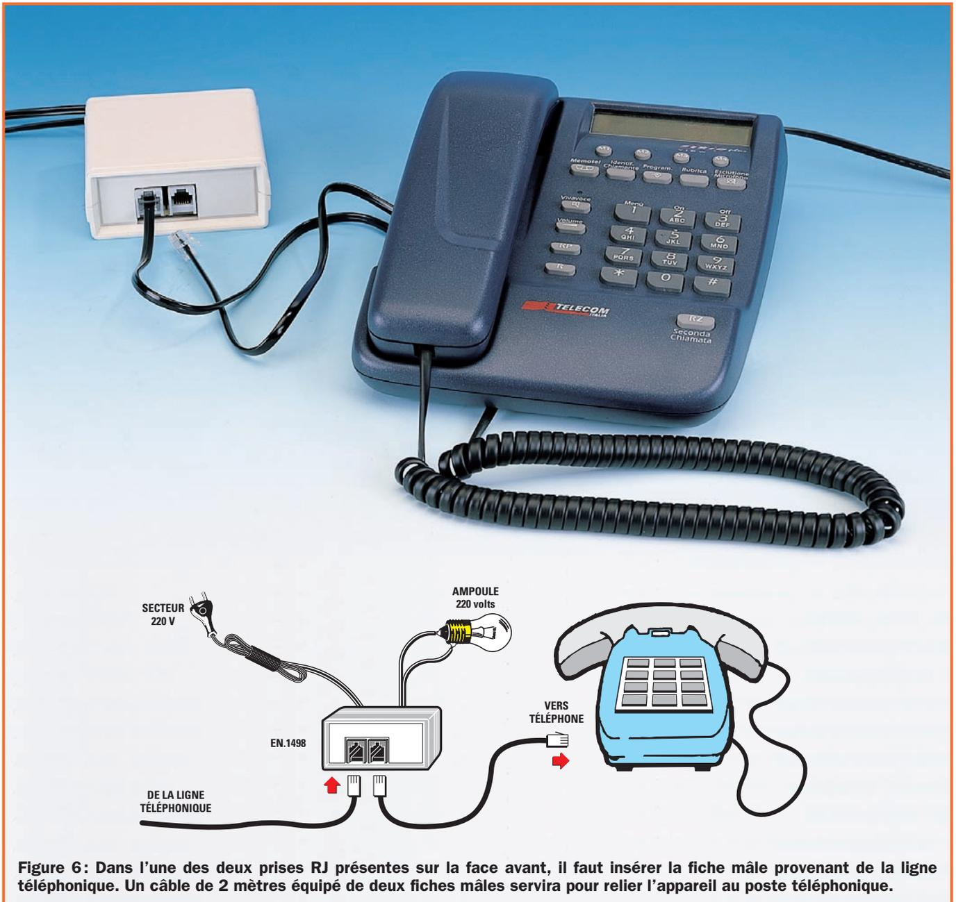
Figure 6: Dans l'une des deux prises RJ présentes sur la face avant, il faut insérer la fiche mâle provenant de la ligne téléphonique. Un câble de 2 mètres équipé de deux fiches mâles servira pour relier l'appareil au poste téléphonique.
