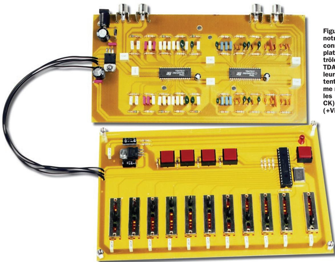
Figure 5: Les deux cartes de notre prototype dûment interconnectées. Une fois les deux platines reliées, le microcontrôleur peut piloter les deux TDA7317 en fonction des valeurs lues aux bornes des potentiomètres à glissière. Comme nous travaillons en FCBUS, les deux fils du signal (DT et CK) et ceux de l'alimentation (+Vin et GND) sont suffisants.
