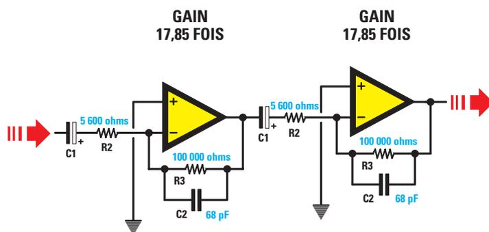
Figure 127 : Deux étages amplificateurs avec entrée inverseuse recevant un signal en alternatif. Avec les valeurs reportées de R2 et R3, le premier et le second étage amplifieront 17,85 fois un signal, on obtiendra donc un gain total de  $17,85 \times 17,85 = 318,6$ .
