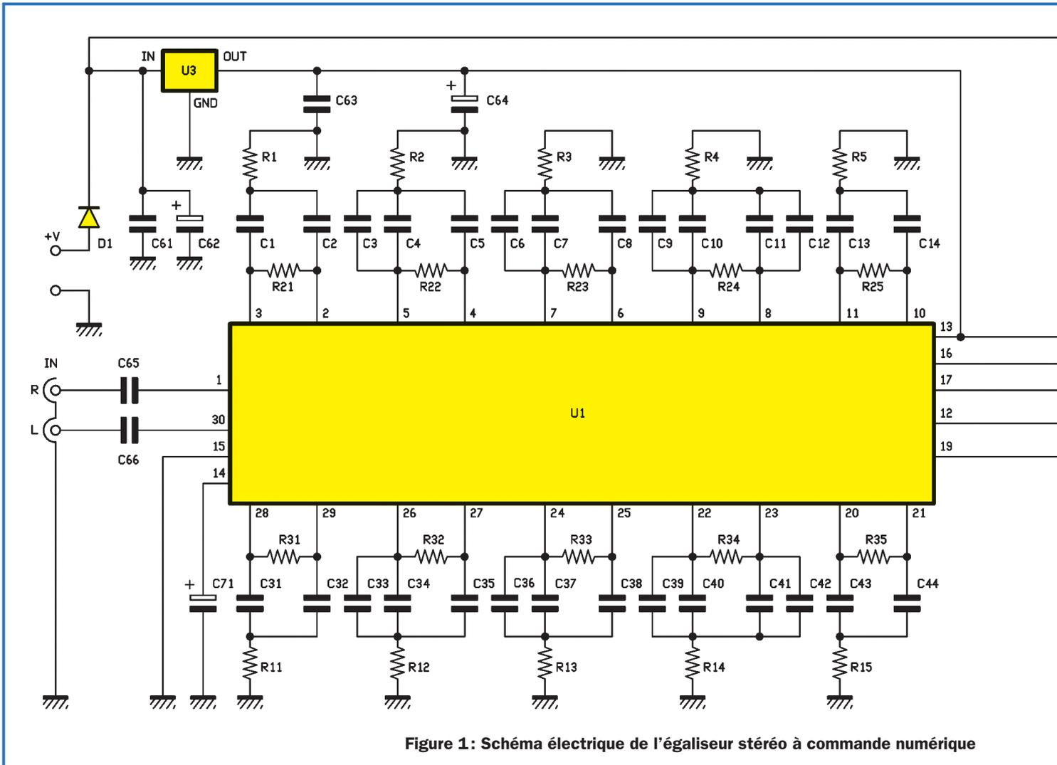
Figure 1: Schéma électrique de l'égaliseur stéréo à commande numérique
