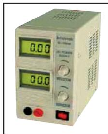
Tension de sortie réglable de 0 à 15 V sous 3 A (réglable également). Affichage de la tension et du courant sur deux LCD rétroéclairés. Bornes au standard IEC-1010. Dimensions 225 x 95 x 160 mm. Poids 2,5 kg.
