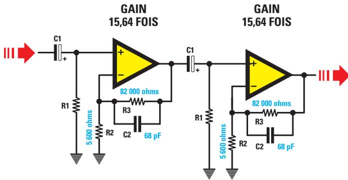
Figure 124 : Deux étages amplificateurs avec entrée non inverseuse recevant un signal alternatif. Avec les valeurs reportées de R2 et R3, le premier et le second étage amplifieront 15,64 fois un signal, on obtiendra donc un gain total de  $15,64 \times 15,64 = 244,6$ .
