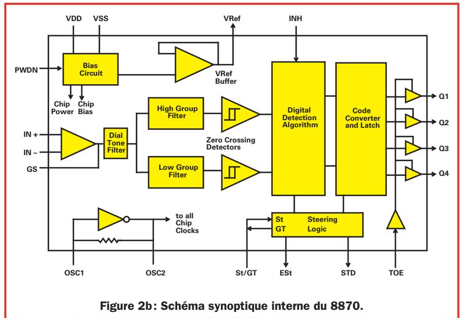
**Figure 2b: Schéma synoptique interne du 8870.**
