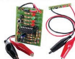
Le kit MK132 est prévu pour contrôler la continuité de câbles et identifier les fils dans un multibrin ou un toron. Il est aussi idéal pour tester les câbles de haut-parleurs. Il permet l'indication, par LED, de circuits ouverts, courts-circuits ou de polarité incorrecte ou erronée. Mis en fonctionnement par un poussoir, il s'éteint de lui-même. Alimenté par une pile de 9 V, il consomme une dizaine de milliampères. Les dimensions du circuit imprimé principal sont: 56 x 40 x 33 mm.
