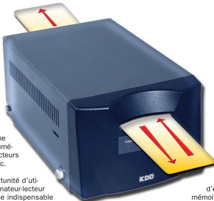
Mais il est compatible avec les cartes G&D (série STARCOS SV 1.1), Schlumberger ME2000 type ATR (Answer To Reset) basées sur une puce à brochage conforme au standard ISO7816 PART 2 et répondant au "power-on" par réinitialisation et envoi d'un code spécial de 15 octets contenant toutes les informations d'état et les données en mémoire.
