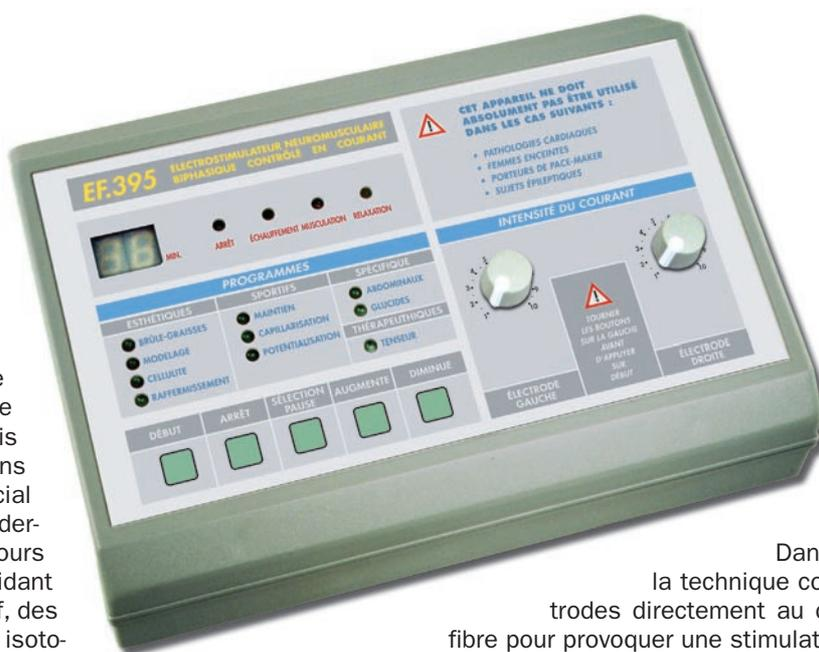
électrodes placées sur la surface de la peau : le champ électrique se formant entre les deux électrodes provoque l'excitation des circuits nerveux qu'il investit.
