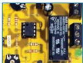
Voici un thermostat analogique simple mais qui se révèle être performant. Il se comporte comme un interrupteur qui serait activé ou désactivé par la température franchissant un seuil inférieur ou supérieur défini. Il s'avérera idéal dans tous les cas où il est utile de garder sous contrôle la température d'un local, en pilotant l'installation de chauffage ou de climatisation.
