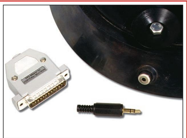
**Figure 2 : Le jack-mémoire et le connecteur de l'interface parallèle. Grâce au jack-mémoire, plus besoin de câble de connexion à l'ordinateur. La programmation en est grandement facilitée.**
