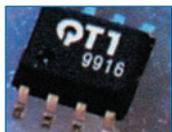
Cet interrupteur à effleurement permet de commander des charges fonctionnant directement sur le 220 volts alternatif, consommant jusqu'à 4 ampères. Il utilise le très innovant circuit intégré QT110 de la société QUANTUM et le non moins récent VB409 de SGS-THOMSON.
