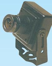
Capteur : CCD 1/3". Système : PAL. Résolution : 400 lignes TV (270 000 pixels). Sensibilité : 0,4 lux. Sortie vidéo : 1 Vpp à 75 Ω. Tension d'alimentation : 9,5 à 16 V. Consommation : 110 mA. Dim : 31 x 31 x 29 mm. T° de fonctionnement : -10°C à +50°C. Angle 92°. Optique : f = 3,6 mm F 2,0.
