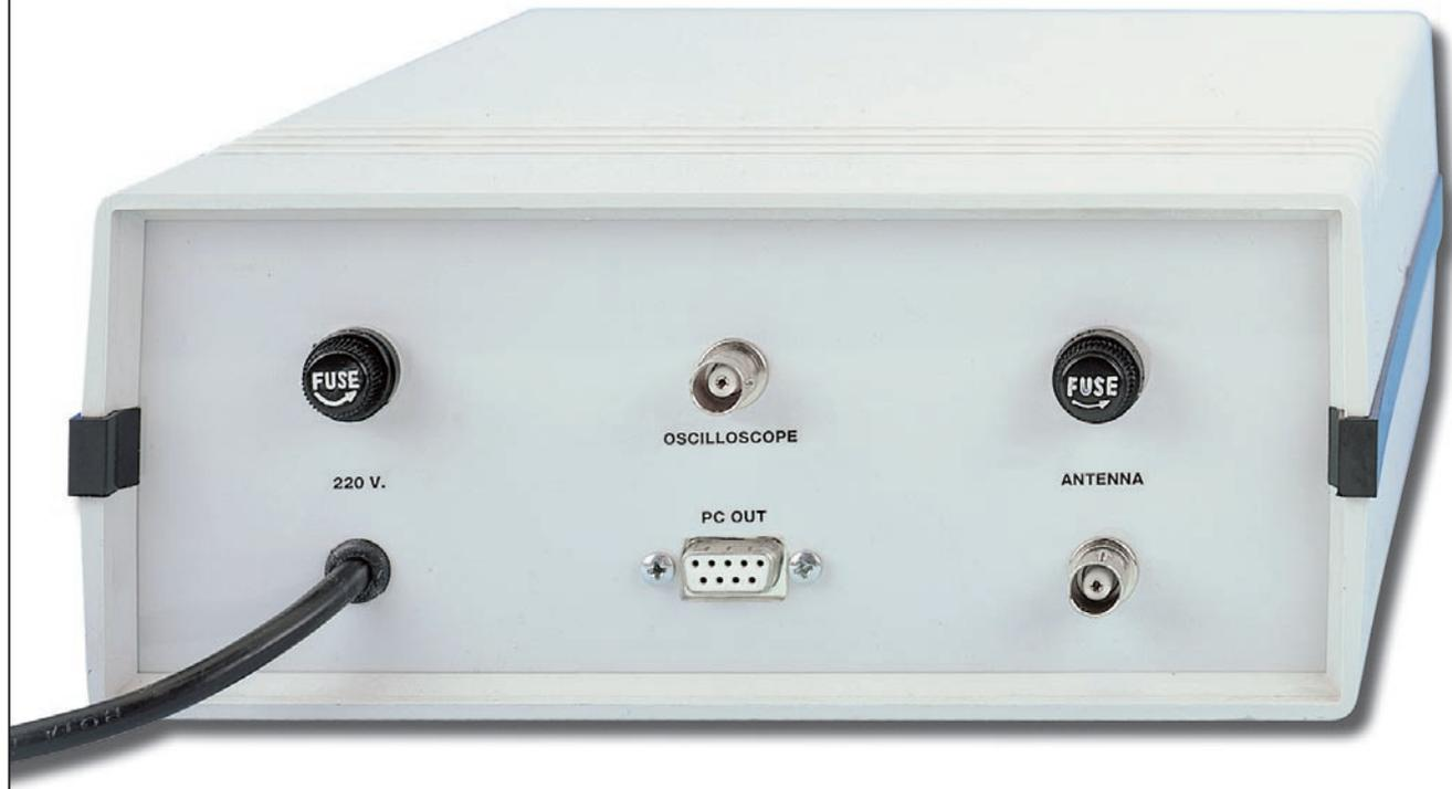
Figure 25 : Sur la face arrière vous trouvez, à gauche, le fusible secteur et, à droite, celui de l'alimentation du convertisseur TV.970 fixé à la parabole. Dans le connecteur PC OUT, on insère le câble série allant vers l'interface EN.1497 qui vous sera présentée dans le prochain numéro d'ELM. La BNC centrale permet de connecter un oscilloscope pour visualiser les signaux reçus (figures 17 et 18).
