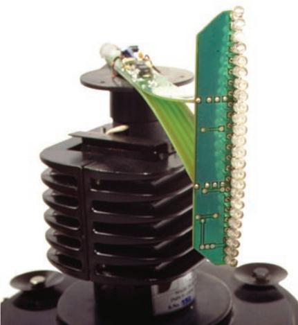
leur pilotant par ailleurs la barre des LED. Ils peuvent être modifiés à volonté au moyen d'un programme, sur un PC tournant sous Windows. La mise à jour nécessite l'utilisation du logiciel de configuration. Mais d'abord il faut brancher, sur le port parallèle, le connecteur d'interface dans lequel doit être inséré le jack fourni (figure 2). Le texte voulu est transféré dans ce jack contenant une électronique miniaturisée : à l'intérieur du jack se trouve une mémoire EEPROM série.
