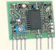
Très haute qualité de l'image et du son. Bande UHF : 479,5 MHz (canal 22). Peut être utilisé avec n'importe quelle source vidéo standard, réception sur n'importe quel récepteur TV standard.
