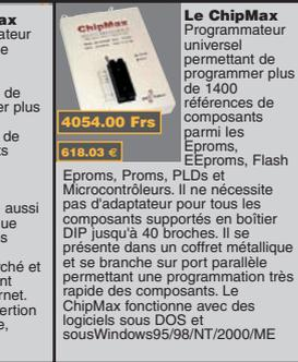
**Le ChipMax** Programmeur universel permettant de programmer plus de 1400 références de composants parmi les Eproms, Eeproms, Flash Eproms, Proms, PLDs et Microcontrôleurs. Il ne nécessite pas d'adaptateur pour tous les composants supportés en boîtier DIP jusqu'à 40 broches. Il se présente dans un coffret métallique et se branche sur port parallèle permettant une programmation très rapide des composants. Le ChipMax fonctionne avec des logiciels sous DOS et sous Windows95/98/NT/2000/ME
