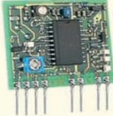
Très haute qualité de l'image et du son. Bande UHF : 479,5 MHz (canal 22). Peut être utilisé avec n'importe quelle source vidéo standard, réception sur n'importe quel récepteur TV standard.
