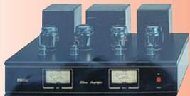
Les transformateurs de sortie sont à carcasses lamellées en acier doux à grains orientés et leur blindage est assuré par un écran de cuivre. L'ensemble est immobilisé dans une résine et moulé dans un boîtier métallique externe.
