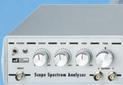
Ce kit vous permet de transformer votre oscilloscope en un analyseur de spectre performant.
