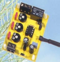
A l'aide d'une photorésistance très économique et de quelques composants périphériques, le montage que nous proposons ici détecte le mouvement de personnes ou d'objets dans un local. L'emploi d'un microcontrôleur permet au circuit de s'adapter automatiquement à n'importe quelle condition de luminosité.
