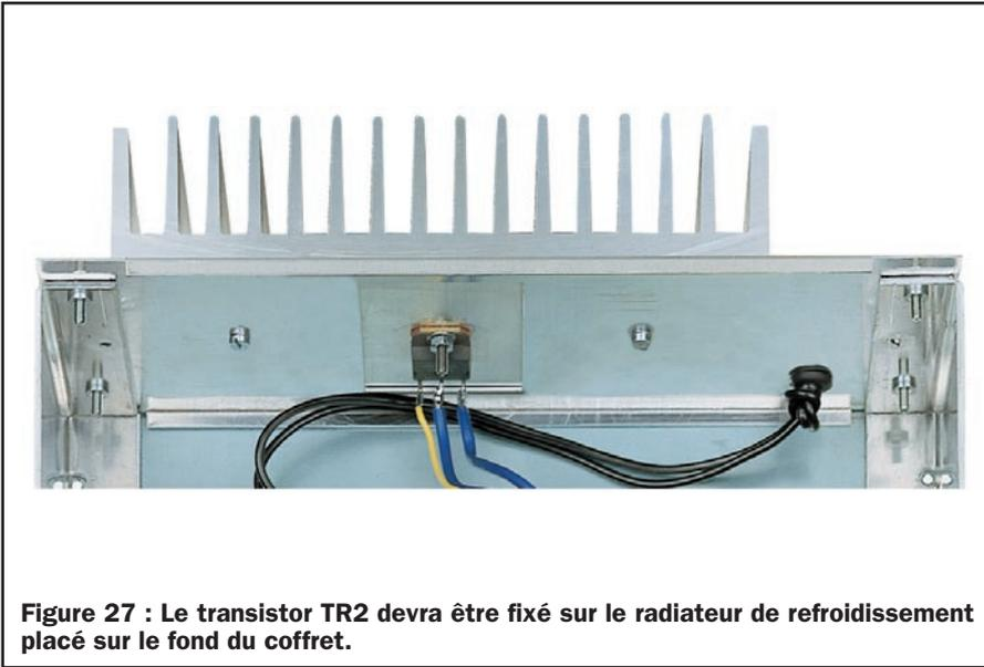
Figure 27 : Le transistor TR2 devra être fixé sur le radiateur de refroidissement placé sur le fond du coffret.
