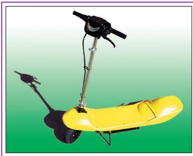
(en série pour obtenir 36 V). Un "réservoir" de ce genre donne une autonomie de presque 1 heure 30 à fond. Si l'on modère la vitesse, on peut dépasser les 2 heures. A propos de la vitesse, nous avons pu vérifier qu'avec une charge faible (30 à 50 kg) on peut atteindre 20 à 25 km/h alors qu'avec une forte charge (80 à 100 kg) la vitesse maximum atteint 20 km/h.
