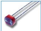
A l'aide d'une photorésistance très économique et de quelques composants périphériques, le montage que nous proposons ici détecte le mouvement de personnes ou d'objets dans un local. L'emploi d'un microcontrôleur permet au circuit de s'adapter automatiquement à n'importe quelle condition de luminosité.
