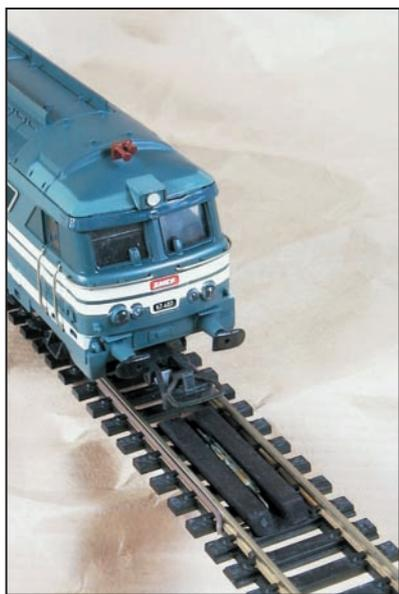
Figure 10 : La loco arrive sur le capteur. L'aimant qui se trouve dessous va le faire coller.
