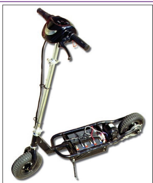
Figure 2 : Notre prototype de patinette à moteur électrique. Ici, on a enlevé le carénage, ce qui permet d'apercevoir le groupe de trois batteries au plomb-gel en série 36 V - 7 Ah garantissant une autonomie de 30 km environ à plus de 20 km/h.
