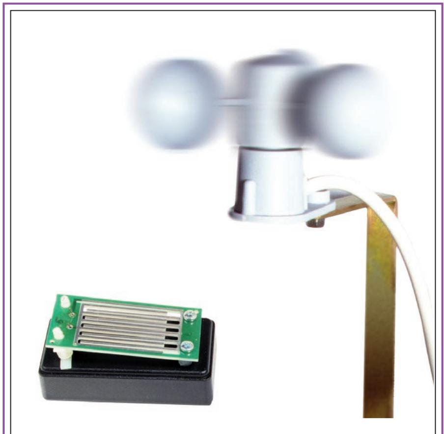
**Figure 4 : Simples mais efficaces : voici les deux capteurs employés pour capturer la présence de la pluie et pour mesurer la vitesse du vent.**
