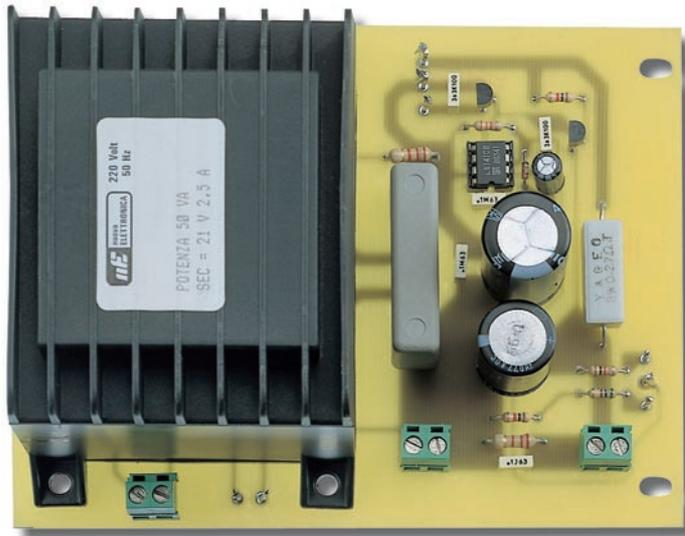
**Figure 25 :** Sur cette photo, vous pouvez voir le circuit imprimé, une fois tous les composants montés. Nous vous conseillons de maintenir la résistance bobinée R4 à une distance d'un à deux millimètres du circuit imprimé.
