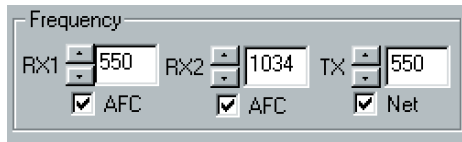
Figure 37 : Dans les petites cases de "Frequency" apparaissent les valeurs des fréquences que vous avez sélectionnées en cliquant dans les fenêtres des figures 33 et 34. Si vous avez habilité "Net" (case de droite), le programme émettra sur la fréquence de RX1.
