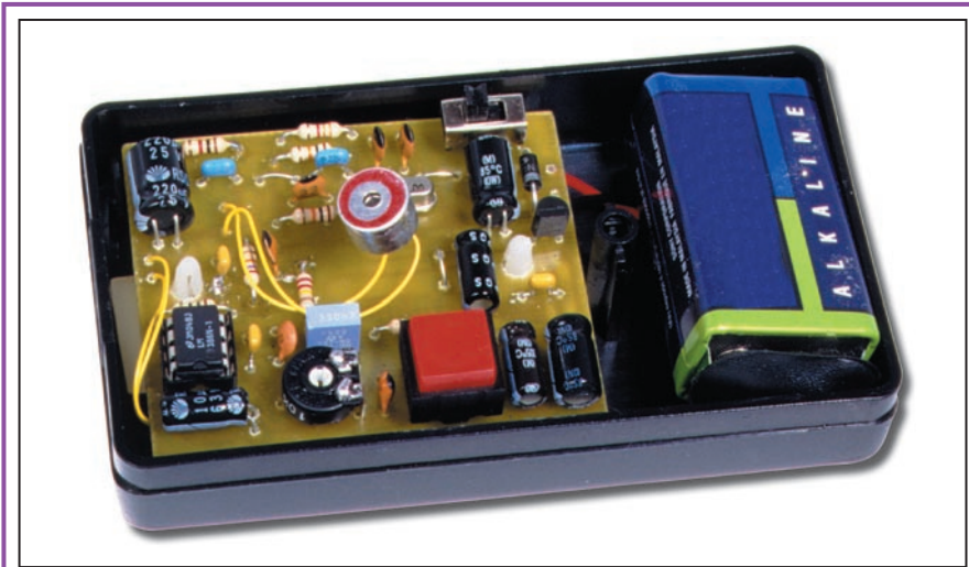
Figure 9 : Le coffret utilisé et le modèle TEK0 10009/B qui, en plus d'avoir des dimensions bien adaptées, dispose d'un logement pour y placer une pile de 9 volts.
