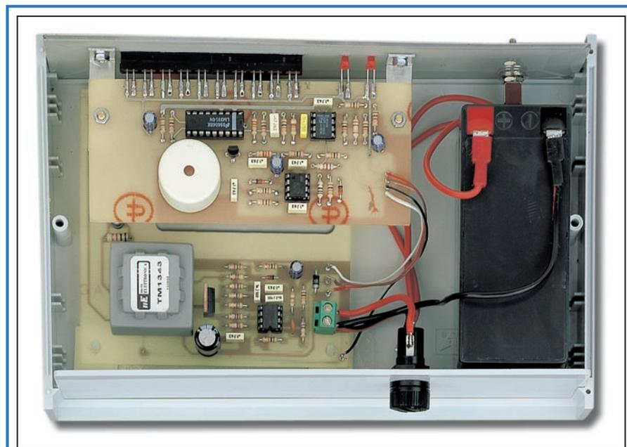
**Figure 10 : Le circuit imprimé voltmètre/buzzer est fixé au dos de la face avant à l'aide de deux équerres métalliques (voir figure 12).**
