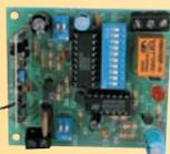
Pour radiocommande. Très bonne portée. Le nouveau module AUREL permet, en champ libre, une portée entre 2 et 5 km. Le système utilise un circuit intégré codeur MM53200 (UM86409). Décrit dans ELECTRONIQUE n° 1.
