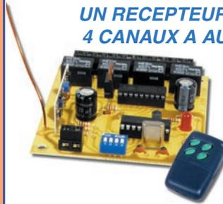
Récepteur de télécommande à 4 canaux, très simple et très fiable, fonctionnant par auto-apprentissage. Dans cette application, les codes sont sauvegardés dans la mémoire Flash du microcontrôleur utilisé au lieu de l'être dans une mémoire externe. D'un fonctionnement bistable ou par impulsion, ce récepteur reconnaît les codes standards sur 12 bits du MM53200 ou UM86409.
