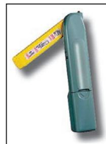
Le multitesteur MS 158 sert à détecter les tensions continues (jusqu'à 36 V), les tensions alternatives (jusqu'à 250 V) et les fuites de micro-ondes sur les appareils ménagers.
