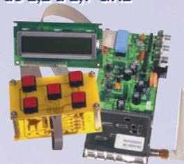
Fonctionnant dans la bande s'étendant de 2 à 2,7 GHz, il trouvera également une utilité non négligeable dans la recherche de mini-émetteurs télé opérant dans la même gamme de fréquences.
