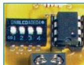
Voici un oscillateur à quartz pour circuit à microprocesseur qui permet de générer des fréquences d'horloge autres que celles standards, tout en étant équipé de quartz que l'on trouve facilement dans le commerce. Ce circuit est idéal pour les numériseurs vidéo, il permet de piloter des dispositifs qui requièrent parfois une fréquence d'horloge pouvant aller jusqu'à 100 MHz !
