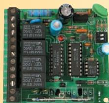
Système de télécommande à code aléatoire et tournant. Chaque fois que l'on envoie un signal, la combinaison change. Avec ses 268 435 456 combinaisons possibles le système offre une sécurité maximale.
