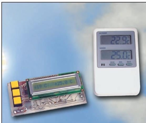
**Figure 10 :** En plus de mesurer à chaque instant la température relevée par sa sonde, notre thermostat est adapté pour maintenir la température d'un local à une valeur imposée. Il permet de commander des chauffages ou des installations d'air conditionné, en sélectionnant les contacts du relais de sortie. Il est possible de choisir entre les modes «heating» ou «cooling» à l'aide d'un menu très simple, assisté par un afficheur.
