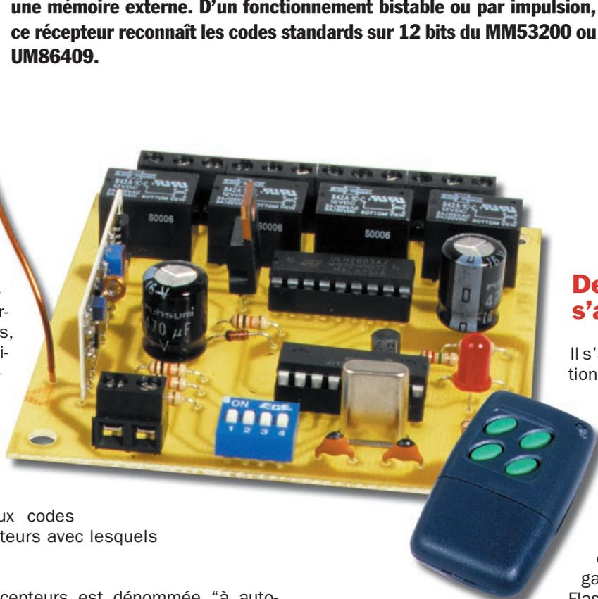
Les sorties sont, évidemment, au nombre de 4, chacune d'elles disposant d'un relais 1 RT avec la possibilité d'un fonctionnement bistable ou astable.
