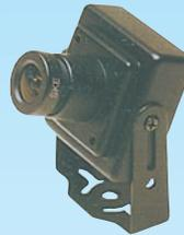
Capteur : CCD 1/3". Système : PAL. Résolution : 400 lignes TV (270 000 pixels). Sensibilité : 0,4 lux. Sortie vidéo : 1 Vpp à 75 Ω. Sortie audio : 0,7 Vpp. Tension d'alimentation : 9,5 à 16 V. Consommation : 110 mA. Dim : 31 x 31 x 29 mm. T° de fonctionnement : -10°C à +50°C. Angle 92°. Optique : f= 3,6 mm F 2,0.
