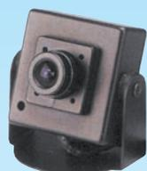
Capteur : CMOS 1/3". Système : PAL. Résolution : 300 lignes TV (528 x 512 pixels). Sensibilité : 5 lux. Sortie vidéo : 1 Vpp à 75 Ω. Tension d'alimentation : 6 à 12 V. Consommation : 30 mA. Dim : 31 x 31 x 29 mm. T° de fonctionnement : -10°C à +50°C. Angle 92°. Optique : f= 3,6 mm F 2,0.
