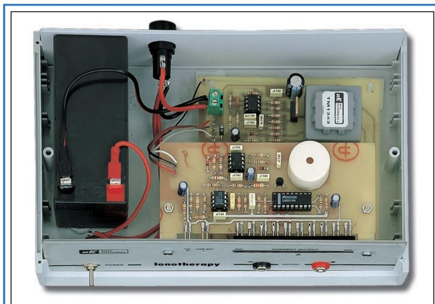
Figure 1 : Sur la photo de début d'article, vous pouvez voir que la pointe de la touche est reliée à la borne négative et la plaque conductrice à la borne positive. Ici, remarquez où est placée la batterie 12 volts dans le coffret.
