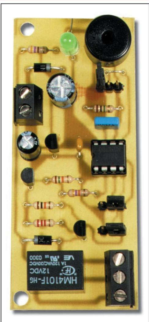
Figure 13 : Photo d'un des prototypes entièrement équipé de ses composants.
