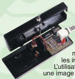
Remarquable et compact, ce générateur de mire a été étudié pour vérifier les moniteurs vidéo à entrée composite, les téléviseurs pourvus d'une prise SCART (péritel), mais aussi les câbles coaxiaux utilisés dans les installations de télévision en circuit fermé. L'utilisation d'un microcontrôleur permet de produire une image avec un texte défilant et d'afficher l'heure.
