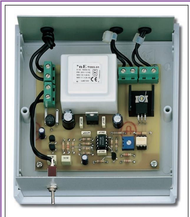
Figure 7 : Sur la face avant, vous devrez pratiquer un trou de 7 millimètres de diamètre pour placer l'interrupteur S1 et sur la face arrière, 3 trous pour insérer les passe-fils utilisés pour le câble secteur (trou de gauche) et ceux qui serviront pour connecter les lampes au bornier de sortie. Le curseur du trimmer R11, sera tourné jusqu'au moment où les filaments des lampes émettront une lumière tremblotante.
