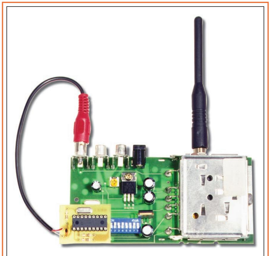
Figure 3 : Photo d'un des prototypes de l'émetteur avec son petit circuit imprimé de contrôle fixé au support du microcontrôleur d'origine. Remarquez la connexion à une des deux entrées audio, à travers laquelle est transmis l'asservissement de synchronisation.
