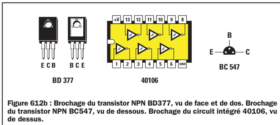
Figure 612b : Brochage du transistor NPN BD377, vu de face et de dos. Brochage du transistor NPN BC547, vu de dessous. Brochage du circuit intégré 40106, vu de dessus.
