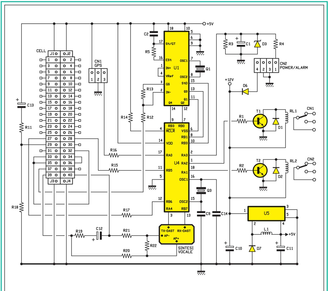
Figure 2 : Schéma électrique relatif à la section principale.
