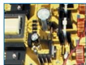
Voici une alimentation ATX pour ordinateur, conçue spécialement pour faire fonctionner n'importe quel PC (ou autre appareil incluant un microprocesseur) dans une voiture, à partir de la batterie 12 volts. Le montage présenté ici produit toutes les tensions nécessaires, positives ou négatives.
