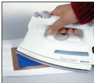
**7 - Passez le fer à repasser sur la face lisse du support de façon à transférer le toner sur le circuit.**
