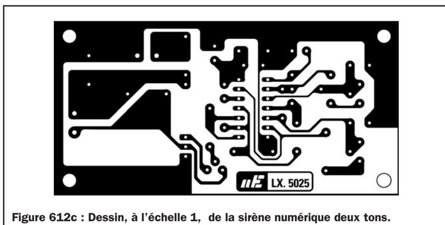
Figure 612c : Dessin, à l'échelle 1, de la sirène numérique deux tons.
