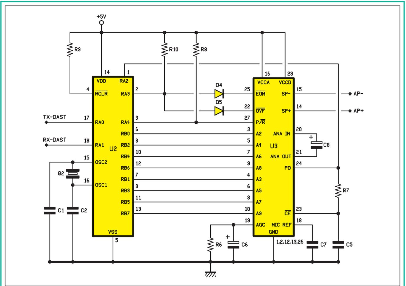
Figure 3 : Schéma électrique relatif à la section vocale.
