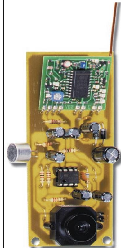
Figure 7 : Voici comment se présente l'émetteur, la réalisation terminée. Remarquez que le micro et le module hybride du prototype ici photographié ont été légèrement relevés pour les besoins de la photo.
