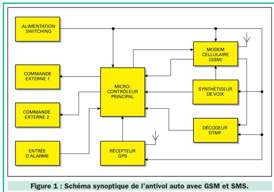
Figure 1 : Schéma synoptique de l'antivol auto avec GSM et SMS.
