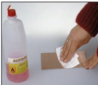
**5 - Nettoyez soigneusement le cuivre du circuit avec de l'alcool de façon à ce qu'il soit brillant et non gras.**
