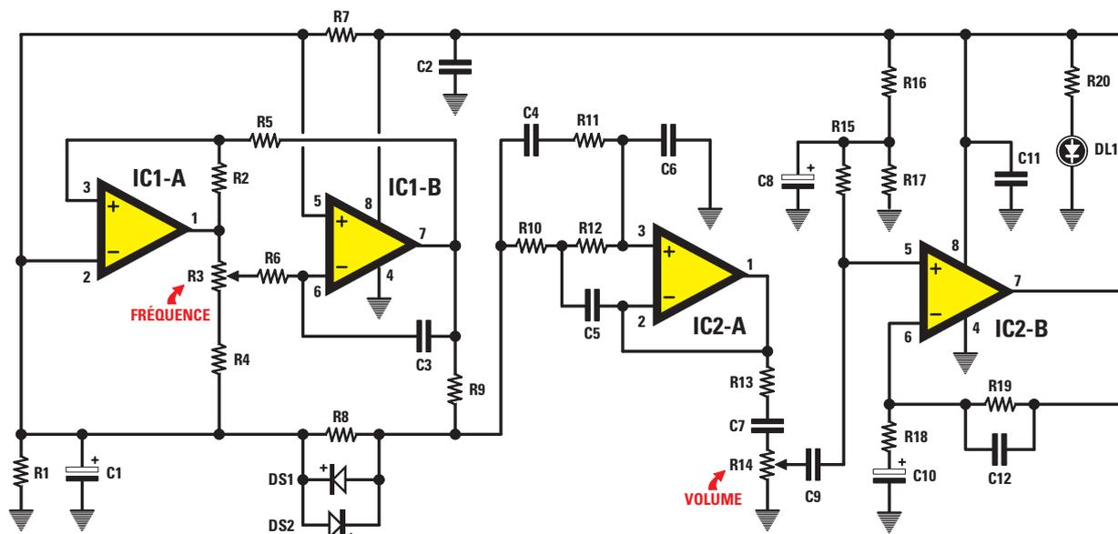
Figure 2 : Schéma électrique de l'oscillateur pour apprendre l'alphabet Morse. Le montage, qui utilise deux circuits intégrés et deux transistors, est alimenté avec une classique pile de 9 volts.
