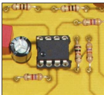
**Figure 3 : Gestion complète de l'alimentation par le PIC12C672-MF375.**
