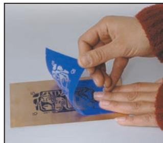
**8 - Laissez refroidir ou passez sous l'eau froide et détachez le support PnP-blue de la face cuivrée du circuit.**
