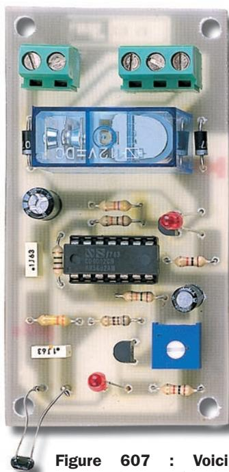
**Figure 607 : Voici comment se présente l'interrupteur crépusculaire, LX.5024, une fois le montage terminé. Remarquez la photorésistance, à gauche, qui, dans ce prototype, est raccordée directement (tout comme les LED, d'ailleurs).**
