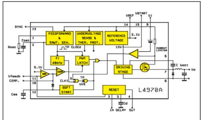
Figure 2c : Le schéma interne par sous-ensembles.
