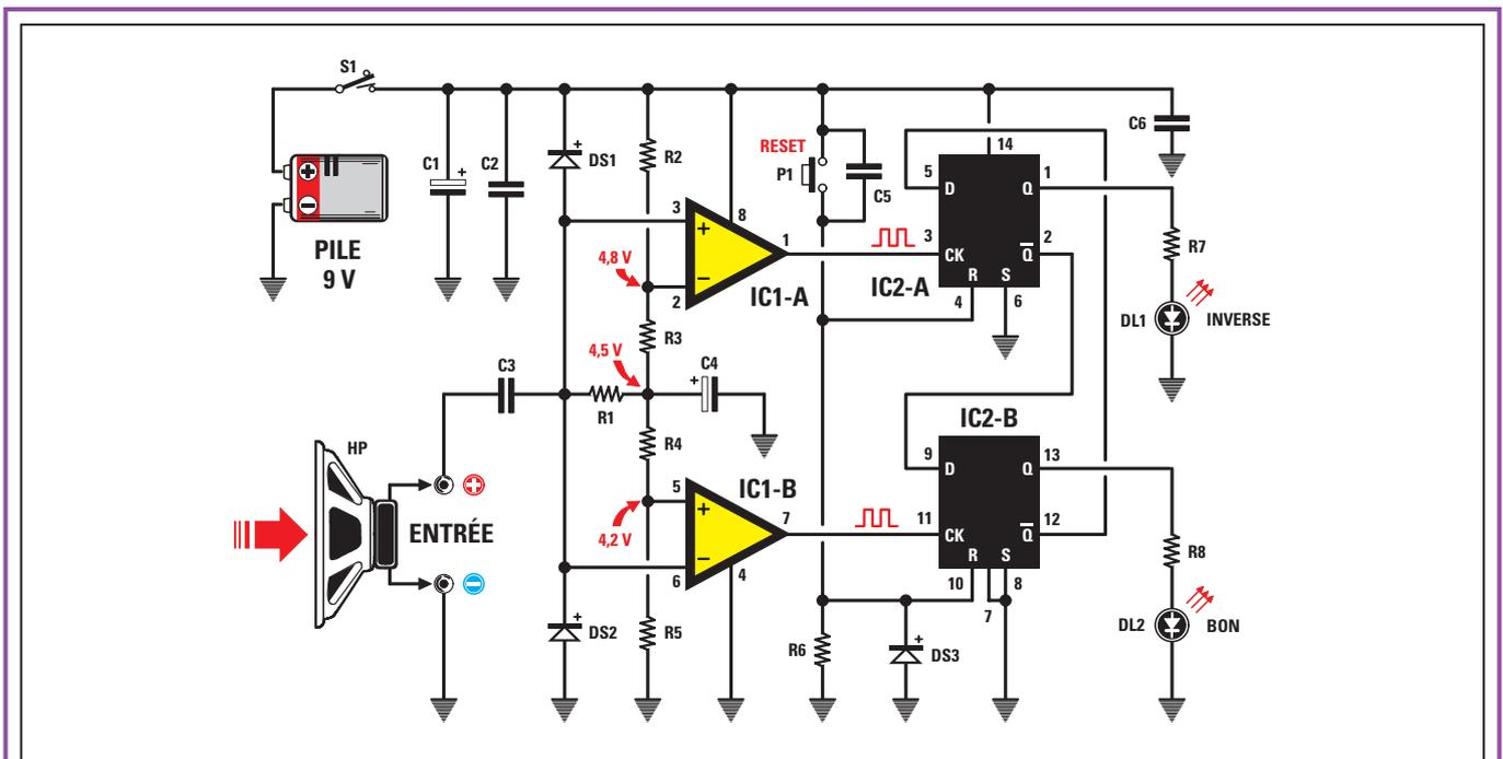
Figure 1 : Schéma électrique du circuit indicateur de polarité des haut-parleurs. Le signal qui sort du haut-parleur est transformé en un signal carré par les amplificateurs opérationnels IC1/A-IC1/B, utilisés comme comparateurs à fenêtre, puis ils sont appliqués à deux FLIP-FLOP IC2/A-IC2/B, utilisés comme indicateurs de polarité.
