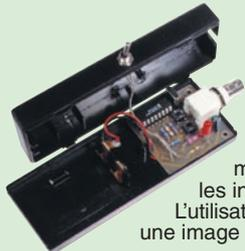
Remarquable et compact, ce générateur de mire a été étudié pour vérifier les moniteurs vidéo à entrée composite, les téléviseurs pourvus d'une prise SCART (péritel), mais aussi les câbles coaxiaux utilisés dans les installations de télévision en circuit fermé. L'utilisation d'un microcontrôleur permet de produire une image avec un texte défilant et d'afficher l'heure.
