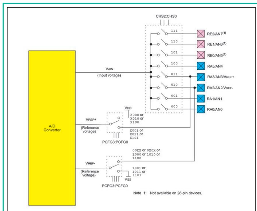
Figure 1 : Les microcontrôleurs PIC de la famille 16F87x sont dotés d'un convertisseur A/D à 10 bits. Selon leurs versions, ils disposent de plus ou moins d'entrées analogiques (voir texte).
