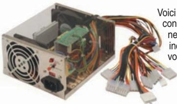
Voici une alimentation ATX pour ordinateur, conçue spécialement pour faire fonctionner n'importe quel PC (ou autre appareil incluant un microprocesseur) dans une voiture, à partir de la batterie 12 V. Le montage présenté ici produit toutes les tensions nécessaires, positives ou négatives.
