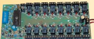
Ce récepteur fonctionne avec tous les émetteurs type MM53200, UM86409, UM3750, comme le FT151, FT270, TX3750/2C.
