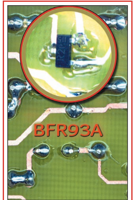
Figure 7 : Pour rendre apte notre détecteur à fonctionner sur une très large bande et à pouvoir ainsi détecter des sources HF allant du mégahertz jusqu'au gigahertz, nous avons utilisé, dans le circuit d'entrée, un transistor spécialement étudié pour les très hautes fréquences. Il s'agit d'un BFR93A, un NPN sorti des usines Philips, version CMS. Ce type de transistor peut monter jusqu'à 6 GHz et, comme la plupart de ses "confrères" de petite puissance étudiés pour être employés dans le domaine des très hautes fréquences, il travaille sous de faibles tensions d'alimentation et son niveau de bruit est de 1,9 dB seulement. Dans notre schéma il est branché en émetteur commun, configuration assez classique pour les étages d'entrée. Ce composant est à manier avec soin. Il faut éviter de trop le chauffer lors des soudures.
