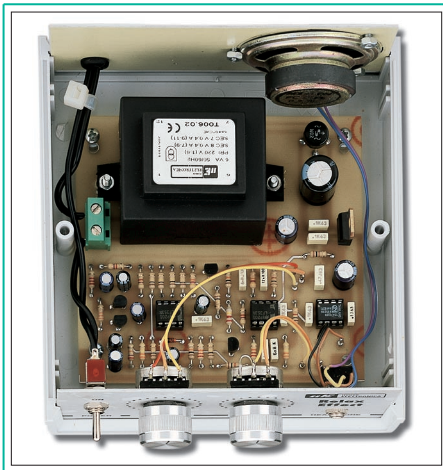
Figure 6 : Le circuit imprimé est fixé avec 4 vis sur le fond du boîtier plastique, le petit haut-parleur sur le panneau arrière, la prise du casque sur le panneau avant.
