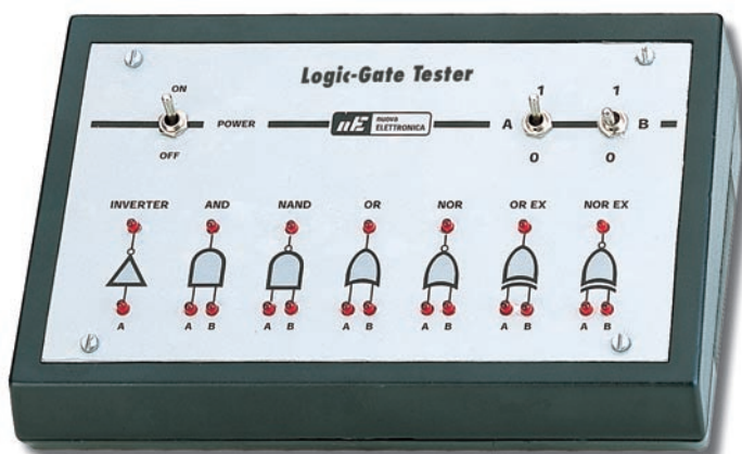
Figure 602 : Vous vous rendez vite compte de l'utilité de cette table de vérité électronique, car elle vous permettra de savoir instantanément quel niveau logique sera présent sur la sortie d'une porte, simplement en modifiant les niveaux logiques sur les entrées.
