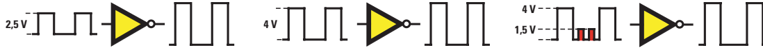
Figure 589 : Une porte INVERTER à trigger reconnaît comme niveaux logiques 1 seulement les signaux de plus de 2 volts. Donc, si des impulsions d'interférences ne dépassant pas une tension de 2 volts arrivent sur les entrées, elles ne sont pas prises en compte.
