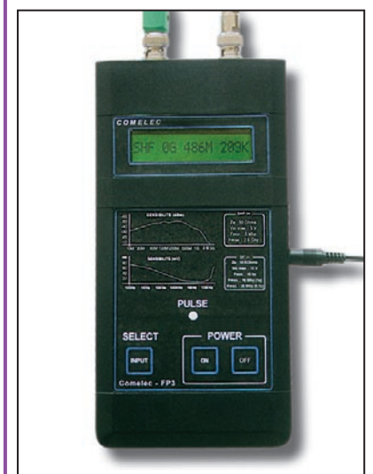
Figure 18 : Avec un fréquencesmètre "montant" à près de 3 GHz, il vous sera facile de mesurer la fréquence de votre système de transmission vidéo.
