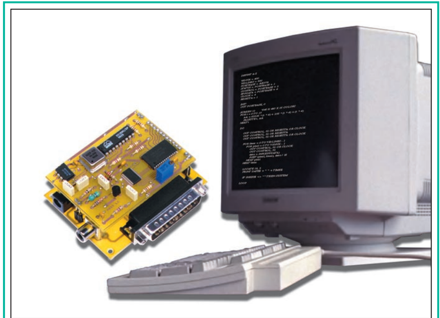
Figure 11 : La carte de test et le module digitaliseur se placent l'un sur l'autre et s'interconnectent au moyen de broches mâles et de contacts femelles.
