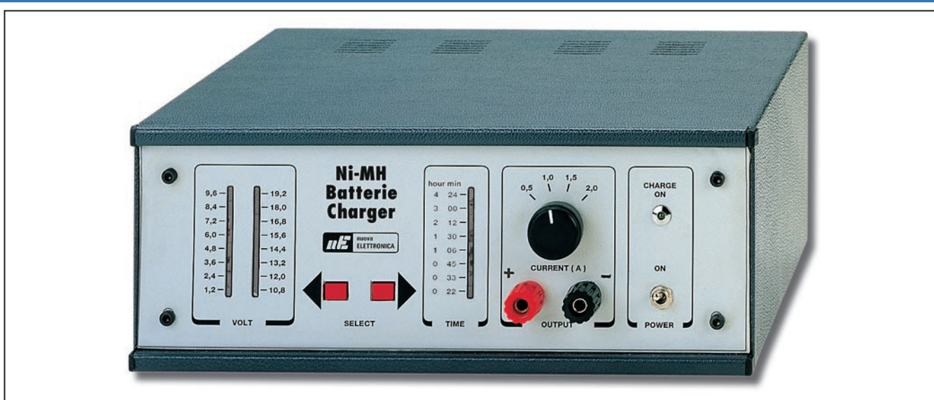
Figure 2 : Voici comment se présentent le coffret et le panneau frontal de ce chargeur. En pressant le bouton poussoir de gauche (voir inscription "Select"), on fait varier la tension de sortie, en pressant le poussoir de droite, on fait varier la valeur du temps de charge. Pour modifier le courant de charge, il faut utiliser le commutateur rotatif présent au-dessus des bornes de sortie (Current).
