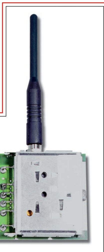
Figure 6: Photo d'un des prototypes de la platine émission. Remarquez la connexion des sorties du module aux pistes du circuit imprimé par l'intermédiaire de picots classiques.
