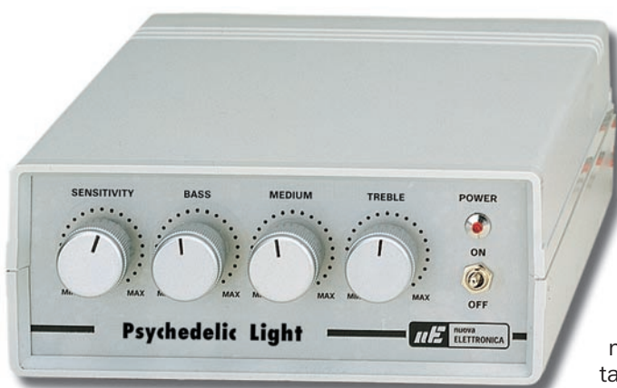
Figure 560 : Voici comment se présente, une fois terminé, le boîtier pour lumières psychédéliqués capable de piloter des ampoules de 12 volts.
