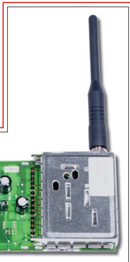
Figure 11 : Photo d'un des prototypes de la platine réception. Remarquez la connexion des sorties du module aux pistes du circuit imprimé via des picots en bande sécable.
