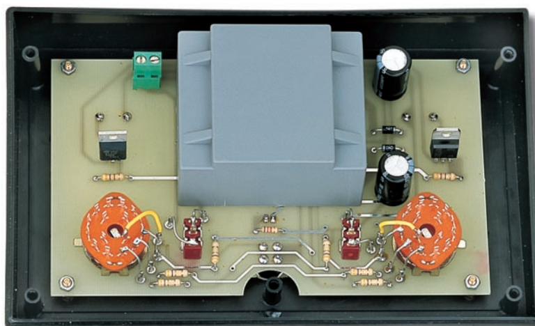
Figure 546 : Vous devez fixer le circuit imprimé sur la face avant du boîtier à l'aide de quatre entretoises métalliques de 5 mm.
