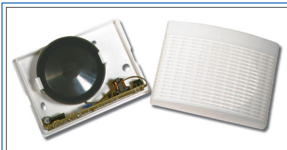
Figure 8 : Une fois le montage du circuit imprimé terminé et après avoir vérifié qu'en alimentant celui-ci, le transducteur émette le son attendu, vous pouvez monter le tout à l'intérieur d'un coffret spécial ou, bien entendu, largement perforé pour laisser sortir le son. Le trimmer qui se trouve sur le circuit (R14, figure 1) permet de régler la gamme de fréquences de la sirène.
