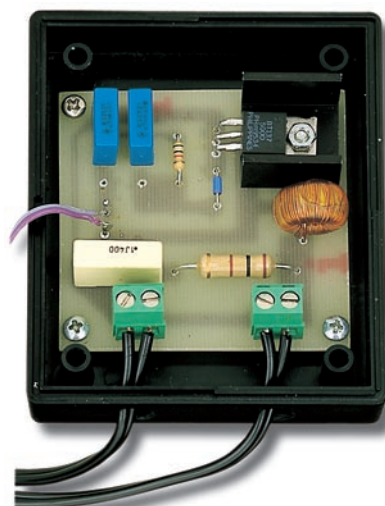
Figure 548b : Le boîtier du variateur ouvert afin de vous montrer comment est fixé le circuit imprimé à l'intérieur.
