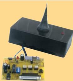
Ce kit va vous permettre de piloter de votre PC, 32 récepteurs différents. Vous pouvez utiliser tous les récepteurs utilisant les circuits intégrés type MM53200 ou UM86409. Portée de 2 à 5 km. Décrit dans ELECTRONIQUE n° 4.
