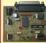
Programme les microcontrôleurs de la série PIC16C84, 16F84, 12C508, 12C509, 24C16 et 24LC16. La connexion se fait par le port // d'un PC. Livré avec logiciel et cordon.
