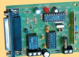
Cet appareil permet de visualiser sur l'écran d'un PC l'état des bits de codage, donc le code, des émetteurs de télécommande standards basés sur le MM53200 de National Semiconductor et sur les MC145026, 7 ou 8 de Motorola, transmettant sur 433,92 MHz. Le tout fonctionne grâce à une interface reliée au port série RS232-C du PC et à un simple logiciel en QBasic.
