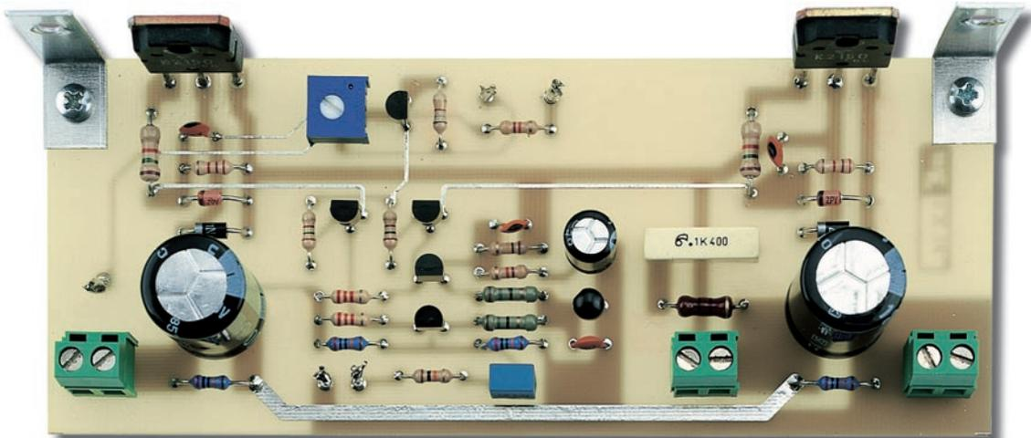
Figure 8 : Photo de l'un de nos premiers prototypes. Sur le circuit imprimé des prototypes, il n'y a pas de dessins des composants, ni même de vernis protecteur, que vous trouverez par contre sur les circuits professionnels.
