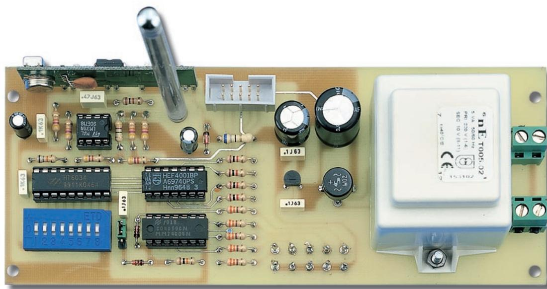
Figure 27a : Photo d'un des prototypes de l'étage récepteur.
