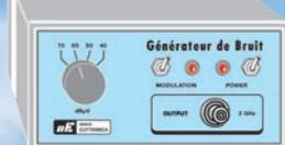
Signal de sortie : 70 dBμV- Fréquence max. : 2 GHz - Linéarité : +/- 1 dB -Atténuateur : 0, 10, 20, 30 dB. Fréquence de modulation : 190 Hz env.
