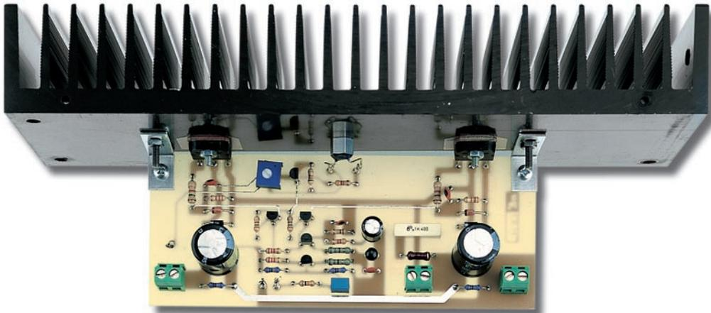
Figure 10 : Photo de l'étage amplificateur de l'ampli avec ses deux MOSFET ainsi que son radiateur. Pour réaliser un ampli stéréo, il faut deux de ces circuits.
