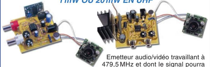
Emetteur audio/vidéo travaillant à 479,5 MHz et dont le signal pourra être reçu par n'importe quel téléviseur, sur le canal 22 UHF. Cette réalisation sera idéale pour surveiller à distance des lieux par l'intermédiaire d'une caméra vidéo et d'un micro.
