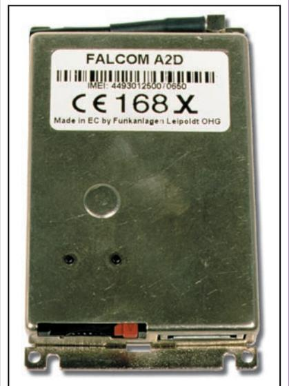
Figure 10 : le modem GSM bande Falcom A2D utilisé dans le transmetteur téléphonique d'alarme.
