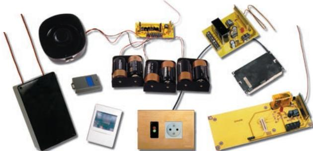
FT348K : Tous les composants pour réaliser la centrale d'alarme, y compris le circuit imprimé percé et sérigraphié ainsi que le microcontrôleur MF348, le boîtier et le porte piles ..... 390 F
