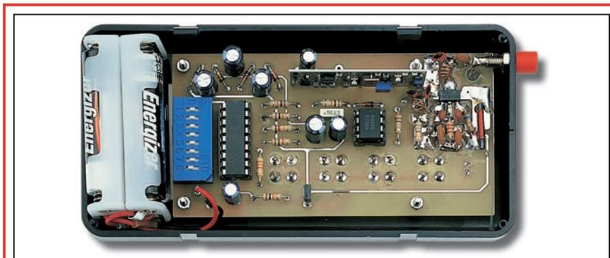
**Figure 24 :** Les deux porte-piles sont placés côte à côte dans l'emplacement prévu à cet effet, à gauche. Ils sont solidarités par une goutte de silicone.
