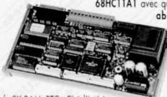
de 8K RAM+RTC ; E<sup>5</sup> à l'intérieur de CPU ; 8 lignes A/D ; 32 I/O TTL ; RS 232, RS 422 ou RS 485 ; Watch-Dog ; Timer ; Counter ; etc. Alimentateur incorporé de 220Vac. Idéal pour le combiner au tool de développement logiciel ICC-11 ou Micro-C. 1.317,83 FF+IVA 200,90 €+IVA
