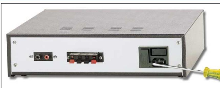
Figure 11 : Les deux prises d'entrée BF doivent être fixées sur le panneau arrière du boîtier, ainsi que les quatre prises de sortie pour les enceintes et, sur la droite, la prise châssis 220 volts secteur. Dans le corps de la prise secteur se trouve un petit boîtier contenant le fusible. Pour le retirer, il suffit d'insérer la lame d'un tournevis dans la petite fente visible sur la photo.
