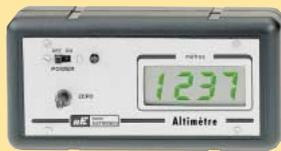
Avec ce kit vous pourrez mesurer la hauteur d'un immeuble, d'un pylône ou d'une montagne jusqu'à une hauteur maximale de 1999 mètres.
