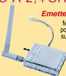
Module émetteur audio/vidéo offrant la possibilité (à l'aide d'un cavalier) de travailler sur 4 fréquences différentes (2,400 - 2,427 - 2,457 - 2,481 GHz). Puissance de sortie 10 mW sous 50 Ω, entrée audio 2 Vpp max. Tension d'alimentation 12 Vcc. Livré avec une antenne accordée. Dim : 44 x 38 x 12 mm. Poids : 30 g.
