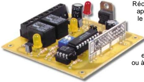
Récepteur à auto-apprentissage, basé sur le système de codage KeeLoq de Microchip. Il dispose de deux sorties sur relais qui peuvent fonctionner en mode monostable ou à impulsions.
