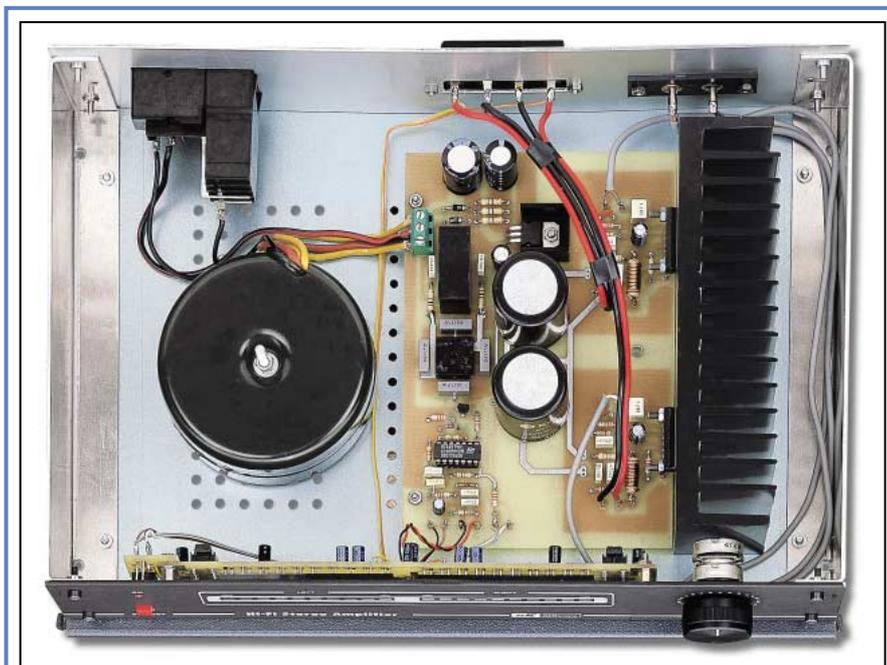
Figure 2: Le circuit imprimé de l'amplificateur équipé de son radiateur doit être fixé sur le fond, du côté droit du boîtier, tandis que le transformateur toroïdal d'alimentation doit être fixé sur le fond, du côté gauche. Le circuit VUmètres doit être fixé derrière la face avant.
