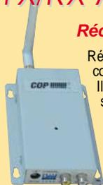
Récepteur audio/vidéo livré complet avec boîtier et antenne. Il dispose de 4 canaux sélectionnables à l'aide d'un cavalier. Il peut scanner en automatique les 4 canaux. Sortie vidéo : 1 Vpp sous 75 Ω. Sortie audio : 2 Vpp max.
