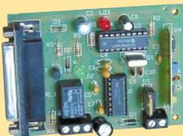
Cet appareil permet de visualiser sur l'écran d'un PC l'état des bits de codage, donc le code, des émetteurs de télécommande standards basés sur le MM53200 de National Semiconductor et sur les MC145026, 7 ou 8 de Motorola, transmettant sur 433,92 MHz. Le tout fonctionne grâce à une interface reliée au port série RS232-C du PC et à un simple logiciel en QBasic.
