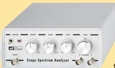
Ce kit vous permet de transformer votre oscilloscope en un analyseur de spectre performant. Vous pourrez visualiser n'importe quel signal HF, entre 0 et 310 MHz environ. Avec le pont réflectométrique décrit dans le numéro 11 et un générateur de bruit, vous pourrez faire de nombreuses autres mesures...
