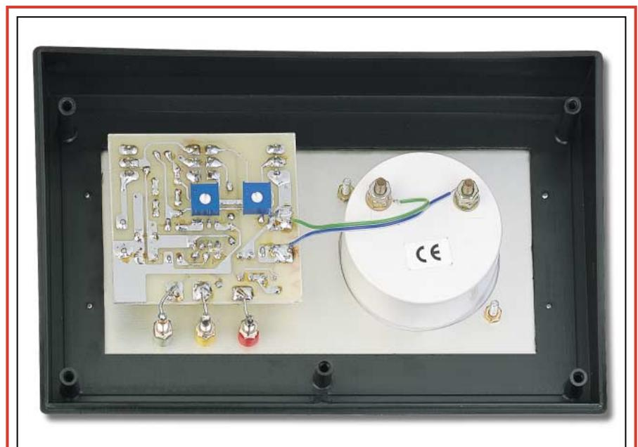
Figure 469b : Vue, dans le boîtier, du circuit du testeur de transistors et de l'arrière du galvanomètre.
