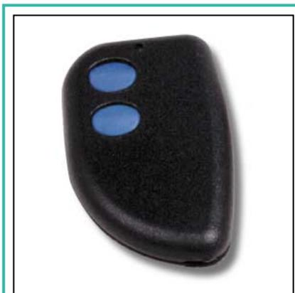
Figure 3 : L'unité de transmission (la télécommande) est composée d'un petit émetteur réalisé en CMS et enfermé dans un coffret plastique en forme de porte-clefs. Le système est bi-canal et fonctionne avec une pile de 12 volts miniature. Il dispose d'un oscillateur SAW très stable accordé sur 433,92 MHz, modulé par les impulsions que l'encodeur Microchip HCS301 produit à chaque fois que l'on agit sur l'un des deux poussoirs.
