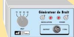
Signal de sortie : 70 dBμV- Fréquence max. : 2 GHz - Linéarité : +/- 1 dB - Atténuateur : 0, 10, 20, 30 dB. Fréquence de modulation : 190 Hz env. Alimentation : 220 VAC
