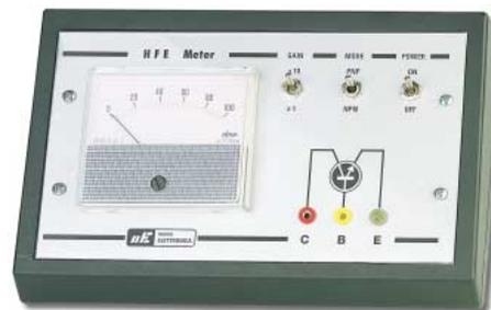
LX5014 : Tous les éléments pour réaliser le testeur de transistors simple, y compris le circuit imprimé double face à trous métallisés et le boîtier avec face avant percée et sérigraphiée : 330 F. Le circuit imprimé seul : 26 F.
