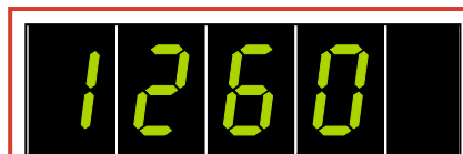
Figure 31 : Pour les fréquences supérieures à 1 000 kHz, vous verrez apparaître sur l'afficheur, quatre chiffres sans point de séparation.
