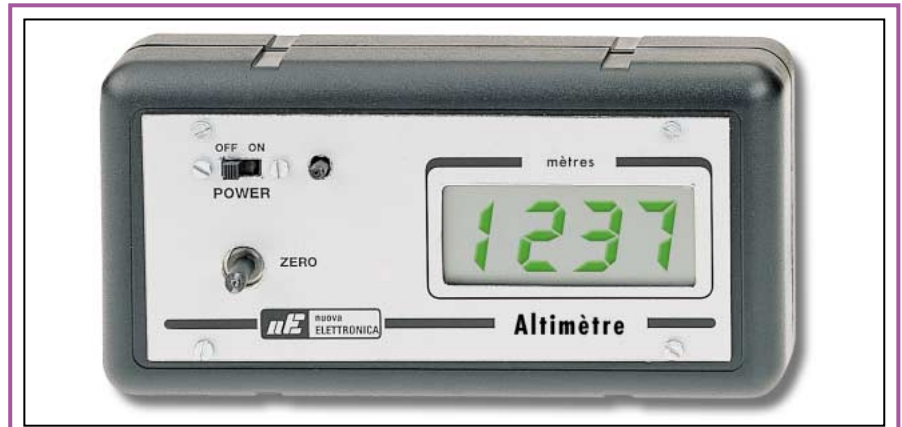
Figure 5 : Voici comment se présente votre instrument lorsque vous l'aurez installé dans son boîtier. L'axe qui sort en bas à gauche est celui du potentiomètre R5, qui sert pour le réglage du zéro.
