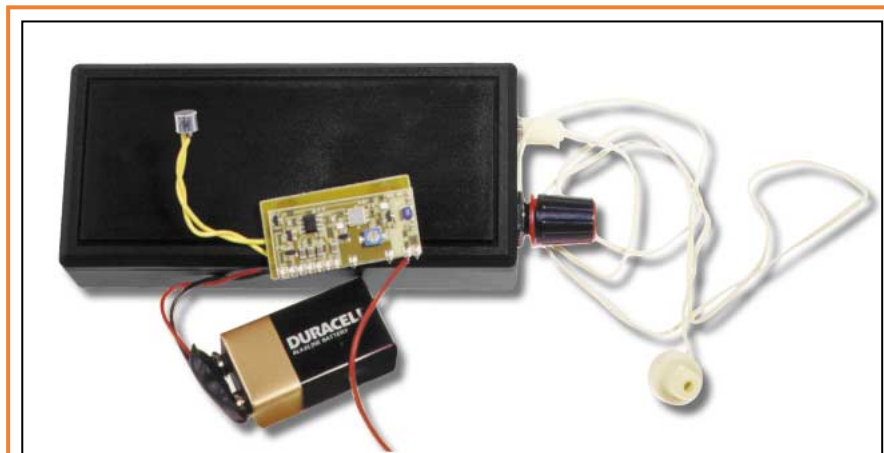
Figure 2 : Pour recevoir le signal du micro-émetteur décrit dans ces pages, il est possible d'utiliser un récepteur prévu pour fonctionner sur la fréquence de 433,75 MHz, basé sur le module RX-FM Audio de Aurel et intégré dans un petit coffret qui peut être avantageusement placé dans une poche. En fonction de l'environnement, la portée du système peut varier entre 50 et 300 mètres. Ce récepteur sera prochainement décrit dans la revue.
