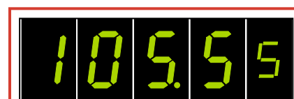
Figure 27 : Pour les fréquences supérieures à 100 MHz, vous verrez apparaître les trois chiffres des MHz, et les deux chiffres des centaines et dizaines de kHz.
