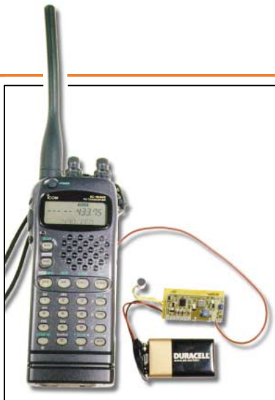
Figure 6 : Pour recevoir le signal émis par notre micro-émetteur, outre le récepteur dont il est question dans la figure 2, il est également possible d'utiliser un récepteur UHF, ou même un scanner, calé sur la fréquence de 433,75 MHz. Bien que permettant une bonne qualité d'écoute du signal émis par le micro-émetteur, ces appareils présentent une bande passante très étroite par rapport à la bande passante de notre réalisation. Le signal du TX-FM Audio est modulé en fréquence, avec une excursion ( \Delta ) de \pm 75 kHz. La puissance émise est un peu inférieure à 10 dBm, ce qui équivaut à 10 mW sur une charge de 50 ohms.
