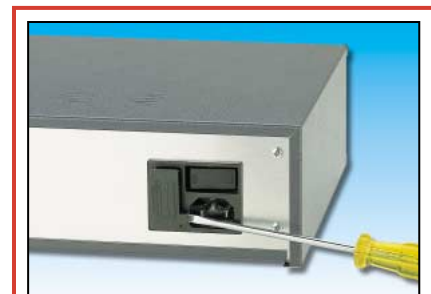
Figure 21: A l'intérieur de la prise secteur se trouve un compartiment contenant le fusible. Pour ouvrir ce compartiment, enfillez la lame d'un tournevis dans la petite fente située sur le côté droit.
