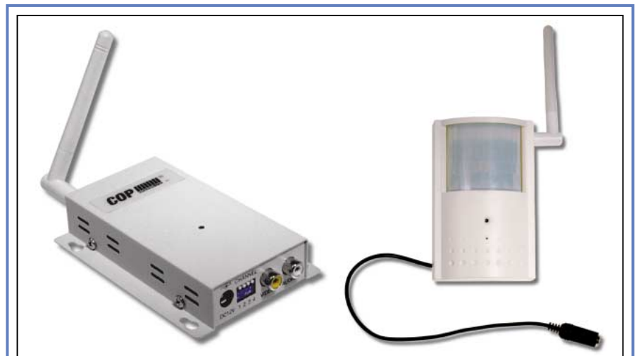
Figure 3 : Outre le circuit de commutation automatique décrit dans cet article, le système de surveillance utilise une caméra vidéo avec capteur P.I.R., un module émetteur A/V à 2,4 GHz et un récepteur réglé sur la même fréquence. La puissance de sortie de 10 mW garantit une portée comprise entre environ 50 et 200 mètres, en fonction de l'environnement.
