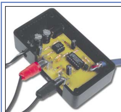
Figure 12 : Afin d'obtenir un montage propre et professionnel, il est conseillé d'insérer le circuit de commutation du téléviseur à l'intérieur d'un boîtier adapté. Dans notre cas, nous avons utilisé un boîtier plastique de Teko (modèle "Coffret 1"), percé pour permettre l'accès aux prises d'entrée, de sortie et d'alimentation. Sur le prototype, nous nous sommes simplifié la vie, mais ce n'est pas une obligation (voir la découpe pour les prises RCA) !
