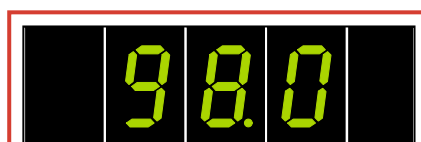
Figure 26 : Pour les fréquences inférieures à 100 MHz, vous verrez apparaître sur l'afficheur les deux chiffres des MHz et le chiffre des centaines de kHz.
