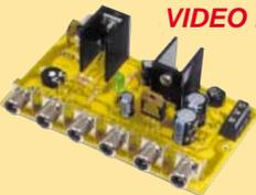
Cette réalisation sera idéale pour piloter plusieurs moniteurs avec un seul signal vidéo composite. Elle est adaptée pour la vidéodiffusion dans une salle de conférence, mais également dans plusieurs pièces d'un même appartement.
