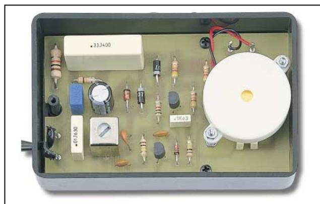
Figure 2 : Photo de l'étage récepteur déjà installé dans son coffret plastique. Le transducteur piézo est fixé au circuit imprimé au moyen de deux longues vis équipées d'écrous comme vous pouvez le voir facilement sur la figure 10. Il est également possible de le fixer directement sur le couvercle du coffret.
