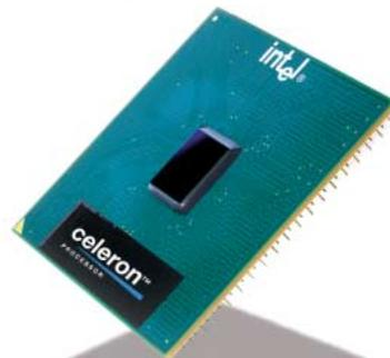
Intel vient d'annoncer, début juillet, la sortie de nouveaux processeurs Celeron tournant à 700, 667 et 633 MHz conçus en technologie 0,18 µm, destinés aux ensembles à moins de 1 000 \$. En boîtier FC-PGA, le nouveau Celeron dispose d'un cache de niveau 2 de 128 K et fonctionne avec des systèmes à bus de 66 MHz.
