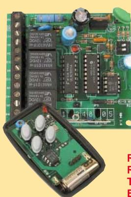
Système de télécommande à code aléatoire et tournant. Chaque fois que l'on envoie un signal, la combinaison change. Avec ses 268 435 456 combinaisons possibles le système offre une sécurité maximale.
