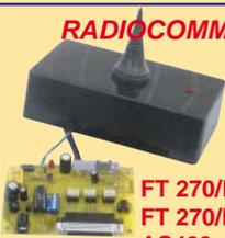
Ce kit va vous permettre de piloter de votre PC, 32 récepteurs différents. Vous pouvez utiliser tous les récepteurs utilisant les circuits intégrés type MM53200 ou UM86409. Portée de 2 à 5 km. Décrit dans ELECTRONIQUE n° 4.
