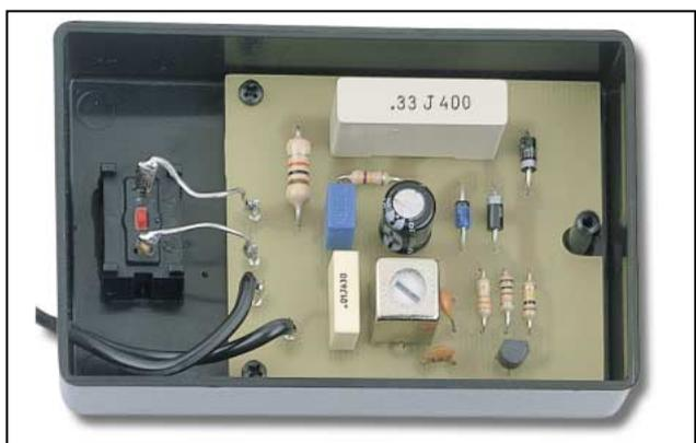
Figure 1 : Photo de l'étage transmetteur déjà installé dans son coffret plastique. Pour éviter qu'en tirant sur le cordon secteur les fils ne puissent s'arracher des deux picots soudés sur le circuit imprimé, nous vous conseillons de faire un nœud (voir figure 6).
