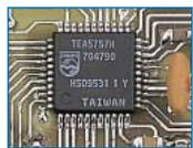
La technologie, toujours en constante évolution, a permis de mettre au point, un circuit intégré de faibles dimensions permettant de réaliser un tuner performant pour la gamme des 522 à 1 620 kHz et pour la gamme FM des 87,5 à 108 MHz. Hélas, ce composant n'est produit qu'en technologie CMS. Pour pouvoir le mettre à la portée du plus grand nombre, nous l'avons fait monter en usine sur un module hybride.
