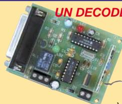
Cet appareil permet de visualiser sur l'écran d'un PC l'état des bits de codage, donc le code, des émetteurs de télécommande standards basés sur le MM53200 de National Semiconductor et sur les MC145026, 7 ou 8 de Motorola, transmettant sur 433.92 MHz. Le tout fonctionne grâce à une interface reliée au port série RS232-C du PC et à un simple logiciel en QBASIC.
