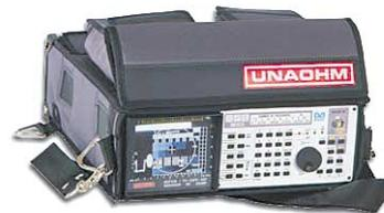
Bande couverte de 46 à 2 150 MHz. Accord de fréquence par synthèse PLL, entrée directe des canaux, des fréquences et des programmes. Commande par clavier et/ou roues codeuses.
