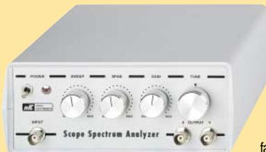
Ce kit vous permet de transformer votre oscilloscope en un analyseur de spectre performant. Vous pourrez visualiser n'importe quel signal HF, entre 0 et 310 MHz environ.
