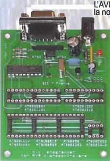
LAVR-01 permet de programmer la nouvelle génération des microcontrôleurs en technologie RISC 8 bits de chez Atmel, famille AT89S, AT90S, Attiny et Atmega. Le circuit se branche sur le port série de tout compatible PC et possède des supports tulipes 8, 20, 28 et 40 broches, permettant la programmation des différents modèles de composants, les Atmega nécessitant un adaptateur supplémentaire. Le logiciel très complet fonctionne sous Windows 95/98/NT. Livré avec cordon port série.
