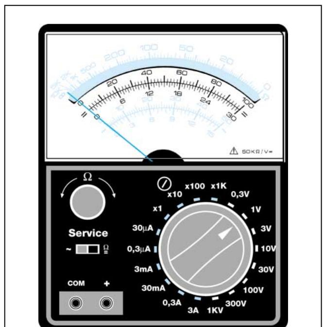
Figure 373 : Concernant la fonction voltmètre CC (courant continu), en tournant le bouton sur les échelles indiquées 0,3, 3, 30, 300 V, la valeur sera lue sur l'échelle graduée de 0 à 30, alors qu'en tournant le bouton sur les échelles indiquées 1, 10, 100 V, la valeur sera lue sur l'échelle graduée de 0 à 100.
