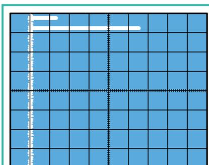
Figure 28 : Si, par erreur, vous intervertissez les câbles coaxiaux reliés aux entrées X et Y de votre oscilloscope, vous verrez apparaître à l'écran la ligne de référence horizontale. Dans ce cas, inversez les deux câbles d'entrée X et Y.
