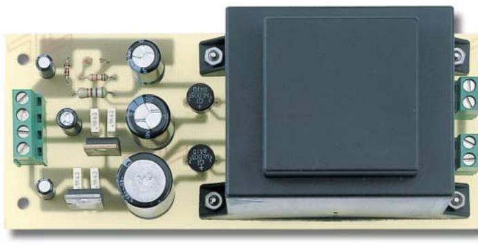
Figure 17 : Photo réduite de l'étage d'alimentation. Il n'est pas nécessaire d'utiliser un radiateur de refroidissement sur les circuits intégrés IC1 et IC2.
