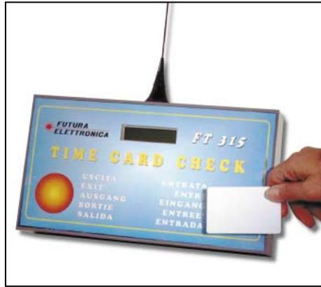
Les deux unités qui composent notre système de pointeuse par transpondeurs utilisent une porteuse radio en 433 MHz destinée à remplacer une liaison par fils, toujours délicate à mettre en place. La simplicité n'excluant pas la sécurité, un protocole complexe de communication contrôle l'exactitude de la transmission des données.
