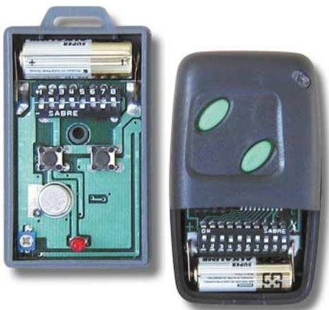
**A gauche, une télécommande utilisant le codage Motorola à 9 bits 3-state, pour un total de 19 683 combinaisons. A droite, une télécommande qui emploie un codage de type MM53200 à 12 bits, pour un total de 4 096 combinaisons possibles.**
