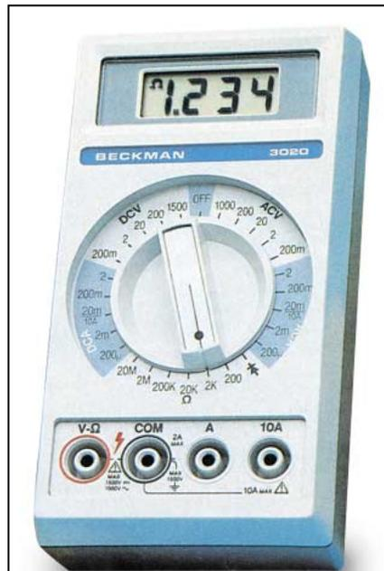
Figure 380 : Toutes les échelles des multimètres digitaux sont toujours des multiples de 2 car le chiffre le plus grand que l'on puisse lire est "1.999". Le "point" qui s'affiche sur l'afficheur à cristaux liquides équivaut à une virgule, "1.234" ohms équivaut donc à 1,234 kilohm.
