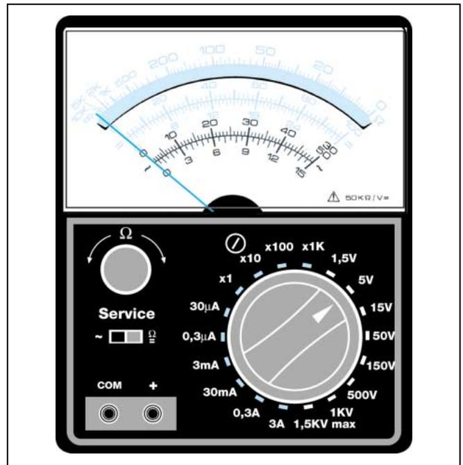
Figure 375 : Concernant la fonction voltmètre ou ampèremètre AC (courant alternatif), la valeur de la tension ou du courant alternatif sera lue sur l'échelle de couleur rouge. Avant d'effectuer une mesure AC, vous devrez penser à déplacer le levier de l'inverseur, de la position "CC- $\Omega$ " à la position "AC". Sur certains multimètres, l'inverseur est remplacé par une douille "AC" sur laquelle doit être déplacé le cordon de mesure rouge.
