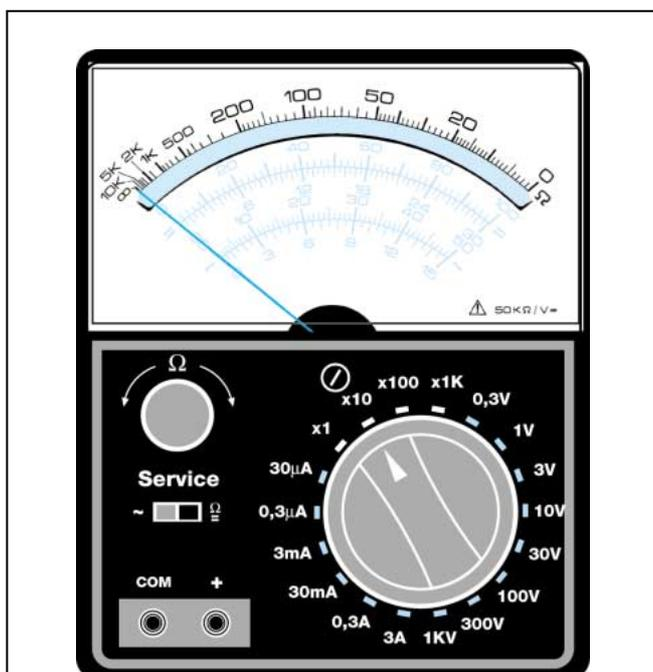
Figure 372 : Concernant la fonction ohmmètre, la valeur de la résistance lue sur l'échelle "Ω" sera multipliée par le facteur indiqué par le bouton des échelles, c'est-à-dire x1, x10, x100, x1K. Chaque fois que vous changerez d'échelle, vous devrez court-circuiter les deux pointes de touche et régler à nouveau le potentiomètre de calibrage.
