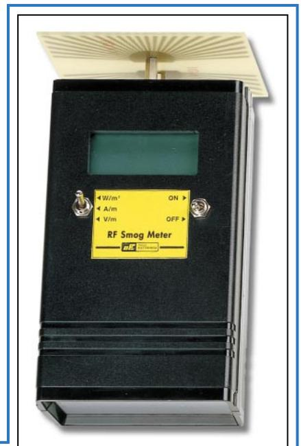
**Figure 12 :** Voici comment se présente le coffret de l'appareil de mesure de la pollution électromagnétique, avec son antenne déjà fixée. Entre les deux inverseurs S1 et S2, sera appliquée la petite étiquette adhésive avec les indications W/m<sup>2</sup>, A/m et V/m.
