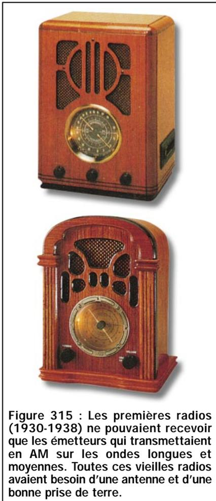
Figure 315 : Les premières radios (1930-1938) ne pouvaient recevoir que les émetteurs qui transmettaient en AM sur les ondes longues et moyennes. Toutes ces vieilles radios avaient besoin d'une antenne et d'une bonne prise de terre.
