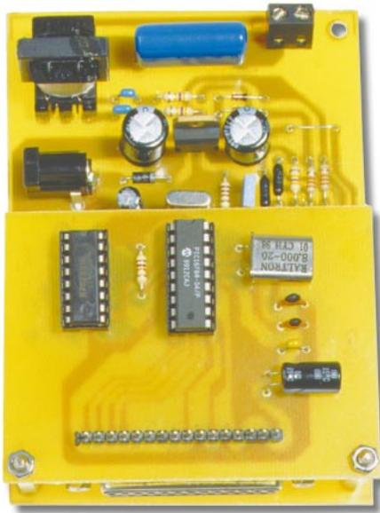
dispose, en interne, d'un filtre et d'un démodulateur de fréquence capable d'extraire les impulsions digitales, qu'il envoie ensuite à la broche 17 (data). De celle-ci, les informations rejoignent le microcontrôleur à la broche 7, positionnée comme entrée des données.
