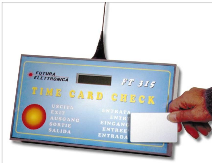
De la dimension et de la forme des bobines des lecteurs dépendra la sensibilité du lecteur. Dans ce prototype, avec un transpondeur en forme de carte, la sensibilité est de l'ordre de 6 à 7 centimètres.
