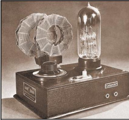
**Figure 339 :** Les premières valves thermo-ioniques (ou thermoionique, synonyme de thermoélectronique) utilisées pour la réalisation des récepteurs radio, appaurent vers 1910. Marconi, pour capter les signaux, utilisait des détecteurs rudimentaires, constitués d'un petit tube de verre contenant de la limaille de nickel (96 %) et d'argent (4 %). Sur la photo, un des premiers récepteurs radio à valve thermo-ionique.
