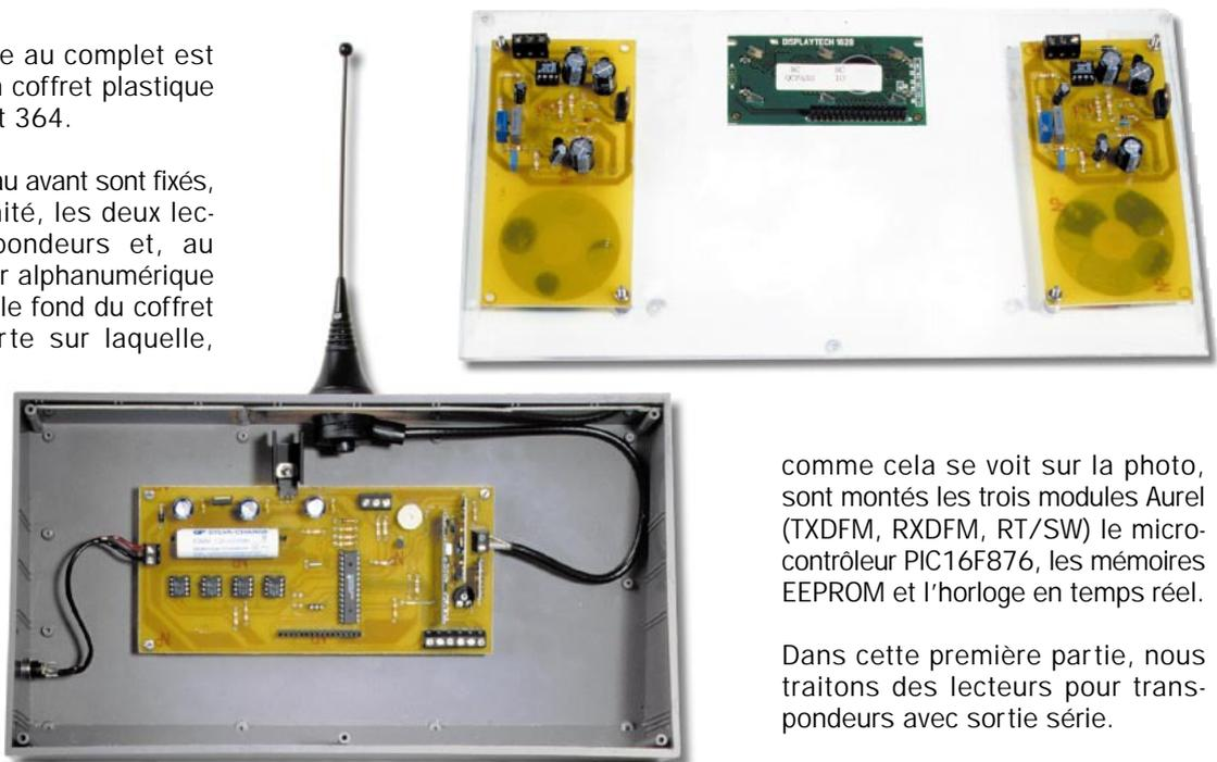
comme cela se voit sur la photo, sont montés les trois modules Aurel (TXDFM, RXDFM, RT/SW) le microcontrôleur PIC16F876, les mémoires EEPROM et l'horloge en temps réel.
