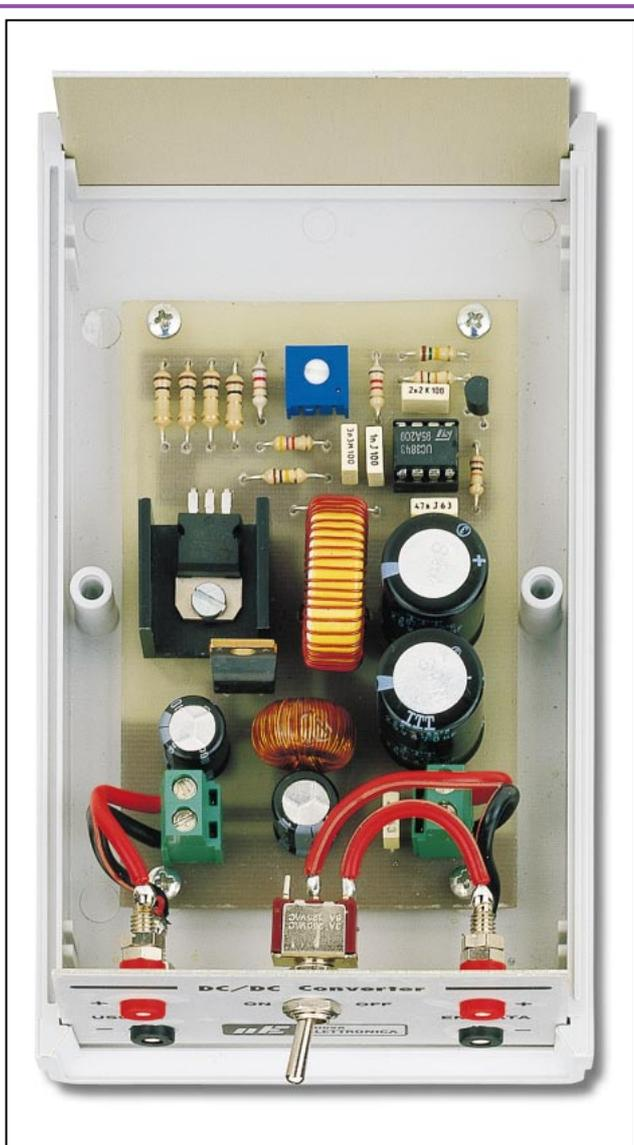
Figure 4 : Après avoir monté tous les composants sur le circuit imprimé, vous devez l'insérer à l'intérieur de son boîtier plastique. Avant de fixer les quatre douilles, vous devrez retirer leurs bagues isolantes et les placer du côté intérieur du boîtier.
