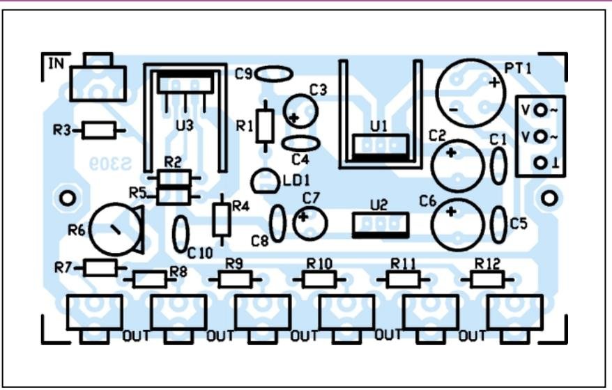
Figure 2 : Schéma d'implantation des composants du répartiteur.
