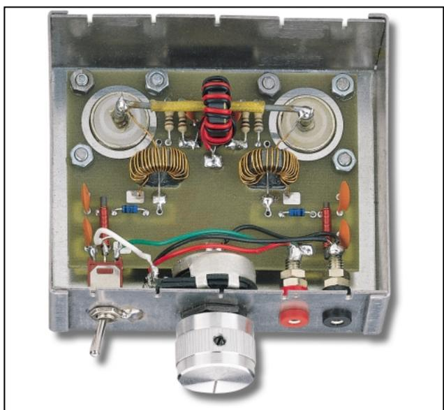
Figure 1 : Photo du ROSmètre de 1 à 170 MHz, qui utilise trois tores de ferrite de type FT50.43.
