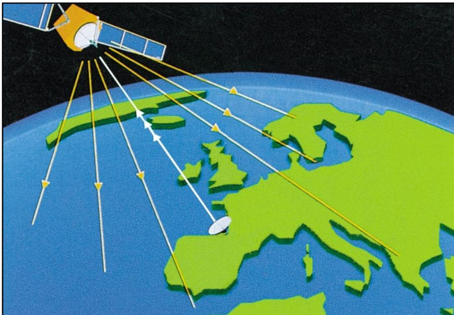
**Figure 306 :** A l'intérieur d'un même satellite, on trouve plusieurs types de récepteurs et d'émetteurs. Des programmes TV ainsi que des communications téléphoniques sont envoyés vers le satellite, par les opérateurs habilités, à l'aide d'émetteurs et de grandes antennes paraboliques. Le satellite "arrosera" ensuite toute sa zone de couverture avec les programmes TV qu'il aura reçus et retransmettra les communications téléphoniques aux opérateurs chargés de les faire parvenir au client final.
