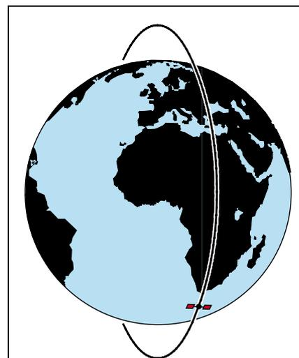
**Figure 309 :** Les satellites "polaires" utilisés en météorologie et à des fins militaires, tournent autour de la terre avec une orbite circulaire qui passe au-dessus des pôles Nord et Sud. Ces satellites, qui se déplacent à une vitesse d'environ 30 000 km/h, se maintiennent à une distance située entre 800 et 1 000 km.
