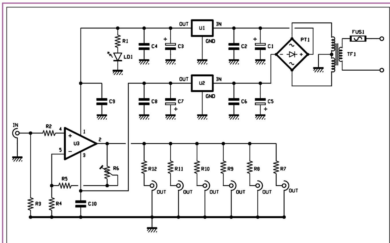
Figure 1 : Schéma électrique du répartiteur professionnel vidéo-composite 6 voies.
