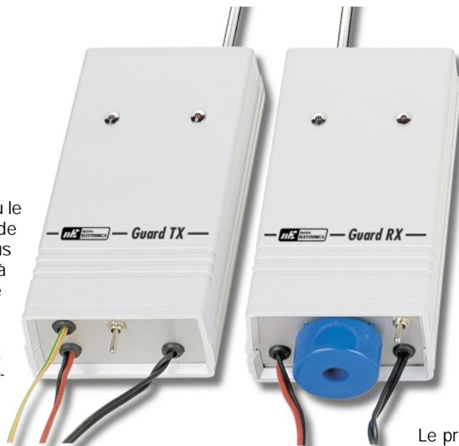
Tendre des fils qui partent du box pour rejoindre la maison, n'est pas toujours possible ou pour le moins fort compliqué. Il ne reste donc qu'une seule solution, celle de relier le capteur à un petit émetteur UHF chargé de transmettre le signal d'alarme à un récepteur installé à l'intérieur de l'appartement.
