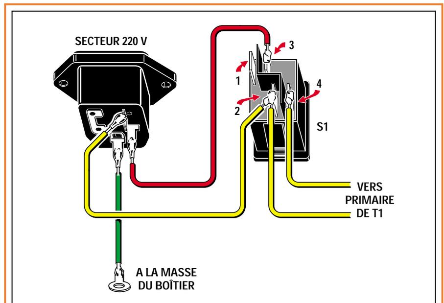
Figure 16 : Pour relier l'interrupteur à la prise secteur, vous devrez effectuer les connexions visibles sur le dessin. Les numéros portés à côté des broches sont gravés sur le corps de l'interrupteur. Un fusible est placé à l'intérieur de la prise 220 volts. Nous vous conseillons de relier la broche de la prise de terre du secteur à la masse métallique du coffret.
