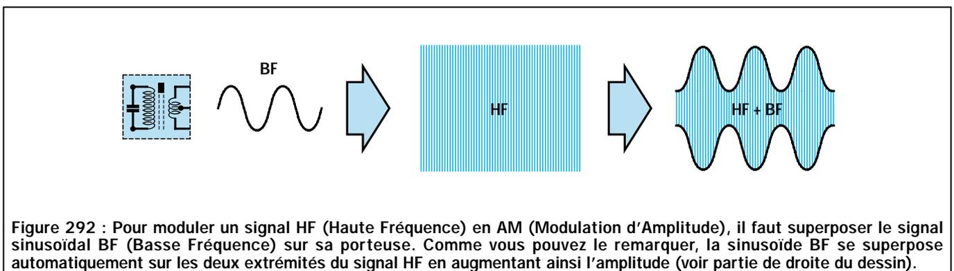
Figure 292 : Pour moduler un signal HF (Haute Fréquence) en AM (Modulation d'Amplitude), il faut superposer le signal sinusoïdal BF (Basse Fréquence) sur sa porteuse. Comme vous pouvez le remarquer, la sinusoïde BF se superpose automatiquement sur les deux extrémités du signal HF en augmentant ainsi l'amplitude (voir partie de droite du dessin).
