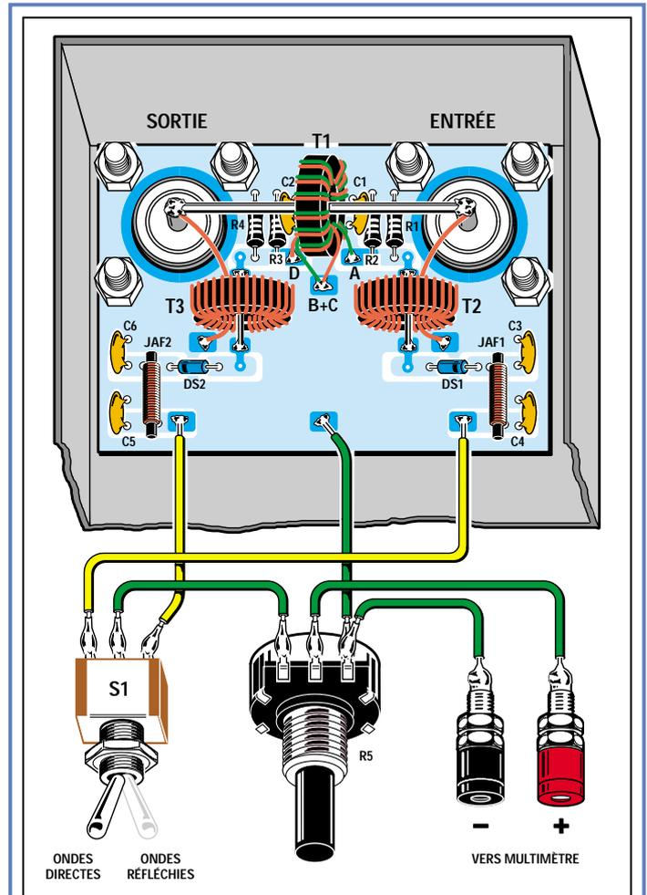
Figure 10 : Schéma d'implantation du ROSmètre LX.1395. Une fois le montage terminé, il est nécessaire de vérifier si les enroulements des deux transformateurs T2 et T3 sont en phase (voir texte).
