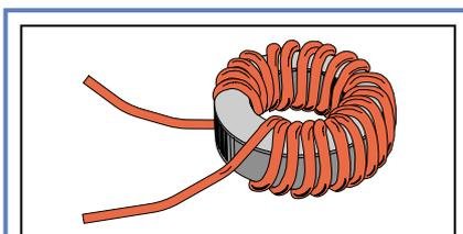
Figure 5 : Les transformateurs T2 et T3 s'obtiennent en enroulant 20 spires sur un tore de ferrite FT50.43, en utilisant du fil émaillé ou gainé de plastique de 0,3 ou 0,4 mm.
