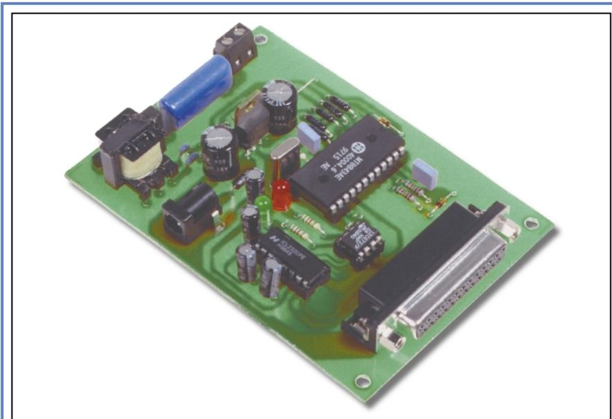
Grâce à l'emploi du circuit intégré Mitel MT8843, notre décodeur ID est particulièrement simple.
