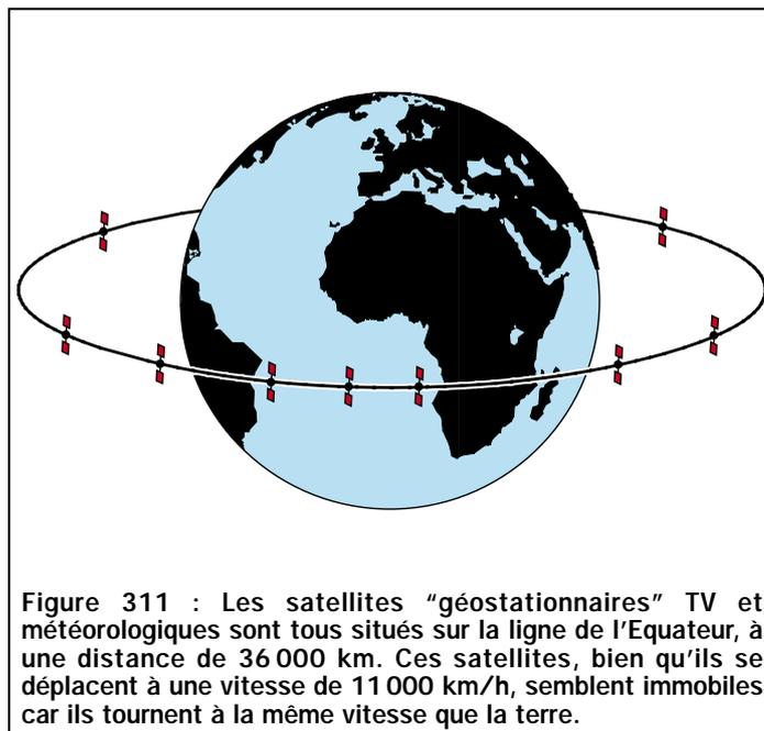
Figure 311 : Les satellites "géostationnaires" TV et météorologiques sont tous situés sur la ligne de l'Equateur, à une distance de 36 000 km. Ces satellites, bien qu'ils se déplacent à une vitesse de 11 000 km/h, semblent immobiles car ils tournent à la même vitesse que la terre.
