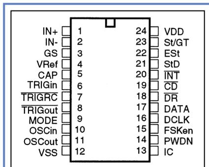
**Figure 3 : Brochage du circuit intégré Mitel MT8843.**
