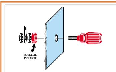
Figure 15 : Avant de fixer les bornes banane de sortie sur le panneau avant, démontez-les et mettez-les en place comme cela est indiqué sur le dessin. Le non-respect de ce type de mise en place, conduirait inévitablement à un court-circuit de la sortie du chargeur.
