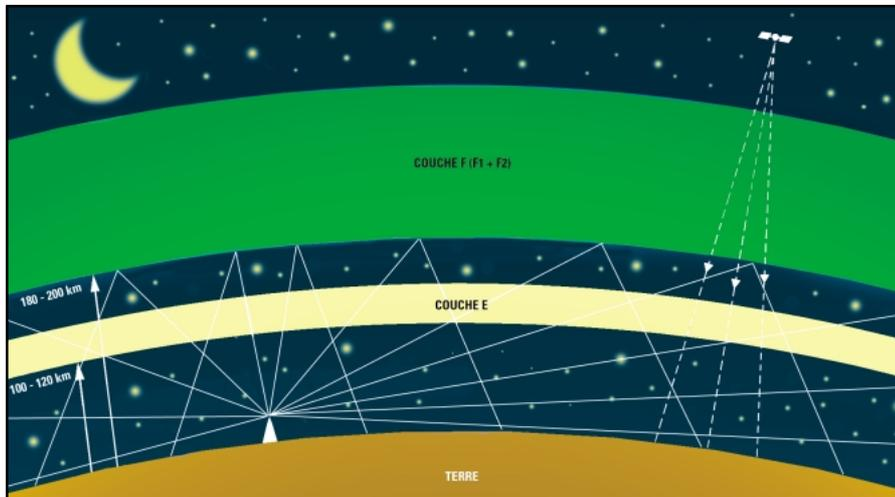
**Figure 288 : Quand la couche D disparaît pendant la nuit, toutes les fréquences des ondes courtes et très courtes, parvenant à atteindre la couche réfléchissante F, sont renvoyées vers la terre et atteignent ainsi des distances remarquables. Seules les ondes moyennes sont réfléchies par la première couche E et rarement par la couche F.**
