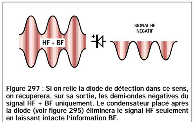
Figure 297 : Si on relie la diode de détection dans ce sens, on récupérera, sur sa sortie, les demi-ondes négatives du signal HF + BF uniquement. Le condensateur placé après la diode (voir figure 295) éliminera le signal HF seulement en laissant intacte l'information BF.
