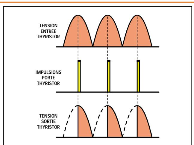
Figure 6 : Si les impulsions d'excitation atteignent la gâchette des thyristors à l'instant précis où la demi-alternance positive a déjà atteint la moitié de son parcours, nous obtiendrons, sur la sortie de ce pont, la moitié de la tension positive appliquée sur les anodes.
