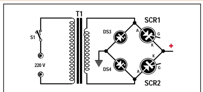
Figure 4 : Pour réaliser un pont redresseur, on peut utiliser également deux diodes et deux thyristors, si des impulsions positives sont envoyées sur leur gâchette.
