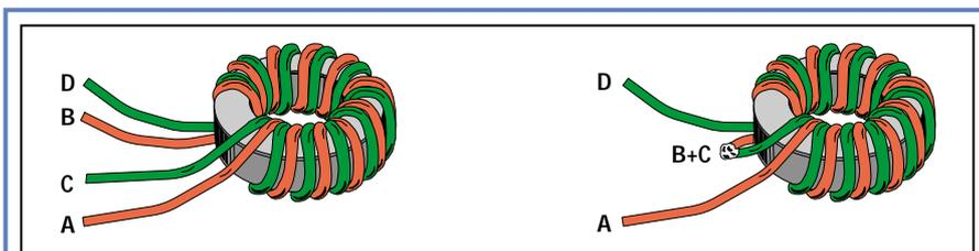
Figure 4 : Le transformateur T1 s'obtient en enroulant 10 spires 2 fils, gainés plastique, en mains sur un tore de ferrite FT50.43.
