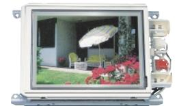
Système PAL. Dimension de l'affichage : 4" (10 cm). 89622 pixels. Résolution : 383 (I) x 234 (L). Configuration pixels : RVB Delta. Rétro-éclairage : CCFT. Signal vidéo d'entrée : 1 Vpp/75 Ω. Alimentation : 12 V/7 W.
