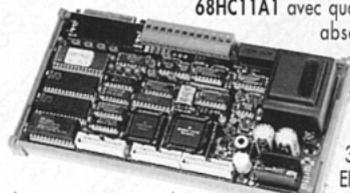
de 8K RAM+RTC ; E<sup>2</sup> à l'intérieur de CPU, 8 lignes A/D ; 32 I/O TTL ; RS 232, RS 422 ou RS 485 ; Watch-Dog ; Timer ; Counter ; etc. Alimentateur incorporé de 220Vac. Idéal pour le combiner au tool de développement logiciel ICC-11 ou Micro-C.
