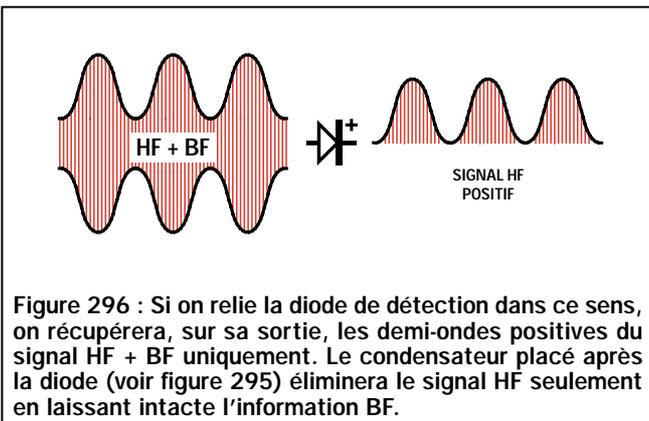
Figure 296 : Si on relie la diode de détection dans ce sens, on récupérera, sur sa sortie, les demi-ondes positives du signal HF + BF uniquement. Le condensateur placé après la diode (voir figure 295) éliminera le signal HF seulement en laissant intacte l'information BF.
