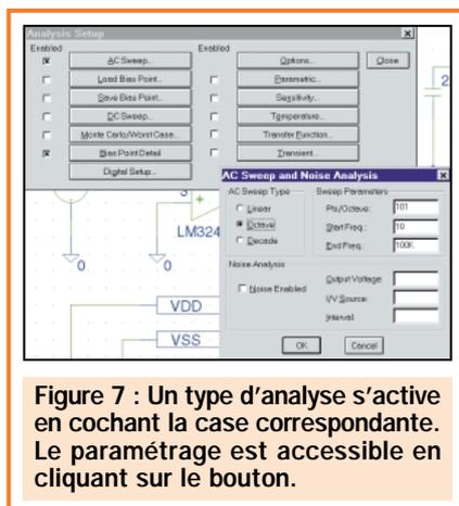
Figure 7 : Un type d'analyse s'active en cochant la case correspondante. Le paramétrage est accessible en cliquant sur le bouton.
