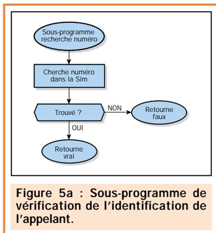
**Figure 5a : Sous-programme de vérification de l'identification de l'appelant.**
