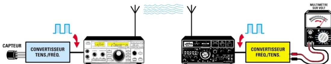
Figure 13 : En modulant un émetteur avec la fréquence générée par le capteur à effet Hall de la figure 11, ou du capteur de température LM35/D de la figure 14, vous pouvez connaître à distance le nombre de tours ou la température en reliant au récepteur le montage réalisé suivant le schéma de la figure 15.
