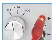
Cet article a pour but la réalisation d'un fréquencemètre analogique simple et économique. Pour ce faire, nous utiliserons un circuit intégré convertisseur fréquence/tension qui permettra de lire, sur un simple multimètre, une fréquence allant de quelques hertz jusqu'à 100 kHz.
