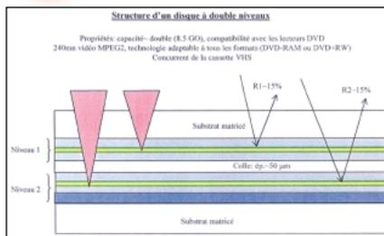
transparente, on peut lire la seconde au travers! De ce fait, il n'est pas nécessaire de retourner le disque pour accéder à "la seconde face".
