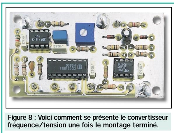
Figure 8 : Voici comment se présente le convertisseur fréquence/tension une fois le montage terminé.
