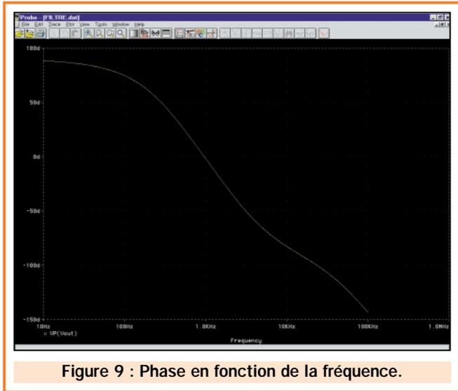
Figure 9 : Phase en fonction de la fréquence.
