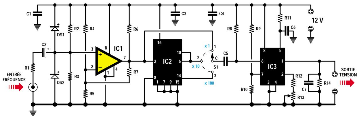
Figure 6 : Schéma électrique du convertisseur fréquence/tension. Le premier amplificateur opérationnel sert pour transformer un signal de forme quelconque (sinusoidal, triangulaire, dents de scie) en un signal parfaitement carré. Celui-ci sera ensuite appliqué sur l'entrée du convertisseur. Le circuit intégré IC2 est un double diviseur par 10.
