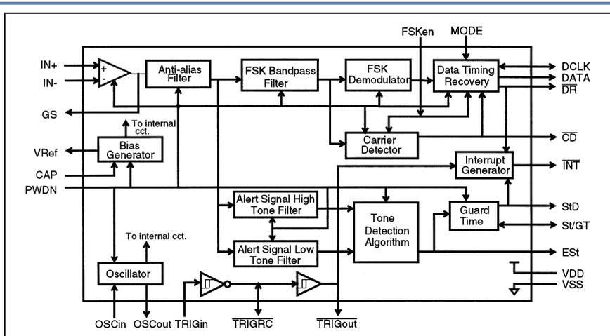
**Figure 4 : Schéma synoptique du circuit intégré Mitel MT8843.**
