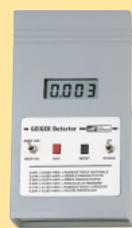
Cet appareil va vous permettre de mesurer le taux de radioactivité présent dans l'air, les aliments, l'eau, etc. Le kit est livré complet avec son coffret sérigraphié.
