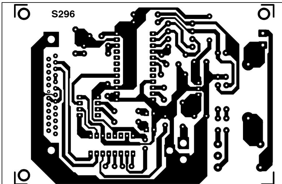
Figure 10 : Dessin à l'échelle 1 du circuit imprimé.
