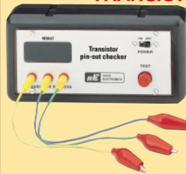
Ce kit va vous permettre de repérer les broches E, B, C d'un transistor et de savoir si c'est un NPN ou un PNP. Si celui-ci est défectueux vous lirez sur l'afficheur "bAd".
