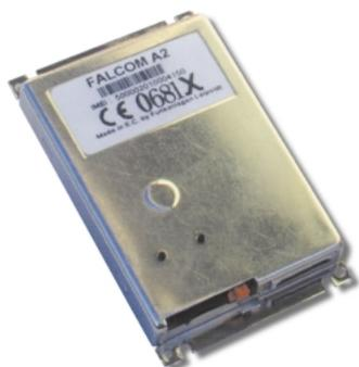
La commande de portail pilotée par GSM décrite dans cet article utilise un module GSM Falcom A2 dont les dimensions sont particulièrement réduites.
