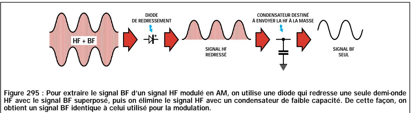
Figure 295 : Pour extraire le signal BF d'un signal HF modulé en AM, on utilise une diode qui redresse une seule demi-onde HF avec le signal BF superposé, puis on élimine le signal HF avec un condensateur de faible capacité. De cette façon, on obtient un signal BF identique à celui utilisé pour la modulation.
