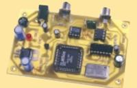
Version 12 V avec entrée et sortie sur RCA.
