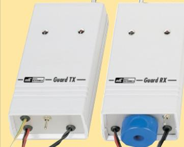
Cette alarme à système d'alerte déporté, trouvera son utilité dans la surveillance d'un local éloigné de 50 à 60 mètres de l'habitation ou du bureau ou dans la surveillance d'un véhicule.
