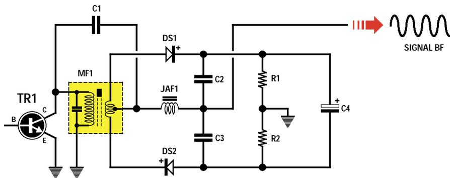
Figure 302 : Pour extraire le signal BF d'un signal modulé en FM, on relie deux diodes de polarité opposée sur le secondaire, muni d'une prise centrale, d'un pot moyenne fréquence. En l'absence de modulation, les deux diodes, en redressant la HF, chargent le condensateur électrolytique C4 avec une tension. En présence de modulation, les deux diodes font varier cette tension de façon à reproduire fidèlement la sinusoïde du signal BF.
