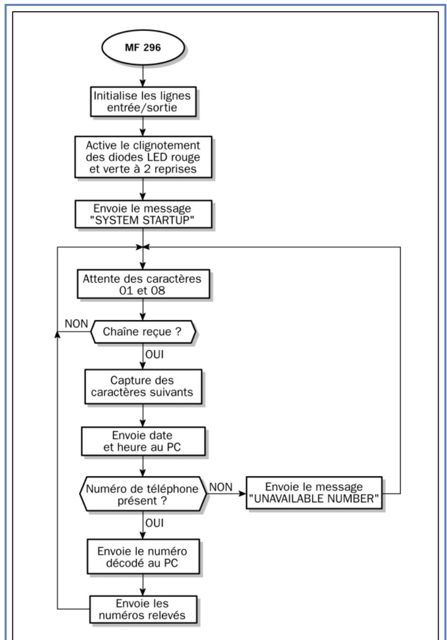
Figure 7 : Diagramme du programme implémenté dans le microcontrôleur.
