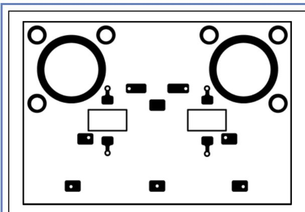
Figure 9b : Dessin du circuit imprimé à l'échelle 1, côté composants.
