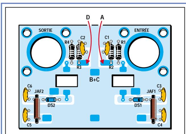
Figure 6 : Avant de fixer le circuit imprimé à l'intérieur du boîtier métallique, vous devez d'abord monter tous les composants représentés sur le dessin. La bague entourant le corps de la diode DS1 doit être dirigée vers l'impédance JAF1 et celle de la diode DS2 vers l'impédance JAF2.
