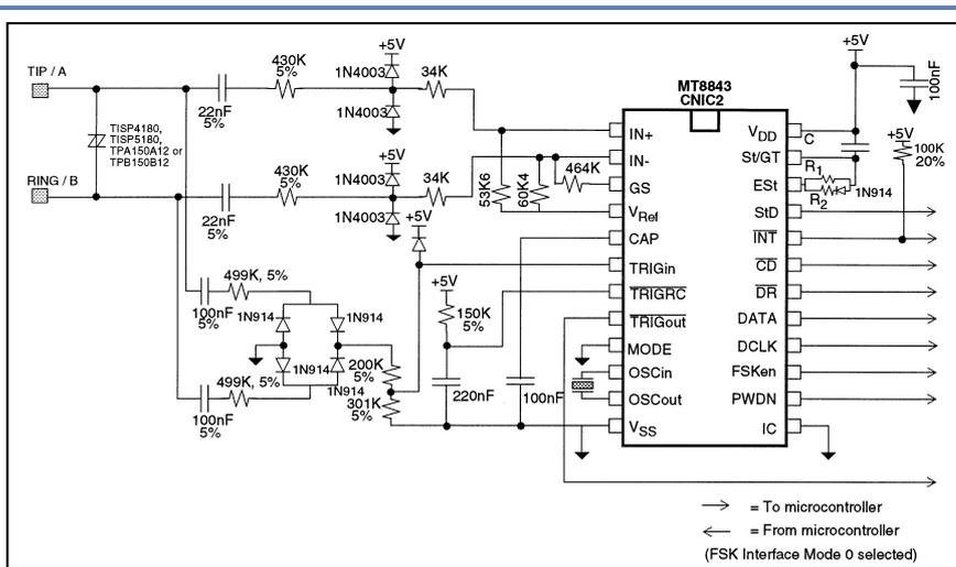
**Figure 5 : Schéma d'application constructeur du Mitel MT8843 (sans transformateur d'isolement). Dans les systèmes plus complexes, il est préférable d'utiliser un transformateur de couplage de façon à isoler la ligne téléphonique des appareils du système.**
