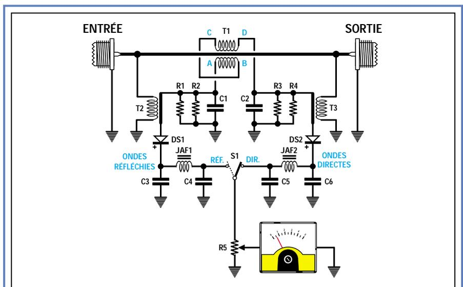
Figure 3 : Schéma électrique du ROSmètre LX.1395. Pour bobiner le transformateur T1, suivez attentivement les instructions de la figure 4, et pour bobiner les transformateurs T2 et T3, suivez les instructions de la figure 5.
