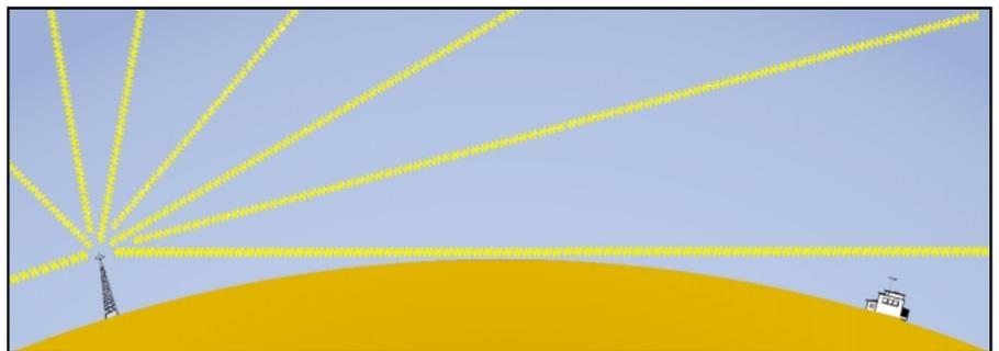
**Figure 289 : Les fréquences VHF ou UHF rayonnées par un émetteur TV terrestre ne peuvent être captées que par l'intermédiaire des "ondes de sol". Comme la terre est ronde, leur portée peut dépasser la portée "optique". C'est pour cette raison que les antennes émettrices sont installées au sommet des points hauts afin de pouvoir atteindre de plus grandes distances.**
