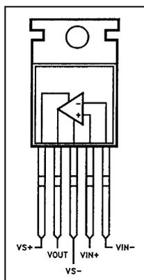
En fait il a une largeur de bande passante de l'ordre de 50 MHz (à -3 dB), un "slew rate" très élevé (1 000 V/μs), une erreur de phase négligeable (à peine 0,05 %) et la possibilité de fournir un
