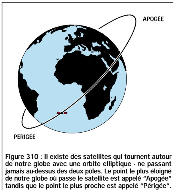
Figure 310 : Il existe des satellites qui tournent autour de notre globe avec une orbite elliptique - ne passant jamais au-dessus des deux pôles. Le point le plus éloigné de notre globe où passe le satellite est appelé "Apogée" tandis que le point le plus proche est appelé "Périgée".
