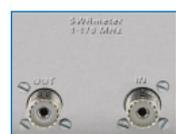
Le ROSmètre simple à lignes imprimées que nous vous avons proposé dans la revue numéro 6, page 26 et suivantes, a le défaut de son avantage : il est peu sensible aux fréquences se trouvant en dessous de 30 MHz mais, par contre, il peut effectuer des mesures jusqu'à 300 MHz. Pour mesurer les ondes stationnaires sur une gamme de fréquences comprise entre 1 et 170 MHz, il faut utiliser un ROSmètre à tores de ferrite. C'est de cet appareil que nous vous proposons la description dans cet article.
