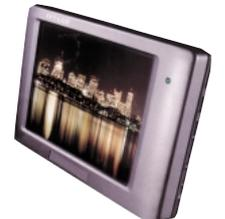
Version "Super Slim", épaisseur 16 mm. Système PAL. 224640 pixels. Résolution : 960 (I) x 234 (L). Configuration pixels : RVB Delta. Rétro-éclairage : CCFT. Signal vidéo d'entrée : 1 Vpp/75 Ω. Alimentation : 12 V/8 W. La durée de vie de ces moniteurs est garantie pour 10 000 heures
