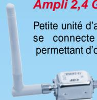
Petite unité d'amplification HF à 2,4 GHz qui se connecte au transmetteur 10 mW permettant d'obtenir en sortie une puissance de 50 mW sous 50 Ω. L'amplificateur est alimenté en 12 V et il est livré sans son antenne.
