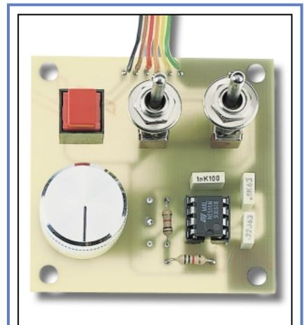
Figure 13b : Photo de la platine LX.1419 que nous utilisons pour piloter le circuit de puissance LX.1420.
