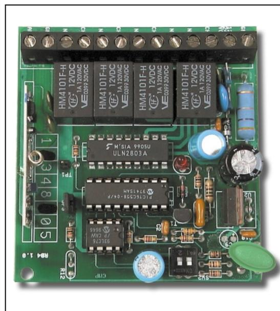
Notre prototype terminé et monté sur le circuit imprimé double face à trous métallisés, sérigraphié et verni.
