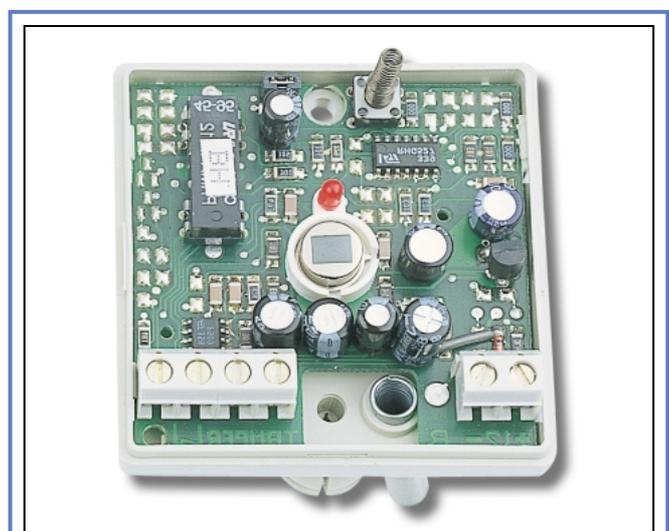
Figure 7 : Si vous enlevez la lentille de Fresnel, au centre du circuit imprimé, vous pouvez observer un petit capteur très sensible uniquement au rayonnement infrarouge émis par un être humain.
