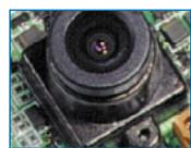
Ce mini émetteur audio/vidéo en VHF, peut être activé et désactivé au moyen d'une radiocommande codée sur 433 MHz. Il est adapté aux contrôles vidéo dans des locaux divers, mais également à la surveillance à distance d'une habitation, d'une chambre d'enfants, etc. La transmission peut être facilement reçue sur un téléviseur quelconque.
