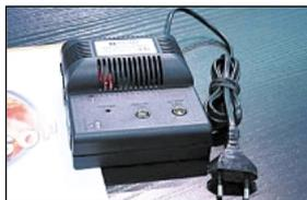
Parmi les différentes sortes de modulateurs UHF disponibles sur le marché, permettant de renvoyer une image provenant d'une source vidéo vers un téléviseur, on notera ce modèle, produit par Johanson, équipé d'un synthétiseur à PLL, garantissant une excellente stabilité de la fréquence. Compatible avec les systèmes PAL, SECAM et NTSC, sa fréquence et la norme sont program-
