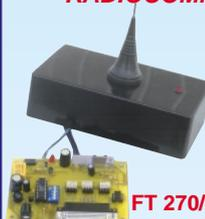
Ce kit va vous permettre de piloter de votre PC, 32 récepteurs différents. Vous pouvez utiliser tous les récepteurs utilisant les circuits intégrés type MM53200 ou UM86409. Cette radiocommande utilise le nouveau module AUREL permet, en champ libre, une portée entre 2 et 5 km. Le système utilise un circuit intégré codeur MM53200 (UM86409). Décrit dans ELECTRONIQUE n° 4.
