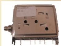
Module Tuner réception 2,4 GHz seul, contrôle de fréquence par bus I2C (PLL SP5055), sortie bande de base, doc. technique anglaise fournie.
