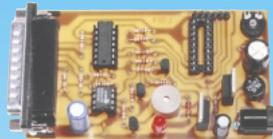
Permet de programmer tous les microcontrôleurs MICROCHIP, à l'exception des PIC16C5x et des PIC17Cxx.
