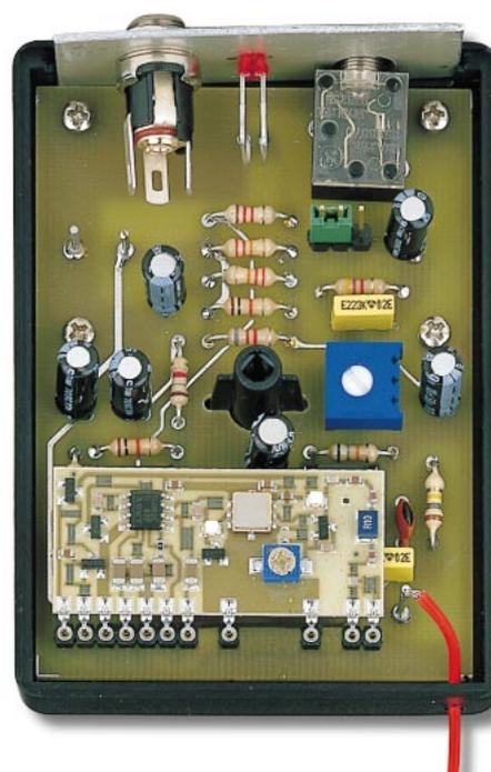
Figure 13 : Après avoir soudé les broches du module KM01.41 sur le circuit imprimé, il faut le replier en "L" afin de pouvoir assurer la fermeture du couvercle du boîtier. Le fil d'antenne est soudé sur le picot situé près du condensateur C7 (voir figure 6).
