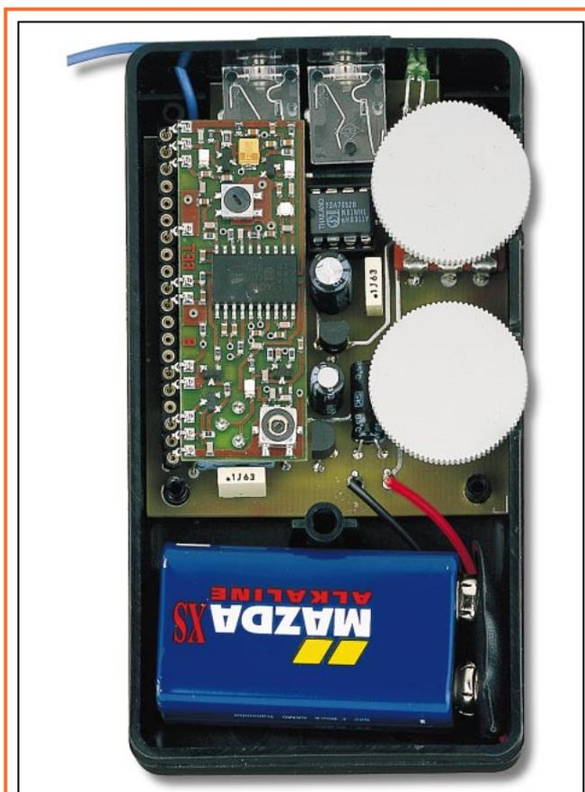
Figure 16 : Les broches du module récepteur KM01.40 sont insérées dans le connecteur femelle à 20 broches disposé sur le circuit imprimé. Ce module sera également replié en "L" avec les composants dirigés vers le haut, comme cela peut se voir sur la photographie.
