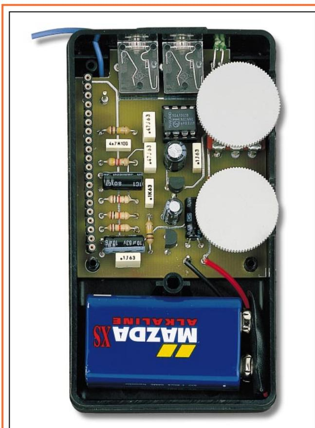
Figure 15 : Avant de mettre le circuit imprimé en place dans le boîtier, vous devez percer et découper ce dernier en vous inspirant de la figure 17 dans laquelle vous trouverez toutes les dimensions des perçages et découpes.
