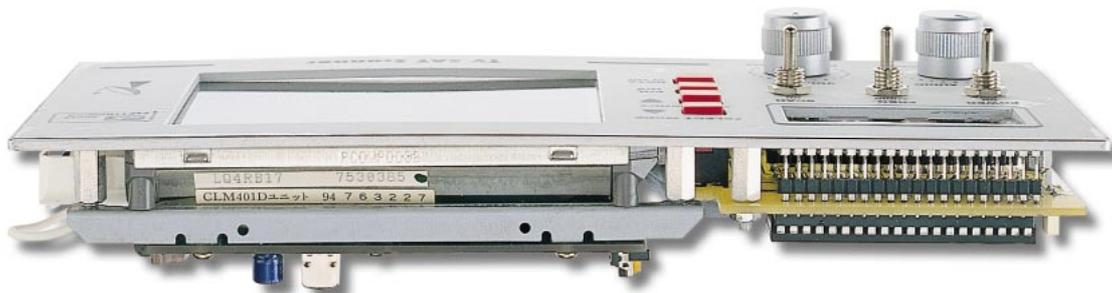
Figure 23 : Pour fixer le moniteur LCD et la platine LX.1415/B, il faut utiliser des entretoises métalliques mâle-femelle que vous trouverez dans le kit (voir dessin de la figure 24).
