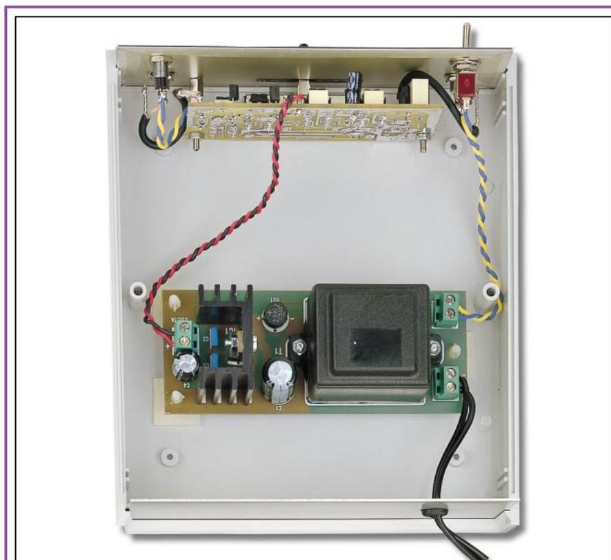
Figure 11 : A l'intérieur de l'appareil, un emplacement est réservé pour insérer le bloc d'alimentation LX.1335 qui est reproduit sur la figure 14.
