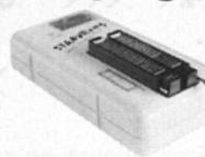
Programmeur, à Bas Prix, pour µP PIC ou pour MCS51 et Atmel AVR. Il est de plus à même de programmer les EPROM sérielles en IIC, Microwire et SPI. Fourni avec logiciel et alimentateur de réseau. 1.134,89 FF 173,00 €
