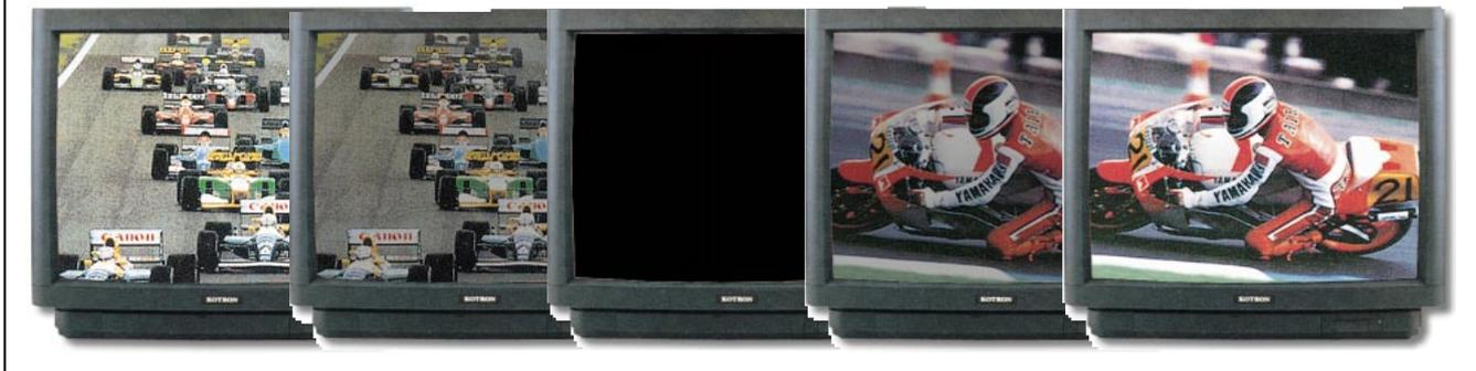
Figure 3 : En agissant sur le potentiomètre vous pouvez réduire le contraste d'une image jusqu'à la rendre complètement noire. Après quoi vous pouvez insérer une seconde image sur la bande.
