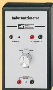
À l'aide de ce simple inductancemètre, vous pourrez mesurer des selfs comprises entre 10 microhenry et 10 millihenry. La lecture de la valeur se fera sur un multimètre analogique ou numérique (non fourni).
