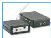
Ce microphone radio utilise, à la place des traditionnels quartz, des résonateurs à ondes de surface (SAW). Tout comme son récepteur, il fonctionne dans la bande des 433 MHz et peut être utilisé comme microphone de scène sans fil ou pour la réception de confort d'un téléviseur ou d'une chaîne HI-FI. Bien entendu, il trouvera également son utilité dans de nombreuses autres applications.
