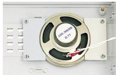
Figure 20 : Le petit haut-parleur est fixé sur le couvercle du coffret au moyen de deux pièces métalliques échancrées pour épouser le profil du haut-parleur.
