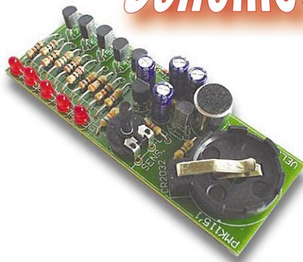
Le MK115 est un kit sonomètre de poche permettant une évaluation du niveau sonore, indiqué par 5 LED rouges. Facile à monter, peu encombrant, il dispose d'une sensibilité réglable. Le MK115 est doté de son propre microphone. L'alimentation s'effectue par une pile (non fournie) de 3V, type CR2032.
