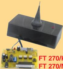
Ce kit va vous permettre de piloter de votre PC, 32 récepteurs différents. Vous pouvez utiliser tous les récepteurs utilisant les circuits intégrés type MM53200 ou UM86409. Pour radiocommande. Très bonne portée. Le nouveau module AUREL permet, en champ libre, une portée entre 2 et 5 km. Le système utilise un circuit intégré codeur MM53200 (UM86409). Décrit dans ELECTRONIQUE n° 4.
