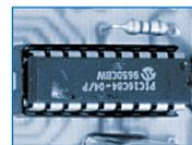
Ce nouveau circuit est conçu pour la génération des 16 tonalités standards DTMF. Très compact et de réalisation simple, il utilise un PIC16C84 à la place du classique UM95087. Le microcontrôleur permet de lire le clavier matricé et de produire un signal modulé grâce à l'utilisation d'une routine appropriée.
