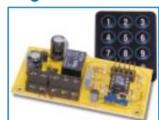
Sûre et fiable, cette clef électronique à clavier trouvera ses applications dans la commande de systèmes d'alarme, de portes à ouverture électrique, de portails motorisés, etc. Le code (à 6 chiffres), se compose sur un petit clavier matricé. Le reste, est confié à un nouveau microcontrôleur Microchip qui, à lui tout seul, gère toutes les fonctions et assure la commande d'un relais en sortie.
