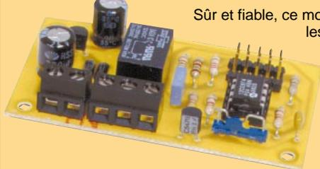
Sûr et fiable, ce montage est conseillé pour les ouvertures de portes et portails, la mise en marche ou l'arrêt d'alarme, etc. Le code de 6 chiffres est programmable.
